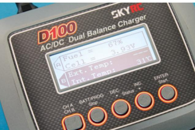
Während der Lader zwei Akkus befüllt, erhält man jederzeit Infos über den Akku (oben, Gesamtfüllung und durchschnittliche Einzelzellenspannung) sowie das Ladegerät (unten, Gehäuse-Innentemperatur)
