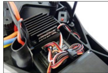
Der sehr kleine Dreikanal-Empfänger ist über einen Taster schnell an den Sender gebunden und ein komplett lüfterloser 45-Ampere-Brushless-Regler von Dragon RC sorgt für die saubere und ruckelfreie Ansteuerung des 9-Turns-Motors
