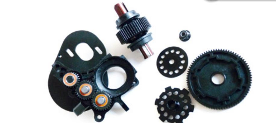
Das Getriebe könnte man wahlweise auch mit drei anstelle der serienmäßigen vier Zahnräder betreiben, um die Motordrehrichtung zu verändern. Hierzu ist das Kegelraddifferential in einem exzentrischen Halter gelagert und lässt sich wahlweise oben (drei Zahnräder) oder unten (vier Zahnräder) montieren
