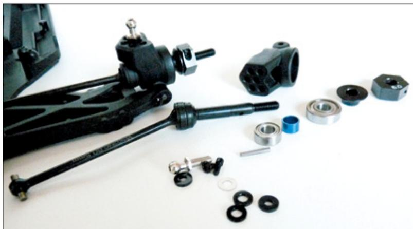
Veränderbarer Radstand durch Unterlegscheiben, übergroße äußere Kugellager, ein Ring zur Kräfteverteilung der Kugellagerinnenringe, CVD-Wellen mit Sicherungsring, Radträger mit vielen Anlenkpunkten und ein klemmbarer 12-Millimeter-Sechskantmitnehmer – mehr geht derzeit am hinteren Radträger nicht
