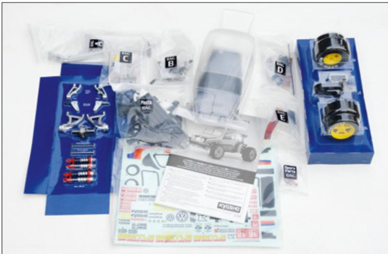
Die Bauteile sind in nummerierten Beuteln abgepackt, was den Zusammenbau übersichtlich macht
