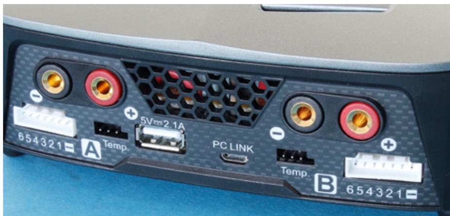
Neben den beiden Akkuanschlüssen mit jeweils einem Balancer- und Temperatur-Sensor-Port gibt es noch einen USB-Port zum Laden von beispielsweise einer Actioncam oder eines Smartphones und eine PC-Link-Schnittstelle
