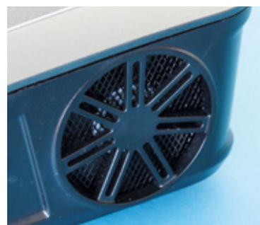
Zwei große Lüfter im Gehäuse – einer links und einer rechts – halten die Elektronik kühl, sind aber nicht gerade leise
