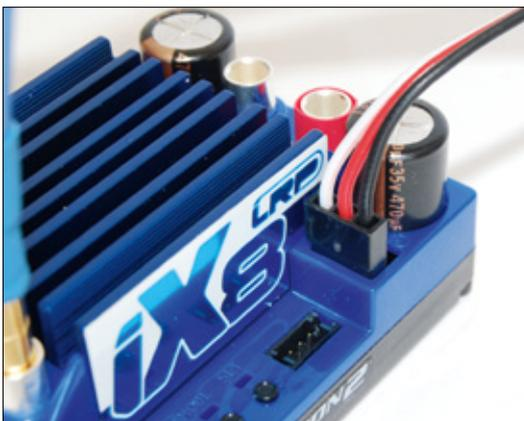
Das Empfängerkabel verfügt ebenfalls über eine Steckverbindung und lässt sich bei einer Beschädigung problemlos austauschen
