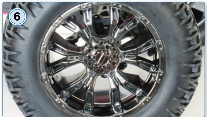
Um an die Radmutter zu gelangen, muss man zunächst die sechs Inbusschrauben des Nabendeckels lösen
