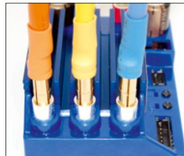
Die mitgelieferten Kabel sind werkseitig mit 4-Millimeter-Goldkontaktsteckern versehen
