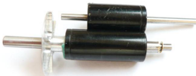
Der normale 540er-Anker wirkt im Vergleich zu einem eher kleineren Anker eines 550er-Motors aus dem 1:8er-Bereich schon recht zierlich. Die Leistung einiger 1:8er-Modelle kann daher – je nach Akku- und Motorqualität – auch knapp bis an die 2.500-Watt-Marke heranreichen
