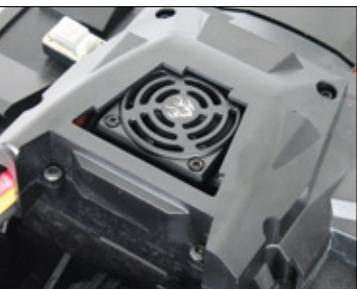
Der Fahrregler ist aktiv gefühlt und wird normalerweise noch von einer kleinen Abdeckung vor Schmutz geschützt
