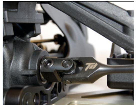
Für eine optimale Verteilung der Motorkraft an die Räder sorgen ringsherum Kardanwellen aus Stahl
