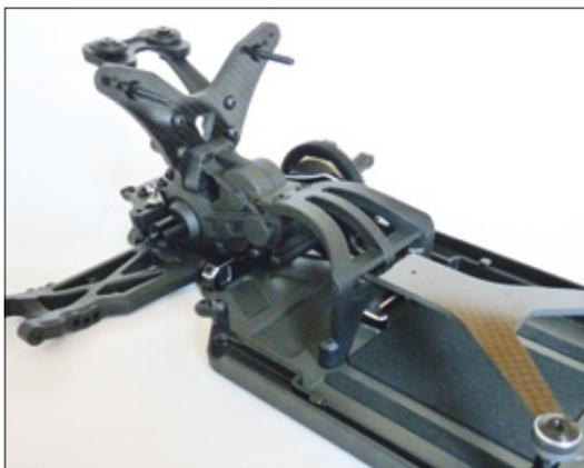
Die edle Anmutung täuscht nicht, denn der Yokomo YZ-2 nutzt eine sehr gute Kunststoffmischung, die sowohl fest als auch hoch belastbar ist und auch etwas Verwindung zulässt. Der Motorplatz ist zudem sehr gut zugänglich, um auch schnelle Motorwechsel zu ermöglichen
