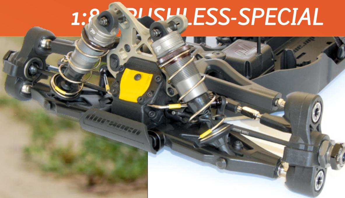
Modernste Renntechnik, wo man hinschaut: Aufhängung mit Buchsensystem, Rechts-links-Gewindestangen und Rändelschrauben auf den Dämpfergehäusen bilden nur einen Teil der möglichen Setup-Eingriffe
