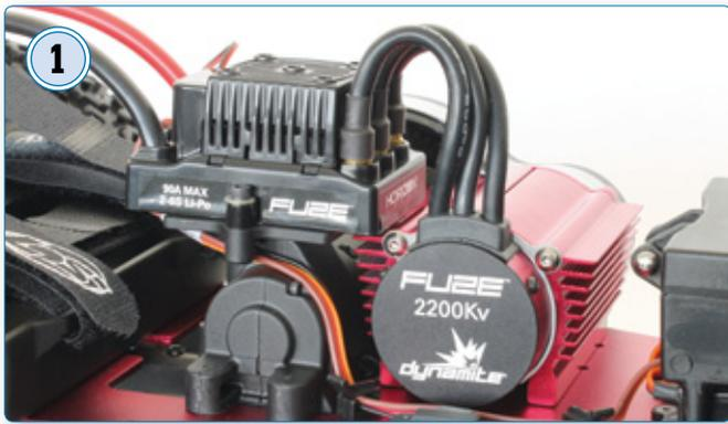
Das Fuze-Antriebsset kann mit bis zu 6s-LiPos befeuert werden. Das dafür notwendige V-Kabel mit EC5-Steckern liegt dem Set bei, die Akkus nicht
