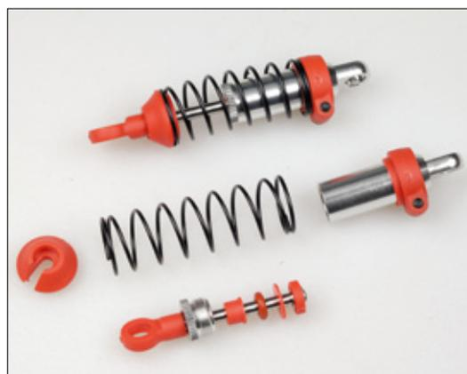
Bauteile der vormontierten Stoßdämpfer
