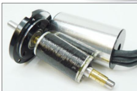
Motoren mit bis zu 45 Millimeter Durchmesser verfügen über große und sehr kräftige Anker, hier im Vergleich zu einem 380er-Motor. Deren Magnetkräfte sind so groß, dass man beim Einschnappen ins Gehäuse auf seine Finger achten muss
