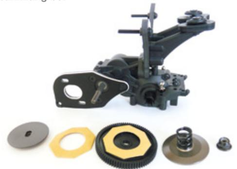
Im teilweise montierten Zustand ist der niedrige Schwerpunkt sofort erkennbar, zudem ist die mit 4 Millimeter sehr bullige CFK-Dämpferbrücke praxisingerecht dimensioniert. Die sechseckigen Slipperpads sind zudem kompatibel zu anderen Anbietern und erleichtern die Abstimmung durch eine Vielzahl nutzbarer Hauptzahnräder
