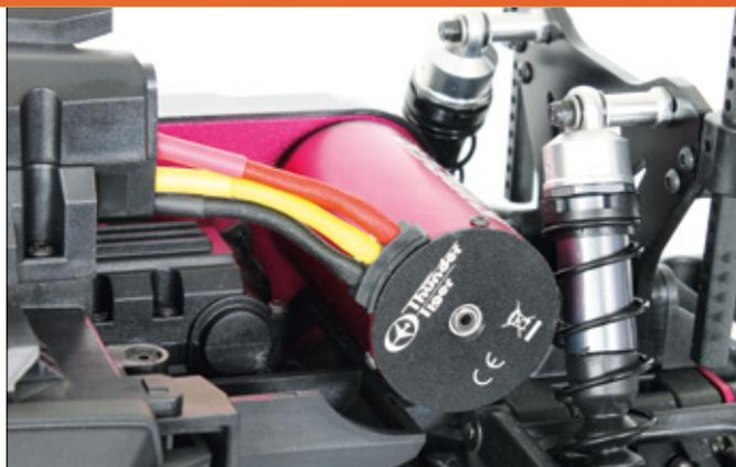
Der Ripper-Brushlessmotor hat eine spezifische Drehzahl von 2.000 Umdrehungen pro Minute und Volt
