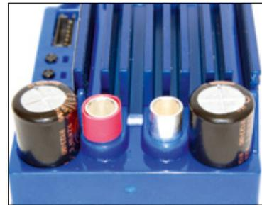
Statt mit Lötpfosten werden die Powerkabel per Stecker mit dem iX8 V2 verbunden. Ein Lötkolben wird nicht benötigt
