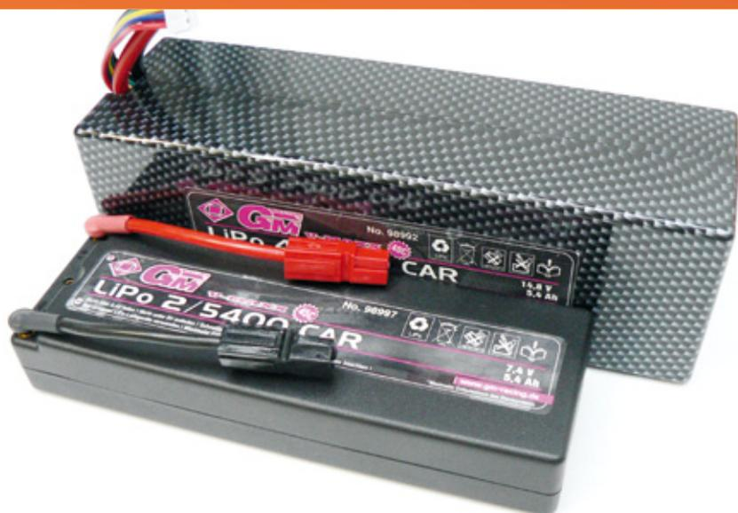
Ein üblicher 1:10er-LiPo-Stick-Pack im Vergleich zu einem sehr großen 4s-Akku, wie er in einigen Monstertrucks zum Einsatz kommt. Üblicherweise werden die 1:8er-Modelle aber mit zwei oder drei normalen 1:10er-Packs mit jeweils 2s betrieben
