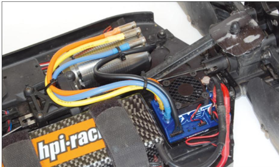
Der Einbau des gesamten Antriebs in einen 1:8er-Elektrobuggy geht sehr zügig von der Hand. Mit einem 4s-LiPo als Stromversorgung kann die Fahrt bald losgehen
