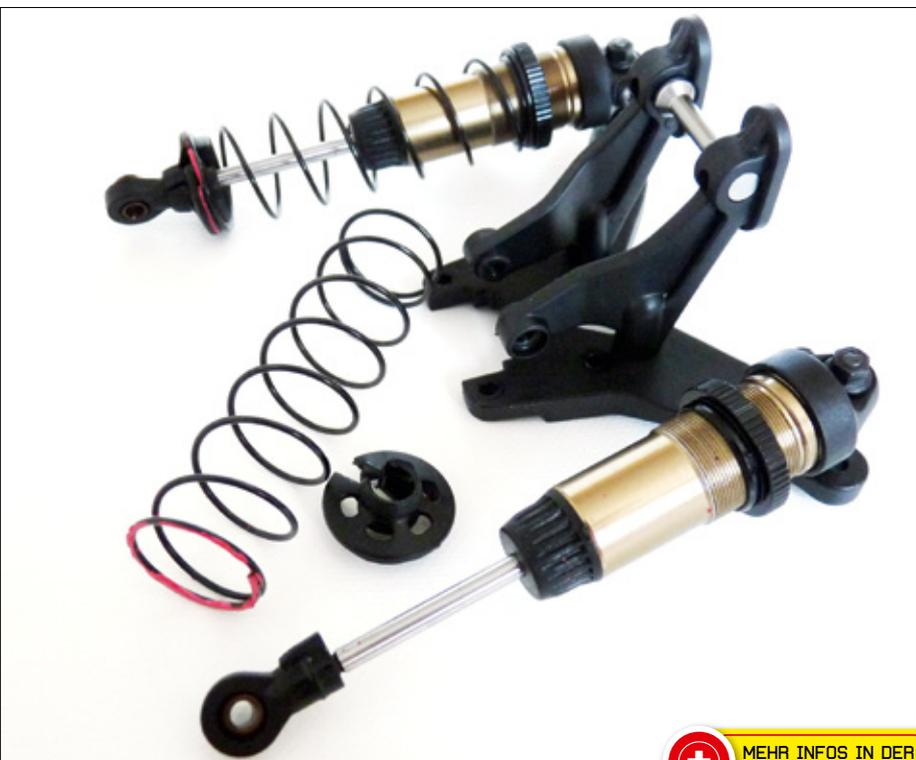
Passgenau gefertigte Kolbenplatten, stabile Alugehäuse, sehr gut abgestimmte Federn und verliersichere untere Federteller sind gerne gesehene Extras an den Dämpfern
