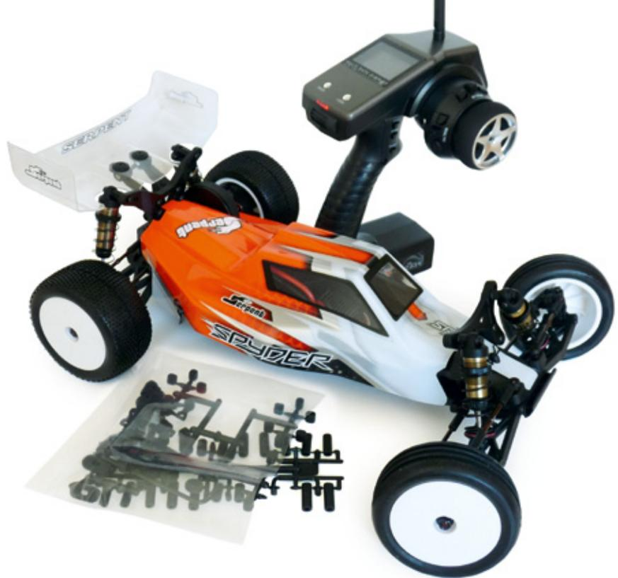
Neben der wirklich gut aufeinander abgestimmten Elektronik wird der Serpent SRX-2 MM mit einem programmierbaren 2,4-Gigahertz-Sender samt 15 Modellspeichern geliefert. Die beiliegenden Kleinteile dienen der individuellen Feinabstimmung auf die Strecke
