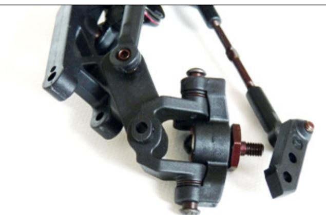
Die Verwendung von Federstahl an den hochbelasteten Stellen ist für ein RTR-Modell ebenso ungewöhnlich wie die bullige Auslegung der vorderen und hinteren Aufhängung und die Verwendung von leicht flexiblen, faserverstärktem Kunststoff
