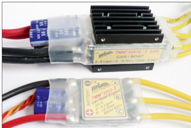
Die Elektronikschmiede MGM Compro ermöglicht stark individualisierbare Regler in fast allen Leistungsbereichen. Der hintere Regler verkräftet bis zu 224 Ampere und ist dabei nicht mal extrem groß, wie der Vergleich zum kleineren 1:12er-Regler zeigt
