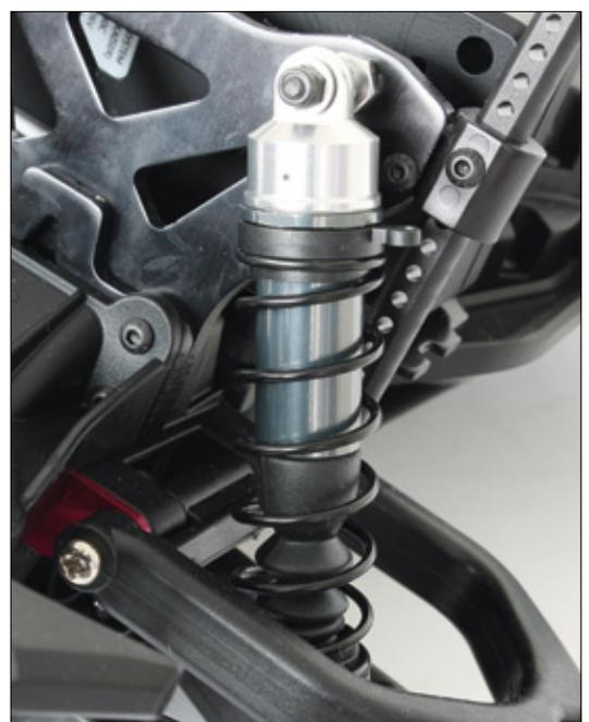
Die Aluminium-Öldruckstoßdämpfer verfügen über Gummitüllen, die die Kolbenstangen schützen
