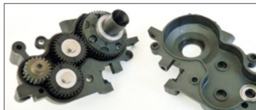
Das spezielle Low Profile-Getriebe des YZ-2 sorgt für einen extrem tief liegenden Schwerpunkt aller genutzten Bauteile. Da dieses Modell konsequent für den Einsatz auf griffigen Strecken ausgelegt wurde, kommt ein über Ölfüllungen beeinflussbares Kegelraddifferenzial zum Einsatz
