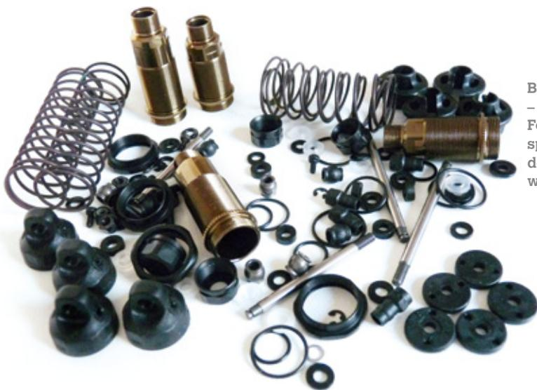
Bauteile ohne Ende – satte 22 Stück pro Dämpfer – ergeben zusammen mit einer sehr guten Fertigungsqualität seidenweiche Dämpfer ohne spürbares Losbrechmoment. Konsequenterweise liegen dem Baukasten auch einige Kolbenplatten für die weitere Abstimmung bei
