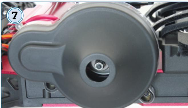
Der Brushlessmotor überträgt seine Kraft auf ein großes Kunststoffhauptzahnrad mit integriertem Slipper. Der Widerstand lässt sich über die Mutter unter der Abdeckung verändern
