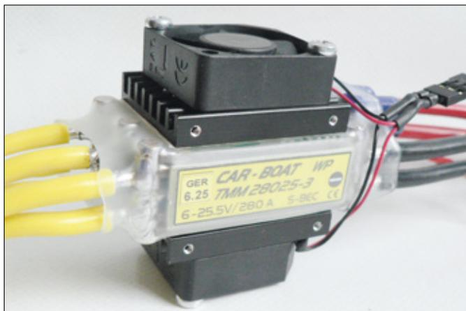
Bei den Reglern herrscht eine extreme Vielfalt, je nach Modell sind auch 1:10er-Regler zwischen 120 und 160 Ampere einsetzbar. Ein ungewöhnlicher Regler ist der 280 Ampere starke, etwa 180 Gramm schwere und mit doppelten 4-Quadratmillimeter-Kabeln ausgestattete Riese von MGM Compro
