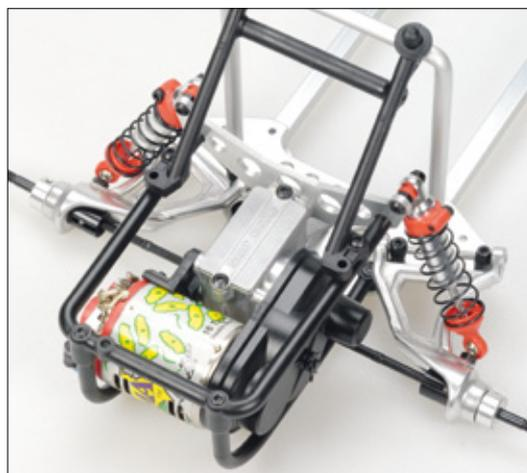
Der Motor sitzt im Heck- gut geschützt durch einen Käfig aus Kunststoffstreben
