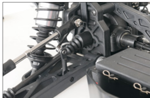
Stabilisatoren gibt's serienmäßig. Achswellen-Gelenke und Dämpferkolbenstangen sind sich in Gummitüllen verpackt
