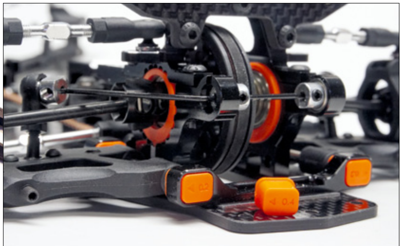
Aufgrund der klaren Beschriftung der exzentrischen Buchsen ist die gewählte Einstellung schnell nachvollziehbar
