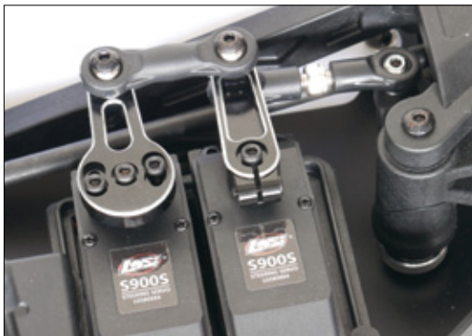
Zwei Servos mit jeweils rund 30 Kilogramm Stellkraft sind für die Lenkung zuständig
