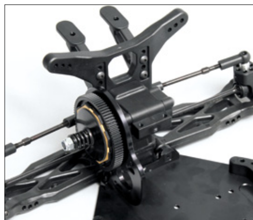
Detailblick auf die stehende Getriebox beim XB2 Dirt
