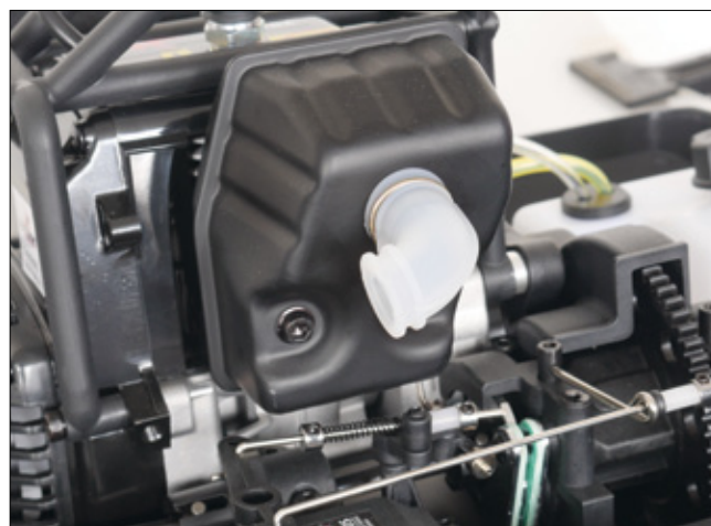
Irgendwie nicht zu Ende gedacht: Dank des abgewinkelten Silikonschlauchs verteilen sich die Abgase zwar nicht mehr seitlich dafür aber hinten auf dem Chassis
