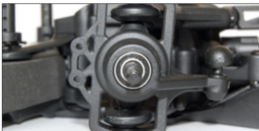
Gut: Bereits ab Werk drehen die Räder in Kugellagern. Das können nicht alle Konkurrenten in dieser Klasse bieten
