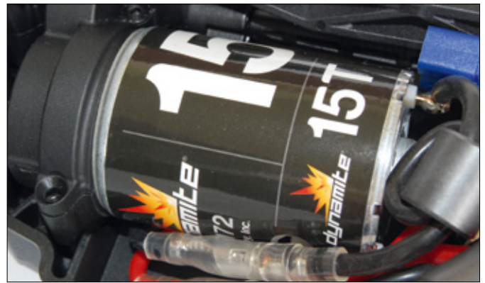
Zugegeben, wahre Sprengkraft besitzt der Dynamite-Bürstenmotor mit seinen 15 Turns nicht. Für Hobbyneulinge bildet er allerdings eine gute Einstiegs-Motorisierung
