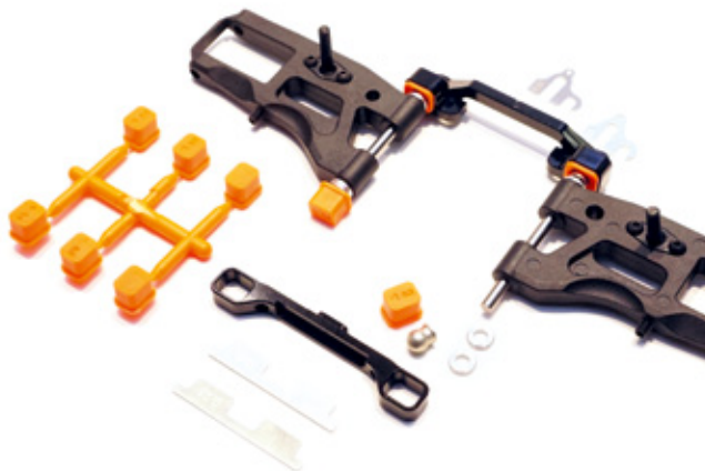
So sieht das Aufhängungsprinzip der Schwingen aus. Aufgrund der fein abgestuften Exzenterbuchsen und verschiedenen dicken Alu-Plättchen zum Unterlegen, lässt sich die Geometrie sehr vielfältig einstellen
