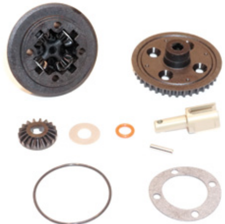
Das Kegeldifferenzial verfügt über eine zweifache Abdichtung. Das leichte Hakeln nach der Montage war nach wenigen Akkupacks verschwunden
