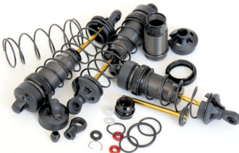
Die aus jeweils 23 Teilen montierten Stoßdämpfer haben ein sehr geringes Losbrechmoment und sorgen damit für eine optimale Dämpferwirkung. Da die obere Dämpferkappe über eine Entlüftungsschraube verfügt, ist das luftblasenfreie Einfüllen des Öls kein Problem
