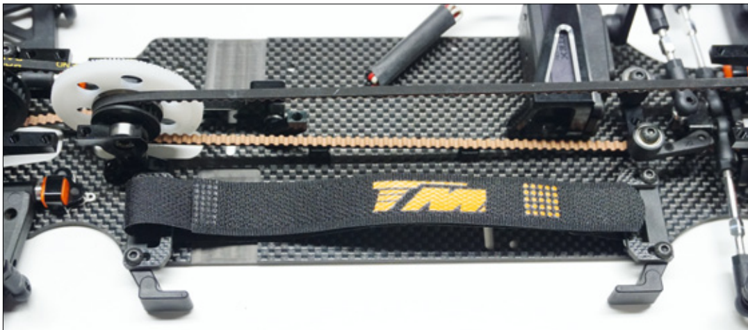
Der Fahrakku kann mittels des serienmäßigen Klettband-Halters oder wie üblich mit Klebeband befestigt werden
