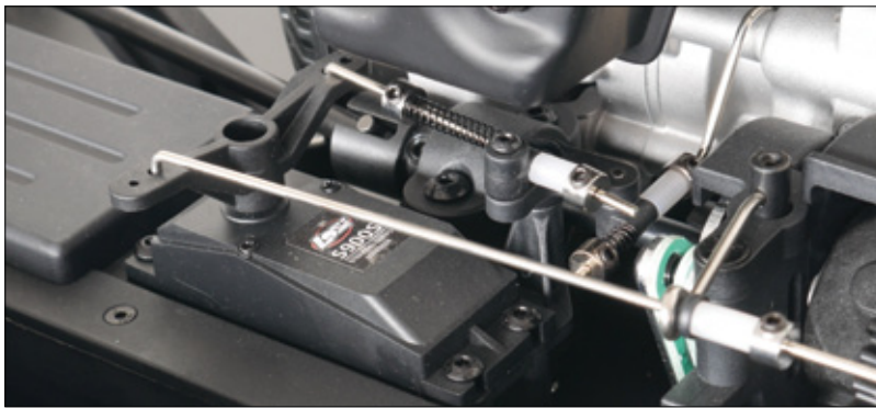
Über einen 90-Grad-Umlenkhebel betätigt das Gas-/Brems-Servo die Motordrossel
