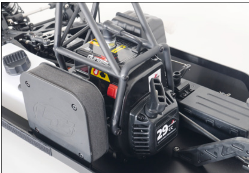
Der 29-Kubikzentimeter-Benziner ist serienmäßig mit einem großen Zweiwege-Luftfilter und einem einfachen Topf-Dämpfer ausgestattet
