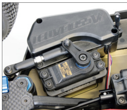
Mit rund 25 Kilogramm Stellkraft ist das Sanwa-Servo ideal für den Einsatz im 1:8er-Buggy
