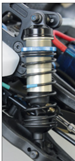
Perfekt verarbeitete Alu-Öldruckdämpfer sorgen für ein seidenweich arbeitendes Fahrwerk
