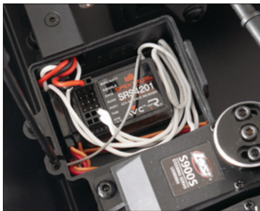
Der serienmäßige Empfänger ist mit AVC ausgestattet. Von den Servos kommt jeweils nur die Impulsleitung (weiß)
