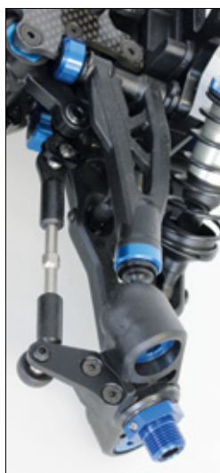
Pivot-Ball-Aufhängungen an der Vorderachse sorgen für geringes Spiel und erlauben ein einfaches Setup
