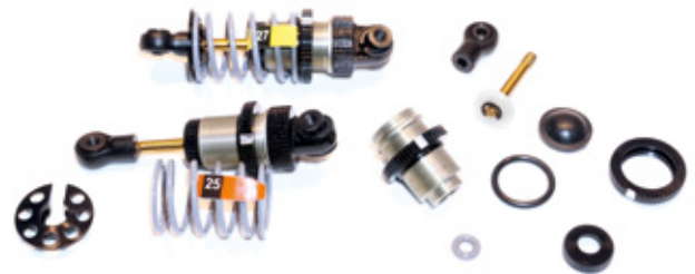
Die kurzen Alu-Dämpfer mit Volumenausgleich verfügen über alle Features, die man in dieser Klasse erwartet. Das gilt auch für die eindeutig gekennzeichneten Federn
