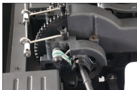
Die Zweischeiben-Bremsanlage sorgt für gute Verzögerungswerte
