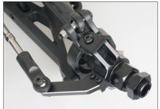
Die Lenkhebel mit den Radträgern an der Vorderachse sind komplett aus Alu gefräst
