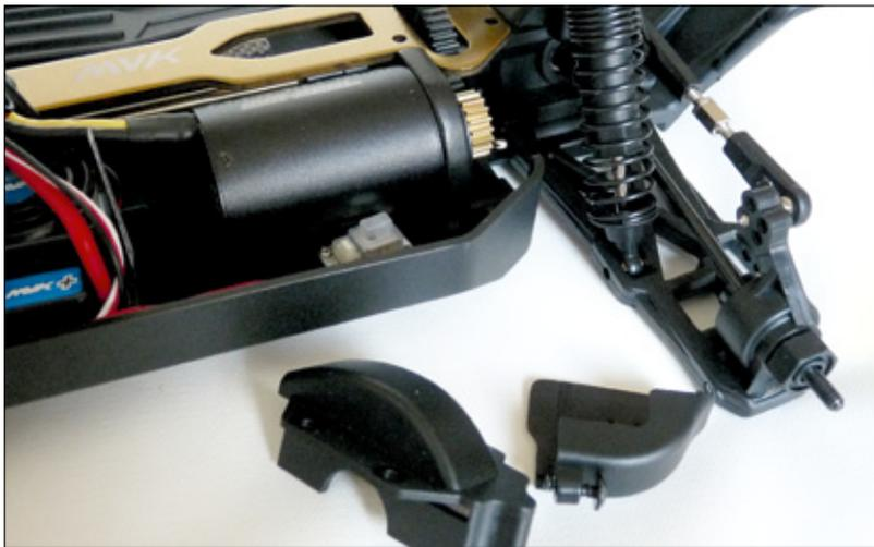
Das Motorritzel und das Hauptzahnrad sind gut durch eine mehrteilige Kunststoffabdeckung vor Schmutz geschützt. Für den Wechsel des Ritzels oder die Spielkontrolle reicht es, den kleineren Teil abzunehmen
