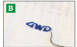
B. Beim Platzieren von einzelnen Aufklebern ist ein Picker aus dem Folienbereich sehr hilfreich, um die exakte Ausrichtung fehlerfrei hin zu bekommen. An der dünnen Spitze bleibt der Aufkleber nur schwach hängen, alternativ kann auch eine schmale Spitze eines Skalpells genutzt werden
