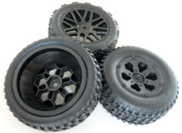
Bei den Reifen gibt es ebenfalls keine Überraschung, hier wird auf den weit verbreiteten 12-Millimeter-Sechskantmitnehmer gesetzt. Die eher feste Reifenmischung überzeugt zudem mit einer langen Lebensdauer und die Reifen sind größer als ein üblicher 1:10er-Reifen im Hintergrund
