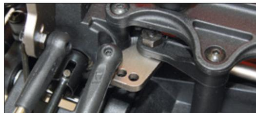
Selbst an unterschiedliche innere Aufnahmepunkte der Spurstangen wurde gedacht. Dadurch lässt sich der Ackermannwinkel der Lenkung justieren. Ein Setup-Feature, das eindeutig aus dem Wettbewerbsbereich stammt
