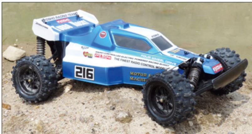
Vom Gallop MK I und II wurde der Kettenantrieb auch in den Turbo Rocky (rechts unten) und schließlich in den Optima übernommen. Neben einer Änderung bei der Gewichtsverteilung wurden die neueren Modelle vielfach stabiler konstruiert, um mit den ständig steigenden Motorleistungen mithalten zu können
