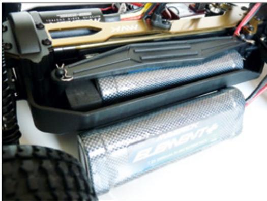
Das Akkufach bietet Platz zum Verschieben des Akkus, um die Balance des Modells verändern zu können. Alternativ können auch siebenzellige NiMH-Akkus genutzt werden, um nochmals etwas mehr Leistung zur Verfügung zu haben
