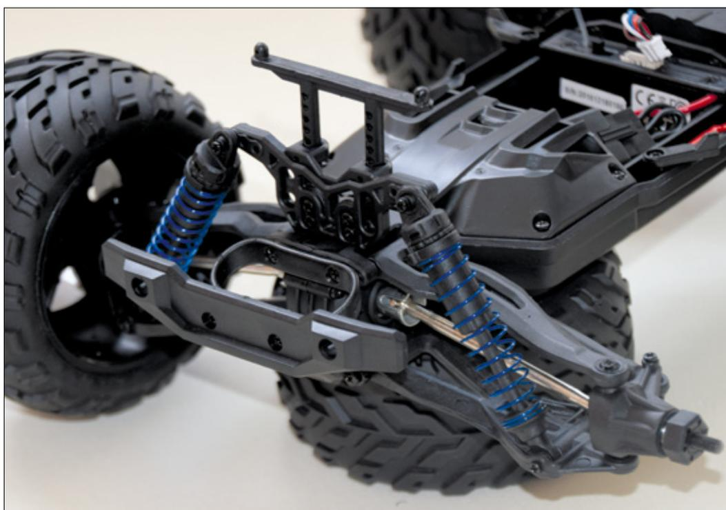
Die Antriebskraft wird über Stahlwellen zu den Rädern geleitet
