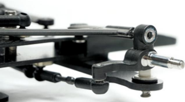
Der vorderen Radachsen können um 180 Grad im Lenkhebel gedreht werden. Dies ermöglicht eine schnelle Veränderung des Radstands
