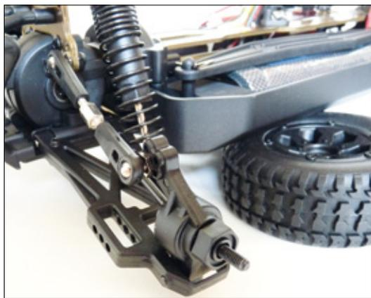
Neben den Rechts-links-Spurstangen gehören Kugellager an allen Stellen und auch großvolumige Öldruckdämpfer zum Standard beim Strada DT. Gut kann man auch die progressive Wicklung der Dämpferfedern erkennen, hiermit werden sowohl kleine Unebenheiten als auch heftige Sprünge gut abgefedert
