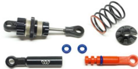
Der zentrale Dämpfer stammt aus dem Tourenwagen von WRC und lässt keine Wünsche offen. Die Wirkung des Reibungsdämpfers lässt sich durch die Anzahl an O-Ringen beeinflussen
