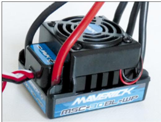
Der spritzwassergeschützte Regler wiegt inklusive Kabeln immerhin 91 Gramm und wird von Hobbywing gefertigt. Die Software dieses Herstellers ist sehr ausgereift und sorgt für eine sanfte Regelbarkeit des 3.200-KV-Motors
