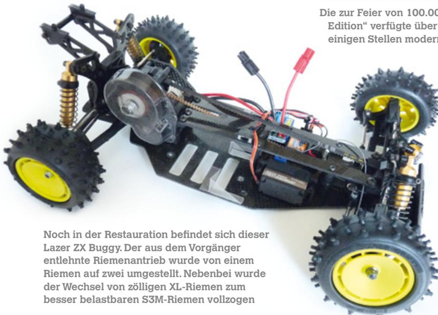
Noch in der Restauration befindet sich dieser Lazer ZX Buggy. Der aus dem Vorgänger entlehnte Riemenantrieb wurde von einem Riemen auf zwei umgestellt. Nebenbei wurde der Wechsel von zölligen XL-Riemen zum besser belastbaren S3M-Riemen vollzogen
