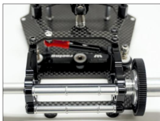
Die komplette Hinterachse mit Reibungsdämpfer, dessen Arbeitsweg etwas knapp ausfällt
