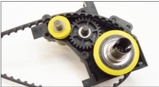
Die Motorkraft wird beim Optima Mid über die oben liegende Slipperwelle und ein Zwischenzahnrad auf das hintere Differential übertragen und von dort mittels XL-Riemen und einer kleinen gelben Umlenkrolle an die Vorderachse weitergegeben
