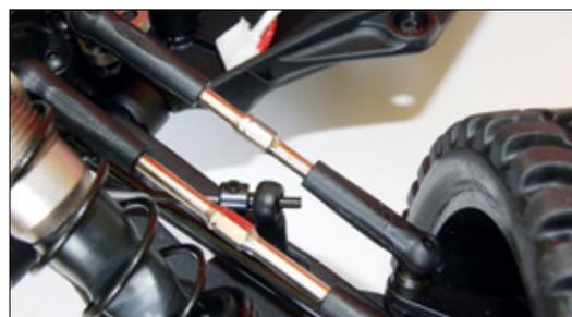
Rechts-links-Gewindestangen ermöglichen die stufenlose Abstimmung von Spur und Sturz. Serienmäßige Stabilisatoren reduzieren Wankbewegungen des Chassis speziell in Kurven
