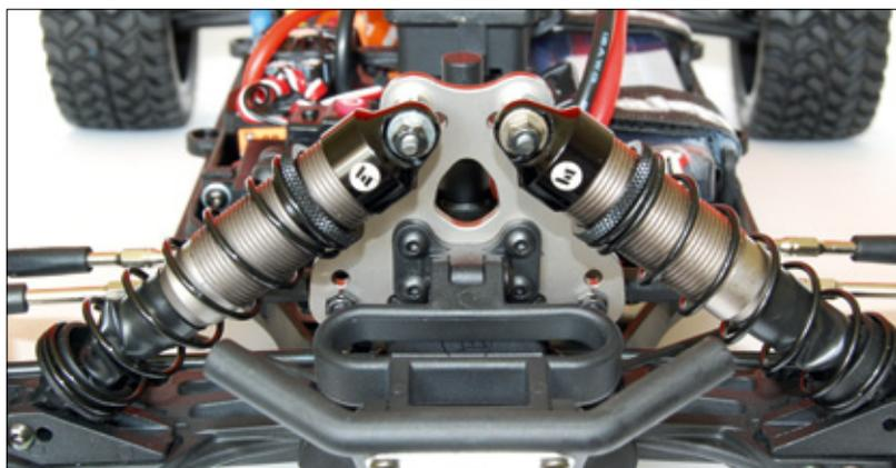
Speziell an der Vorderachse liegen die langen, mit Silikonöl befüllten Aluminium-Stoßdämpfer relativ flach. Dadurch ergibt sich ein recht weiches Setup, das auch im groben Gelände eine gute Figur macht
