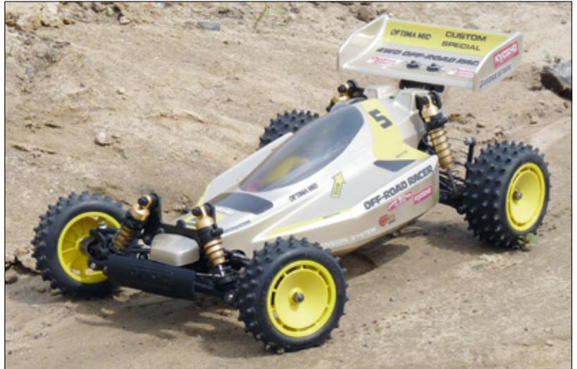
Einige besonders erfolgreiche Modelle wie der Ur-Optima wurden in Sondereditionen aufgelegt, wie auch dieser Optima Mid Custom Special. Es handelte sich im Grunde um einen normalen Custom, der aber mit Rechts-links-Gewindestangen, Kardanwellen an allen vier Rädern, Aludämpfern, einer stylischen Karosserie und zwei Kugeldifferenzialen sehr opulent ausgestattet ist
