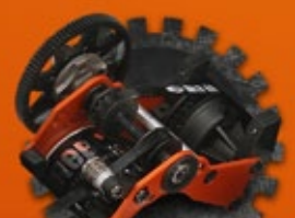
ALLRADANTRIEB MIT DOPPELTEM RIEMEN Verlustarm mit nur einer Zahradstufe.
