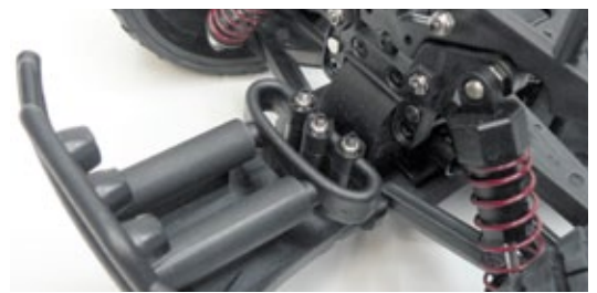
Die Konstruktion des vorderen Rammers ist ersatzteilmäßig ausgelegt, denn der Federmechanismus verhindert bei einem Crash weitere Schäden an der Aufhängung zuverlässig
