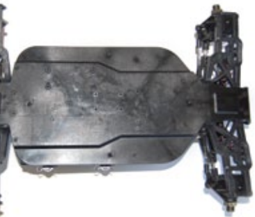
Der ZRE-1 baut auf einem Kunststoffchassis auf
