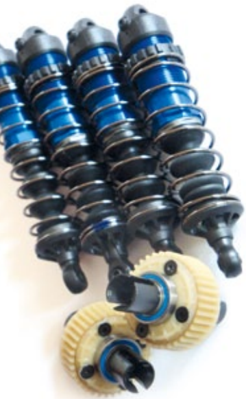
Die großvolumigen Big-Bore-Dämpfer und die Differenziale sind bereits fertig ab Werk zusammengebaut. Das erleichtert die Montage des SC10 4x4 ungemein
