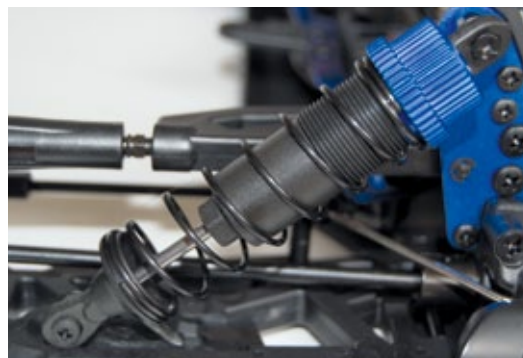
Die großvolumigen Bigbore-Stoßdämpfer konnten sich im Test besonders positiv in Szene setzen
