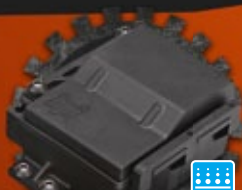
WASSERDICHTE EMPFÄNGERBOX hält die Elektronik trocken.
