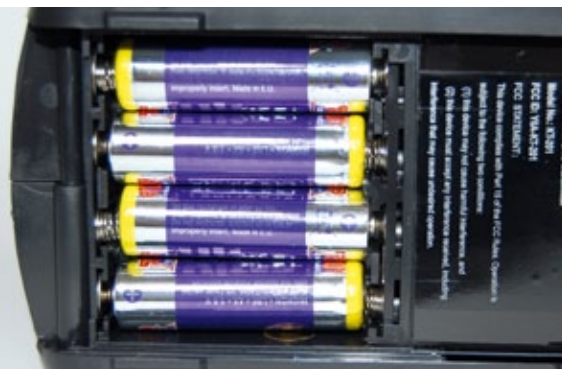
Vier Zellen in AA-Bauweise reichen als Stromversorgung aus
