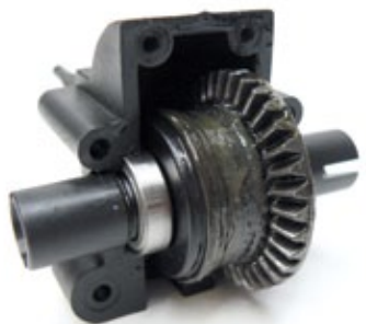
Gerade bei Einsteigermodellen ist ein gut gefettetes Getriebe wichtig
