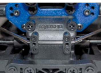
Stabilisatoren an beiden Achsen sind Teil des Race-Spec-Konzepts
