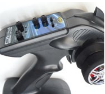
Die beiliegende Fernsteuerung ist in 2,4-Gigahertz-Technik gehalten und ermöglicht die wesentlichsten Einstellungen
