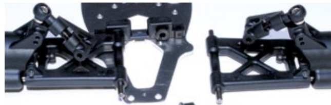
Das Rollcenter der Hinterachse kann sowohl an den unteren als auch den oberen Schwingen mittels Buchsen verändert werden
