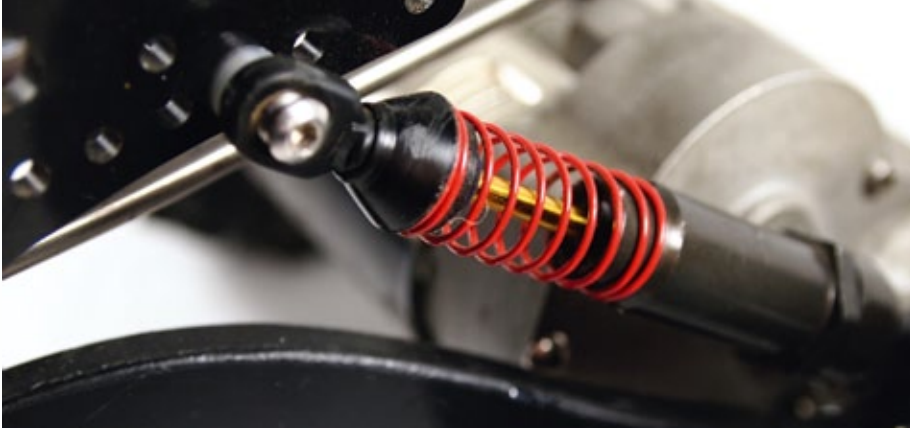
Die filigranen 1:18er-Federn haben genau die richtige Härte
