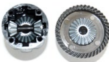
Die Bestückung der Differenziale mit nur zwei kleinen Kegelrädern aus Aluminium ist nicht optimal
