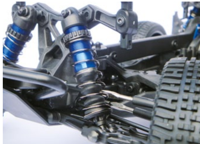
Die Big-Bore-Dämpfer sind dank eines Gummibalgs gegen Dreck geschützt
