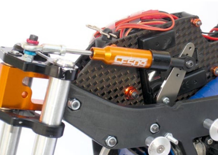
Das kleine DES-Servo verfügt über ausreichend Stell- und Haltekräfte, um über den langen Alustellarm das Bike sicher auf der Ideallinie zu dirigieren
