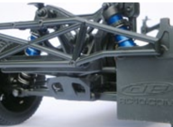
Der große Heckrammer wird mit einigen Schrauben am Chassis fixiert. Er ist sehr robust und gibt bei zu großer Belastung nach
