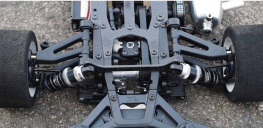
Die Alu-Stoßdämpfer wurden eins zu eins vom NT1 übernommen, was das relativ kleine Ölvolumen erklärt
