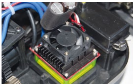
Der Regler des ZRE-1 bietet eine Strombelastbarkeit von 80 Ampere sowie eine aktive und passive Kühlung
