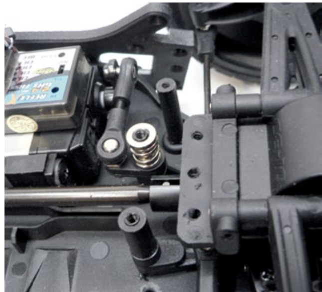
Nach der Demontage der oberen Platte kann man schnell Einstellungen an der Lenkung mit integriertem Servosaver vornehmen
