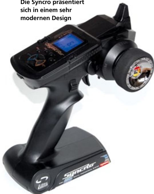
Der Schalter für den dritten Kanal sitzt in Reichweite des Daumens direkt am Handgriff
