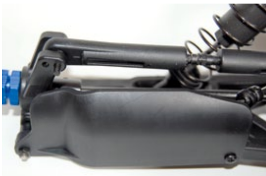
Im Bereich der Hinterachse schützen Mudguards aus Kunststoff die Stoßdämpfer vor Schmutz und Schlamm
