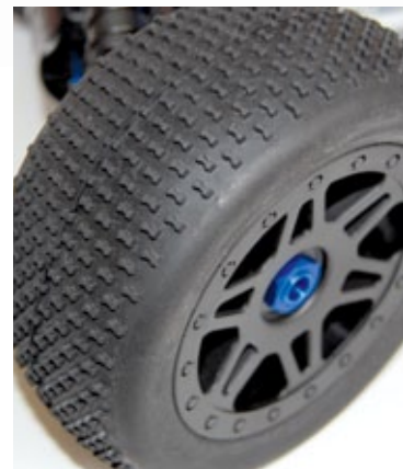
Die recht weichen Pin-Reifen zeigen eindeutig Rennstrecken-optimierte Profile
