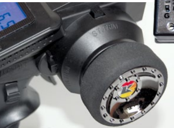
Ein griffiger Moosgummi-Überzug und Trimmerschalter sorgen für Komfort
