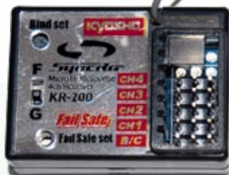
Der KR-200-Empfänger ist von mittlerer Größe und verfügt über eine Failsafe-Funktion
