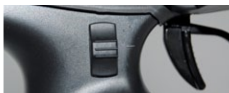
Der Schalter für den dritten Kanal sitzt in Reichweite des Daumens direkt am Handgriff
