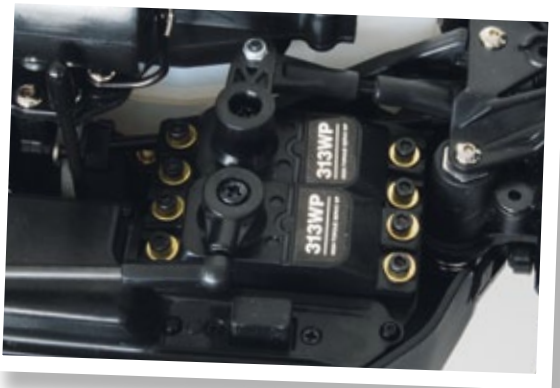
Für die Umsetzung der Lenk- beziehungsweise Gas-Brems-Befehle sind zwei 313WP-High-Torque-Servos zuständig. Beide sind stehend, nebeneinander verbaut
