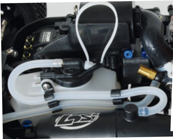
Die 82 Milliliter Nitrosprit, die in den Tank passen, ermöglichen Fahrzeiten von rund zwölf Minuten
