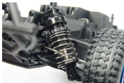
Die großvolumigen, ölfüllten Stoßdämpfer sind in der Höhe verstellbar und leisten gute Arbeit
