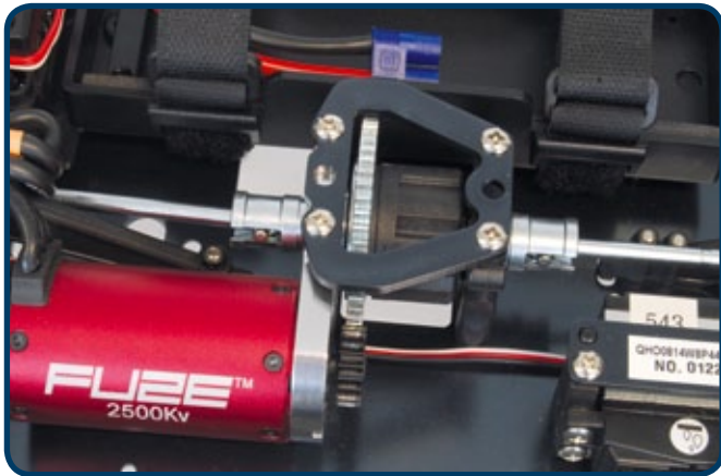
Der Revenge Type E verfügt über drei Differenziale. Die Kraftübertragung zwischen dem Mittel-, den Achsdiffs und den Radachsen übernehmen Knochenwellen
