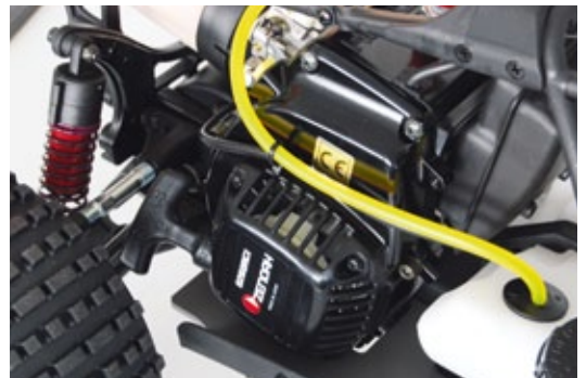
Kettensägen-Feeling inklusive: Einen Zenoah-Benziner startet man stilecht mit dem Seilzug
