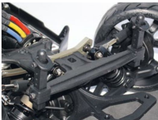
Mit der niedrigen vorderen Dämpferbrücke, an die die einstellbare Karosseriehalterung geschraubt wird, können auch flache GT-Karosserien am GT8 LE zum Einsatz kommen
