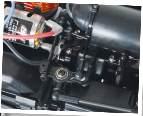
Gas- und Bremse werden über ein Gestänge mit Umlenkhebel betätigt, was naturgemäß mehr Spiel aufweist, als eine direkte Ansteuerung
