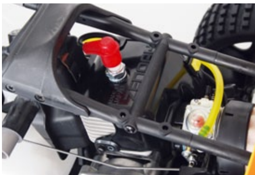
Die Zündkerze wechselt man bei FG durch das Dach
