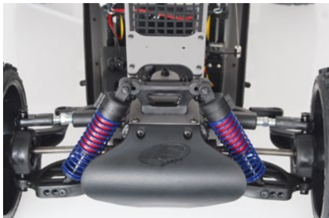
Straffe Waden: Die Federn der überarbeiteten Öldruckstoßdämpfer lassen sich über Kunststoff-Klippe vorspannen
