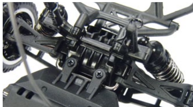
Die Querlenkerhalterungen bestehen aus u-förmig gebogenen Stahlstäben. E-Klipse oder Schrauben entfallen hier
