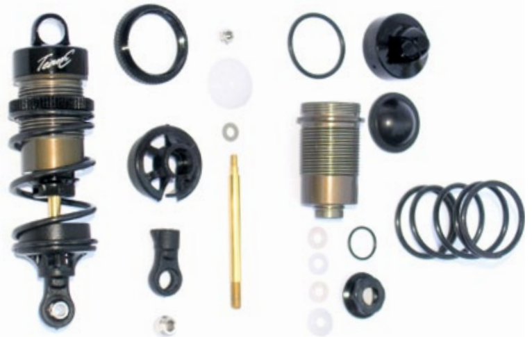
Die Technik der kurzhubigen Big-Bore-Stoßdämpfer gleicht aktuellen Offroad-Dämpfern, lediglich der Kolbenstangenschutz fehlt, weil er im Onroadbereich nicht zwingend benötigt wird
