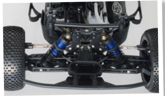
Die Achsen setzen sich aus Doppelquerlenkern, Öldruckstoßdämpfern und Stabilisatoren zusammen
