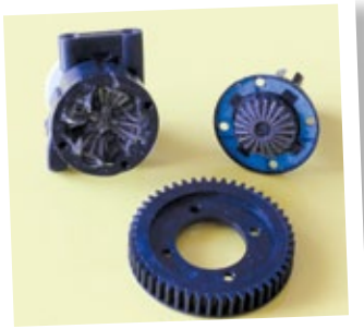
Die Differenziale sind in Vierspider-Bauweise erstellt und ab Werk ausgezeichnet geschmiert
