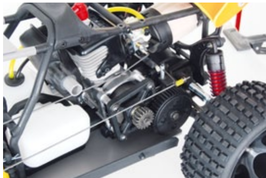
Das Stahlritzel der Kupplung überträgt die Motorkraft auf das Hauptzahnrad aus Kunststoff
