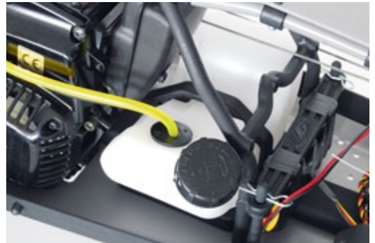
Schwerpunktünstig befindet sich der Tank in der Chassismitte. So beeinflusst die Spritmenge nicht das Fahrverhalten
