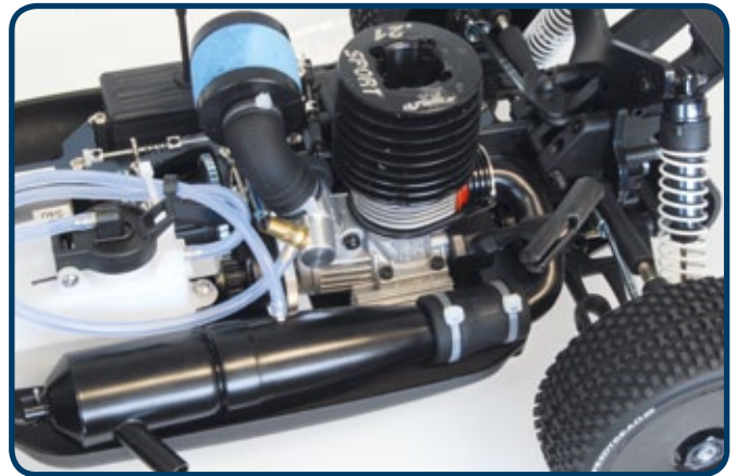
Der .21er-Mach 2 Sport-Nitro-Motor mit 3,5-Kubikzentimeter-Hubraum sorgt für Vortrieb. Krümmer und Reso sind bereits werkseitig mit dem Aggregat verbunden
