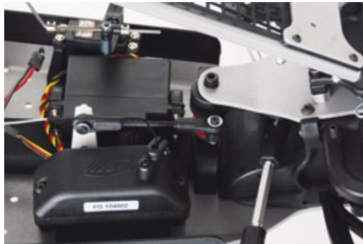
Das liegend verbaut Lenkservo im Jumbo-Format überträgt seine Kraft über einen Servosaver an die Vorderräder
