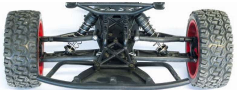
Die Vorderachse basiert auf einer Konstruktion aus Doppelquerlenkern und Öldruckstoßdämpfern
