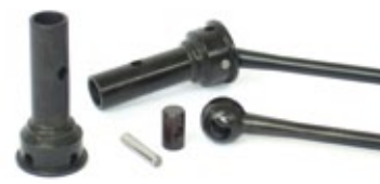
Sämtliche Antriebswellen enden in leichtgängigen CVD-Antriebsachsen
