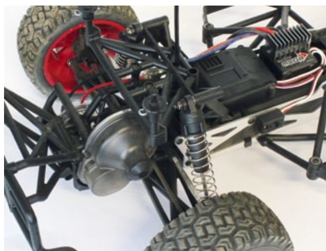
Typisch für ein 2WD-Modell ist die Antriebseinheit beim Fury an der Hinterachse platziert
