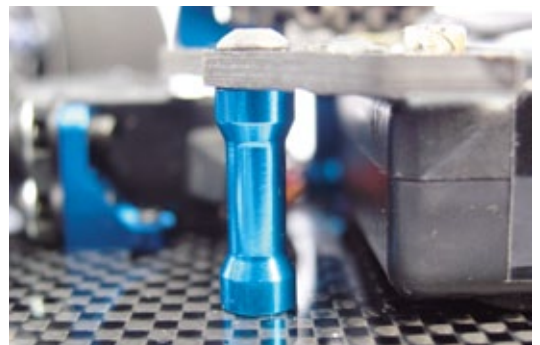
Das notwendige, kleine Topdeck ruht auf drei gewichtsoptimierten Aluminiumpfosten. Hierfür benötigt man aber noch extra 6 Millimeter kurze M3-Schrauben als Zubehör
