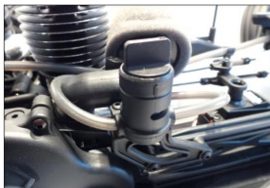
Aufwändiges Bauteil mit guter Wirkung: Über den Motorabsteller wird lediglich der Silikonschlauch gequetscht
