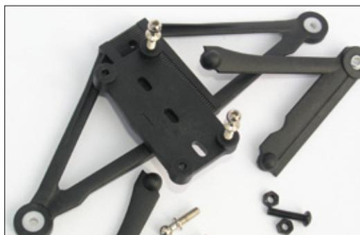
Über eine verzahnte Trägerplatte der oberen Schwingenaufnahme kann der Nachlauf der Vorderachse nach Lösen einiger Schrauben je nach gewünschter Lenkagilität verändert werden
