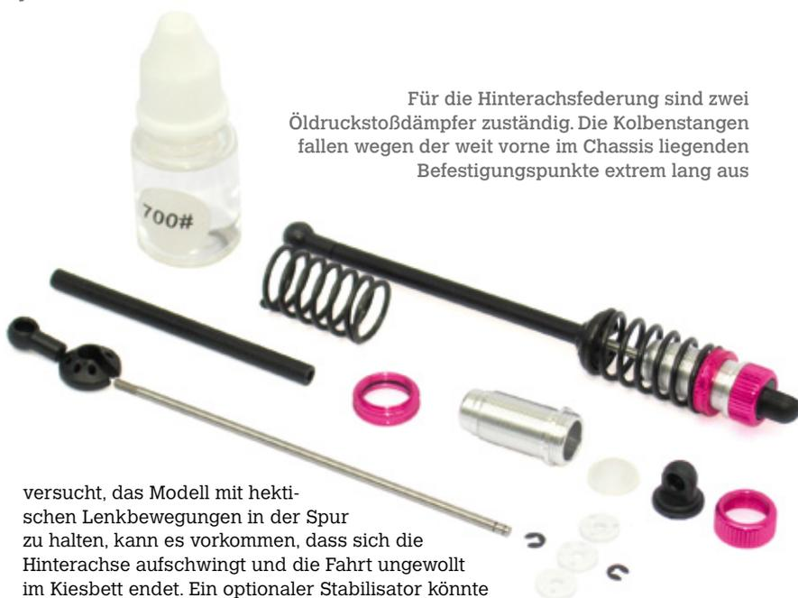
Für die Hinterachsfederung sind zwei Öldruckstoßdämpfer zuständig. Die Kolbenstangen fallen wegen der weit vorne im Chassis liegenden Befestigungspunkte extrem lang aus
