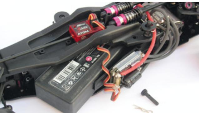
Akkuwechsel leicht gemacht: Entfernt man einen Splint sowie den damit gesicherten Bolzen, können die seitliche Fahrregleraufnahme herausgeklappt und der Akku eingesetzt werden. Für den rauen Rennalltag sollte man der Akku zusätzlich mit einem Stück Klebeband auf dem Chassis fixieren
