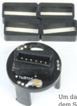
Um das Timing des Motors zu verändern, liegen dem Set vier weitere Timing-Einsätze bei
