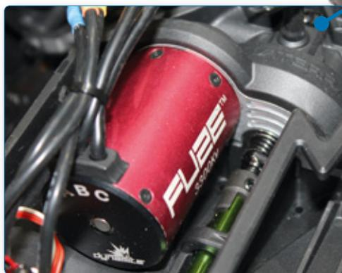
Der Dynamite Fuze-Brushlessmotor mit 3.300 Umdrehungen pro Minute und Volt ist serienmäßig eingebaut und überträgt die Kraft auf eine zentrale Antriebswelle
