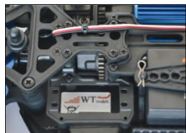
Der Werewolf ist für den Einbau einer optionalen mechanischen Scheibenbremse vorbereitet. Die Halterung für das erforderliche Bremsenservo ist vorhanden
