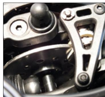
Gut versteckt zwischen Slipperkupplung und Hinterachsdifferenzial findet sich die Bremse
