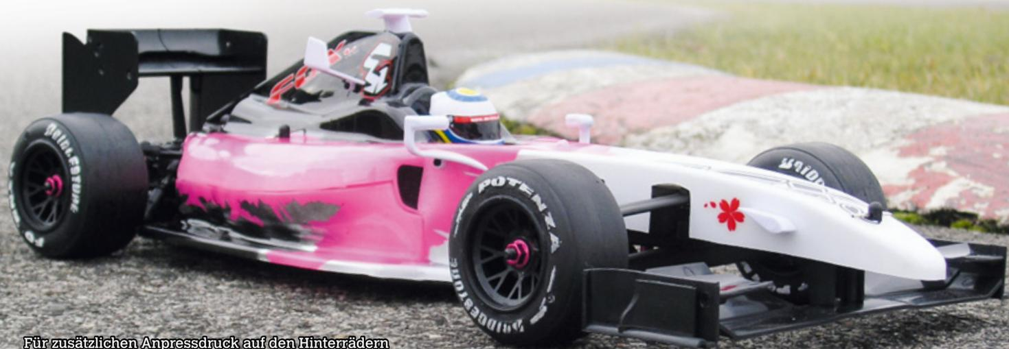
Für zusätzlichen Anpressdruck auf den Hinterrädern sorgt der einstellbare obere Flügel am Heckspoiler
