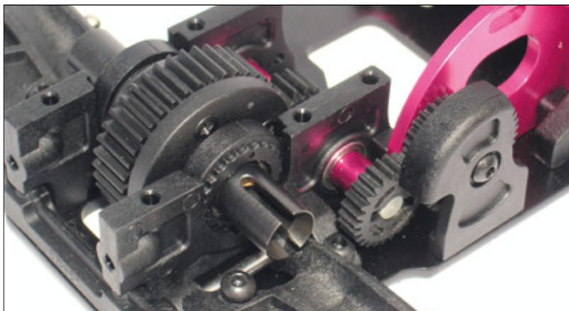
Zahn um Zahn: Die Einzelradaufhängung und damit die zentrale Lage des Differenzials sowie des Motors macht ein zusätzliches Zwischengetriebe unumgänglich
