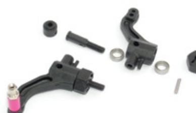
Anstatt der üblichen Kugellager in den Felgen verbaut 3Racing an ihrem FGX die Kugellager bereits in den Lenkhebeln
