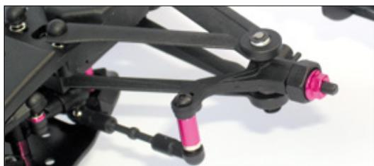
Eine tiefe Anlenkposition der Vorderräder unterhalb der verwindungssteifen unteren Vorderachsträger erfordert eine zusätzliche Verlängerung der Anlenkpunkte an den Lenkhebeln
