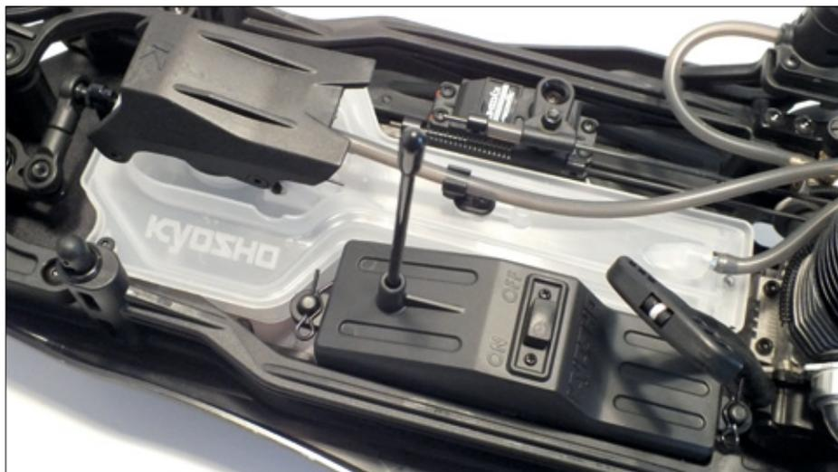
Der Tank wurde so konstruiert, dass RC-Box und Gas-Brems-Servo ausreichend Platz haben aber trotzdem noch möglichst viel Sprit bevorratet werden kann
