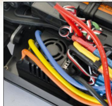
Für einen Dauerstrom von 80 Ampere ist der Brushless-Regler ausgelegt. Er ist programmierbar, verfügt über ein BEC und ist ab Werk mit einem Y-Kabel versehen
