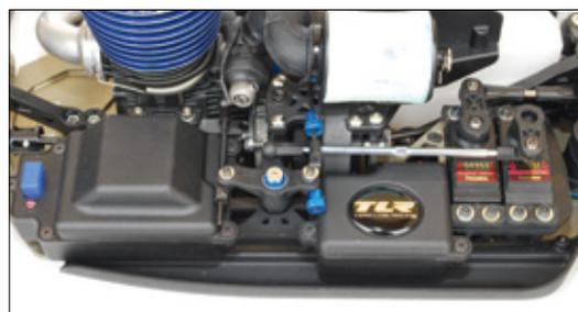
Die sogenannte Generation III-Radioplate wird durch die außergewöhnliche Anordnung der beiden Servos geprägt. Der Ein- und Ausbau der kompletten Einheit erfordert weniger als eine Minute
