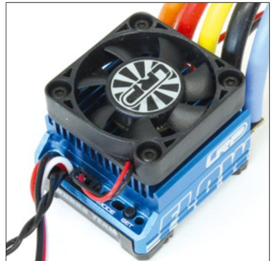
Dem Regler liegt ein Kühlventilator bei, der seinen Strom vom Controller bezieht
