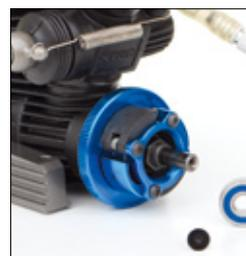
TLR spendiert seinem Racing-Chassis eine Kupplung mit vier Backen; zwei aus Aluminium und zwei aus Composite Material einschließlich unterschiedlicher Federhärten
