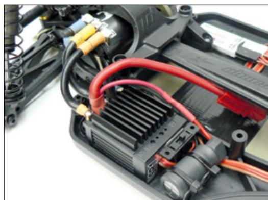
Bei der Montage des Sets lassen sich sehr kurze Kabelwege realisieren
