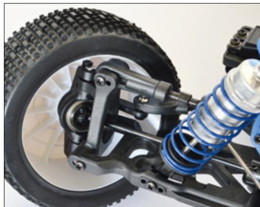
Nicht nur, dass das Low-Budget-Modell mit serienmäßigen Stabis ausgerüstet ist, an der Vorderachse kommen sogar CVD-Wellen zum Einsatz. Genoppte Buggyreifen auf weißen Dishfelgen sorgen für gute Bodenhaftung und ordentlich Vortrieb.
