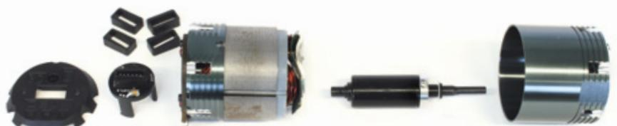
Vier Schrauben müssen gelöst werden, dann lässt sich der Motor zu Wartungszwecken in seine Einzelteile zerlegen
