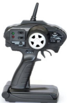
Dem Set liegt ein funktionaler Dreikanal-Sender bei, der mit 2,4-Gigahertz-Technik arbeitet
