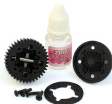
Die Kraftverteilung zwischen den angetriebenen Hinterrädern erfolgt über ein klassisches Vierspider-Differential.
