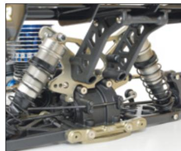
Das so genannte Lower Roll Center-System – kurz LRC – ermöglicht unterschiedliche Vorspur- und Anti-Squat-Einstellungen mittels exzentrischer Kunststoffeinsätze
