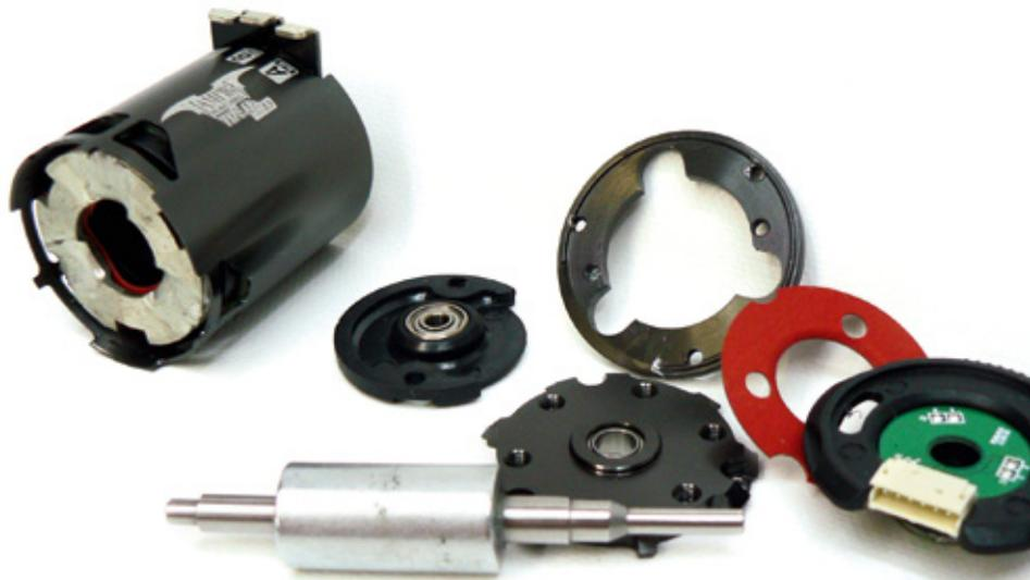
Der Motor lässt sich für Wartungszwecke komplett demontieren und überzeugt mit einer sauberen und aufwändigen Konstruktion. Da viele Teile aus Aluminium bestehen, ist zusammen mit den Kühlöffnungen eine sehr gute Wärmeableitung gegeben
