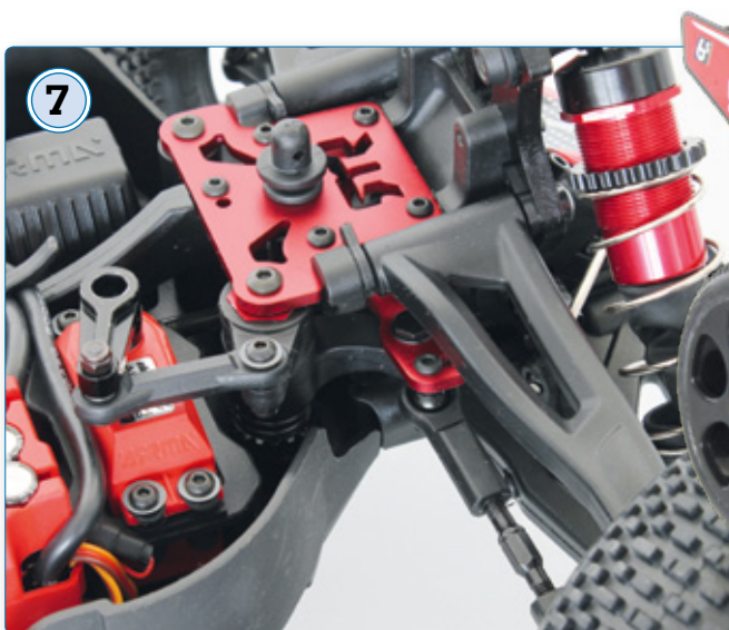
Aluminium kommt nur an den wirklich wichtigen Stellen zum Einsatz. Ein Servo-Saver darf natürlich nicht fehlen
