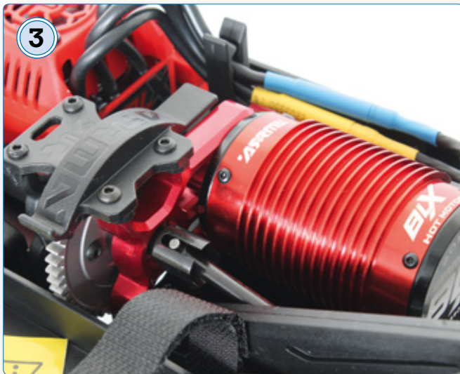
Der BLX-Brushlessmotor mit 2.050 Umdrehungen pro Minute und Volt sitzt an einem dicken Alu-Träger
