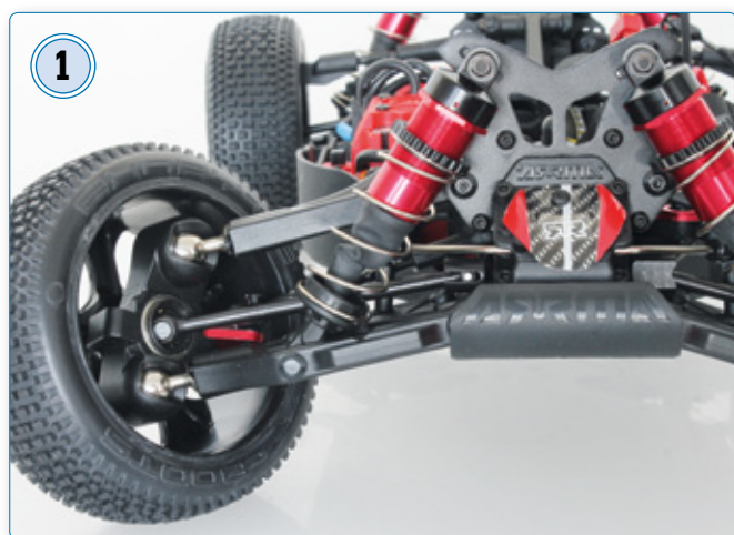
1 Pivot-Ball-Aufhängungen, CVD-Wellen, Öldruckstoßdämpfer – der Typhoon 6S hat ein echtes Rennfahrwerk
