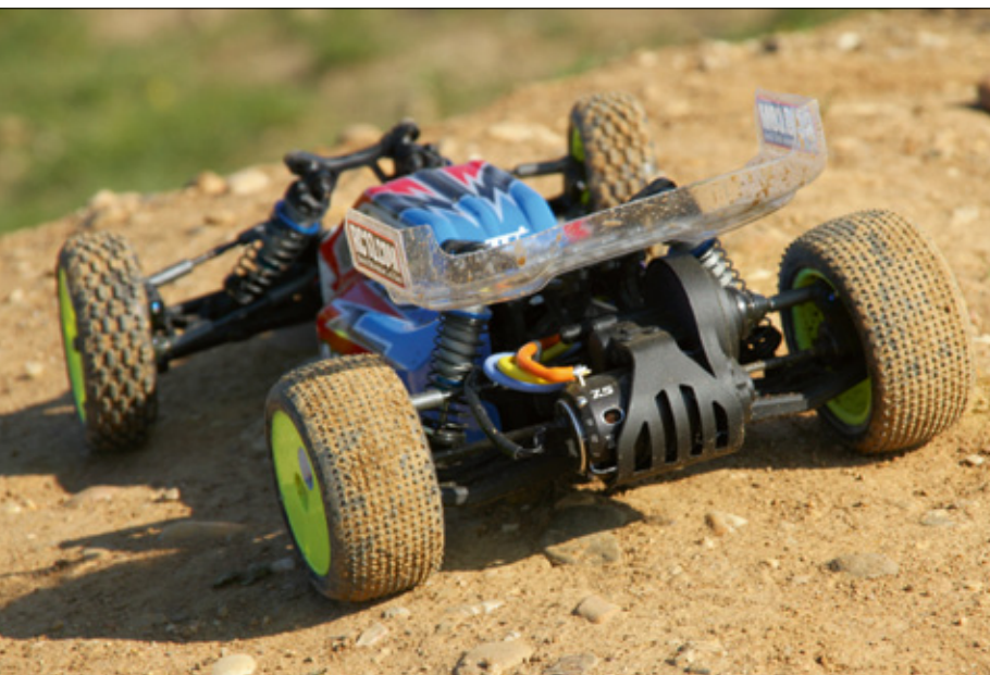
Der Motor des B5 ragt weit über die Hinterachse hinaus
