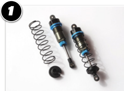
Federteller und Feder entfernen
