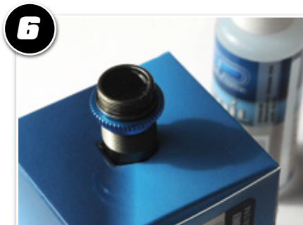
Dämpfer senkrecht einige Minuten ruhen lassen - so kommt auch die kleinste noch im Öl befindliche Luftblase an die Oberfläche. (Hier wurde aus einer Akkusachtel schnell mit einer Schere ein Dämpferhalter gebastelt)
