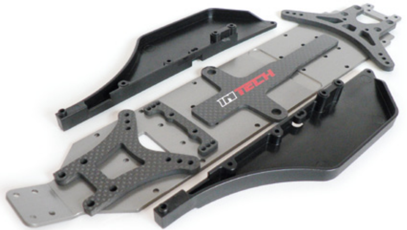
Der Materialmix aus faserverstärktem Kunststoff, Kohlefaser und hochfestem Alu ergibt eine verwindungssteife Buggy-Plattform. Die CFK-Teile sind allesamt sehr sauber gefertigt und selbst die Aluteile sind nicht wie sonst üblich ausgestanzt, sondern ebenfalls gefräst
