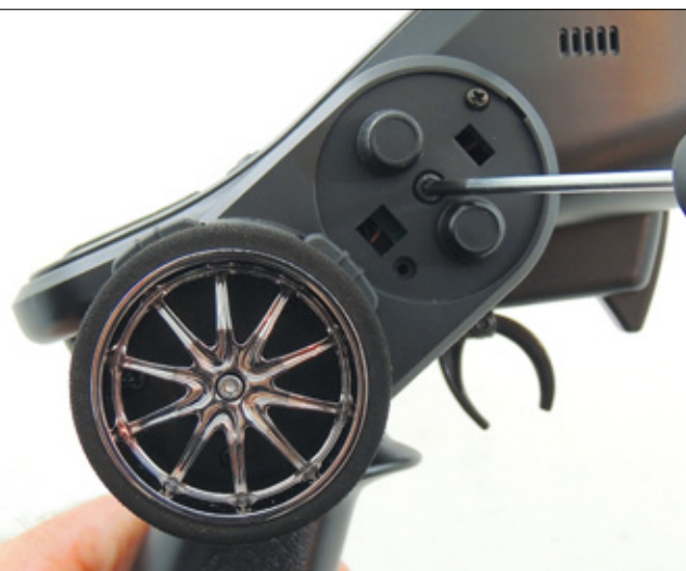
Die Neigung des Steuerrads, zum Fahrer – vom Fahrer weg, kann ebenfalls eingestellt werden
