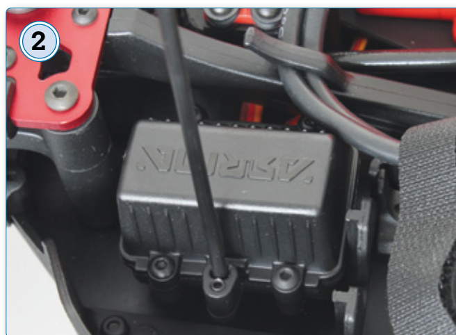
2 Die RC-Box ist wirklich winzig. Der enthaltene Empfänger des RTR-Pakets empfängt Signale im 2,4-Gigahertz-Band
