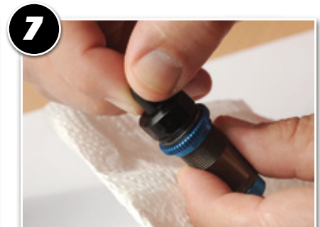
Die Kolbenstange ganz einschieben und dann die Dämpferkappe wieder aufschrauben - das überschüssige Öl entweicht durch die Bohrung in der Kappe.
