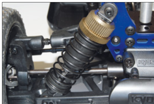
Auch der Neo 2.0 verfügt über einstellbare Bigbore-Stoßdämpfer, in seinem Fall aus Kunststoff
