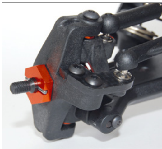
An der Vorderachse prägen die C-Hub-Lenkung und Sechskantmitnehmer aus Aluminium das Bild
