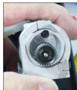
Der Motor sitzt in einer exzentrischen Halterung, über die man mühelos das Ritzelspiel einstellen kann. Zwei Schrauben lösen, Motor passend drehen, Schrauben festziehen und fertig
