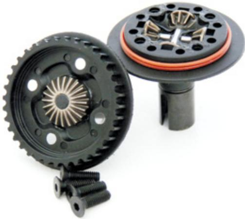
Eine willkommene Neuerung stellt das sehr schmal bauende Kegelraddifferential des Cougar KF dar. Entgegen erster Befürchtungen sorgten die beiden Dichtungsringe für eine sehr gute Abdichtung. Dies ist in der Nähe des Riemens besonders wichtig, da sich dieser im Laufe der Zeit durch Öl zersetzen kann
