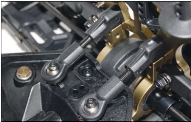
Im Bereich der Vorderachse sitzen zwei kurze Chassisstreben. Sie beugen übermäßigem Durchbiegen wirkungsvoll vor
