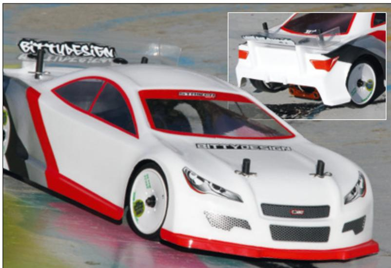
Die Striker SR liegt im Fahrverhalten zwischen den beiden anderen Karossen. Deutlich zu sehen: Zur Montage der Striker auf den XRAY mit langen Radstand passt der hintere Radkasten nicht
