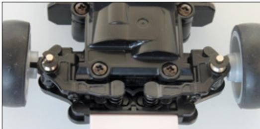
An der Vorderachse sind die Räder einzeln aufgehängt. Die Achse selber basiert auf Doppelquerlenkern und Federn
