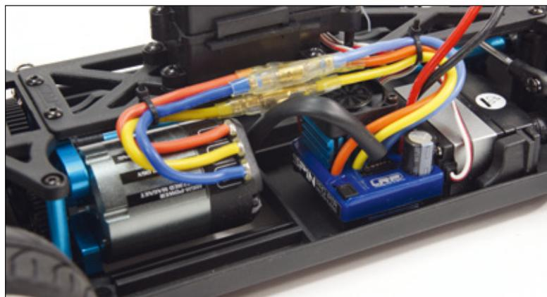
Beim LRP Vector K7-Brushlessmotor setzt LRP auf Sensortechnik für ein sanftes Anfahren und weit gefächerten Drehzahlbereich
