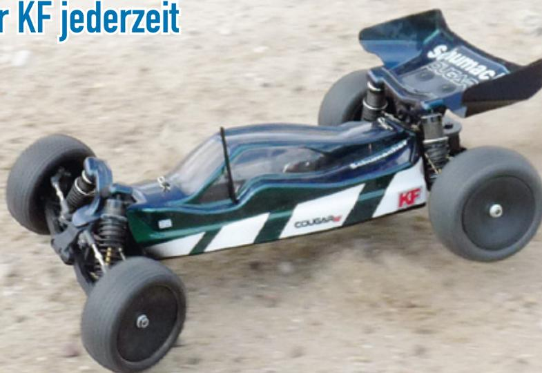
Der Cougar KF besteht im Wesentlichen aus der Vorderachse des 2WD-Buggys Cougar und der Hinterachse der SX 4WD-Buggys. Diese Kombination sorgt für eine sehr gute Gewichtsverteilung und eine gute Erreichbarkeit der Elektronik
