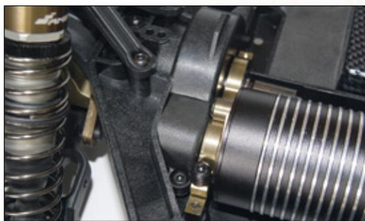
Per Kapselung werden Motorritzel und Hauptzahnrad vor eindringenden Steinen bewahrt. Im Gegensatz zu der kleineren, unteren Hälfte ist der größere Oberteil der Abdeckung fest ins Chassis integriert und lässt sich nicht abnehmen. Das erschwert die Justierung des Zahnflankenspiels
