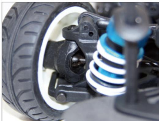
Die Vorderräder werden von CVD-Wellen angetrieben. Hinten kommen Knochen zum Einsatz
