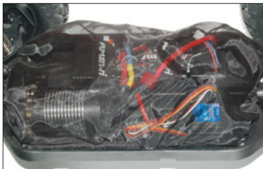
Ein engmaschiges Schutznetz hält Schmutz von den Komponenten auf der Chassis-Oberseite fern
