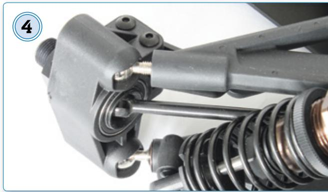
Pivot-Ball-Aufhängungen, CVD-Wellen und jede Menge Kugellager gehören bei einem solchen Modell zum guten Ton
