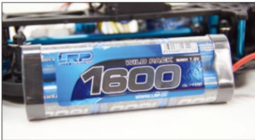
Bei der Bürstenvariante liegt dem Fahrzeug ein Nickelmetallhydrid-Energieriegel mit 7,2 Volt und 1.600 Milliamperestunden bei
