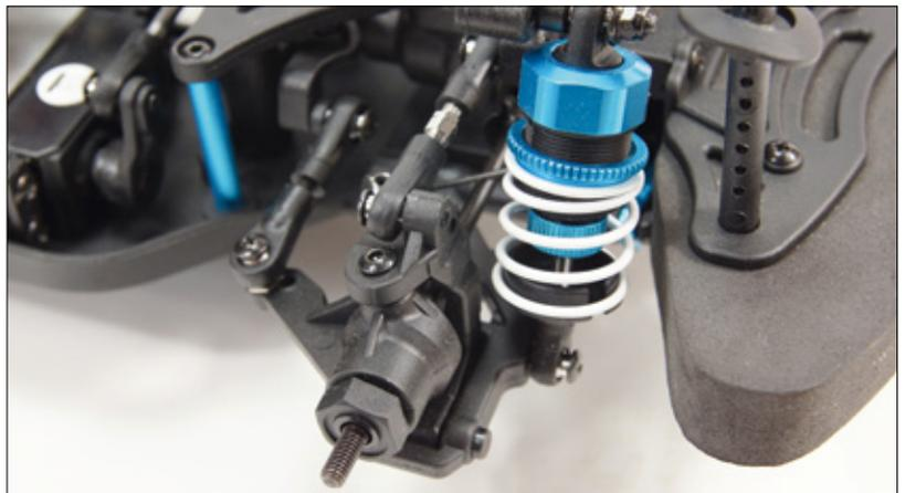
Rechts-links-Gewindestangen gehören ebenso zum guten Ton, wie die Öldruckstoßdämpfer an beiden Achsen
