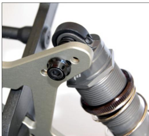
Verschiedene Befestigungspunkte an den Dämpferbrücken und Gewinde auf den Dämpfergehäusen gehören zum Setup der Stoßdämpfer
