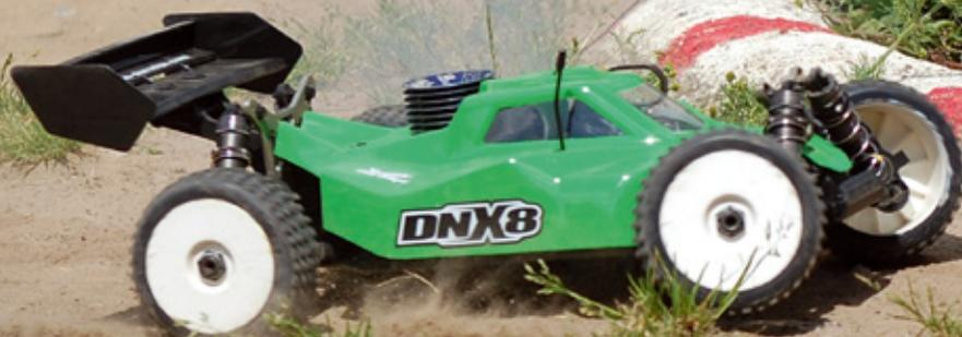
Das recht niedrige Gripniveau der Rennstrecke sorgte beim Beschleunigen für leicht durchdrehende Hinterräder. Als Reaktion darauf wurde das werkseitig einzufüllende 7.000er-Silikonöl im Mitteldiff gegen 4.000er ausgetauscht. Dadurch wurde bei Gasstößen mehr Kraft zu den Vorderrädern geleitet und das Heck damit stabilisiert
