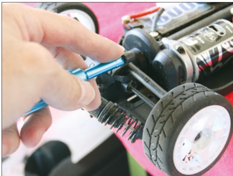
Um die Dämpfer hinten anders zu positionieren, muss man mit zwei Schrauben den Karosseriehalter entfernen
