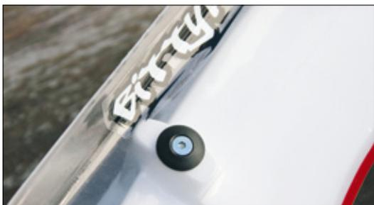
Gut gelöst: Schrauben und Unterlegscheiben zur Befestigung des Heckspoilers liegen der Karosse bei
