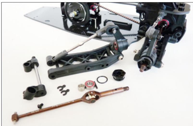
Hochwertige Materialien, dicke Kunststoffteile und eine sinnvolle Ausstattung wie die rundum genutzten gummidichteten Kugellager prägen nicht nur die Hinterachse des Cougar KF. Die Querlenker werden an allen vier Ecken mit je zwei Schrauben samt Halterung am Chassis befestigt – Antisquat oder Spureinstellungen inklusive
