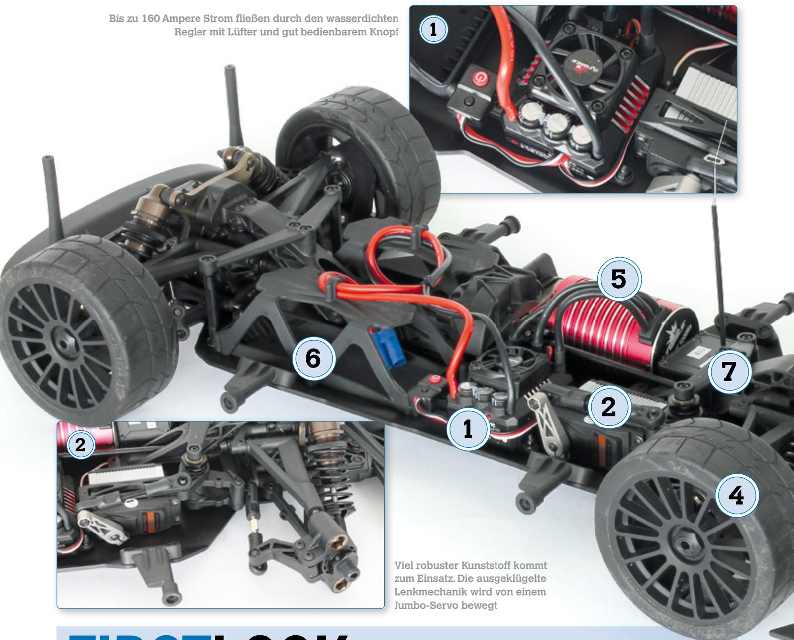
Viel robuster Kunststoff kommt zum Einsatz. Die ausgeklügelte Lenkmechanik wird von einem Jumbo-Servo bewegt
