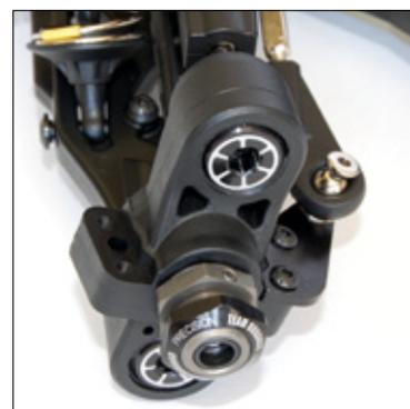
Bei der Lenkung hat sich Team Durango für eine konventionelle Pivotball-Konstruktion entschieden. Per Inbusschlüssel lassen sich Justierungen vornehmen
