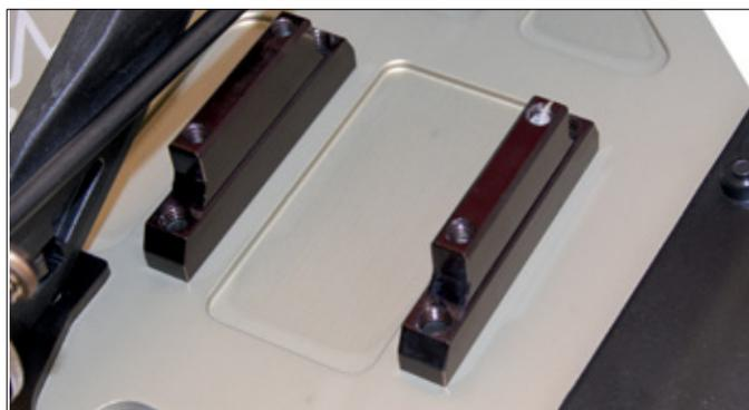
Die zwei Teile des Motorhalters werden fest auf der Chassisplatte verschraubt und lassen sich nicht verschieben. Um unterschiedlich breite Motorengehäuse aufnehmen zu können, sind die Halter so konstruiert, dass sich der Abstand zueinander durch Umdrehen anpassen lässt
