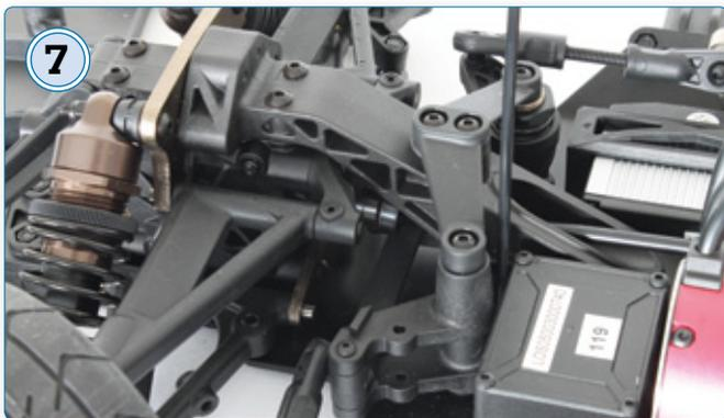
Dichtes Gedränge im vorderen Achsbereich. Viele Verstärkungen, Verstrebungen und Abstützungen sorgen für eine äußerst verwindungssteife Konstruktion
