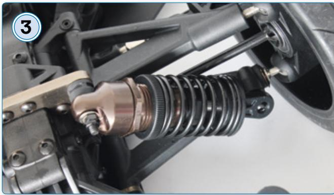
Um den Schwerpunkt möglichst niedrig zu halten, sind die Aluminium-Öldruckstoßdämpfer im flachen Winkel montiert
