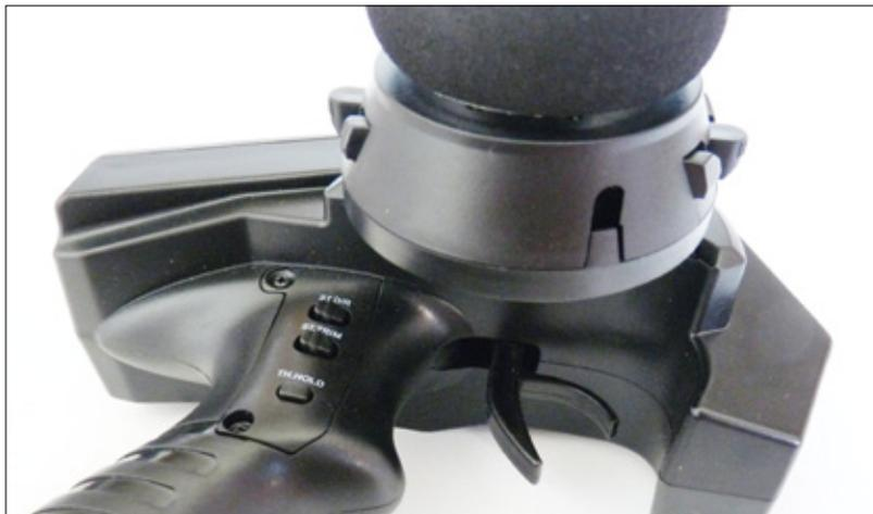
Nitro-Fahrer werden sich über den einstellbaren und via Knopfdruck anwählbaren Gaspunkt freuen. Die anderen, ebenfalls hilfreichen Schalter und Taster sind gut mit dem Daumen erreichbar
