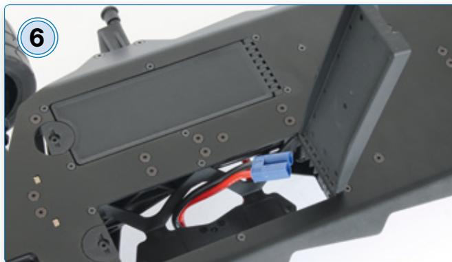
Da die Karosserie über acht Schrauben mit dem Chassis verbunden ist, werden die Akkus von unten eingelegt
