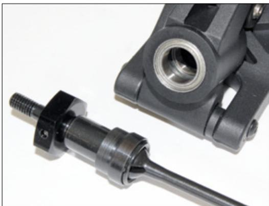
Ebenso wie die Öldruckstoßdämpfer, wurden zentrale Teile der Aufhängung aus Aluminium gefertigt. Das bringt die nötige Stabilität im harten Offroad-Alltag
