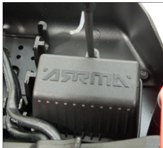
Der Empfänger versteckt sich in einer kleinen wasserdichten RC-Box
