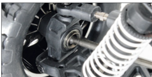
An beiden Achsen kommen CVD-Wellen zum Einsatz
