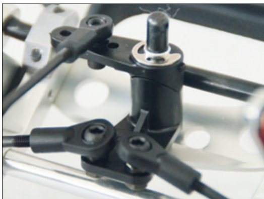
Der Servosaver ist ein potentieller Schwachpunkt des Modells. Bei stärkeren Kollisionen kann sich der Sprengring lösen, was massiven Einfluss auf die Steuerbarkeit des Modells hat
