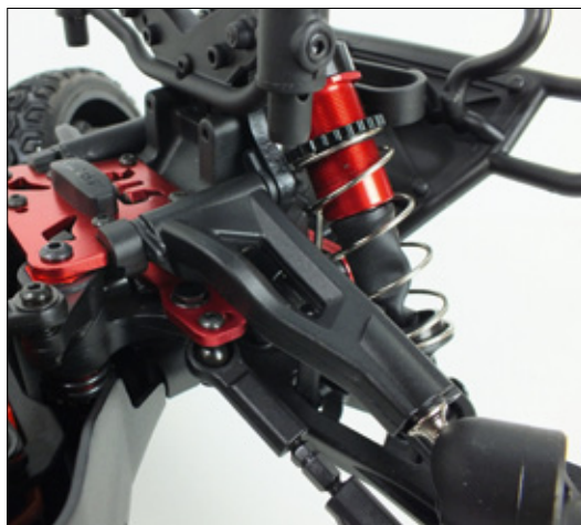
An der Vorderachse sind ebenfalls stabil wirkende Querlenker verbaut
