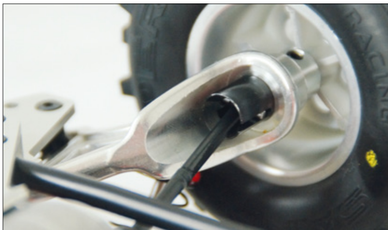
Der Antrieb des Tomahawk erfolgt über gewöhnliche Antriebsknochen aus Stahl
