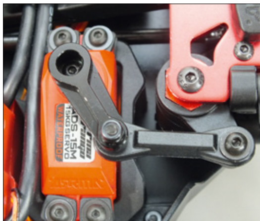
Lenkbefehle werden Dank des wasserdichten 15-Kilogramm-Servos gut umgesetzt. Ein einstellbarer Servosaver soll das Metallgetriebe schützen
