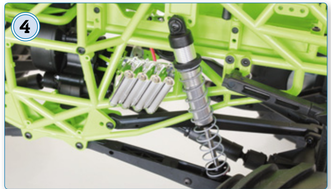
4 Bei einem Monstertruck kommt es auf die Länge an – zumindest, wenn es um die Aluminium Gewinde-Öldruckdämpfer geht. Schließlich muss das Fahrwerk ordentlich arbeiten
