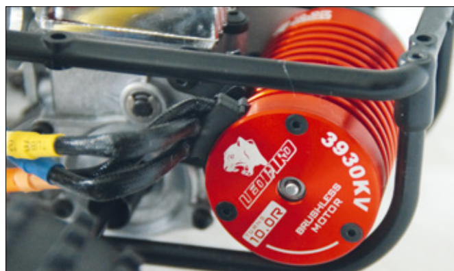
Der Leopard-Motor mit 3.930 kv erzeugt mächtig Vortrieb und schiebt den Tomahawk in jeder Lage an sein Limit
