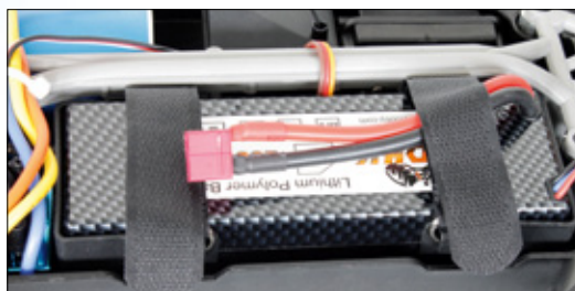
Ein 2s-Fahrakku mit einer Kapazität von 2.300 Milliamperestunden gehört zum Lieferumfang des Modells
