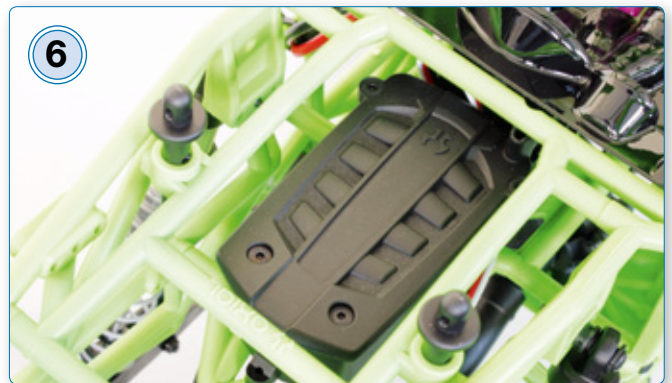
6 Wo beim Original der Motor sitzt, befindet sich im Modell die verschraubte RC-Box
