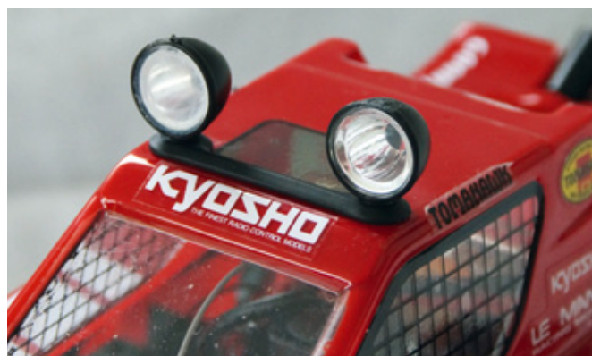
Die beiden Dachlampen sind zwar stilecht, können bei Überschlägen jedoch auch schnell abbrechen
