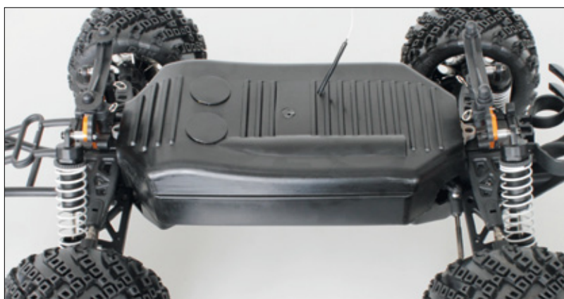
Ein besonderes Highlight ist der massive Staubschutzdeckel, der unter der Karosserie platziert ist – und er funktioniert
