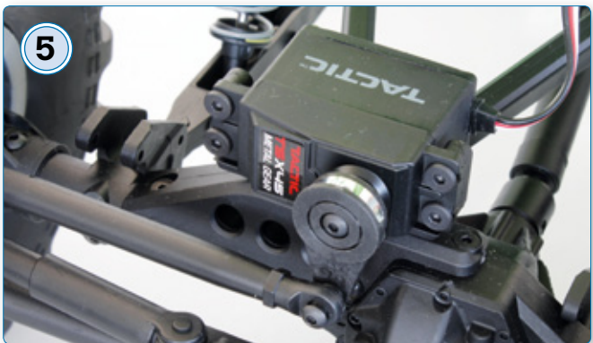
5 Ein schnelles und stellstarkes Metallgetriebeservo inklusive Servosaver garantiert ein gutes Handling des Grave Digger
