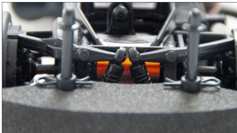
Die F1-Style-Cantilever-Frontdämpfer arbeiten sehr sauber und sind entsprechend hart abgestimmt
