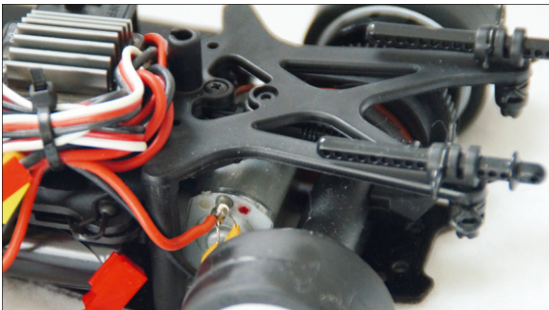
Die verstellbaren Karosseriehalter erlauben auch die Verwendung anderer Karosserien
