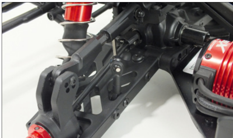
Großdimensionierte Achsaufhängungsteile sorgen für Haltbarkeit. Einstellbare Querlenker und Stabilisator helfen, das optimale Setup zu finden
