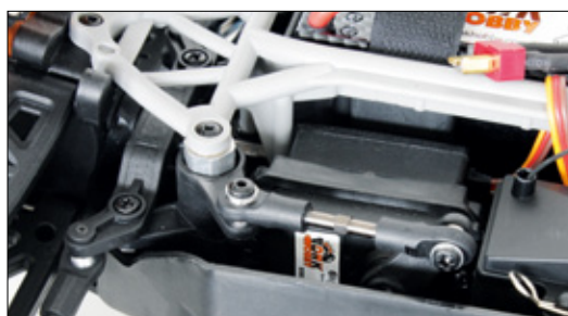
Das Lenkservo verfügt über ein Kunststoffgetriebe und wartet mit einer Stellkraft von 6 Kilogramm auf
