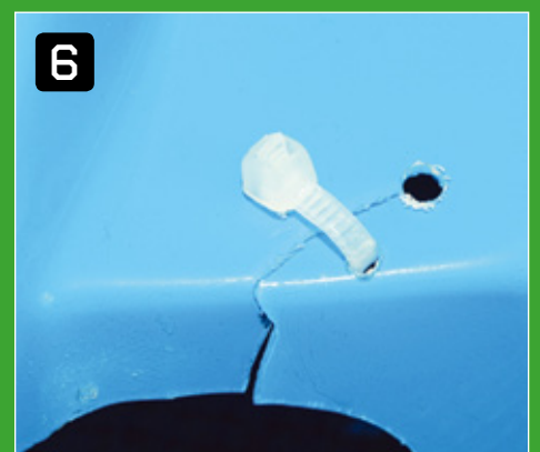
Durch die zwei Löcher wird jetzt ein dünner Kabelbinder geschoben und leicht (!) festgezogen. Er nimmt die Belastung von der Risskante und dient ebenfalls dazu, ein Fortlaufen des Risses zu verhindern oder zumindest zu verlangsamen
