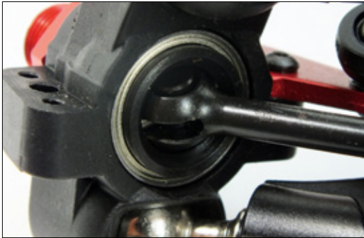
An der Vorderachse arbeiten CVD-Wellen aus Stahl
