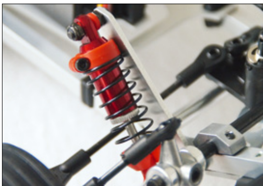
Die Wirkungsweise der Öldruckstoßdämpfer wurde komischerweise mit jeder Ausfahrt besser. Sie helfen die Leistung des Buggys auch in unebenem Gelände kontrolliert auf den Boden zu bringen
