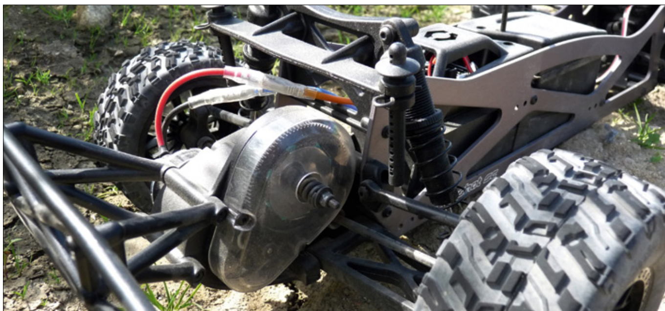
Trotz der recht großen Öffnung im Getriebe­schutz dringt auch bei sandigem Untergrund recht wenig Schmutz zum Getriebe vor. Zur Not kann dieses aber sehr schnell herausgeschüttelt werden
