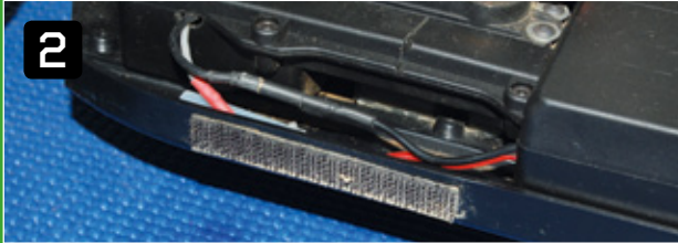
Im ersten Schritt ist jeweils ein Streifen Klettband an den Seitenwannen zu befestigen
