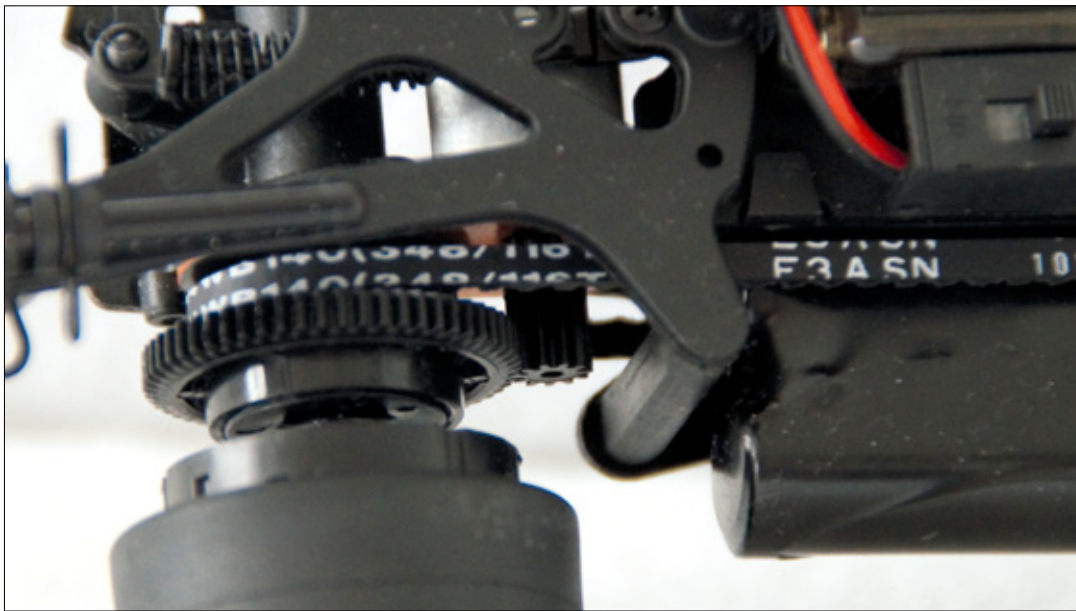
Die Kraftübertragung erfolgt über ein Plastikmotorritzel – Metall wäre hier gerade im Hinblick auf Tuning-Maßnahmen besser gewesen
