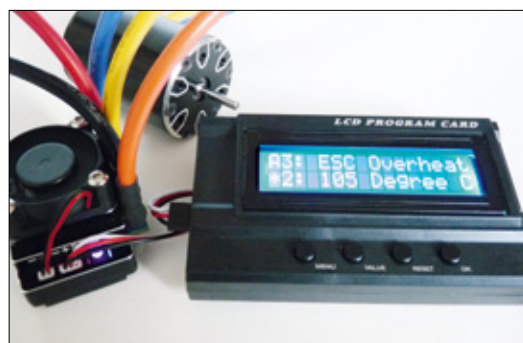
Die optionale Programmierbox ist unbedingt notwendig, wenn man sich alle Parameter dieses universell einstellbaren Reglers nutzbar machen möchte. Neben der Einstellbarkeit aller Daten lassen sich diese ebenfalls am PC verändern sowie Firmwareupdates einspielen
