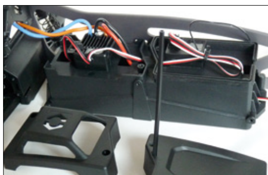
Der Empfänger ist gut geschützt in einer spritzwasserdichten Box untergebracht
