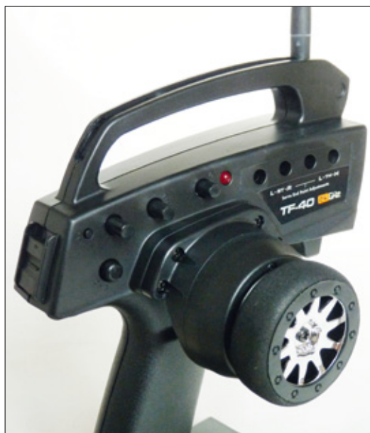
Einige weniger oft benötigte Einstellungen verbergen vertieft sich im Sendergehäuse, die wesentlichen Dinge sind jedoch sofort erreichbar und lassen sich auch rasch beim Fahren einstellen. Das griffige Lenkrad liegt zudem mit 50,6 Millimetern Durchmesser angenehm in der Hand
