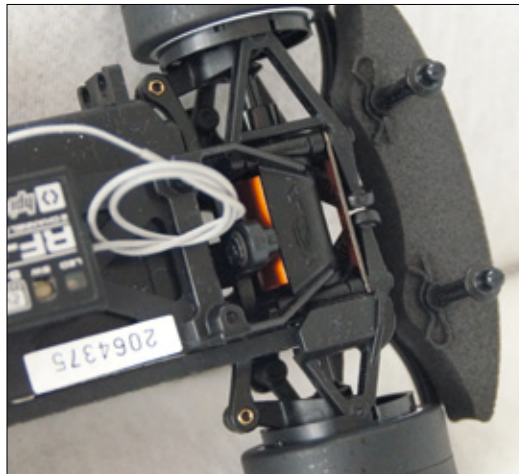
Die beiden Differenziale befinden sich in orange-eloxierte Aluminiumhülsen. Sieht cool aus und ist sehr langlebig
