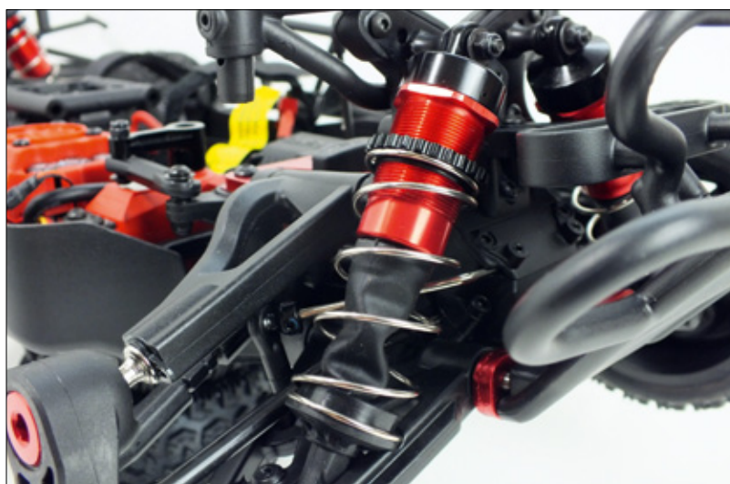
Big-Bore-Stoßdämpfer aus Aluminium sollen Unebenheiten ausgleichen. Mit Hilfe von Gummimanschetten werden die Kolbenstangen und Dichtringe gut vor Verschleiß geschützt
