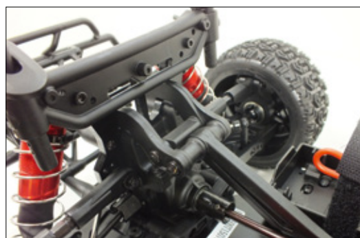
Anstelle einer Heckspoilerhalterung verfügt der Senton über höhenverstellbare Karosteher
