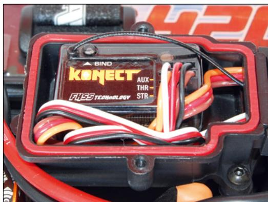
Gegen Staub und Schmutz geschützt, sitzt der Empfänger in einer separaten Box. Ein Dichtring aus Gummi hält zusätzlich Spritzwasser fern
