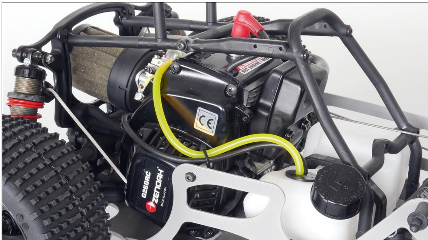
Der 26-Kubikzentimeter-Zenoah-Motor überzeugt durch gutes Laufverhalten, ist jedoch mit dem Standard-Auspuff etwas laut
