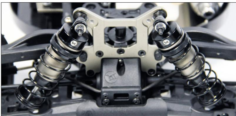
Die Dämpfer sind über eine Alu-Rändelmutter stufenlos einstellbar und ab Werk gut mit Öl befüllt. Befestigt sind diese an 4 Millimeter starken, aus Alu gefrästen Dämpferbrücken, die an der Vorderachse über drei verschiedene Bohrungen für die Dämpferaufnahme verfügen
