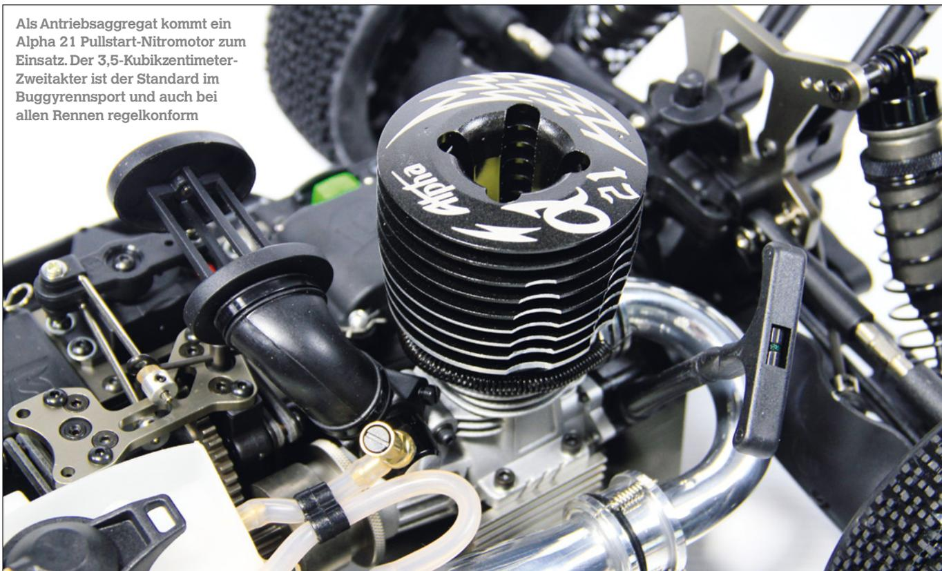
Als Antriebsaggregat kommt ein Alpha 21 Pullstart-Nitromotor zum Einsatz. Der 3,5-Kubikzentimeter-Zweitakter ist der Standard im Buggyrennsport und auch bei allen Rennen regelkonform
