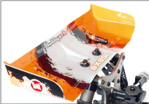
**Per Lexanspoiler wird aerodynamischer Anpressdruck auf die Hinterachse generiert**
