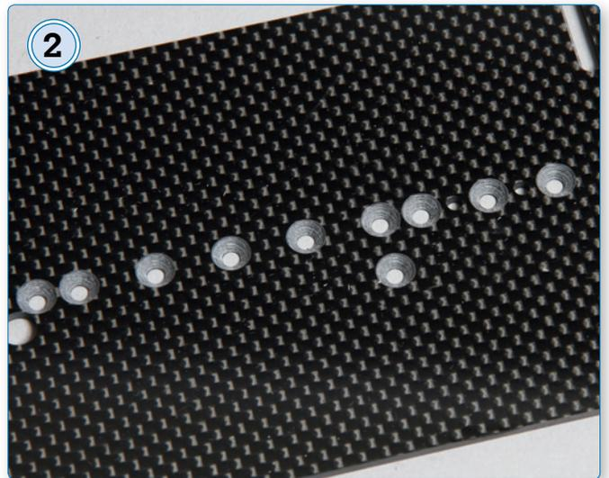
2 Die Chassisplatte ähnelt einem Schweizer Käse. Die zusätzlichen Bohrungen bieten mehr Flex-Optionen am Motorhalter
