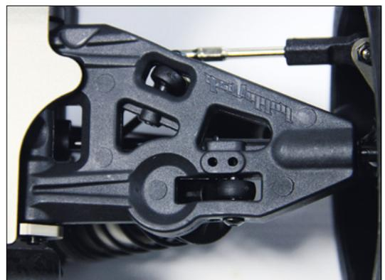
Die vorderen Doppel-Querlenker sind schön massiv und leicht elastisch. Hier gibt es nur zwei Befestigungspunkte für die Dämpfer und ein Stabilisator ist ebenso verbaut
