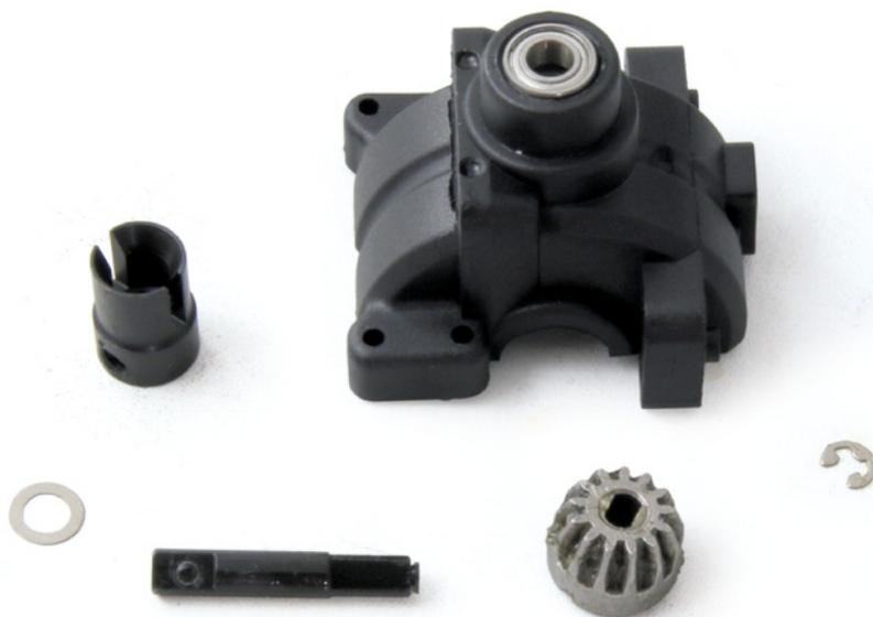
Ein Getriebegehäuse mit Antrieb ist hier zerlegt. Positiv ist die Kugellagerung
