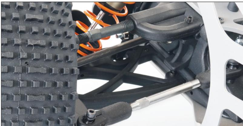
Das Fahrwerk erlaubt das Einstellen verschiedener Parameter über Rechts-links-Gewindestangen
