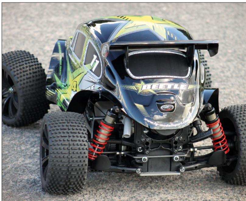
Die Abgase werden über das graue Rohr nach hinten abgeleitet
