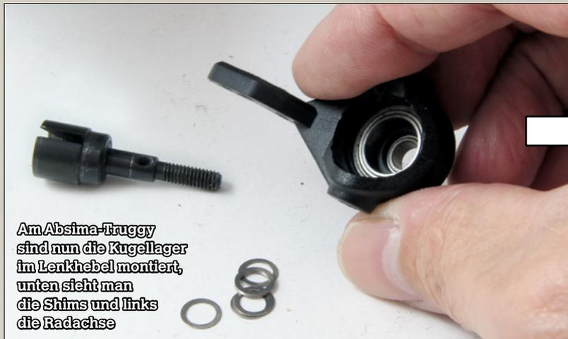
Am Absima-Truggy sind nun die Kugellager im Lenkhebel montiert, unten sieht man die Shims und links die Radachse
