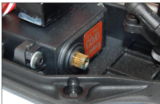
Sein Metallgetriebe verleiht dem Lenkservo erhöhte Festigkeit. Kraft und Geschwindigkeit fallen hingegen eher ernüchternd aus
