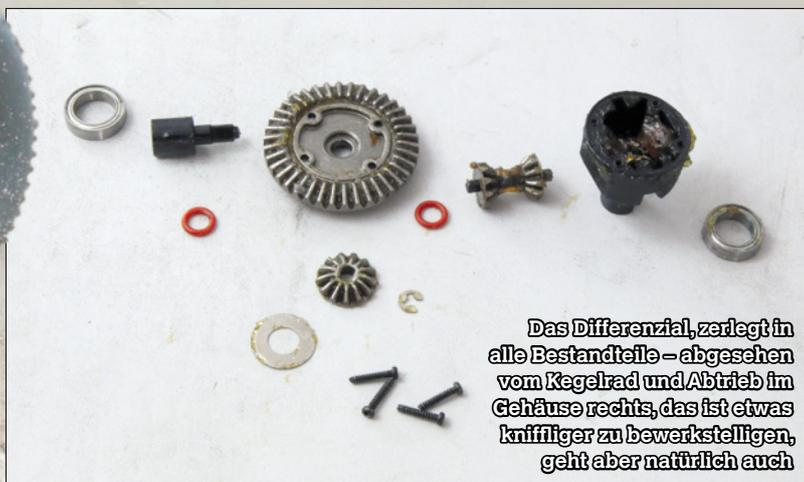
Das Differential, zerlegt in alle Bestandteile – abgesehen vom Kegelrad und Abtrieb im Gehäuse rechts, das ist etwas kniffliger zu bewerkstelligen, geht aber natürlich auch
