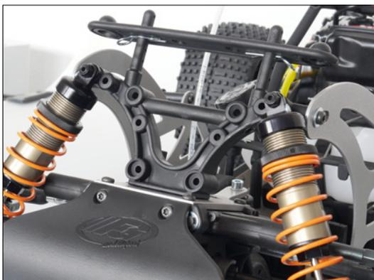
Die Vordere Dämpferbrücke ist über die Chassis-Seitenplatten zusätzlich abgestützt
