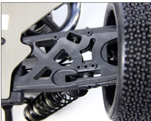
Die unteren Querlenker der Hinterachse machen ebenso einen sehr guten Eindruck und bieten drei Aufnahmen für die Stoßdämpfer und den Stabilisator, der hier ebenfalls zur Ausstattung gehört
