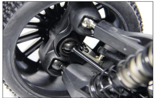
An der Vorderachse sorgen CVD-Antriebswellen für eine perfekte und spielfreie Kraftübertragung an die Räder
