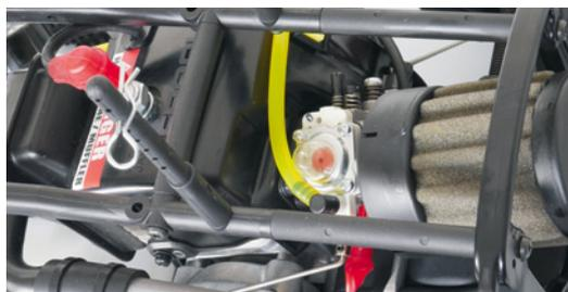
Der Luftfilter guckt nach hinten heraus und ist ab Werk gut eingölt
