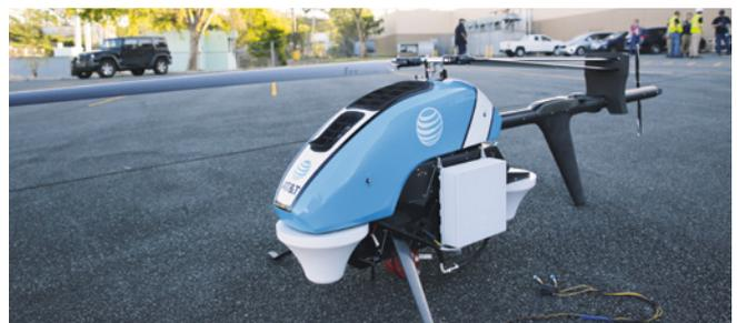
drahtlose Verbindungen herstellen, sodass den betroffenen Menschen im Katastrophengebiet Daten-, Sprach- und Textdienste wieder zur Verfügung stehen. Die COW mit ihrem Rotordurchmesser von rund 2.300 Millimeter ist damit deutlich effektiver als andere mobile Relaisstationen und kann durch ihre erhöhte Position einen weitaus größeren Bereich abdecken als bodenbasierende Systeme. Internet: [www.att.com](http://www.att.com)
