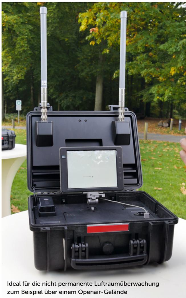
Ideal für die nicht permanente Luftraumüberwachung – zum Beispiel über einem Openair-Gelände
