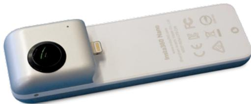
Über den Lightning-Connector ist der Anschluss zum iPhone gegeben. Auf der anderen Seite ist die Auslösetaste für den Solo-Betrieb
