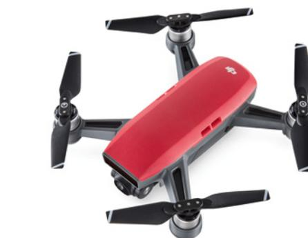
Auch im Spark, der kleinsten Drohne von DJI kommt Intel-Technik zum Einsatz – in Form der Myriad 2 VPU. Dieser ist das Herzstück des optischen Systems zur Gestensteuerung
