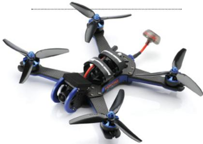
Blade Vortex 230 Mojo nennt Horizon Hobby sein jüngstes Rennpferd im FPV-Racing-Stall. Der in einer BNF Basic-Version angebotene Kopter für 419,99 Euro kommt Ready-to-Race, also vollständig montiert, und weist eine Reihe spannender Features auf. Der Mojo ist 4s LiPo-kompatibel und mit 5-Zoll-Propeller ausgestattet.
