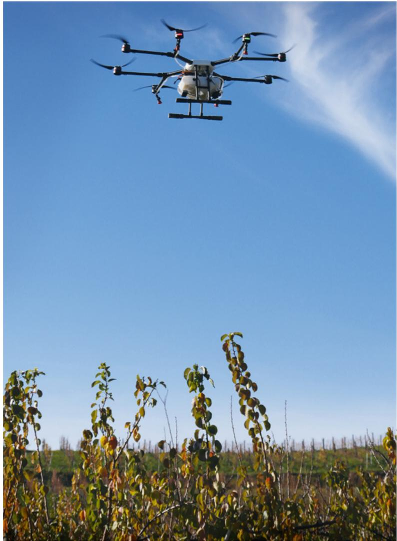
Für einen Octokopter ist die Drohne erstaunlich leise. Die Geräuschkulisse ist vergleichbar mit der eines aktuellen Phantom-Modells. Dabei wiegt der Agras inklusive vollem 10-Liter-Tank stattliche 24,5 Kilogramm. Das merkt man dem System, aber nicht an. Lenkbefehle werden knackig umgesetzt und die Drohne beweist eine beachtliche Agilität.
