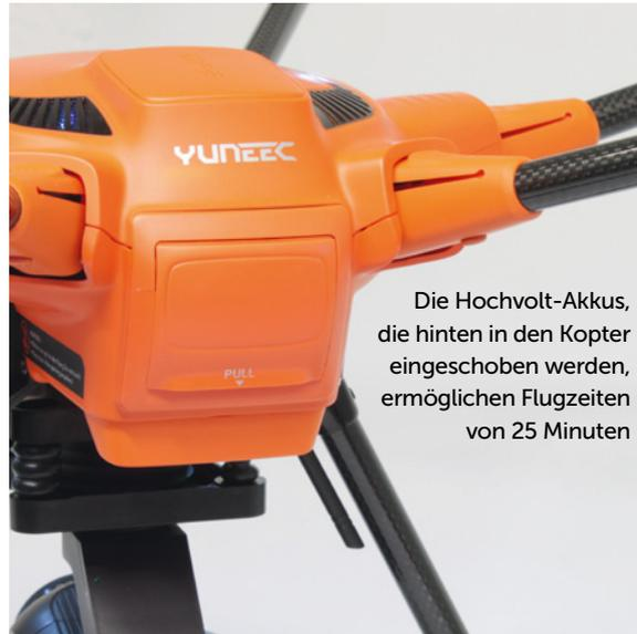
Die Hochvolt-Akkus, die hinten in den Kopter eingeschoben werden, ermöglichen Flugzeiten von 25 Minuten
