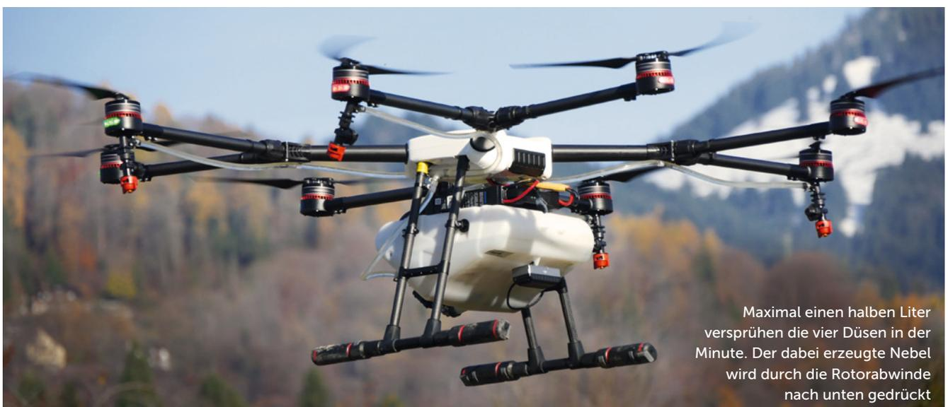
Maximal einen halben Liter versprühen die vier Düsen in der Minute. Der dabei erzeugte Nebel wird durch die Rotorabwinde nach unten gedrückt
