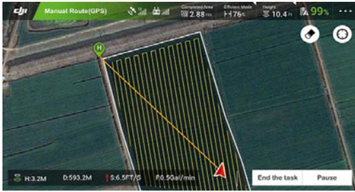
Die Steuerung mittels App ermöglicht es dem Nutzer, Routen sowie Missionen zu planen und No-Fly-Zones – um beweidete Flächen oder Gebäude – zu definieren
