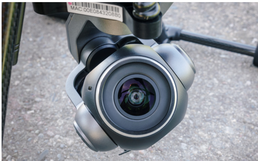
Die C23-Kamera des Typhoon H Plus liefert sehr gute Videos und ist an einem Dreiachs-Gimbal aufgehängt
