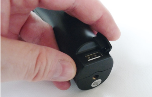
Ein Stativgewinde und ein herkömmlicher USB-Anschluss zum Laden des Aufnahmegeräts, so präsentiert sich die Unterseite des Smooth Q. Leider ist der Akku nicht ohne Weiteres auswechselbar
