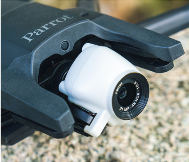
Das Gimbal ist um zwei Achsen mechanisch und um alle drei Achsen elektronisch stabilisiert
