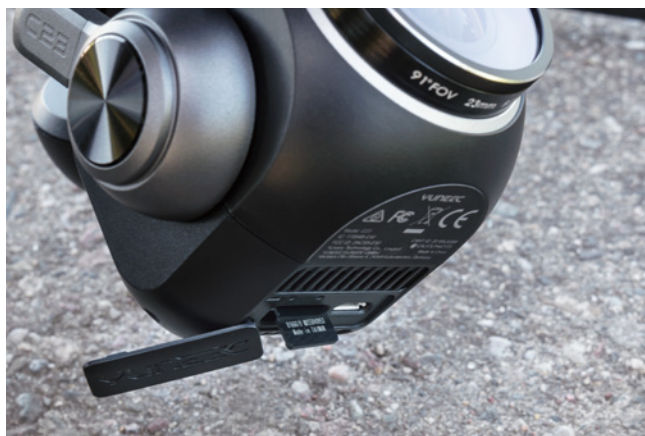
Auf der Unterseite der Kamera wird die Micro-SD-Karte eingeschoben
