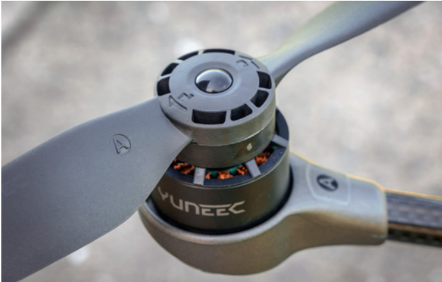
Die Motoren haben einen größeren Durchmesser als beim Vorgänger-Typhoon. Sie drehen die ebenfalls größeren Rotoren langsamer, was zu geringeren Geräuschemissionen führt
