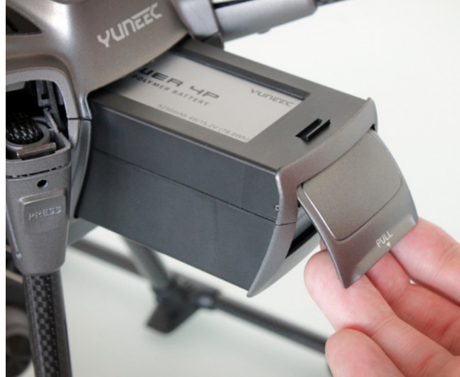
Der Akku wird einfach von hinten in den Kopter eingeschoben und mithilfe der Entriegelungslasche wieder herausgezogen
