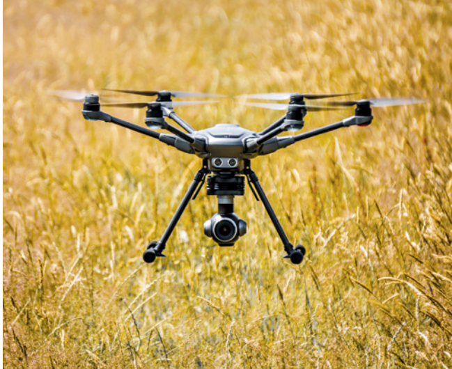
Das einziehbare Landegestell fährt der Typhoon bei der Return to Land-Funktion automatisch vor dem Aufsetzen aus
