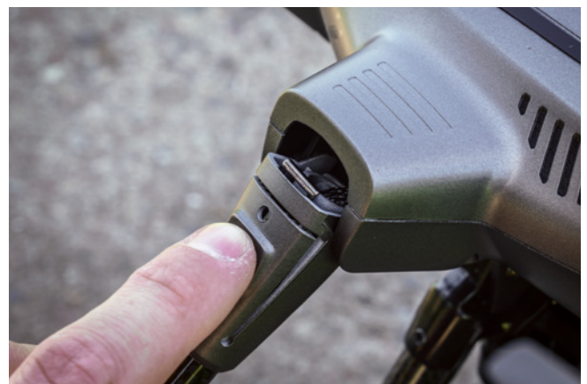
Das Entriegeln der Ausleger funktioniert durch einen Fingerdruck
