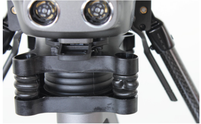
Die Gummitüllen, die die Kamera vibrationsdämpfend am Kopter halten, wirken arg angestrengt, halten jedoch problemlos
