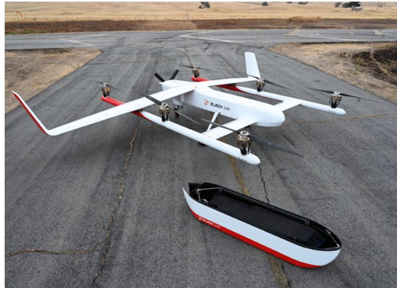
Die Ladung wird in einer Transportbox unter der Drohne fixiert, sodass diese schnell be- und entladen werden kann
