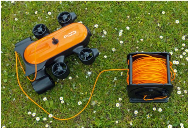
Mit einer Länge von 150 Meter definiert das Kabel den maximalen Einsatzradius des Titan
