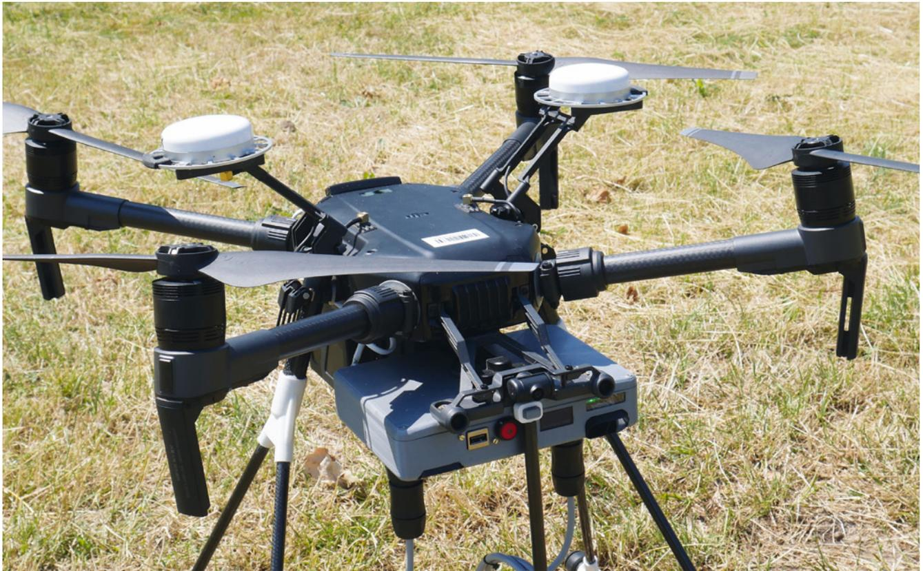
Die Basis des Systems ist eine DJI Matrice, die mit der benötigten Sensorik ausgestattet wurde
