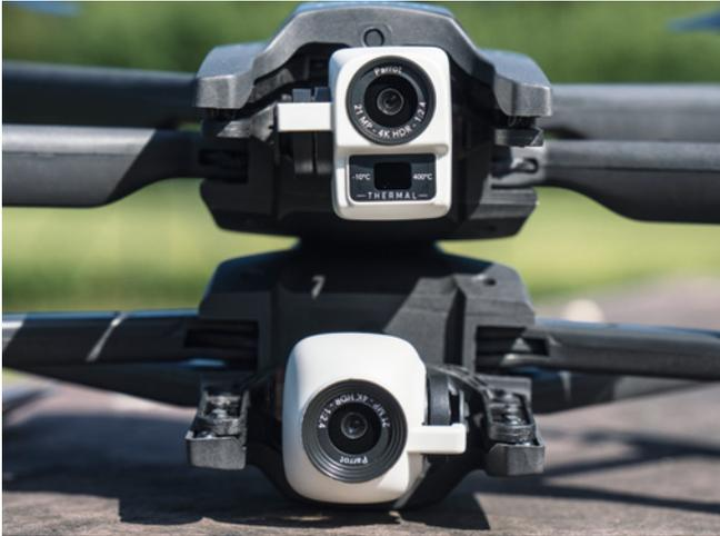
Die Foto- und Videokamera ist bei beiden Anafis gleich, sieht nur anders aus. Die Thermal-Version (oben) hat jedoch noch den Thermalsensor unter der Hauptlinse
