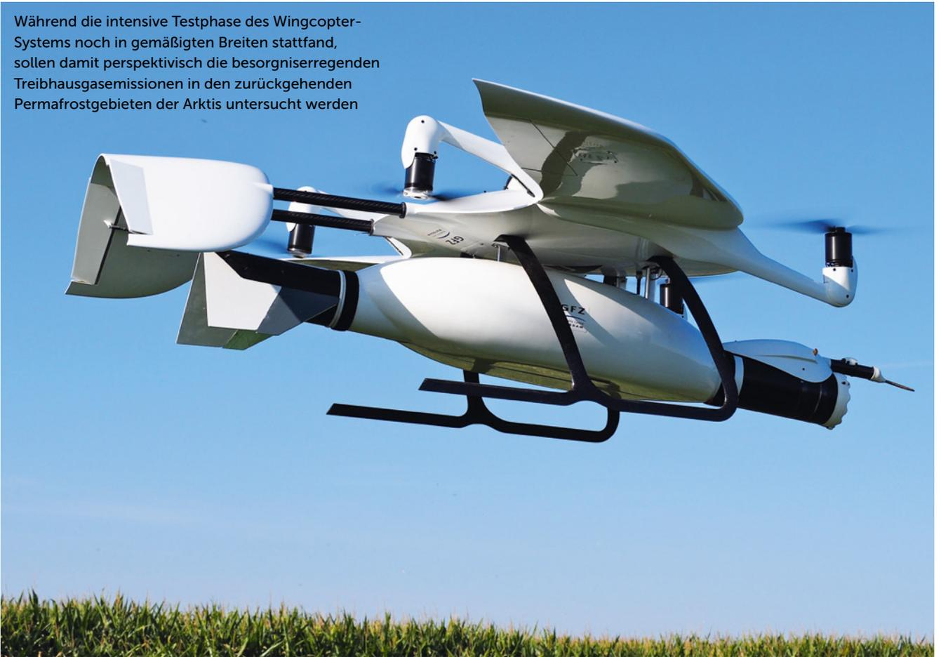
Im Projekt ReMon nutzen Forscher des GFZ ein UAV mit Hyperspektralkamera, um die Eisenmineral-Verteilung auf Abraumhalden als Indikator für schädliche Minenabwässer zu kartieren
