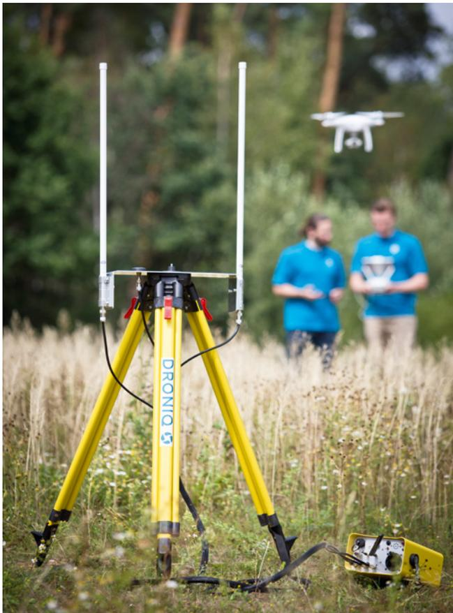
Über Sensoren am Boden werden die Signale aufgefangen, die vom bemannten Luftverkehr ausgehen (FLARM, ADS-B), um ein möglichst vollständiges Lagebild zu haben
