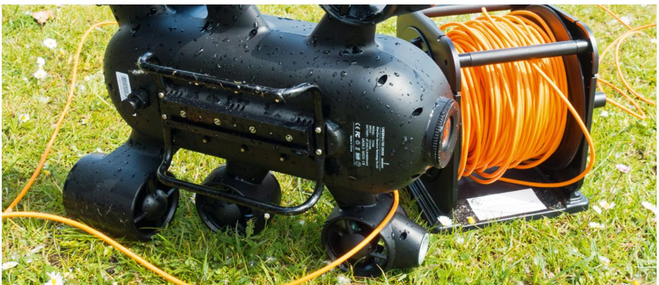
Der Bügel am Unterboden schützt nicht nur vor Beschädigungen, damit lässt sich auch der Transport der Drohne gut bewerkstelligen
