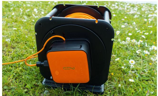
Die WLAN-Basisstation ist geschickt an der Kabeltrommel montiert
