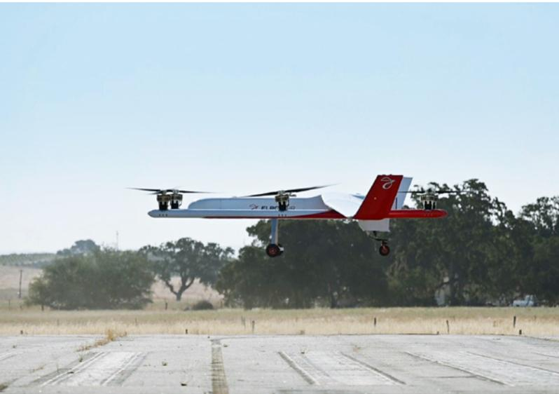
Am Anfang war der Schwebeflug: bei der Premiere über dem McMillan Airfield flog die Schwerlastdrohne etwas über eine Minute in 3 Meter Höhe
