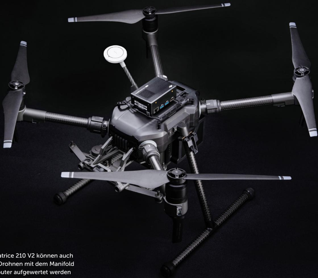
Wie diese Matrice 210 V2 können auch andere DJI-Drohnen mit dem Manifold 2-Bordcomputer aufgewertet werden
