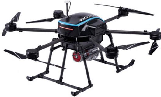
Eine Drohne für unterschiedliche Aufgaben ist die PD6B-Type II von ProDrone. Das System zeichnet sich durch eine hohe Traglast aus und kann unter anderem mit einem LiDAR-Scanner ausgestattet werden. Der Hexakopter kommt bei einem Eigengewicht von 11,5 Kilogramm mit einer Zuladung von bis zu 30 Kilogramm zurecht. Je nach Ausstattung kann er zwischen 10 und 30 Minuten in der Luft bleiben.
