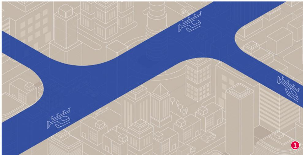
Eine Voraussetzung für den Erfolg eines Urban Air Traffic Management ist die Definierung von Korridoren, in denen eVTOLs fliegen können (1). Im Fall von medizinischen Notfällen kann die Flugsicherung Flüge zu Krankenhäusern umleiten (2). Dynamische Anpassung der Korridore ermöglicht das Umfliegen von Geländehindernissen (3). Der Pilot erhält Informationen zu Umleitungen direkt von der Flugsicherung. Auf diese Weise ist sichergestellt, dass Sperrungen einer Route auch eingehalten werden (4)
