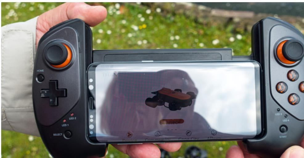
Smartphone oder Tablet werden per Klemmvorrichtung am Controller fixiert und dienen als Ausgabemedium für das Kamerabild
