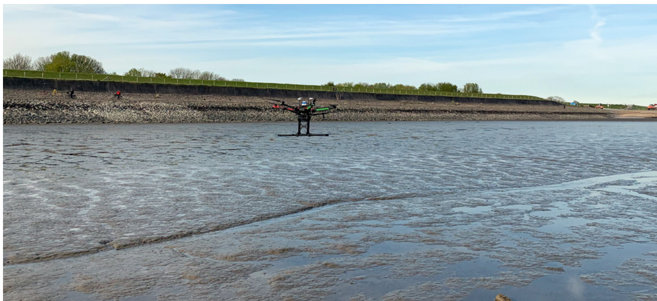
Wo sich früher Menschen mit dem Equipment zur Kampfmitteldetektion durch den schweren Wattboden kämpfen mussten, werden mittlerweile Drohnen eingesetzt. Das spart jede Menge Zeit, Mühe und Geld
