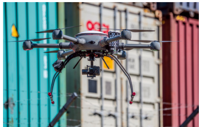
Kontrollflug zwischen Containern: Mit ihren sechs Propellern lässt sich die HHLA-Drohne auch außerhalb der Sichtweite mit einer Genauigkeit von bis zu 0,05 Meter manövrieren
