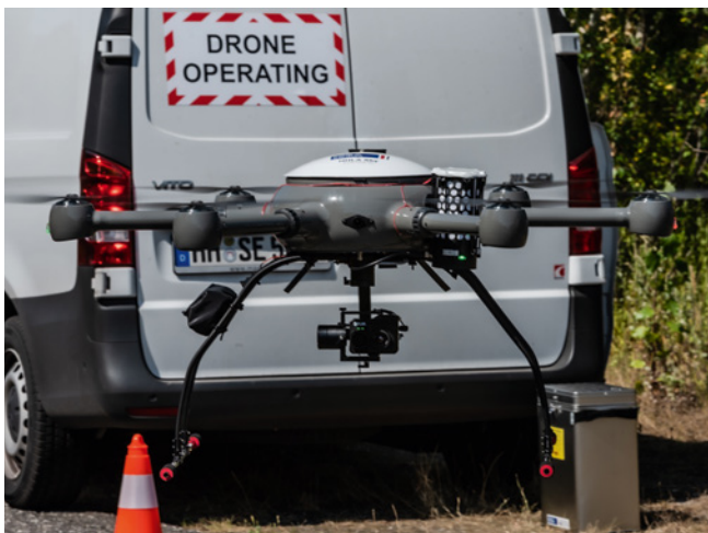
Bis zu 45 Minuten Einsatzzeit kann die 11 Kilogramm schwere Drohne mit einer Akkuladung absolvieren. Bei Signalverlust setzt der Hexakopter selbständig zur Landung an, im Notfall hilft ein selbstauslösender Fallschirm dabei, das Schlimmste zu verhindern
