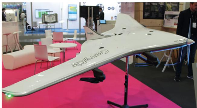
Bis zu 10 Kilogramm Payload soll die CarryAir, eine Nurflügel-Drohne in VTOL-Ausführung, laut Hersteller Striekair Engineering transportieren können
