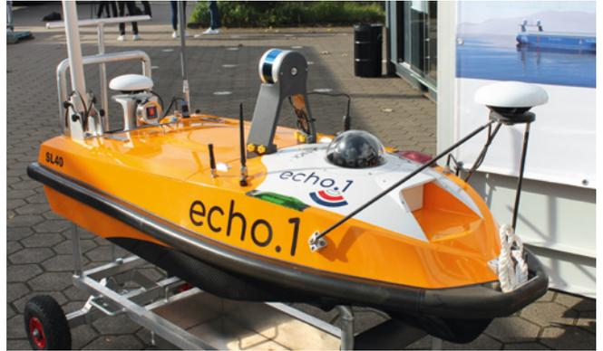
Auf dem Testgelände homePORT im Hamburger Hafen konnten Interessierte die Vermessungsdrohne echo.1 in Augenschein nehmen, die beispielsweise zur Erfassung von Geodaten in Hafenbecken eingesetzt werden kann
