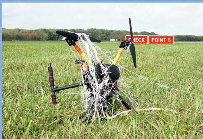
Die Abfangdrohne, die im Rahmen des Projekts Falke entwickelt wird, soll unkooperative Drohnen mit einem Netz vom Himmel holen und kontrolliert zur Landung bringen
