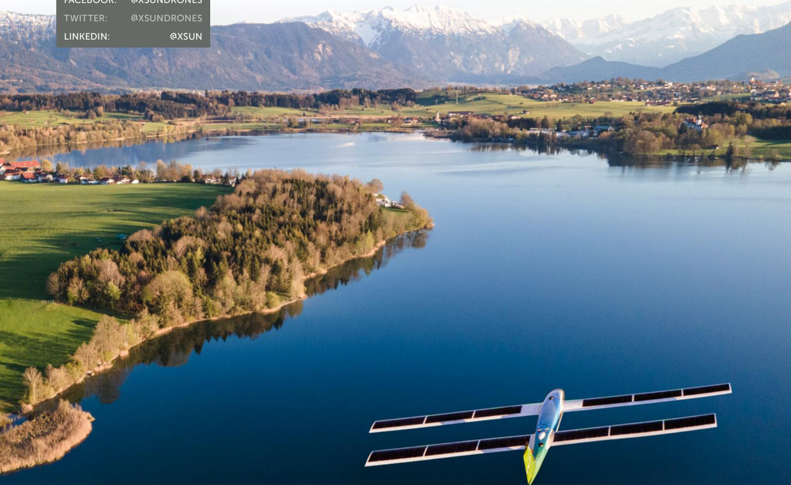
Von einer Startrampe aus beginnt die SolarXOne ihre Missionen, in denen sie autonom bis zu 12 Stunden unterwegs sein kann
