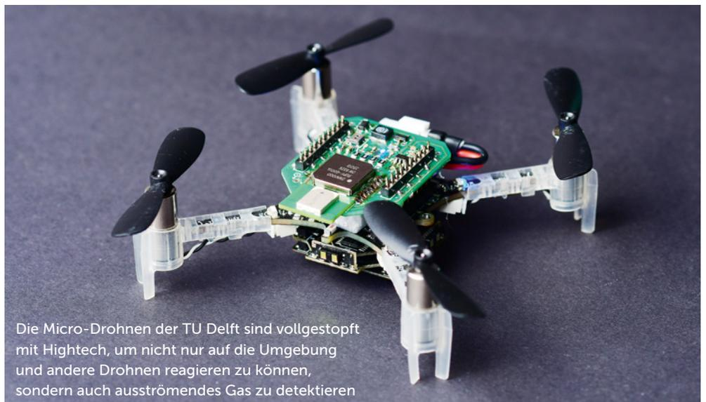
Die Micro-Drohnen der TU Delft sind vollgestopft mit Hightech, um nicht nur auf die Umgebung und andere Drohnen reagieren zu können, sondern auch ausströmendes Gas zu detektieren
