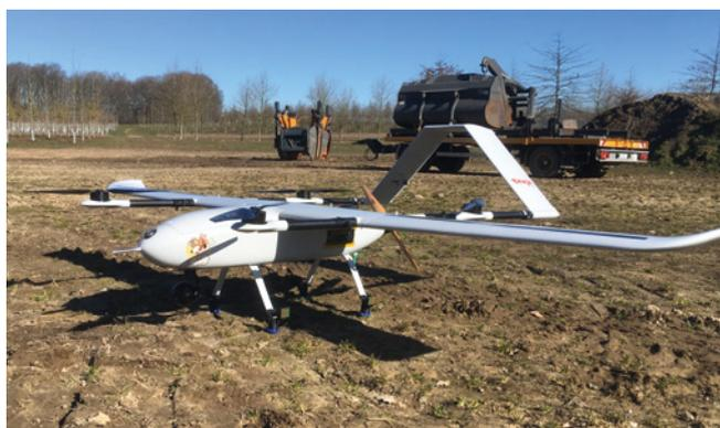
Die „Beagle M“ hat eine Spannweite von 2,50 Metern und kann bis zu drei Kilogramm Payload transportieren
