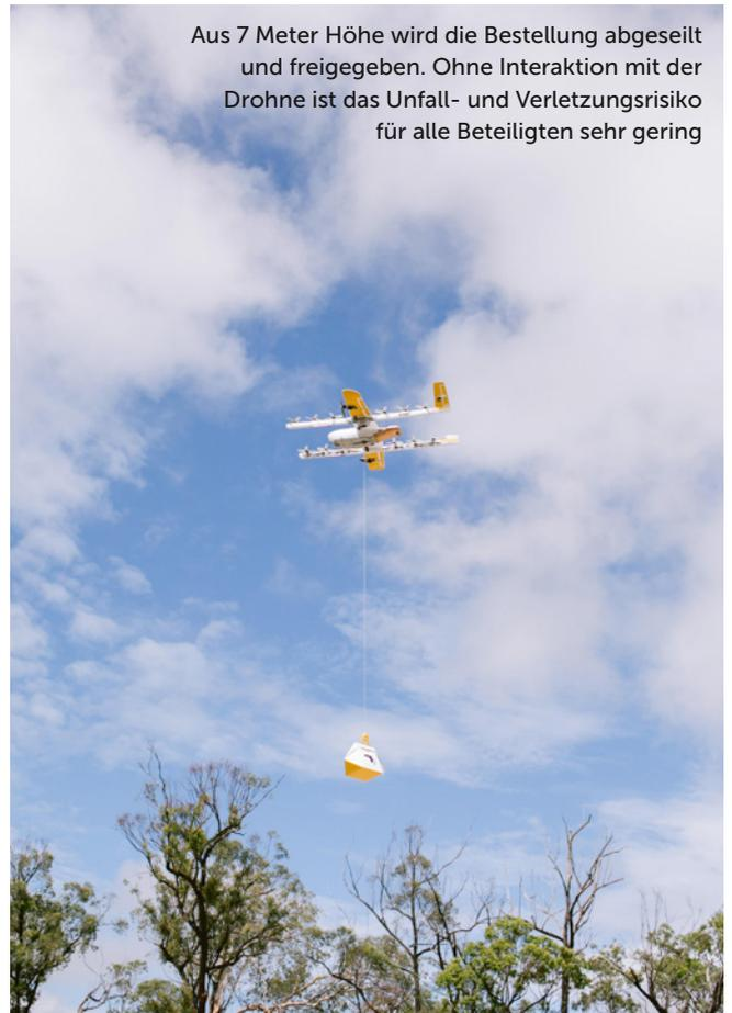
Aus 7 Meter Höhe wird die Bestellung abgeseilt und freigegeben. Ohne Interaktion mit der Drohne ist das Unfall- und Verletzungsrisiko für alle Beteiligten sehr gering
