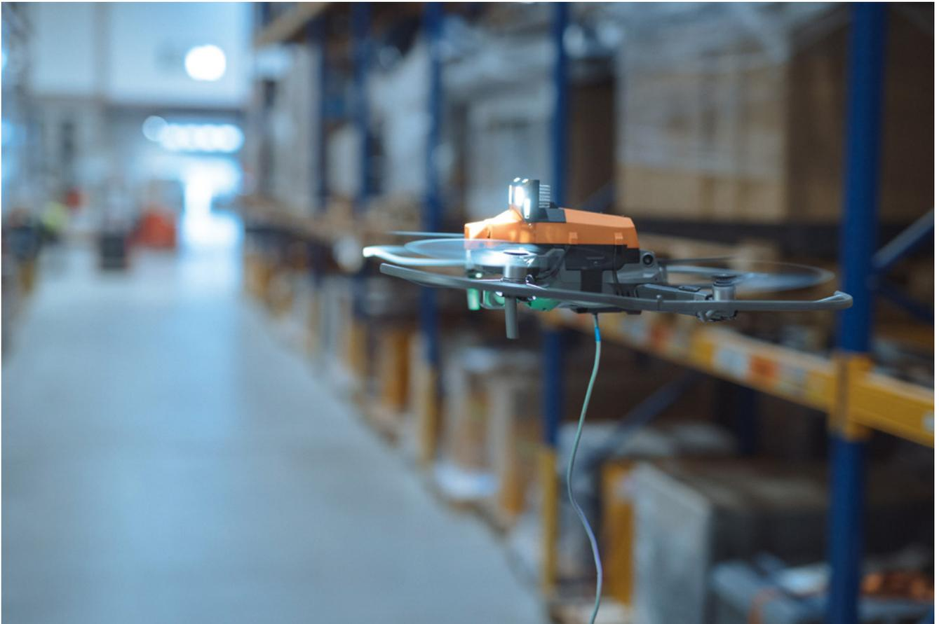
Die entscheidende Neuerung bei inventAIRy XL im Vergleich zum Vorgänger inventAIRy X ist die Kabelverbindung zwischen rollender Basisstation und fliegender Drohne, die die Betriebszeit auf bis zu fünf Stunden erhöht
