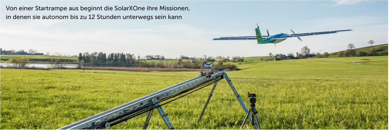
Akku an Bord sorgt dafür, dass nach Herstellerangaben auch ohne Sonneneinstrahlung noch vier bis fünf Stunden Flugzeit möglich sind. Bei einer Payload von etwa 5 Kilogramm und der Möglichkeit, verschiedene Kamera- und Sensoriksysteme einzusetzen, ergeben sich vor allem im Bereich Monitoring oder Vermessung interessante Einsatzoptionen, aber auch in der maritimen Wirtschaft oder bei Sicherheitsorganisationen.
