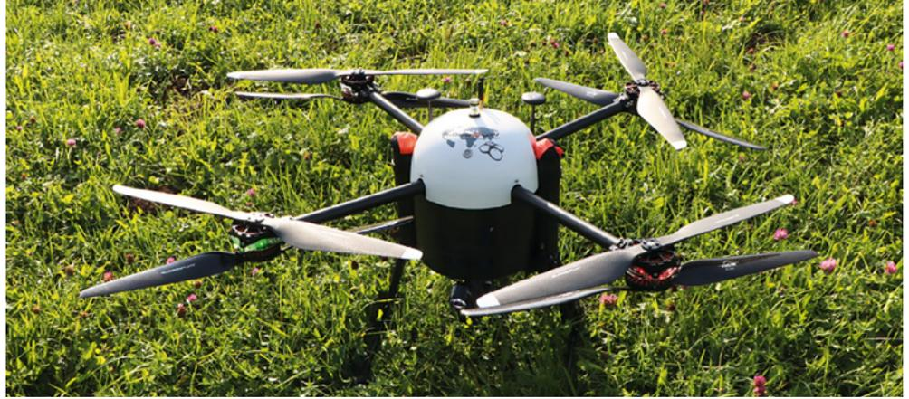
Die 10 Kilogramm schwere Drohne von Globe UAV fliegt teilautomatisiert auf einer vordefinierten Route. Per Mobilfunk ist sie mit dem Betreiber verbunden und liefert in Echtzeit hochauflösende Bilddaten
