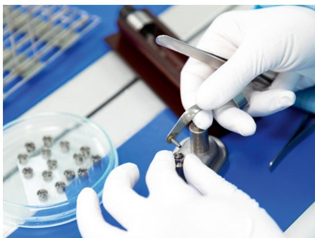
Für Hochpräzisionslager gilt für die Abmessungen außerhalb des Lagers die Toleranzklassen ABEC 7 (Annular Bearing Engineering Committee), für die Komponenten innerhalb des Lagers ist ABEC 9 gefordert. Das bedeutet, dass die Messtoleranzen zwischen 0,004 (ABEC 7) und 0,003 Millimeter (ABEC 9) liegen
