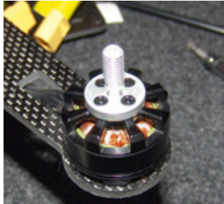
Die starken Motoren verleihen dem Rise RXS270 Wahnsinns-Power. Schwarze und silberne Spinner markieren die Rechts-Links-Gewinde der Naben
