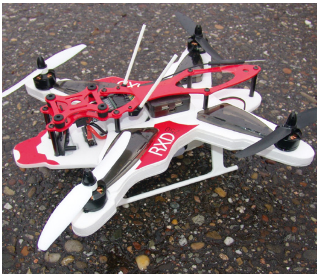
Das Kürzel RXD steht beim Rise RXD250 für „Rise Xtreme Durability“ – das Chassis ist aus Composit-Material gefertigt und bietet quasi „Knautschzonen“
