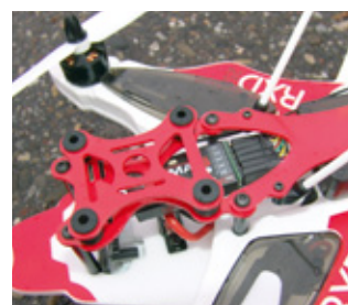
Der Empfänger lässt sich geschützt unter der oberen Platte anbringen. Frontseitig ist am Kopter wie auch am RXS270 alles zur Aufnahme einer FPV-Cam vorbereitet
