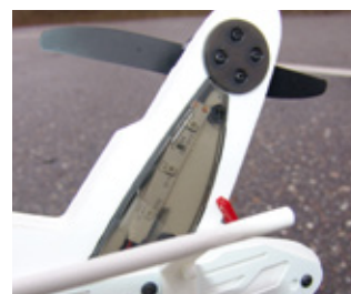
Auf der Unterseite der Auslegerame sind hinter Rauchglaskappen LED eingebaut
