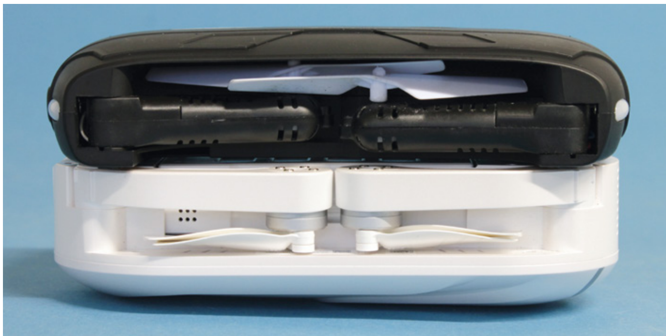
In zusammengeklapptem Zustand schmiegen sich die Propeller und Arme der Dobby (unten) sauber an den Korpus an. Bei den Starrluftschrauben von Elfie sieht das nicht so elegant aus
