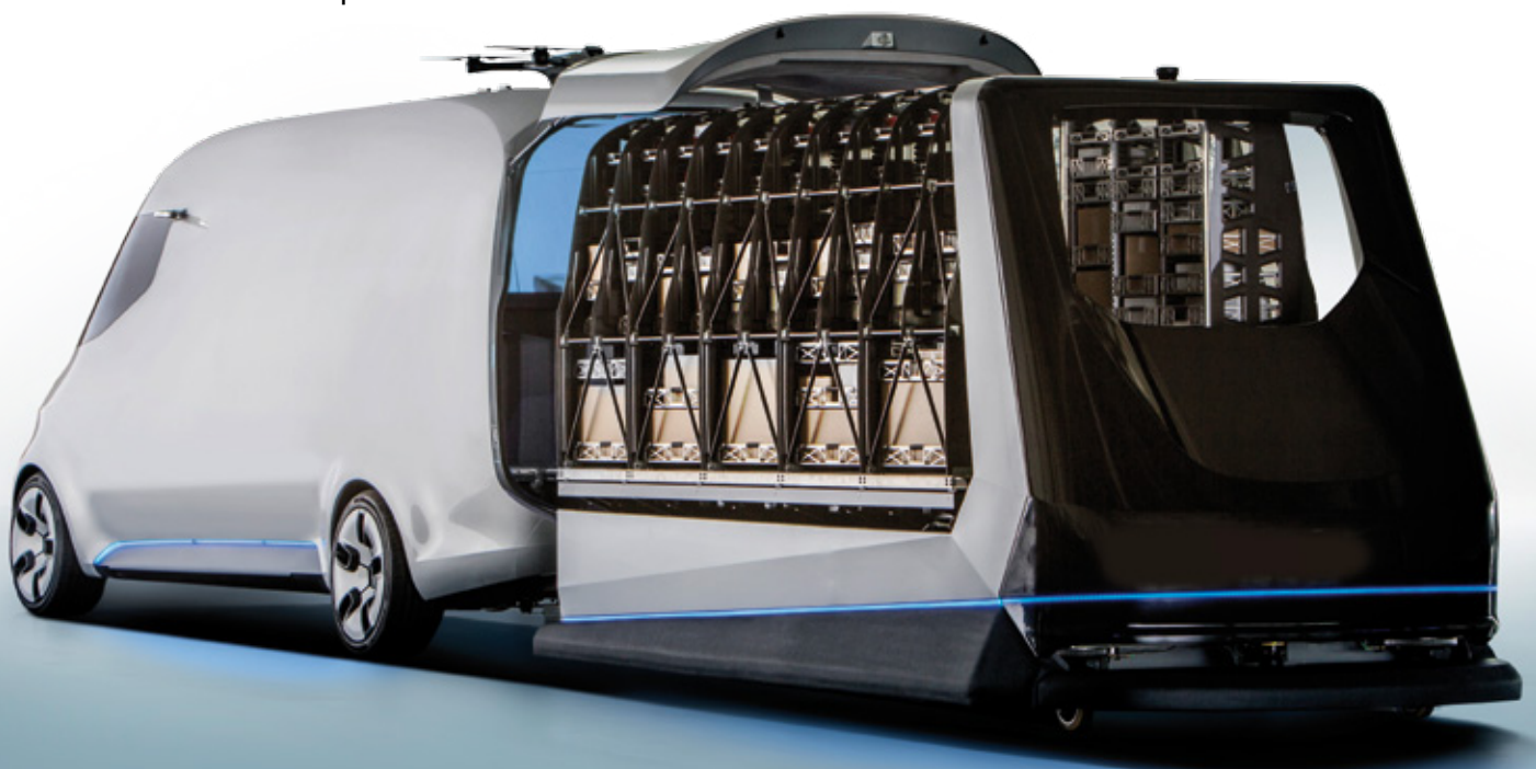
Ein fertig gepacktes Regalsystem wird in einem Zug in den Vision Van geladen. Der Prozess ist automatisiert, der Fahrer kann sich entspannen
