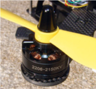
Die starken Motoren verleihen dem Rise RXS270 Wahnsinns-Power. Schwarze und silberne Spinner markieren die Rechts-Links-Gewinde der Naben
