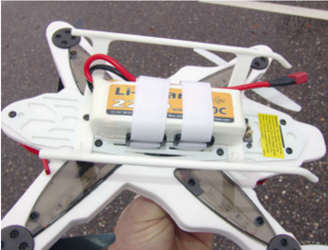
Das Landegestell RXD250 bietet Schutz für den an der Unterseite festgezurrten 3s-Akku
