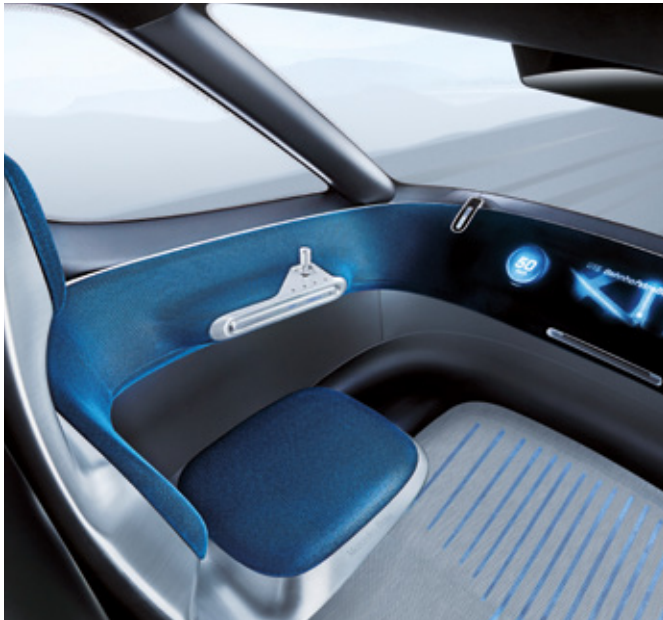
Gelenkt wird der Vision Van Transporter mit einer in der Armlehne integrierten Joystick-Steuerung
