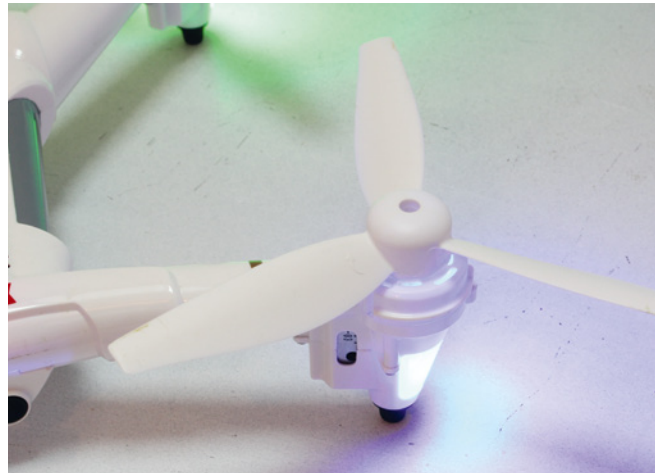
An dem Quadrocopter sind serienmäßig Dreiblattpropeller verbaut
