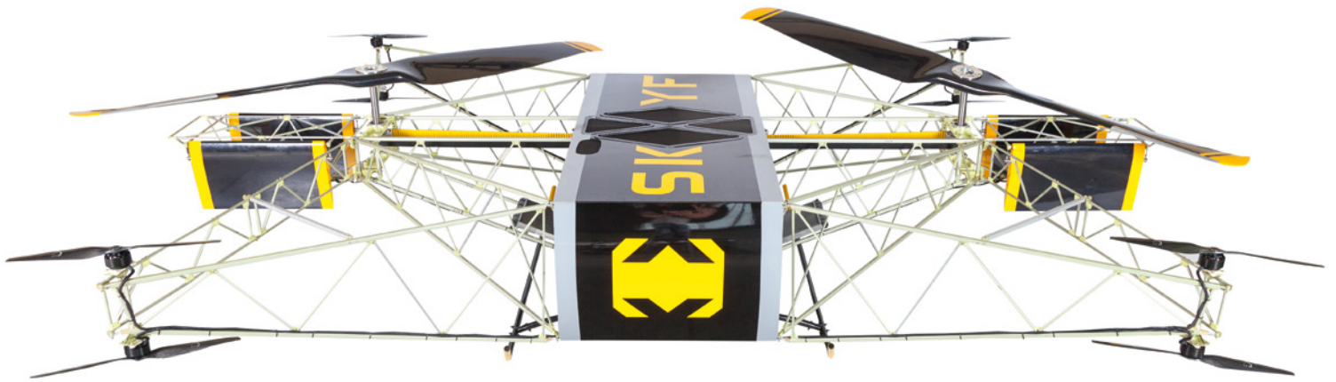
Der Antrieb basiert auf zwei großen – von einem Verbrennungsmotor angetriebenen – Schrauben, die für den Auftrieb sorgen. Die Steuerung übernehmen die elektrisch betriebenen Hilfsprops
