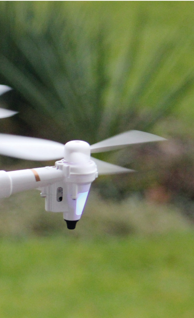
An dem Quadrocopter sind serienmäßig Dreiblattpropeller verbaut
