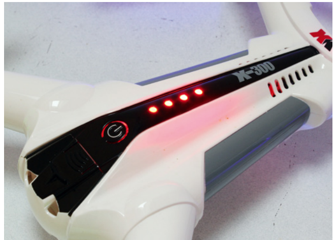
LED geben Auskunft über den Ladestatus des Flugakkus
