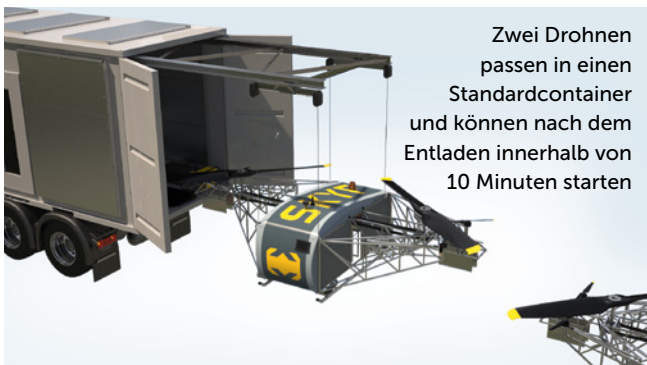
Der Antrieb basiert auf zwei großen – von einem Verbrennungsmotor angetriebenen – Schrauben, die für den Auftrieb sorgen. Die Steuerung übernehmen die elektrisch betriebenen Hilfsprops
