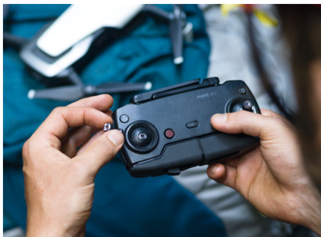
Auch der Sender wurde überarbeitet. So können erstmalig die Senderknüppel abgenommen werden
