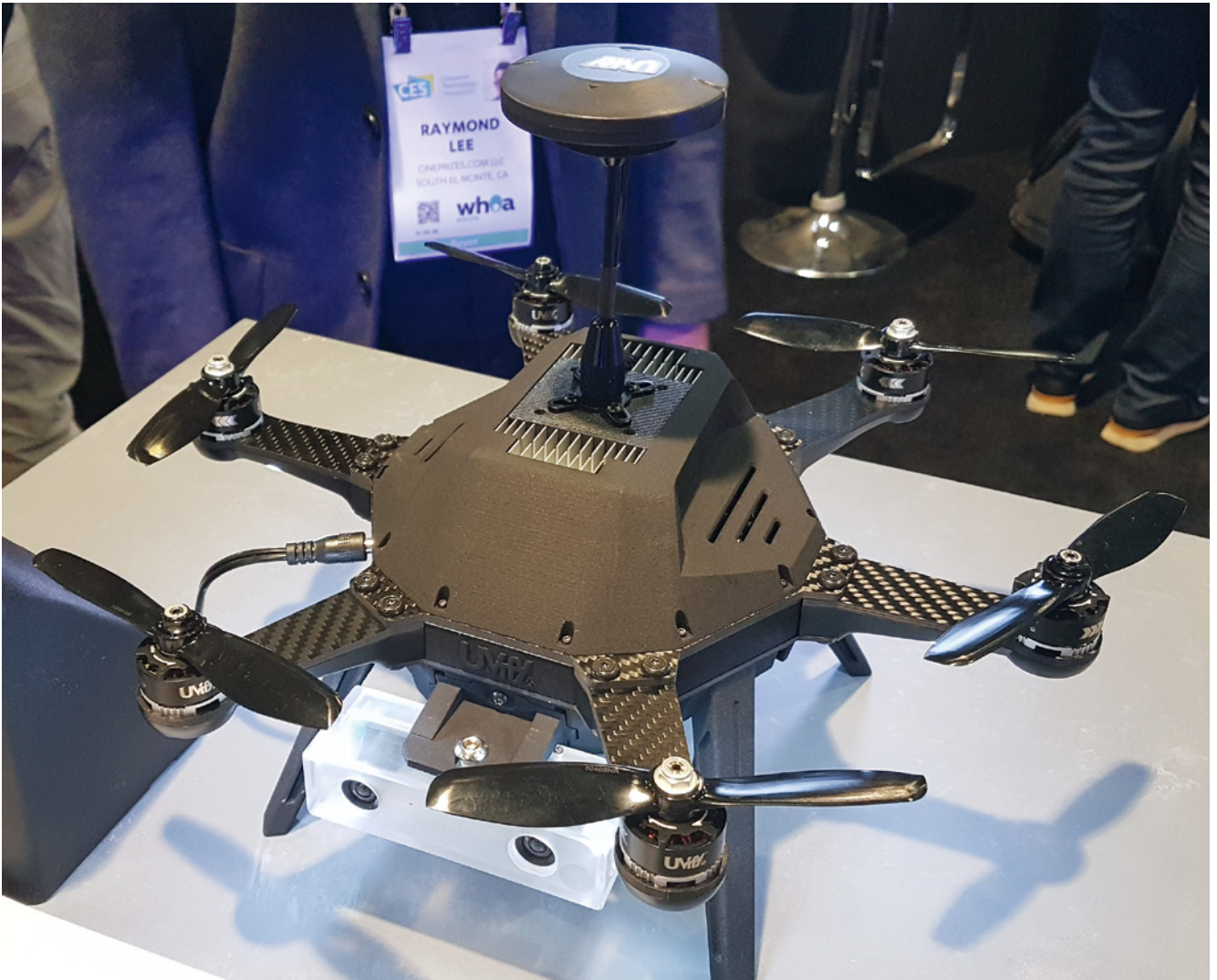
Eine Highend-Forschungsplattform hat Uvify mit der Draco Research im Sortiment. In dem kompakten Hexakopter ist eine Menge Technik verbaut – unter anderem ein Schnellwechselsystem für den Antrieb, ein universeller Sensor-Anschluss für verschiedene Nutzlasten, Nvidia-Technik und verschiedene Kamerasysteme. Draco Research ist mit Sicherheit einer der innovativsten Kopter der CES 2018. WWW.UVIFY.COM
