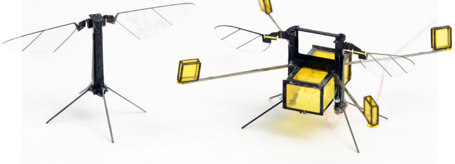
Der Aerial-Aquatic Microrobot (rechts) zusammen mit der RoboBee – einer weiteren Micro-Drohne aus den Labors von Harvard
