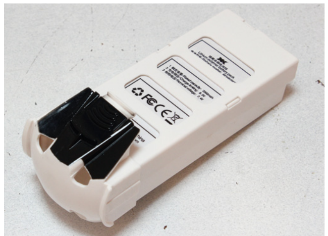
Der Systemakku hat zwei Zellen und wird einfach in den rückwärtigen Schacht der Drohne gesteckt
