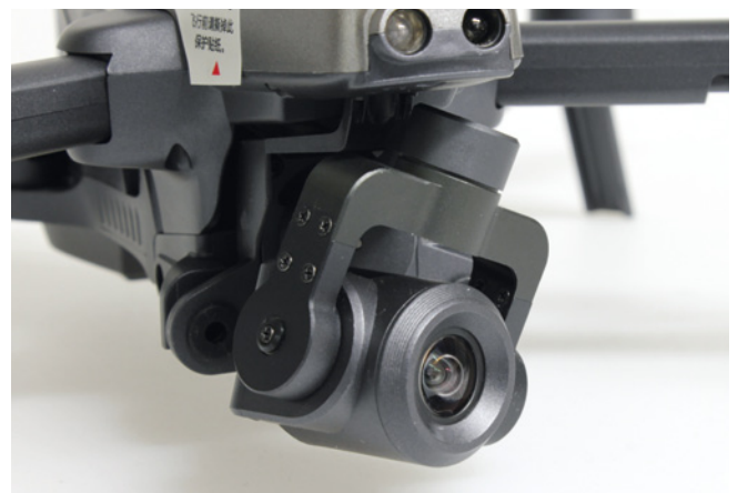
Verbaut ist eine 4K-Kamera, die in ein Mini-Gimbal eingefasst ist. Die Aufnahmen werden durchweg gut
