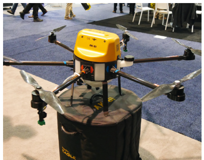
Die AK61 von Digital Eagle ist eine Highend-Drohne in Hexakopter-Auslegung, die für landwirtschaftliche Anwendungen konzipiert wurde. Das System kann eine Nutzlast von 10 Kilogramm transportieren und zum Beispiel zum Besprühen oder Vermessen von Feldern genutzt werden. Die Flugzeit gibt der Hersteller mit bis zu 20 Minuten an. WWW.DIGITALEAGLE-UAV.COM
