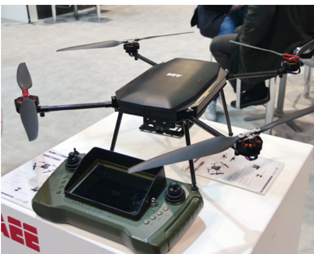
Die Mach 4 von AEE ist eine Multi-Payload-Drohne, die über einen Rahmen verfügt, der die Montage verschiedener Nutzlasten ermöglicht. Die Mach 4 kann 40 Minuten in der Luft bleiben, ist für verschiedene professionelle Anwendungszwecke geeignet und wird wahlweise mit Ground Station anstelle eines Senders ausgeliefert. WWW.AEEUSA.COM
