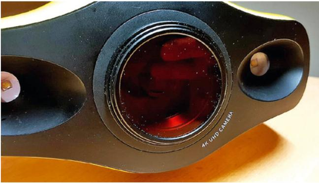
Sollen unterhalb von 10 Meter Wassertiefe Aufnahmen gemacht werden empfiehlt sich der Einsatz eines Unterwasser-Filters
