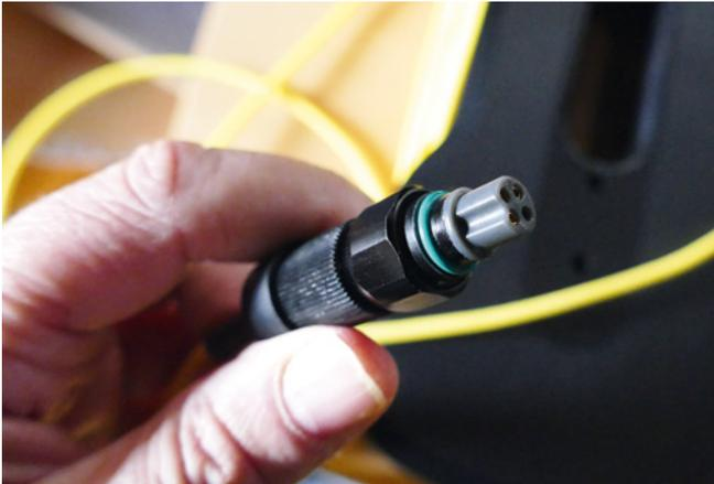
Es ist ratsam, die O-Ringe der Verbindungsstecker regelmäßig zu überprüfen und diese bei kleinsten Beschädigungen auszutauschen
