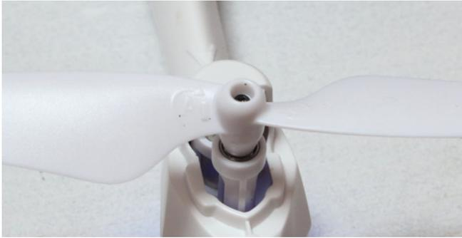
Die Propeller werden auf den Motorwellen verschraubt. Das Verfahren ist nicht mehr ganz zeitgemäß, funktioniert aber
