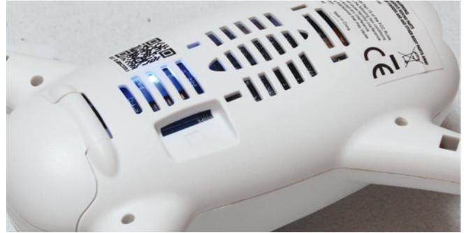
Auf der Unterseite der Drohne befindet sich unter anderem der Micro-SD-Karten-Slot
