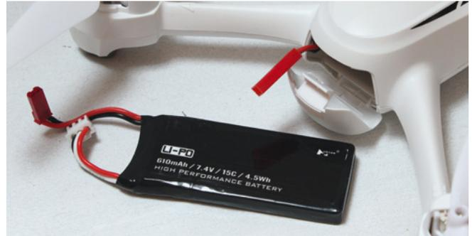
Der zweizellige Akku gehört zum Set und ermöglicht Flugzeiten von bis zu 10 Minuten
