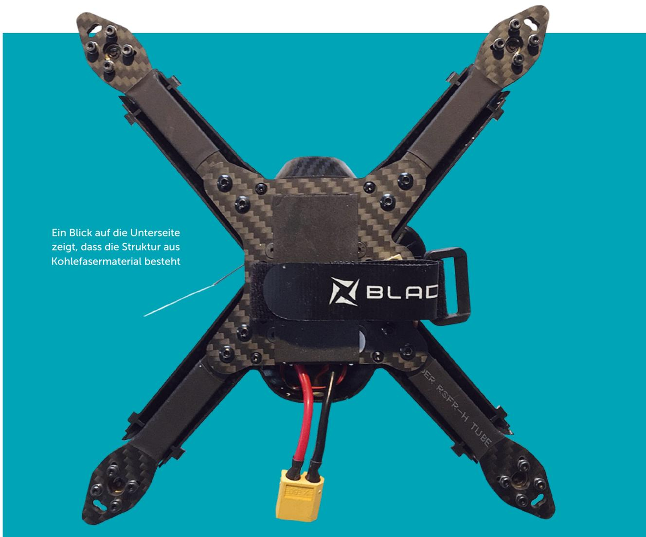
Ein Blick auf die Unterseite zeigt, dass die Struktur aus Kohlefasermaterial besteht
