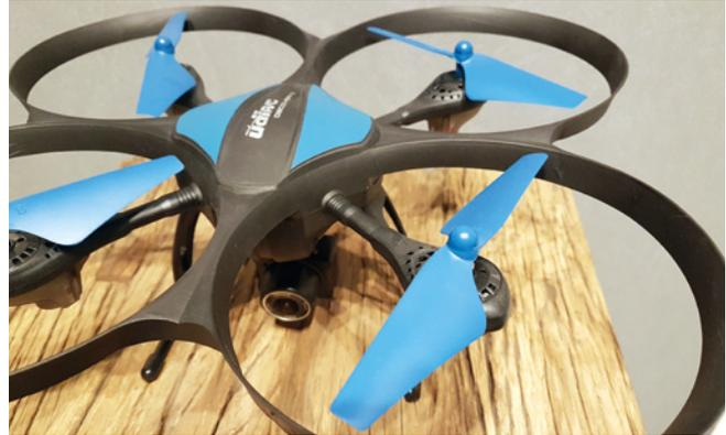
Die Akkus der beiden Kontrahenten erlauben je nach Flugstil Einsatzzeiten von 10 Minuten (X8 Pro) bis zu einer Viertelstunde (Discovery 2)
