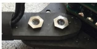
Ein Makel: Einige Schrauben sind zu kurz, werden nicht bündig von den Muttern erfasst
