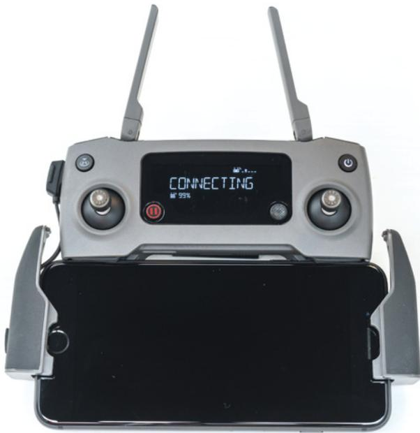
Ein bekanntes Bild vom Vorgänger ist die Fernsteuerung. Die theoretische Maximal-Reichweite soll bei 8 Kilometern liegen
