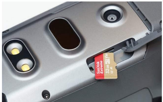
Die Micro-SD-Karte wird seitlich auf der Unterseite in die Drohne geschoben. Zusätzlich steht ein interner Speicher von 8 Gigabyte zur Verfügung
