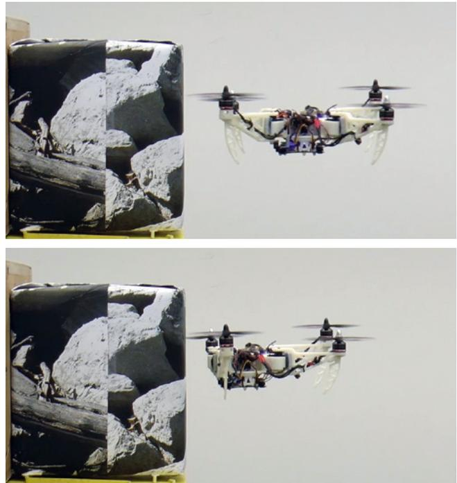
In der T-Form kann die Drohne mit einer am Rahmen montierten Onboard-Kamera besonders dicht an zu inspizierende Objekte heranfliegen
