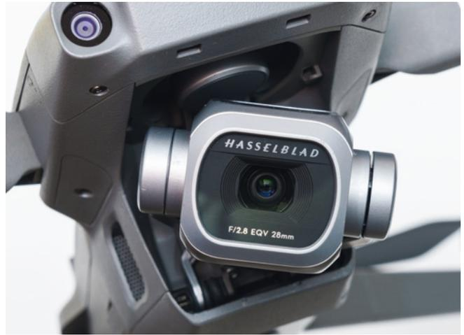
Die Hasselblad-Kamera hat einen 1-Zoll-Sensor und verfügt über eine einstellbare Blende
