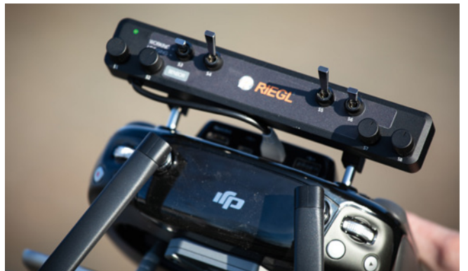
Der Sender der DJI Wind 8 wurde so modifiziert, dass der Steuerer die Drohne fliegen und gleichzeitig den Scanner bedienen kann
