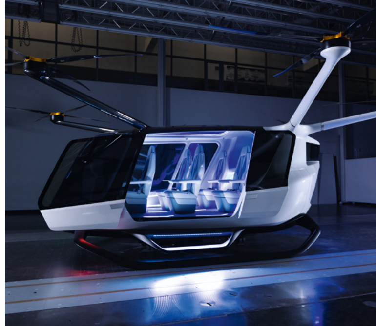
Angetrieben von einer Brennstoffzelle beträgt die Reichweite von Skai rund 600 Kilometer
