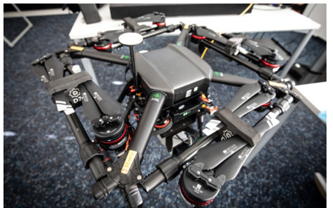
Die Wind 8-Drohne, ein Highlight im Professional-Segment von DJI, lässt sich kompakt zusammenfallen
