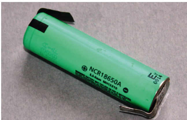
Alles begann mit der 18650. Moderne Zelle mit 3,1 Ah und moderater 2C-Belastbarkeit
