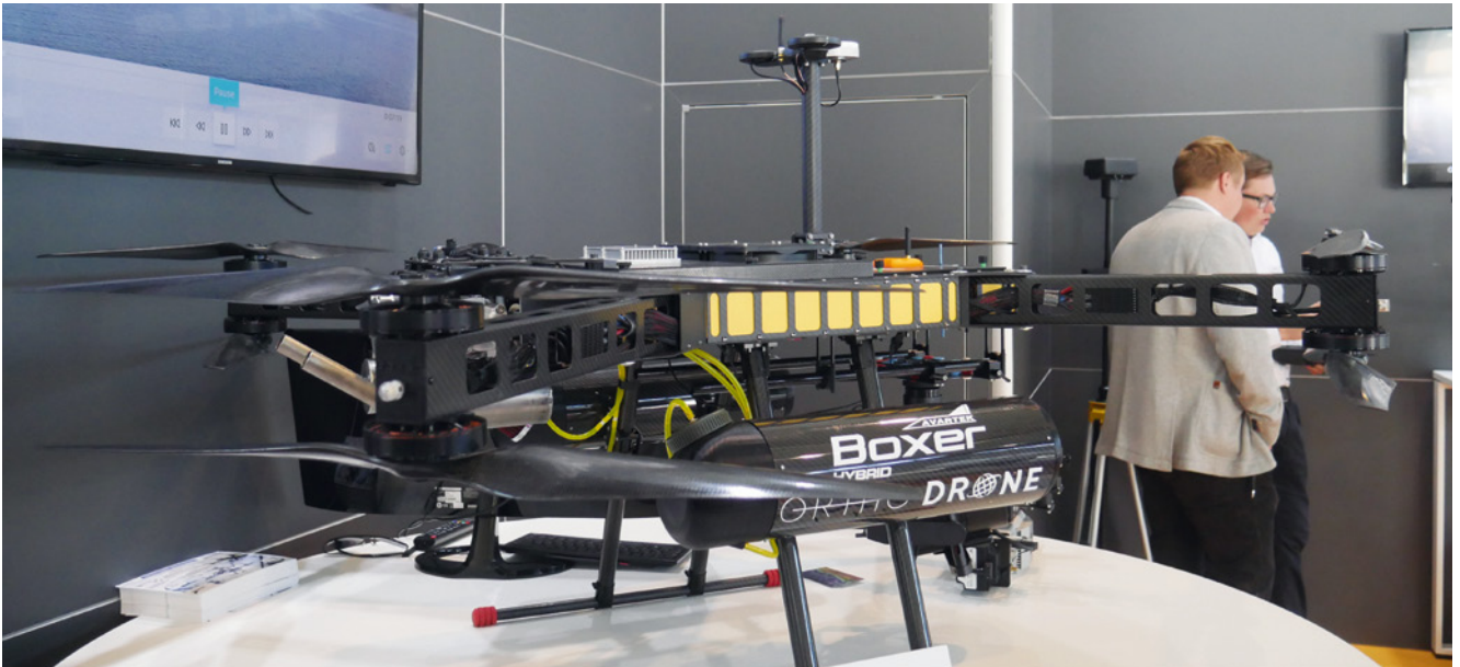
Nicht nur bei den Straßenfahrzeugen, auch im UAV-Bereich könnten Hybridantriebe zumindest übergangsweise die Lösung für bestehende Reichweitenprobleme sein. Mit ihrer Boxer-Drohne realisiert die Orthodrone GmbH aus Kiel Flugzeiten von mehreren Stunden und erhebt Geodaten für Vermessung, Modellierung und Oberflächenanalysen
