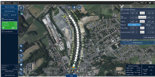
Flugplan für einen vordefinierten Streckenabschnitt, automatisch erstellt mit der Missionsplanungssoftware QBase
