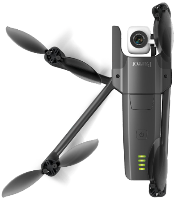
Die Ausleger der Anafi lassen sich anklappen, sodass die Drohne sehr transportfreundlich wird
