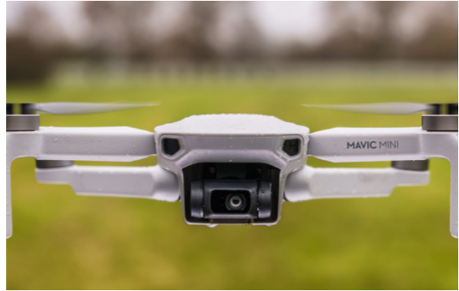
Die unscheinbare Kamera liefert hervorragende Fotos und ist an einem Dreiechs-Gimbal aufgehängt
