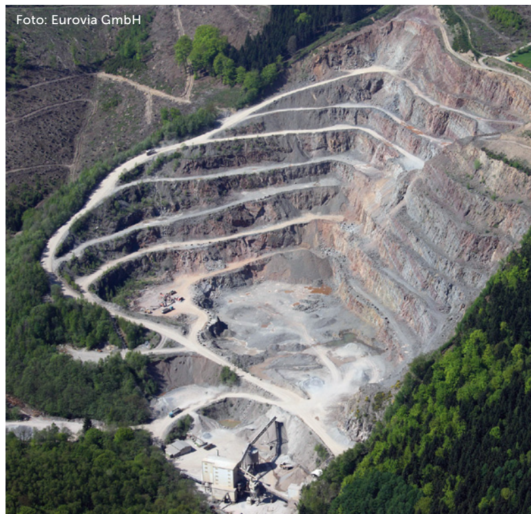
Für Geländevermessungen sowie für die Ermittlung von Materialreserven nutzt Eurovia Drohnen auch oft in Steinbrüchen wie hier in Lasbeck; damit lassen sich der Fortschritt im Abbau und die vorhandenen Bestände wesentlich häufiger und genauer erheben
