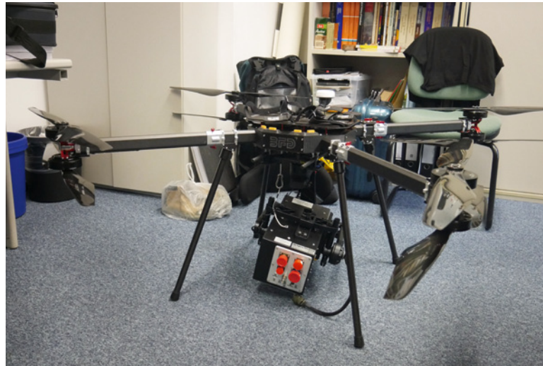
Den augenzwinkernden Spitznamen „Rambo“ trägt der Kopter des Typs BFD XQ-1400S, der mit einer Hyperspektralkamera (HySpex Mjolnir) der Firma NEO ausgestattet ist und unter anderem im Projekt HyPhy zum Einsatz kommt
