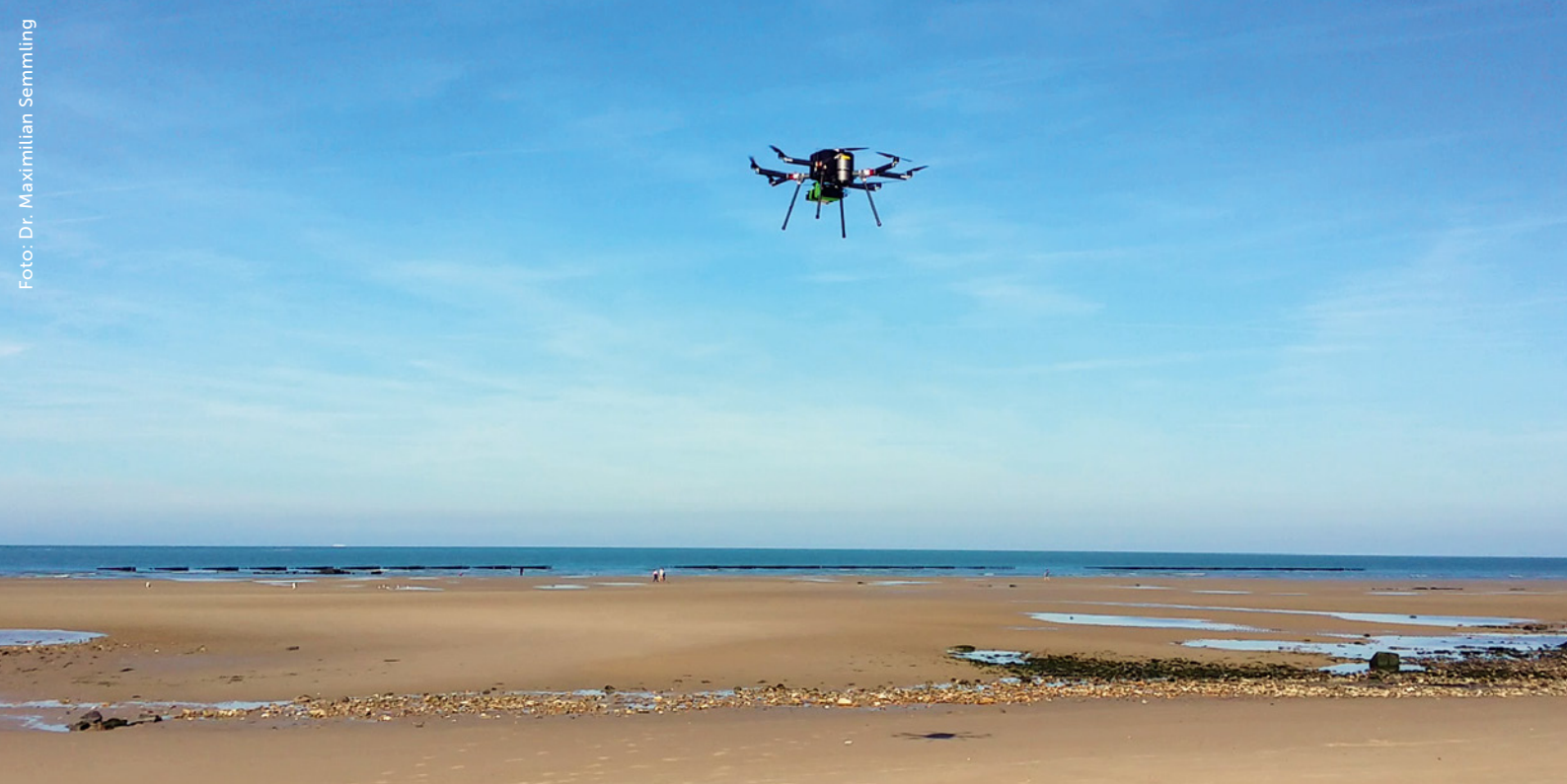
Prototyp eines mit einem GNSS-Empfänger zur Reflektometrie ausgerüsteten Oktokopters während eines Experiments an der französischen Opalküste. Im konkreten Fall wurden vom Meer reflektierte GNSS-Signale gemessen. In Kooperation mit französischen Partnern von der Universität Calais sollen dabei Informationen über Meeresspiegel und Seegang gewonnen werden
