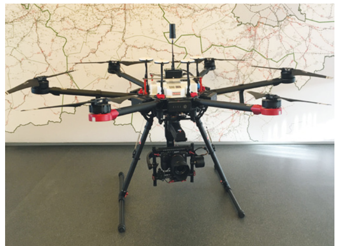
Die DJI-Drohne Matrice 600, die Patrick Placht und seine Kollegen hauptsächlich einsetzen, ist von der österreichischen Flugsicherung Austro Control für Flugeinsätze über besiedeltem Gebiet zugelassen
