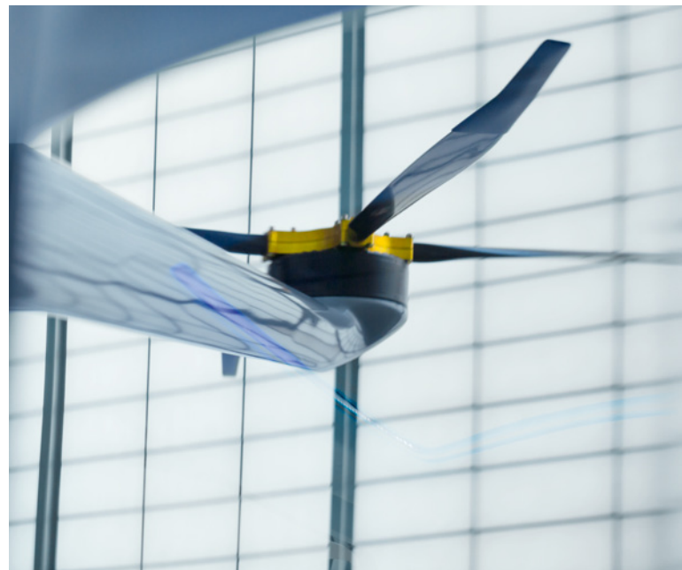
Die Elektromotoren beziehen ihren Strom aus einer Brennstoffzelle. Sie wurden für eine möglichst geringe Lärmentwicklung und gleichzeitig hohe Effizienz optimiert
