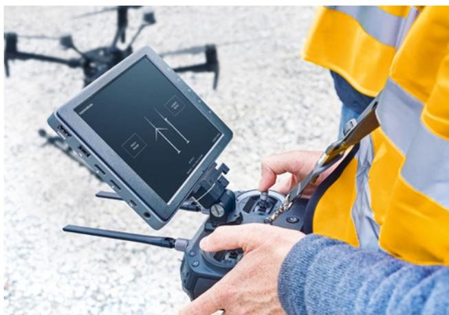
Anhand vorher konfigurierter Routen fliegt die Drohne das zu inspizierende Windrad automatisch ab
