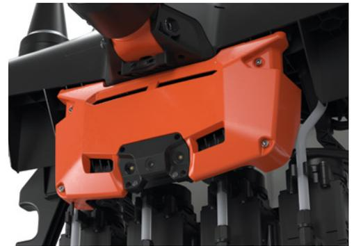
Im wechselbaren Tank der DJI Agras T20 können bis zu 20 Liter Flüssigkeiten transportiert und über acht Düsen zielgenau ausgebracht werden. Das ebenfalls erhältliche Ausbringsystem 2.0 ermöglicht es, festen Dünger oder Saatgut mit Korngrößen von 0,5 bis 5 Zentimeter zu verstreuen
