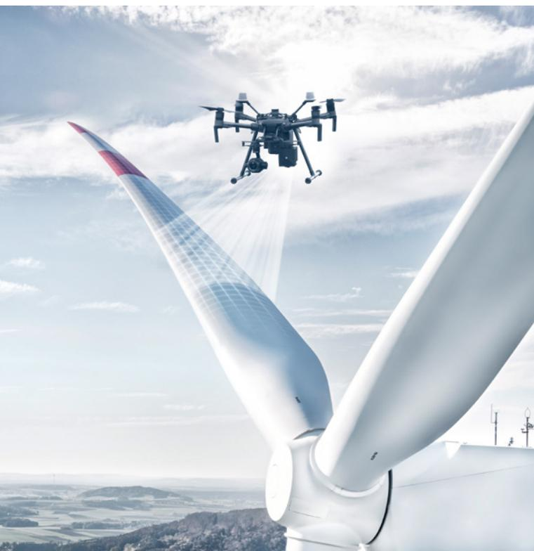
... und dann von der Drohne aufgefangen wird. Kommt der Impuls mit voller Stärke an, ist alles gut. Ist dies nicht der Fall, kann der Fehler mit der Drohne gefunden werden.
