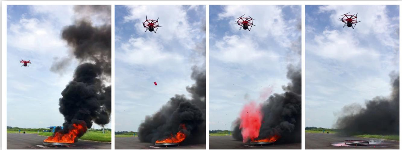
Abwurf einer so genannten „Extinguishing Bomb“, die bei der Brandbekämpfung universell eingesetzt werden kann
