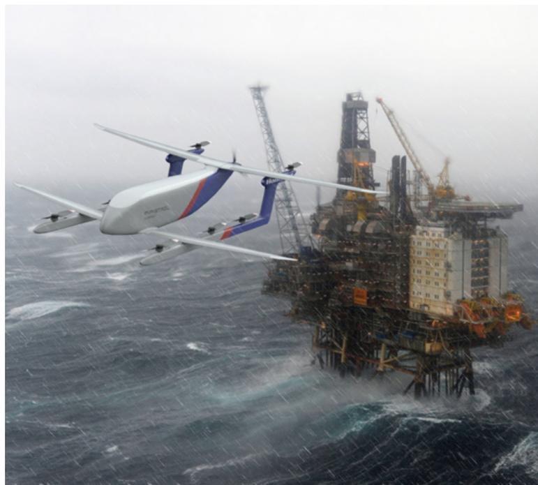
Mit acht kräftigen Elektromotoren absolvieren Pipistrels Nuuva-Drohnen Starts- und Landungen elektrisch, für den "Reiseflug" kommt ein Verbrennungsmotor zum Einsatz
