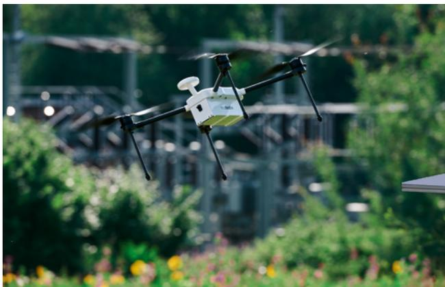
Die EB4-700 wiegt lediglich 3 Kilogramm, die maximale Flugzeit liegt knapp über der Grenze von 100 Minuten
