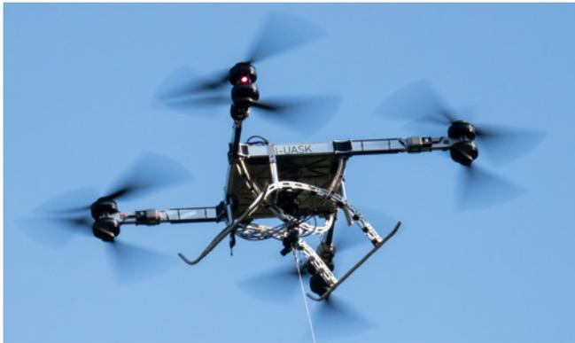
Ist die Ware am Zielort abgesetzt, kann die Drohne das Transportseil ausklinken und ohne Zwischenlandung zurück zum Ausgangspunkt der Mission oder einem anderen Landepunkt in der Nähe fliegen
