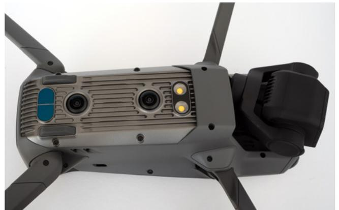
Acht Sensoren sorgen für eine omnidirektionale Hinderniserkennung und damit sichereres Fliegen
