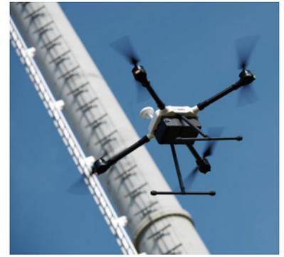
Der Quadrocopter EB4-850 kann bei einer Flugzeit von bis zu 55 Minuten verschiedene Kameras oder auch einen LiDAR-Sensor transportieren
