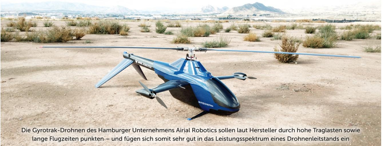
Die Gyrotrak-Drohnen des Hamburger Unternehmens Aerial Robotics sollen laut Hersteller durch hohe Traglasten sowie lange Flugzeiten punkten – und fügen sich somit sehr gut in das Leistungsspektrum eines Drohnenleitstands ein
