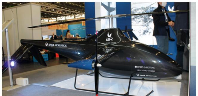
Ein beeindruckendes Fluggerät ist der Prototyp des Gyrotrak GT100 von Aerial Robotics, der bei einem maximalen Startgewicht von 100 Kilogramm eine Payload von bis zu 62 Kilogramm transportieren kann
