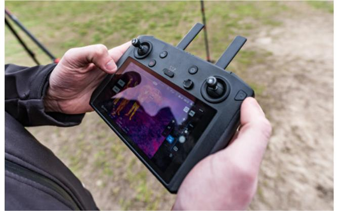
Direkt auf dem Senderdisplay kann man sich per Funkübertragung die von der Thermalkamera gewonnenen Bilddaten ansehen
