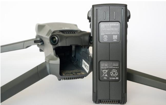
Nur spezielle Akkus passen in den Schacht. Mit diesen sind dann bis zu 35 Minuten Flugzeit möglich
