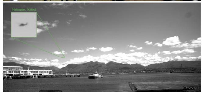
Wie ein Spotter überwacht das Casia G-System (oben) von Iris Automation den Himmel und gibt eine automatische Warnmeldung aus, wenn sich ein Luftfahrzeug dem Missionsgebiet der eingesetzten Drohne nähert
