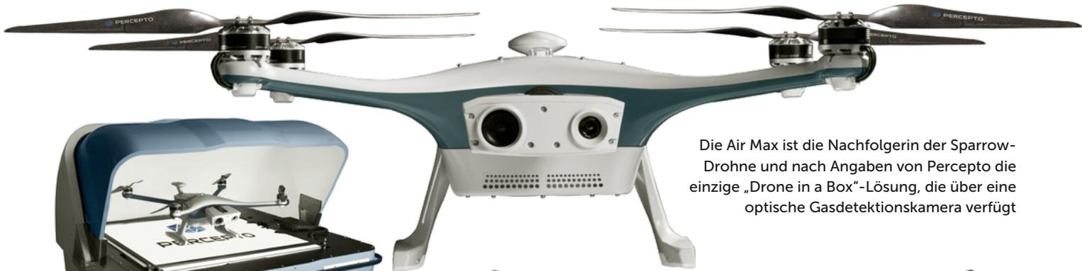
Die Air Max ist die Nachfolgerin der Sparrow-Drohne und nach Angaben von Percepto die einzige „Drohn in a Box“-Lösung, die über eine optische Gasdetektionskamera verfügt
