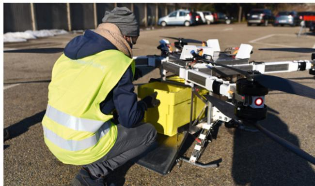
In einer Cargobox wurden 26 Kilogramm Payload verstaut und über eine Distanz von knapp 4 Kilometern transportiert
