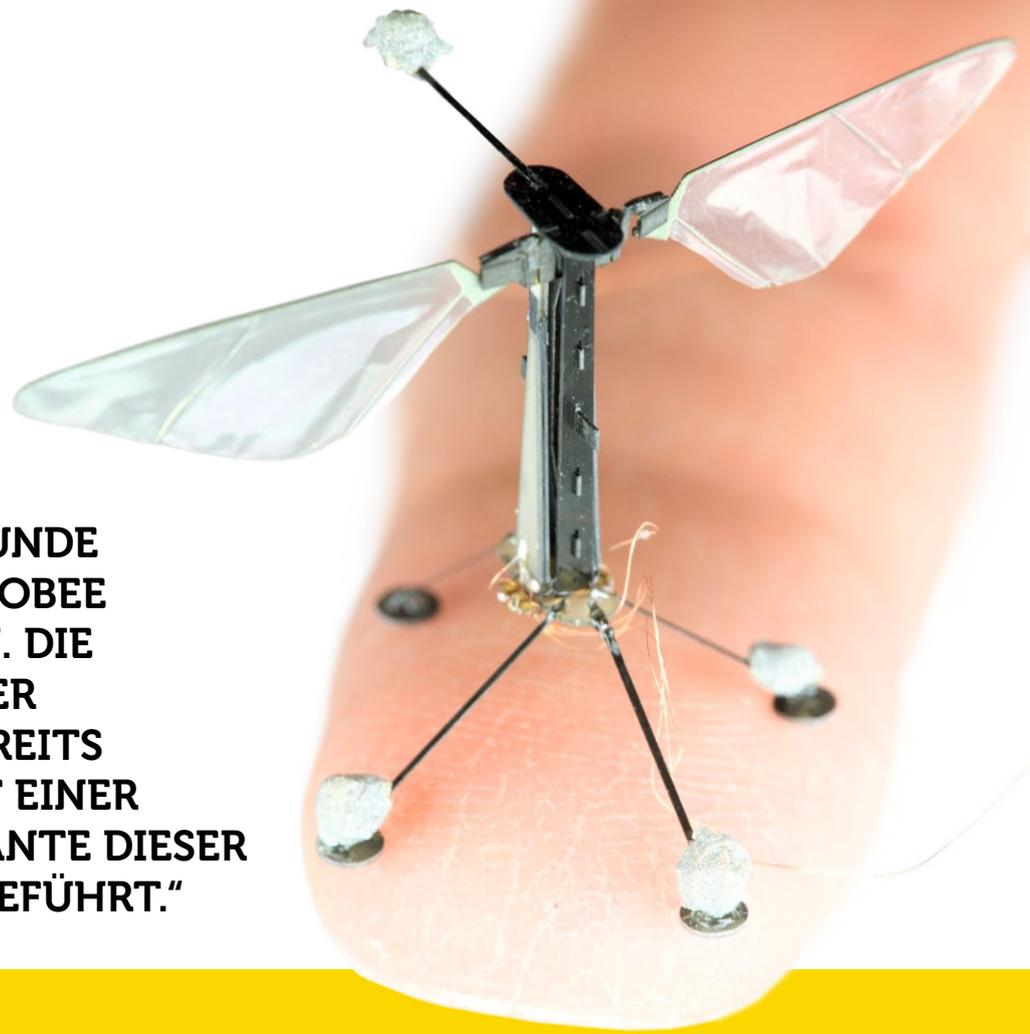
**„120 MAL PRO SEKUNDE SCHLÄGT DIE ROBOBEE MIT DEN FLÜGELN. DIE BESTÄUBUNG EINER BLÜTE WURDE BEREITS ERFOLGREICH MIT EINER GRÖßEREN VARIANTE DIESER DROHNE DURCHGEFÜHRT.“**
