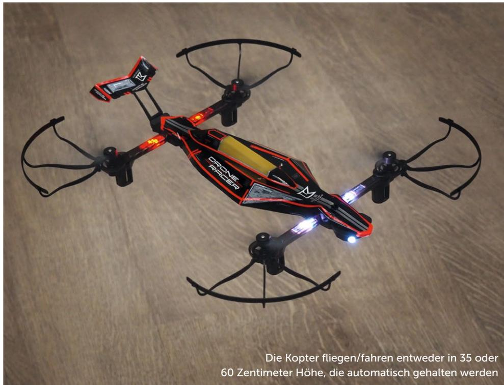
Die Kopter fliegen/fahren entweder in 35 oder 60 Zentimeter Höhe, die automatisch gehalten werden
