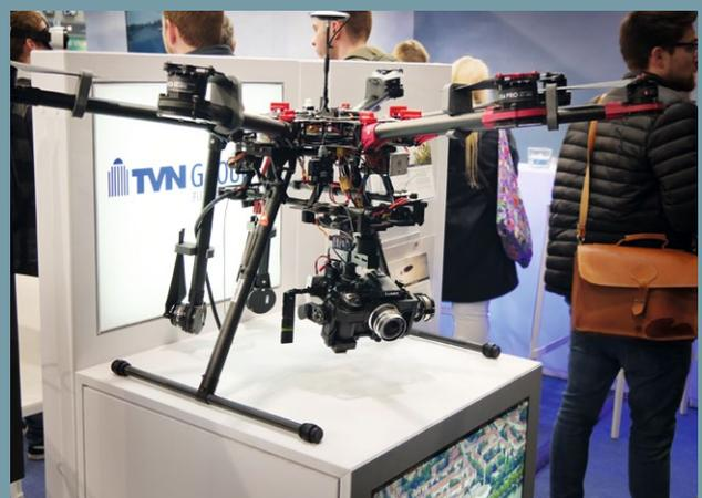
1 W-Lan war gestern: Zumindest wenn es nach den Machern von Globe UAV geht. Diese Drohne wird über das Mobilfunknetz gesteuert. Auf diese Weise kann sie von nahezu jedem Punkt gestartet, geflogen und wieder gelandet werden. Ein spannendes System für Dienstleister, die Inspektions- und Fotoflüge durchführen können, ohne vor Ort sein zu müssen. [www.g-uav.com](http://www.g-uav.com)
