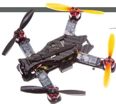
Der kleine Race-Kopter SkyRC Sparrow Racer von Voltmaster hat eine Diagonale von 120 Millimeter und kommt inklusive Motoren, Reglern sowie einer Mini-FPV-Kamera samt FPV-Sender. Geeignet ist er für den In- und Outdorr-Einsatz. Der Preis: 188,10 Euro. [WWW.VOLTMASER.DE](http://WWW.VOLTMASER.DE)
