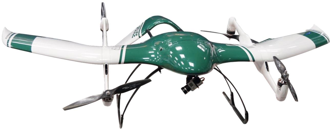
Gebrandet als Einsatz-Drohne der Polizei präsentierte sich diese Ausführung des Wingcopter 178 auf der CeBIT. Ausgerüstet mit einer Action-Cam erreicht die Drohne, die eine Spannweite von 1780 Millimeter hat eine Flugzeit von 2 Stunden sowie eine Maximalgeschwindigkeit von 120 Kilometer in der Stunde. [www.wingcopter.com](http://www.wingcopter.com)
