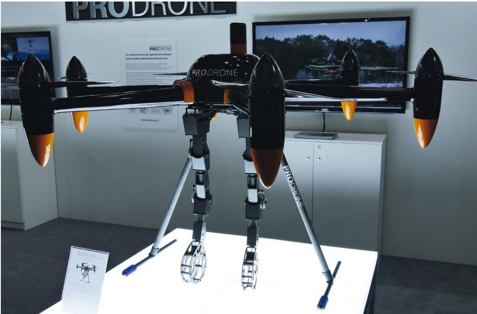
Die Profi-Drohnen von ProDrone sind wahre Technikwunder. Die „Droria“ zum Beispiel verfügt über Arme und kann Lasten mit einem Gewicht von maximal 10 Kilogramm greifen sowie transportieren. Sie hat einen Durchmesser von 1.450 Millimeter, ist bis zu 60 Kilometer in der Stunde schnell und kann 20 Minuten in der Luft bleiben. [www.prodrone.jp](http://www.prodrone.jp)
