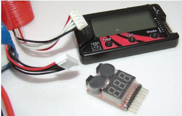
Zum Überprüfen der Akku-Spannung eignen sich diverse auf dem Markt angebotene LiPo-Checker. Das exakte Balancieren der Zellen innerhalb eines Akku-Packs sollte man aber seinem intelligenten Ladegerät überlassen
