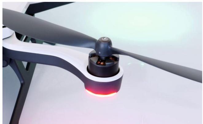
Die Motoren müssen vor dem Start noch mit den Propellern bestückt werden. Diese werden einfach aufgeschraubt
