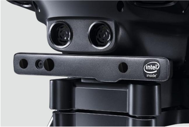
Herzstück der Drohne ist das RealSense-Modul. Es ermöglicht die intelligente Hinderniserkennung
