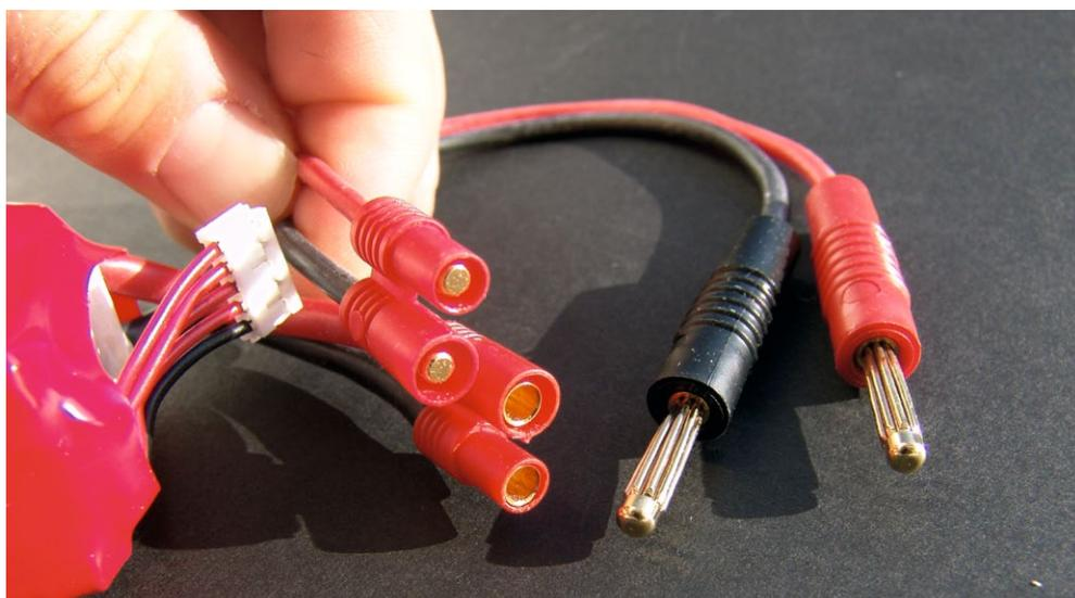
Selbstverständlich sind verpoltsichere und ausreichend dimensionierte Goldkontakt-Stecksysteme Pflicht bei der Nutzung von LiPos
