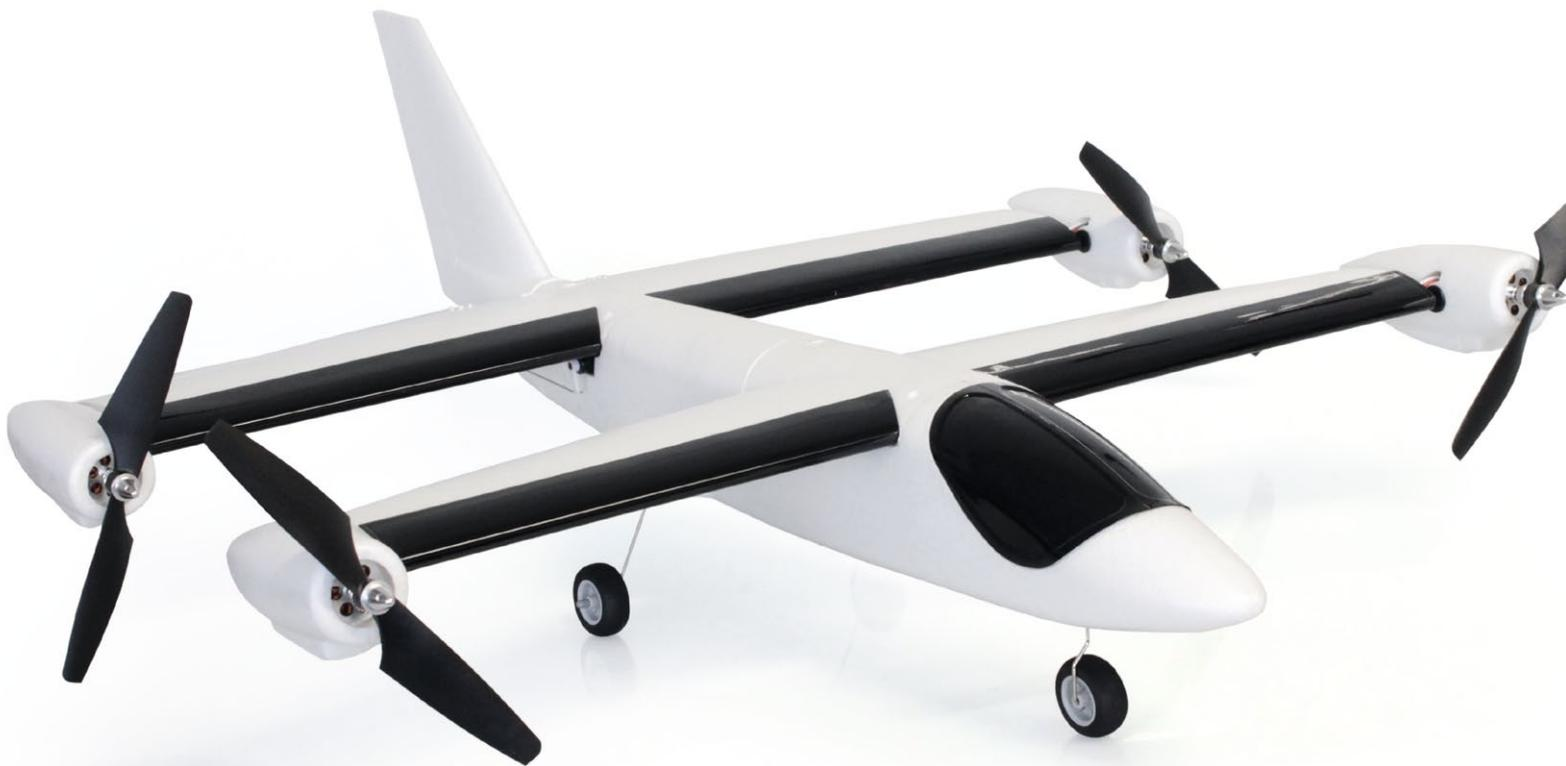
Die Transition mit montierten Propellern und nach vorne gerichteten Motoren
