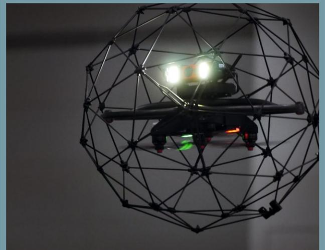
Der Elios von Flyability wurde konzipiert, um Inspektionen in schwer zugänglichen Bereichen durchzuführen. Er ist komplett gekapselt, sodass Wandberührungen der Drohne nichts anhaben können. Er kommt in Pipelines, Rohrleitungen und Schachtsystemen zum Einsatz. [www.flyability.com](http://www.flyability.com)
