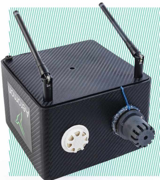
Die BH-8-Sensoreinheit ist ausreichend klein, um per Drohne bewegt zu werden. Kopter mit der Traglast einer Spiegelreflexkamera reichen aus
