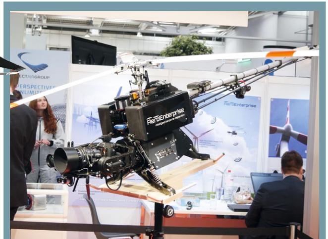
Bei diesem Single-Rotor-System handelt es sich um den Sensorcopter, der für Inspektionsaufgaben konzipiert wurde. Er stammt vom österreichischen Anbieter Aero Enterprise und ist mit einer hochauflösenden Optik ausgerüstet. [www.aero-enterprise.com](http://www.aero-enterprise.com)
