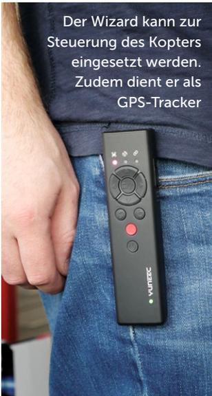
Der Wizard kann zur Steuerung des Kopters eingesetzt werden. Zudem dient er als GPS-Tracker
