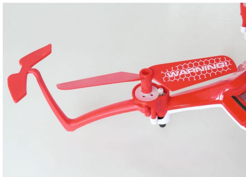
Beide Drohnen sind mit einem Propellerschutz ausgestattet. So führt nicht jede Wandberührung gleich zum Crash
