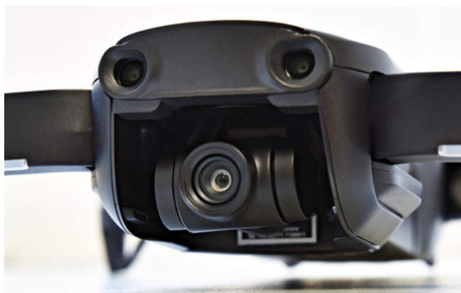
Hier zu sehen: Die zurückgesetzte Kamera an ihrem Dreiachs-Gimbal. Bei Unachtsamkeit oder gar einer Kollision ist die Gefahr der Beschädigung des Gimbals dadurch deutlich verringert
