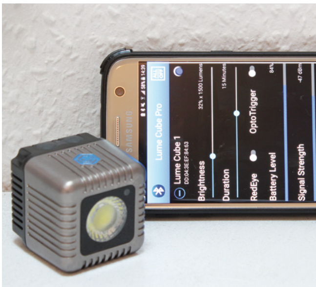
Die Cubes lassen sich mittels App via Bluetooth steuern. Unter anderem kann man die Helligkeit stufenlos einstellen
