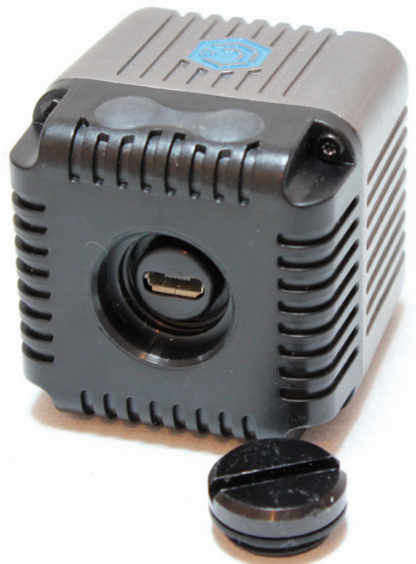
Die Abdeckung des USB-Ladeanschlusses ist verschraubt. Das garantiert eine Wasserdichtigkeit bis 30 Meter
