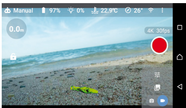
Gesteuert wird der Gladius mittels Sender und Smartphone-App, die neben dem Livebild auch Aufschluss über die Lage des Bootes und verschiedene Telemetriewerte gibt
