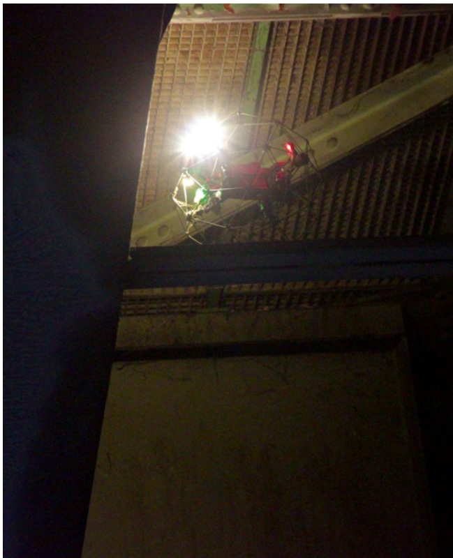
Gut geschützt im sicheren „Käfig“ können auch enge Stellen gefahrlos passiert werden, eine Berührung der Hindernisse hat keine Auswirkungen auf die Flugtauglichkeit der Elios 2
