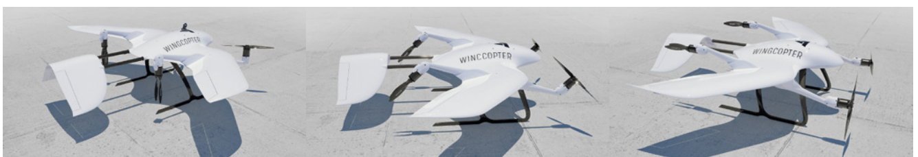
Die Besonderheit des Wingcopters ist die variable Antriebsauslegung. In der Hover-Konfiguration kann das System vertikal starten und landen, in der Transition-Phase beschleunigen und in der Forward Flight-Position die aerodynamischen Vorteile der Flächen ausnutzen
