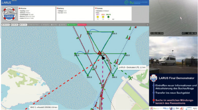
Echtzeit-Lagebild des LARUS-Systems während einer Sektorensuche, welches auf die Brücke des Seenotrettungskreuzers BERTHOLD BEITZ/Station Greifswalder Oie der DGzRS übertragen wurde
