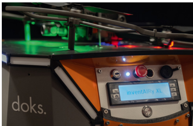
Die Basisstation ist bei InventAIRy XL noch einmal deutlich gegenüber dem Vorgänger verändert und aufgewertet worden. Diese übernimmt die komplette Navigation des Systems und gibt dem „fliegenden Stativ“ die Kommandos
