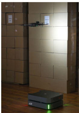
Bei der provisorischen Demonstration in der Hamburger Speicherstadt wurde das Funktionsprinzip deutlich: die Basisstation gibt die Richtung vor, die Drohne folgt den „Befehlen und bewegt sich vor allem vertikal, um die eingelagerten Güter zu scannen
