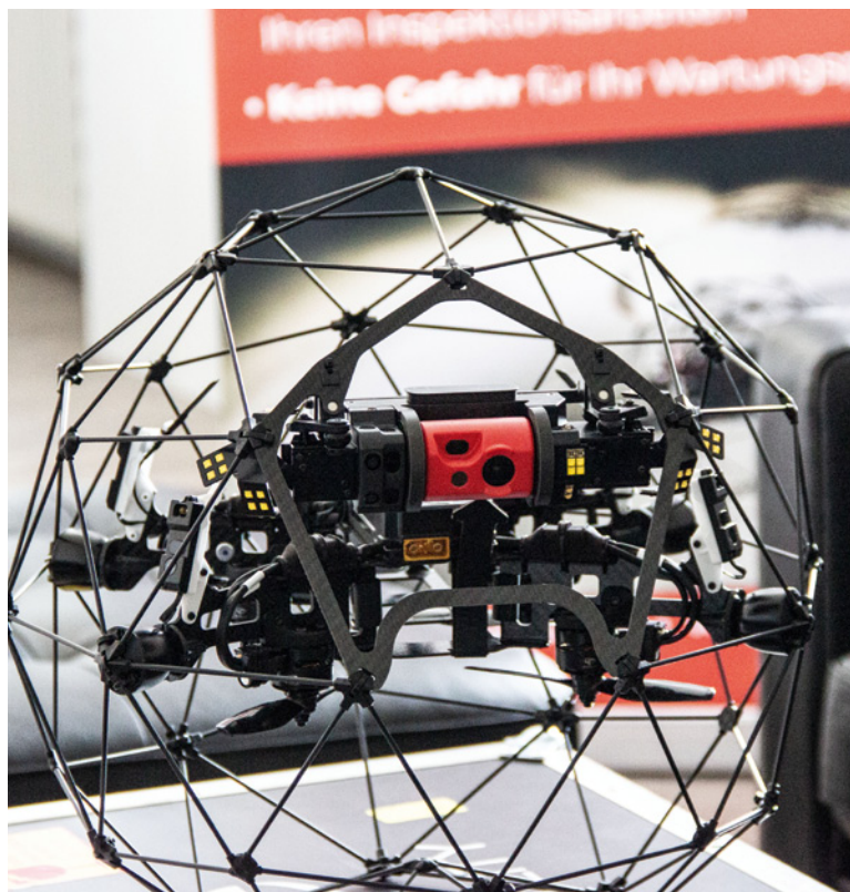
Dank effektiver Beleuchtungsoptionen und der serienmäßig verbauten 4K- und Thermalkamera ist die Elios 2 eine gute Wahl, wenn es um Inspektionsflüge aller Art geht
