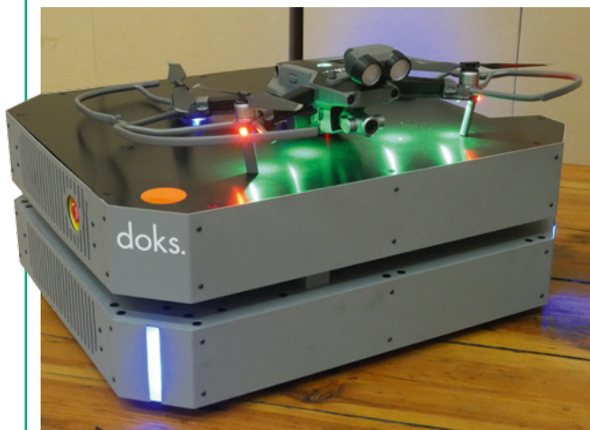
Während man auf „handelsübliche“ Drohnen setzt, steckt die wesentliche Innovation in der AGV getauften Basisstation
