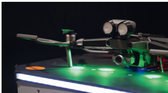
Mit der integrierten Sensorik können Kunden Informationen über Verpackungs- und Palettenqualität sowie mögliche Beschädigungen der Waren erhalten. Und auch versehentlich falsch abgestellt Paletten lassen sich in kurzer Zeit automatisiert finden
