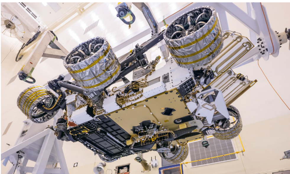
Perseverance von unten. Im Boden ist Ingenuity zu erkennen, die im Rover eingelassen ist und erst an ihrem Startplatz abgesetzt wird
