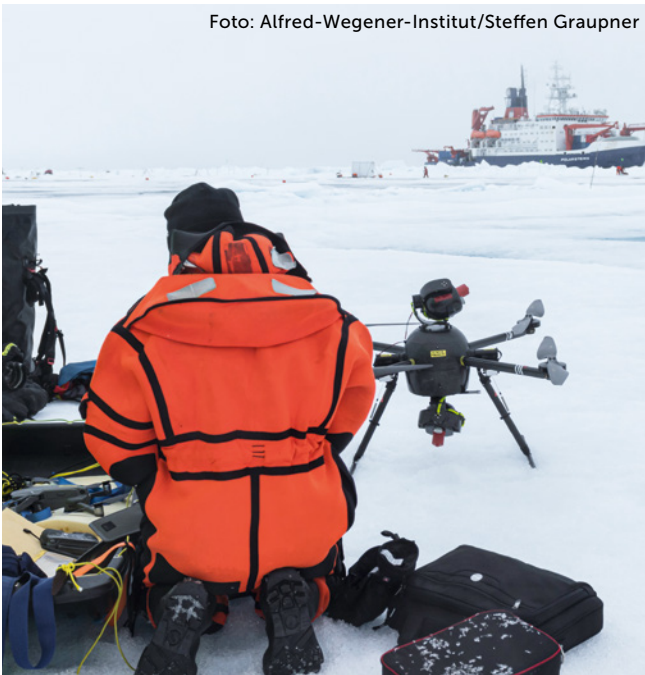
Der häufige Nebel sorgt schnell für gefährliche Eisbildung an den Rotorblättern. Was bei Helikopter-Einsätzen für die Besatzung lebensgefährlich sein kann, sorgt im Falle von wissenschaftlichen Drohnenflügen im schlechtesten Fall für den Verlust des Equipments
