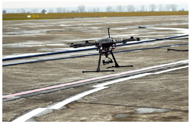
Aufgabe der Forschungsdrohne DexHawk war es, im Umfeld einer Kombination aus realem und virtuellem Drohnenverkehr selbständig eine bestimmte Mission abzufliegen und dabei Konflikte mit dem umgebenden Verkehr im Vorfeld zu erkennen sowie selbständig zu vermeiden
