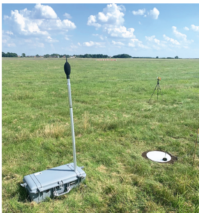
Um die Geräuschentwicklung in Abhängigkeit zur Positionierung der Drohne messen zu können, wurden auf dem Flugplatz Mikrofone verteilt
