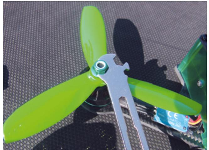
Die Props – wahlweise gibt es Zwei- oder Dreiblatt – werden mit Stoppmuttern befestigt. Das Werkzeug hierzu gehört mit zum Lieferumfang
