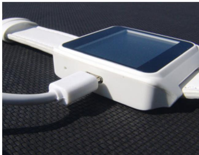
Die USB-Ladebuchse befindet sich auf der linken Gehäuseseite ...
