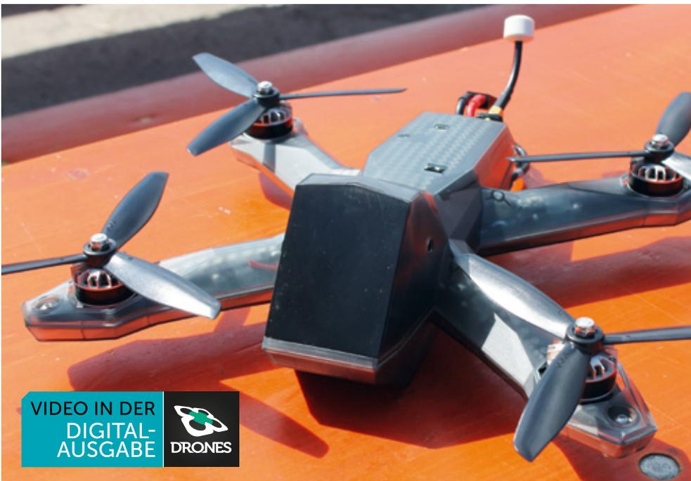
Die optisch signifikanteste Änderung des Racer3 gegenüber seinem Vorgänger ist der Body aus Polycarbonat, der zu einer erheblich größeren Crash-Resistenz geführt hat
