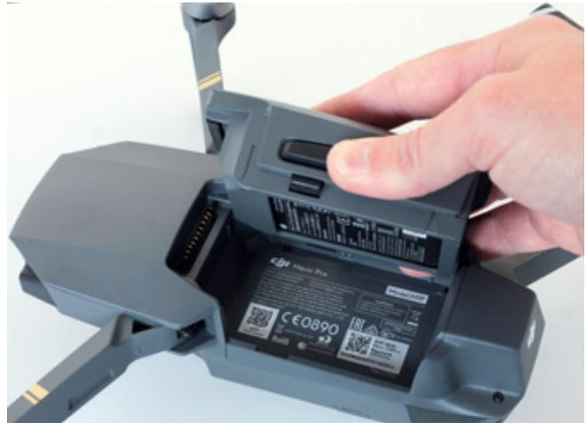
Der Akku wird einfach aufgesteckt. Seine Leistung reicht für eine Flugzeit von rund 25 Minuten
