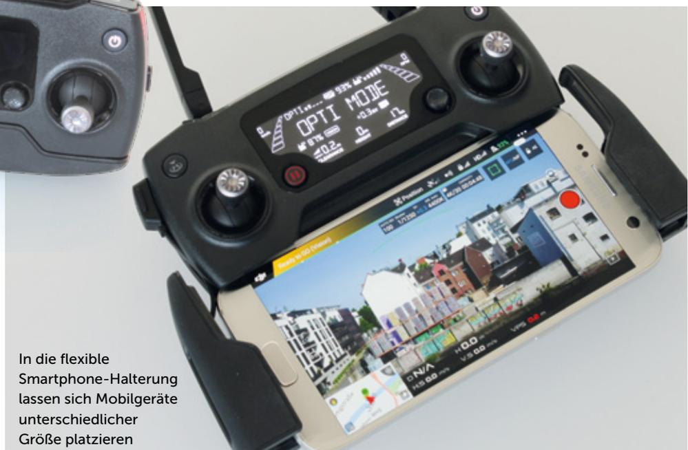
In die flexible Smartphone-Halterung lassen sich Mobilgeräte unterschiedlicher Größe platzieren
