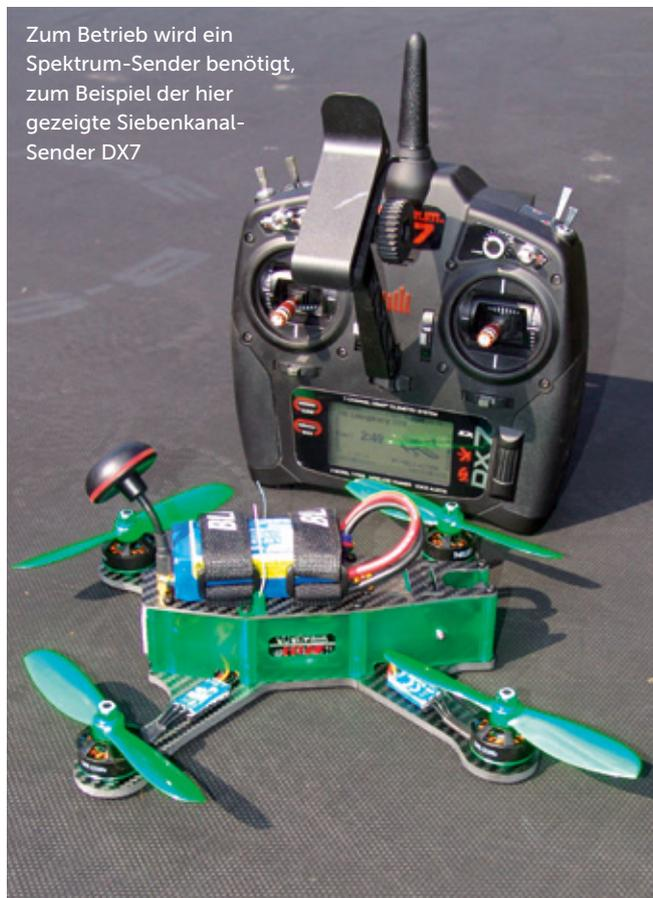
Zum Betrieb wird ein Spektrum-Sender benötigt, zum Beispiel der hier gezeigte Siebenkanal-Sender DX7
