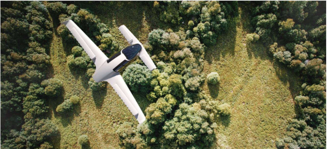
komplett horizontal stehen, wird der gesamte Auftrieb, der benötigt wird, um das Fahrzeug in der Luft zu halten, durch die Luft generiert, die über die Flügelflächen strömt – genau wie bei einem herkömmlichen Flugzeug.
