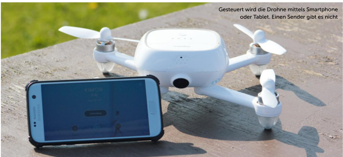
Gesteuert wird die Drohne mittels Smartphone oder Tablet. Einen Sender gibt es nicht
