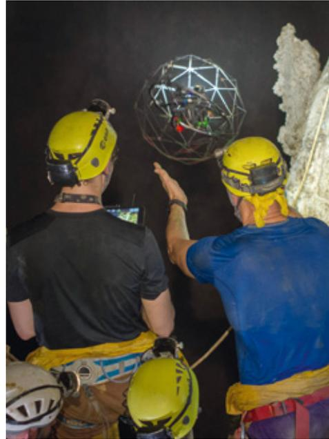
in der Höhlenforschung. Ende Mai wurde Elios bei der Erkundung der La Cucchiara-Höhle auf Sizilien eingesetzt. Bei Temperaturen von über 37 Grad und 100 Prozent Luftfeuchtigkeit untersuchte die Drohne erfolgreich einen 100 Meter tiefen Schacht am Ende des zugänglichen Bereichs der Höhle. [WWW.FLYABILITY.COM](http://WWW.FLYABILITY.COM)
