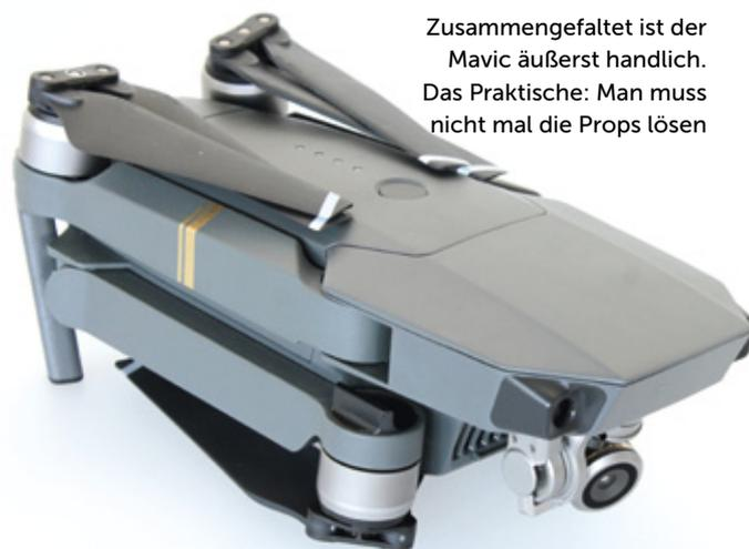
Zusammengefaltet ist der Mavic äußerst handlich. Das Praktische: Man muss nicht mal die Props lösen
