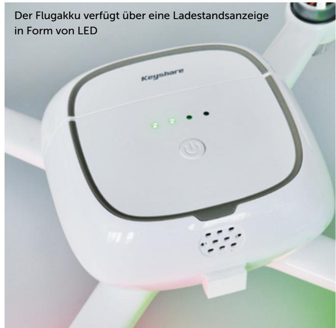
Der Flugakku verfügt über eine Ladestandsanzeige in Form von LED
