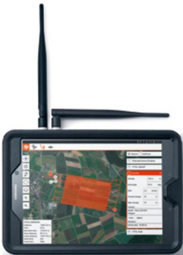
Mithilfe der intuitiv bedienbaren Bodenstation lassen sich Flüge schnell und effektiv planen. Da die Drohne autonom fliegt, gibt es keine besonderen Anforderungen an den Piloten
