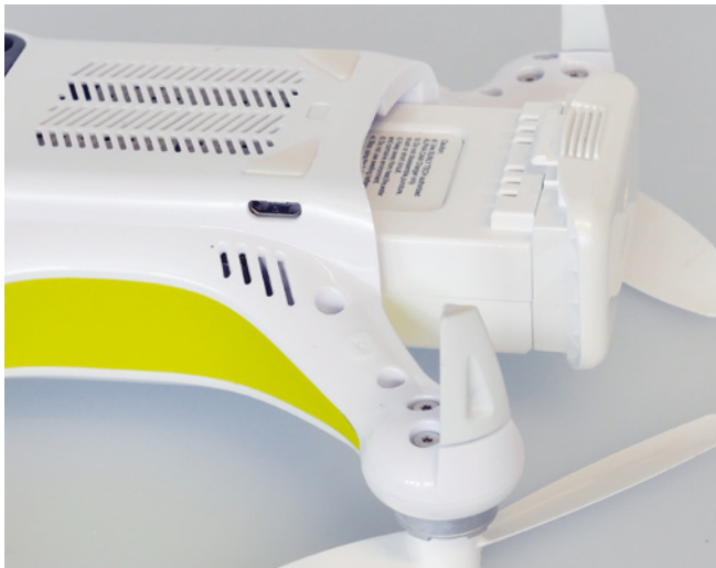
Der Akku wird heckseitig eingeschoben. Über den USB-Port können die Fotos und Videos heruntergeladen werden
