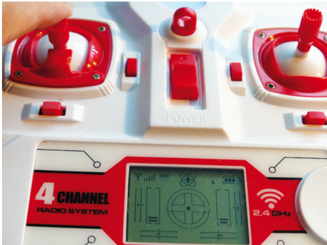
Zur Begrenzung des linken Knüppelweges wurde ein Kunststoffteil mittig angebracht. Das stammt in diesem Fall von einem defekten Sender. Hier sind der Fantasie keine Grenzen gesetzt. Möchte man die Motoren stoppen, führt man den Knüppel seitlich vorbei in Null-Stellung
