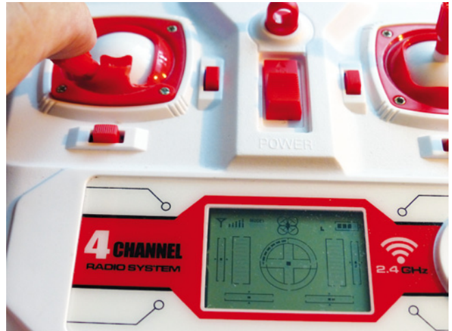
Zur Begrenzung des linken Knüppelweges wurde ein Kunststoffteil mittig angebracht. Das stammt in diesem Fall von einem defekten Sender. Hier sind der Fantasie keine Grenzen gesetzt. Möchte man die Motoren stoppen, führt man den Knüppel seitlich vorbei in Null-Stellung
