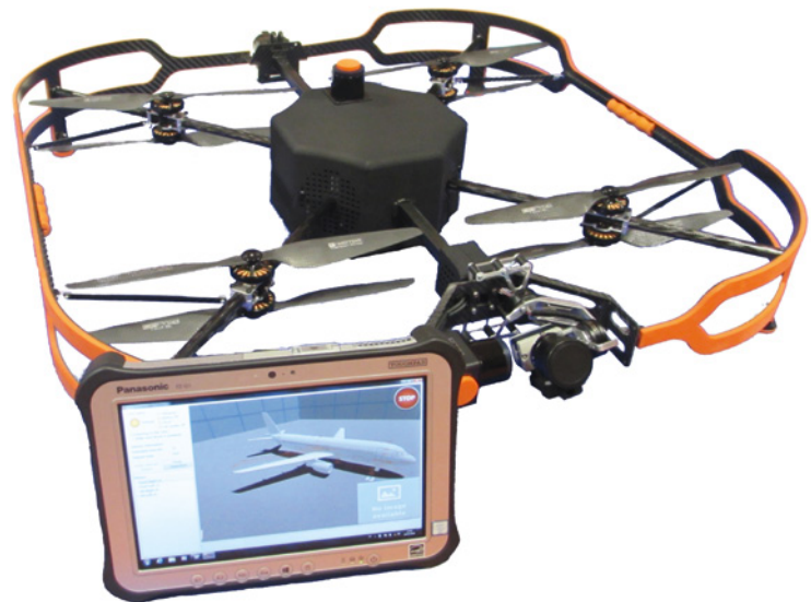
Die Inspektions-Drohne von Airbus agiert autonom und hält mit einem Hinderniserkennungssystem auf Laserbasis Abstand zum Flugzeug
