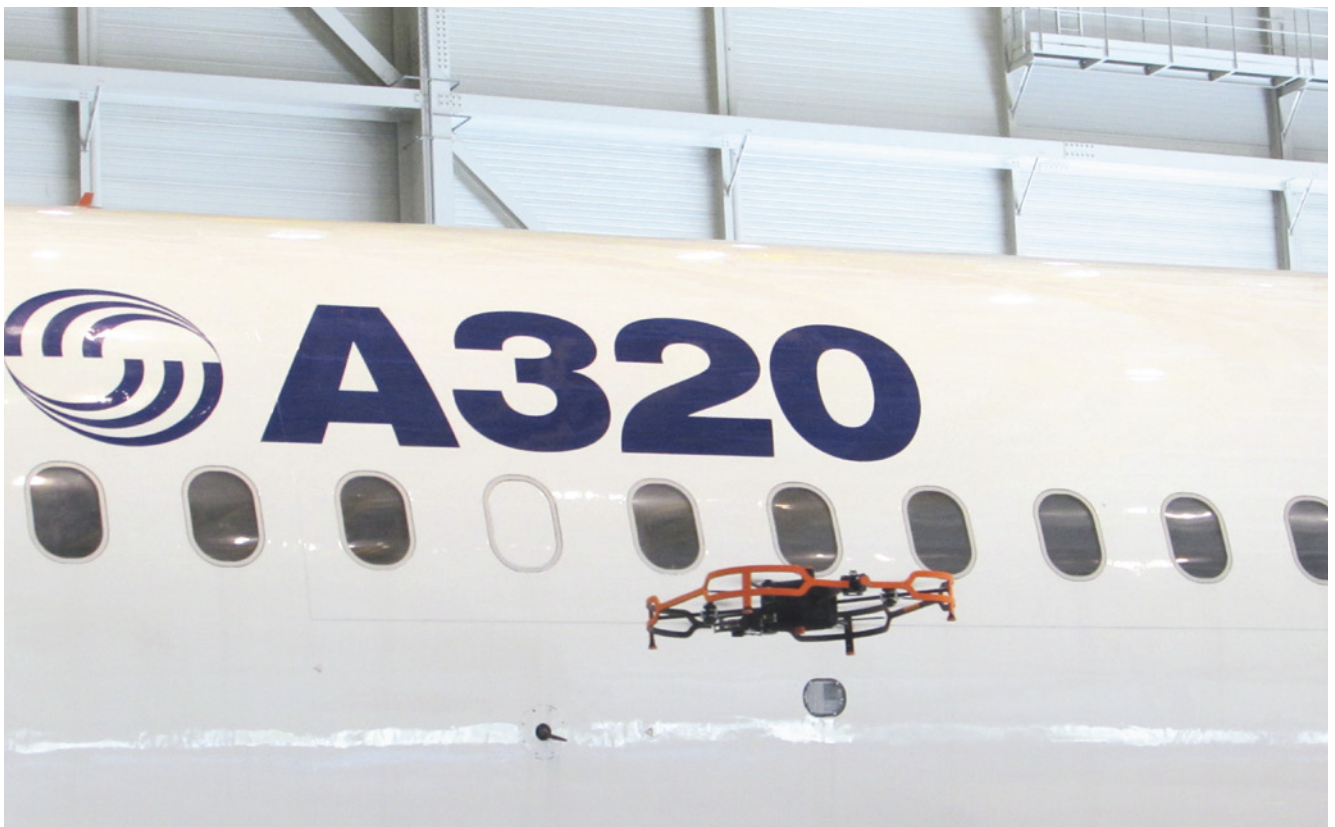
Die Dauer einer Hüllen-Inspektion kann mithilfe der Drohrentechnik von einem Tag auf drei Stunden reduziert werden
