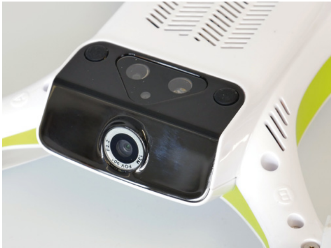
Bei der 13-Megapixel-Cam, die mit bis zu 4K aufnehmen kann, handelt es sich um eine festverbaute, nicht mechanisch stabilisierte Knopfkamera
