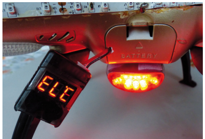
Der LiPo-Checker am linken Landegestell ist mit Klebeband befestigt. Das Balancerkabel wurde durch eine kleine Aussparung im Deckel des Batteriefachs herausgeführt
