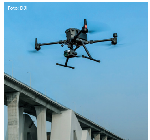
Die Drohnenplattform Matrice 300 RTK von DJI soll insbesondere für Inspektion, Mapping und BOS-Einsätze konzipiert sein
