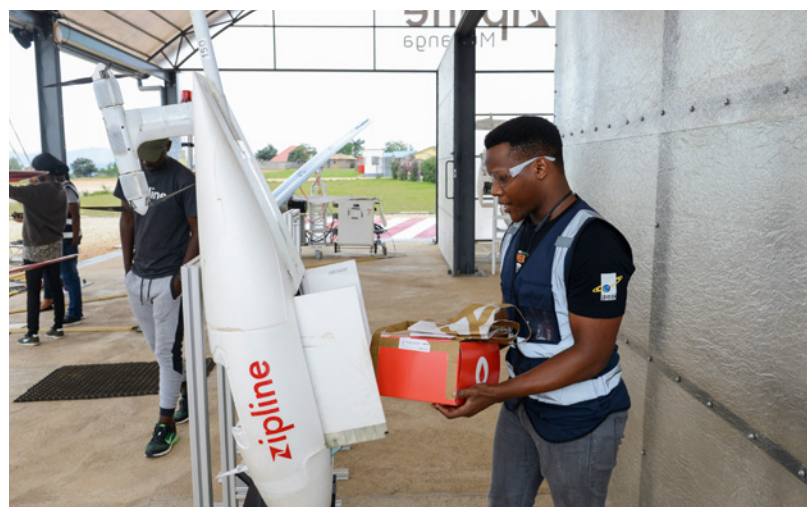
Bei einer Tragfähigkeit von etwa 1.750 Gramm können die Flächendrohnen bis zu drei Blutkonserven auf einmal transportieren. Bei umfangreicheren Bestellungen werden mehrere Drohnen "parallel" zum selben Zielort geschickt
