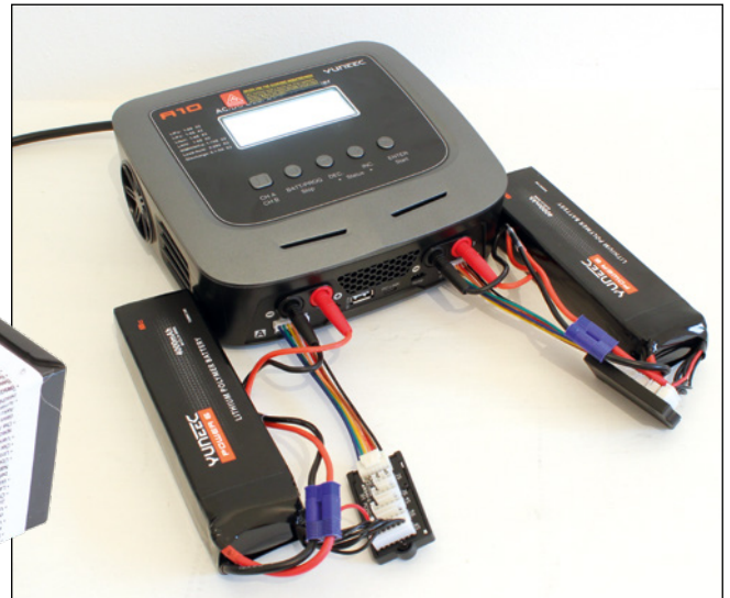
Beim Laden von Akkus ist es extrem wichtig, mit den passenden Parametern zu laden. Vor allem, wenn man parallel zwei leistungsstarke Lithium-Akkus lädt
