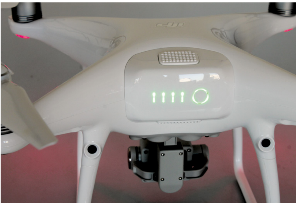
Systemakkus wie die von Marktführer DJI verfügen standardmäßig über eine Reihe technischer Features – Ladestandsanzeige und Zellenüberwachung
