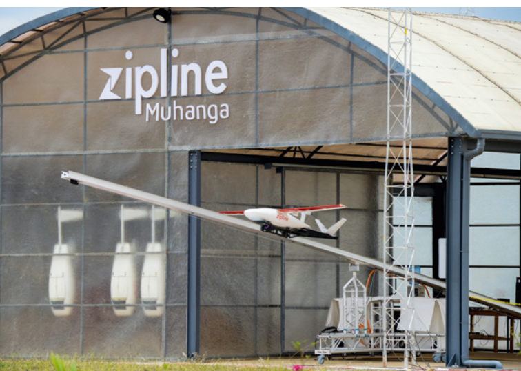
Per Knopfdruck beschleunigt die Zipline-Drohne auf der kurzen Startrampe und macht sich automatisch auf den Weg zum Zielort
