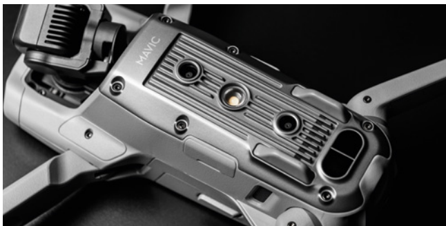
Wie üblich bei DJI-Drohnen, finden sich auf der Unterseite einige Sensoren. Außerdem sitzt hier eine zuschaltbare LED, damit die Sichtsysteme auch bei schlechten Lichtverhältnissen optimal arbeiten können
