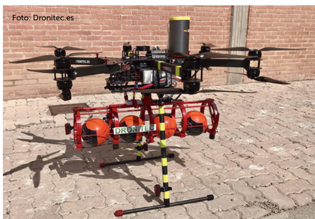
Feuerlöschdrohnen müssen nicht bodengebunden sein. Dieses System von Dronitec setzt auf ein Abwurfssystem für Löschbälle
