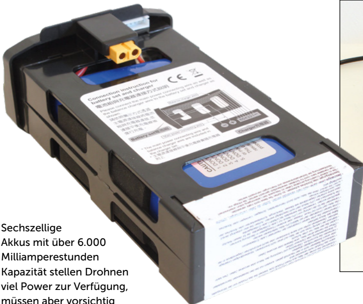
Beim Laden von Akkus ist es extrem wichtig, mit den passenden Parametern zu laden. Vor allem, wenn man parallel zwei leistungsstarke Lithium-Akkus lädt
