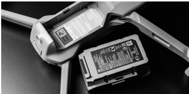
Der 3.500-Milliamperestunden-Akku ermöglicht eine Flugzeit von rund 30 Minuten
