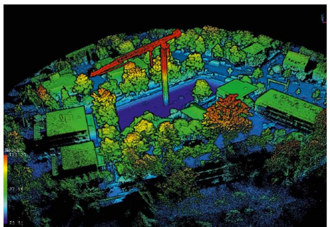
Beim Bau eines Mehrfamilienhauses mitten in Wien wurden die örtlichen Gegebenheiten detailliert per LiDAR-Vermessung dokumentiert
