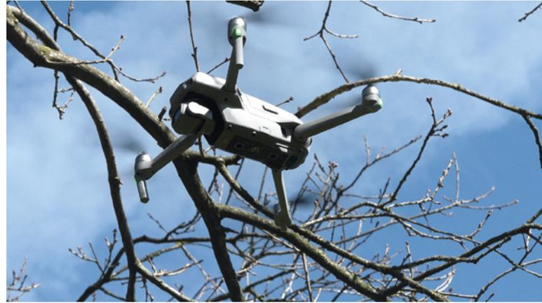
Dank nach oben gerichteter Hinderniserkennungssensoren stoppt die Air 2S den Steigflug rechtzeitig und vermeidet eine Kollision. Beispielsweise bei der Inspektion von Brücken oder auch Balkonen ein wichtiges Feature
