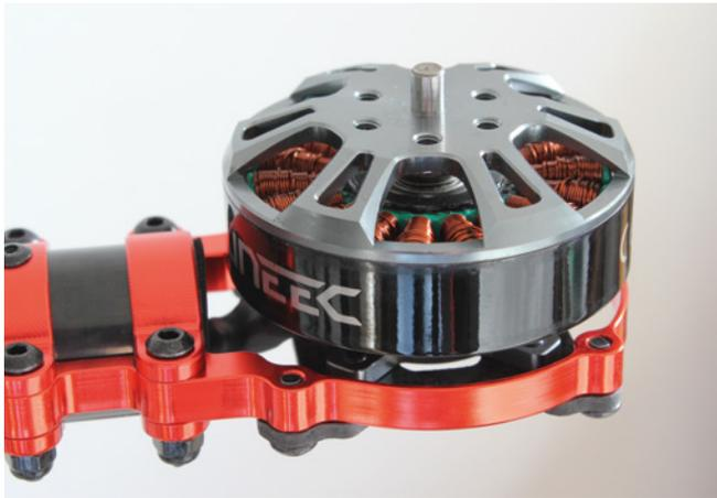
Ohne leistungsstarke Permanentmagnete aus Neodym – einem Seltenerdmetall – wären Elektromotoren in der Form, in der sie heute existieren, nicht denkbar. Hier das Aggregat eines Tornado H920 von Yuneec
