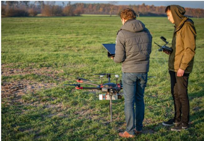
In der Projektplanung und -dokumentation sind LiDAR-Sensoren eine große Hilfe, weil sich mit ihnen hochpräzise Oberflächenmodelle erstellen lassen
