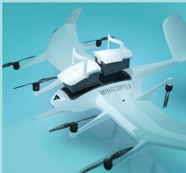
Die Akkus lassen sich einfach wechseln, sodass die Drohne nach Beendigung eines Einsatzes direkt wieder startklar gemacht werden kann
