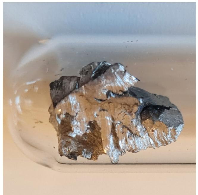
Elementares Neodym ist selten und kann dauerhaft nur unter Argon-Atmosphäre gelagert werden, da es an den Schnittkanten ansonsten schnell oxidiert
