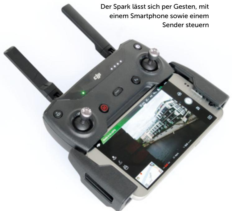
Der Spark lässt sich per Gesten, mit einem Smartphone sowie einem Sender steuern
