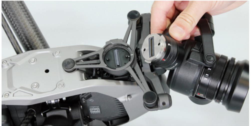
Die Montage der Zenmuse X5S ist simpel: aufsetzen, drehen, fertig. Zunächst muss der Kopter jedoch aus dem Transport- in den Landemodus gebracht werden
