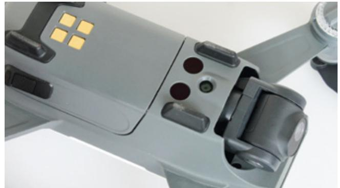
Im vorderen Bereich: das nach unten gerichtete Sichtsystem des Spark. Dahinter befindet sich der Flugakku
