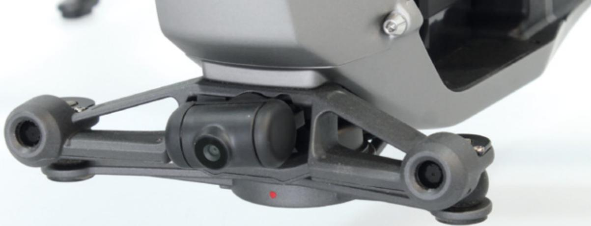
Die über zwei Achsen stabilisierte FPV-Kamera garantiert dem Piloten nicht nur dauerhaft den Blick nach vorne, sie ist auch Teil des Sichtsystems
