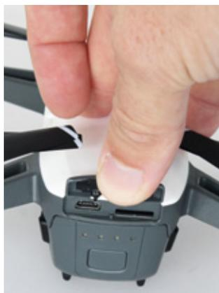
Neben einem Micro-SD-Kartenslot ist auch ein Micro-USB-Anschluss für den Kontakt zum PC verbaut
