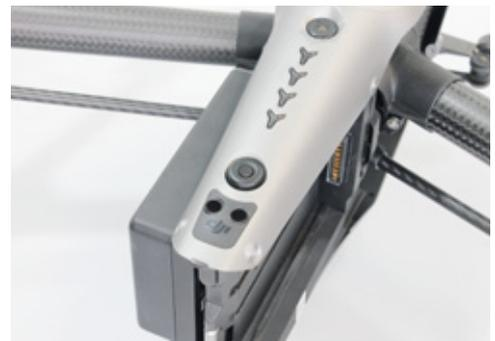
Auf beiden Seiten des Hecks findet ein sechszelliger Flugakku Platz. Schiebt man sie ein, arretieren sie sich automatisch
