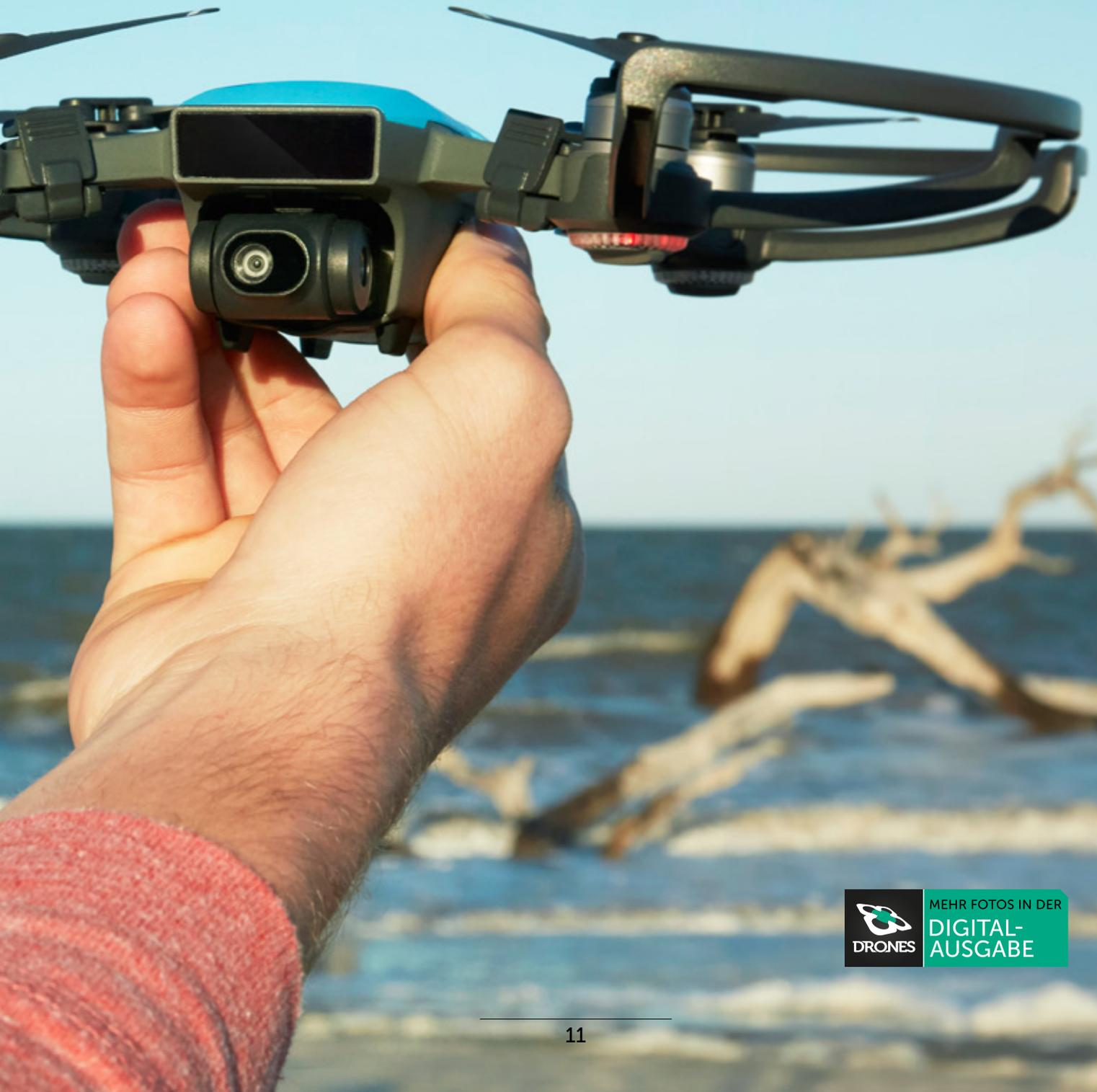
Der Balken über der Gimbal-Cam ist das 3D-Sensorsystem, das zur Kollisionsvermeidung dient und die Gestensteuerung ermöglicht
