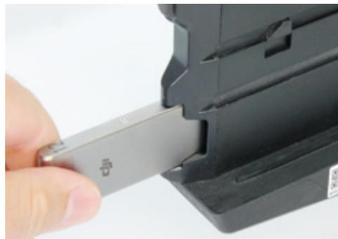
Wer 5,2K-Aufnahmen machen möchte, muss sich eine SSD kaufen. Diese wird dann einfach in den Slot am Heck eingeschoben
