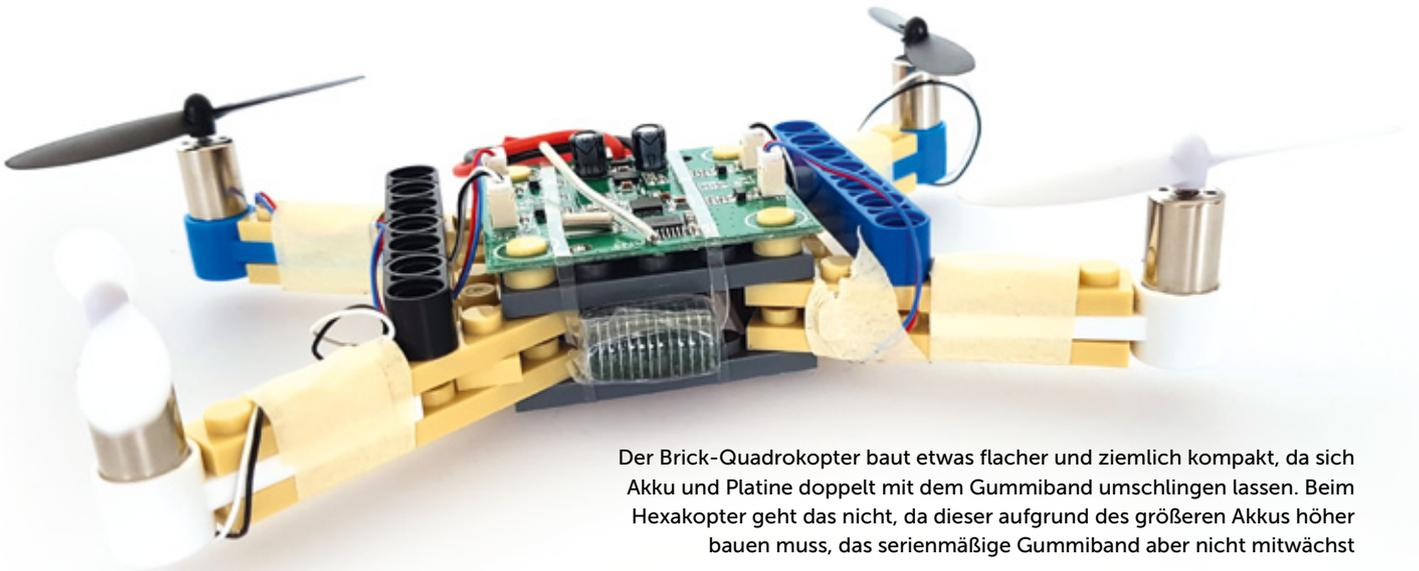
Der Brick-Quadrocopter baut etwas flacher und ziemlich kompakt, da sich Akku und Platine doppelt mit dem Gummiband umschlingen lassen. Beim Hexakocter geht das nicht, da dieser aufgrund des größeren Akkus höher bauen muss, das serienmäßige Gummiband aber nicht mitwächst
