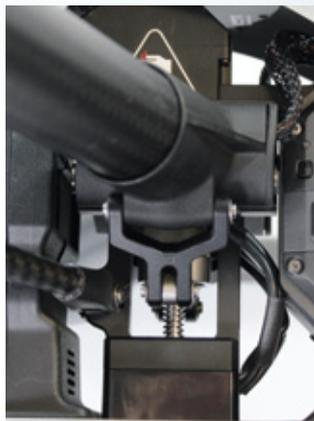
Die Fahrwerksmechanik sorgt dafür, dass der Inspire innerhalb von Sekunden vom Lande- in den Flugmodus wechseln kann
