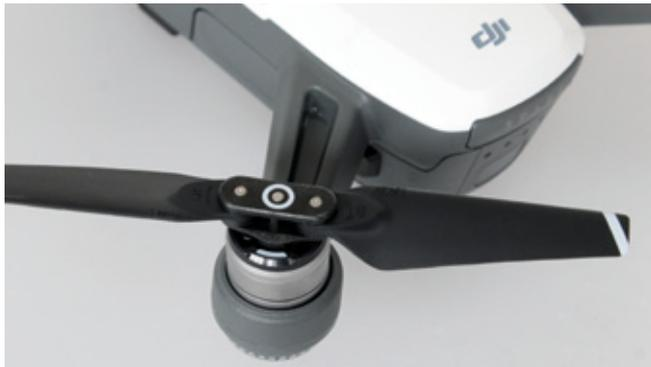
Die klappbaren Props verfügen über ein Schnellwechselsystem – lassen sich in Sekundenschnelle lösen und wieder aufsetzen
