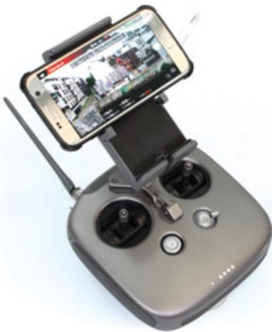
Der Sender des Inspire 2 wird über ein USB-Kabel mit einem Smartphone oder Tablet gekoppelt. In Kombination mit der DJI Go-App ergibt dies eine vielseitige Kontrollstation
