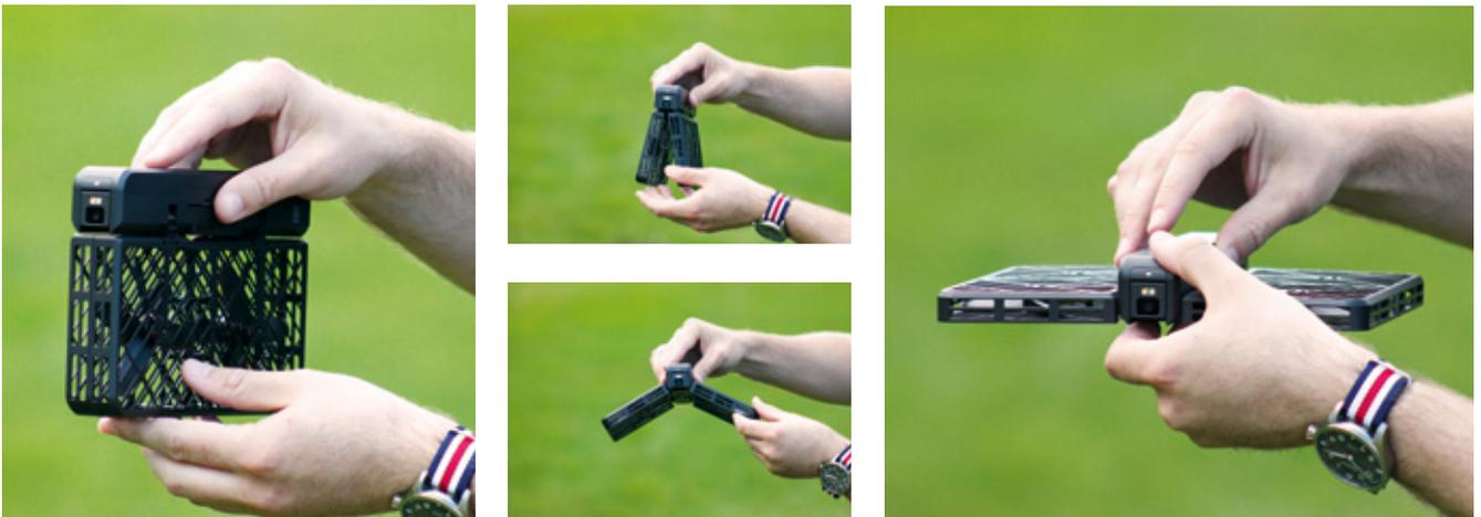
Um die Drohne startbereit zu machen, wird sie zunächst angeschaltet. Steht die Verbindung zur App – einfach aufklappen und aus der Hand starten
