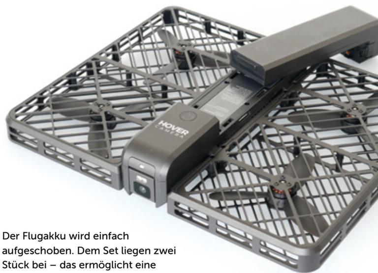
Der Flugakku wird einfach aufgeschoben. Dem Set liegen zwei Stück bei – das ermöglicht eine Gesamtflugzeit von rund 20 Minuten. Die beiden Akkus, die zum Set gehören, lassen sich über den Doppellader befüllen
