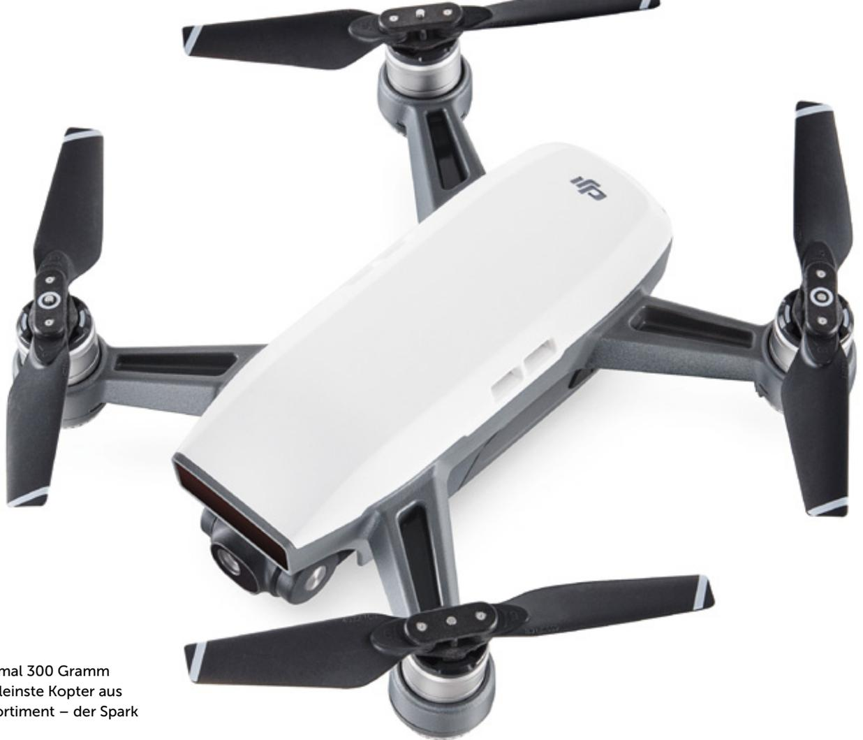
Gerade einmal 300 Gramm wiegt der kleinste Kopter aus dem DJI-Sortiment – der Spark
