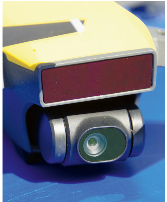
Während die Kamera beim Breeze (links) um eine Achse schwenkbar ist – die Stabilisierung des Kamerabildes erfolgt elektronisch –, verfügt der Spark über ein Dreiachs-Gimbal
