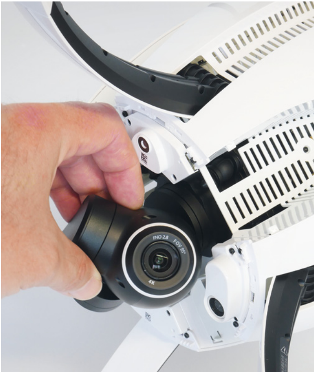
Die verbaute Gimbal-Kamera ist mit ihrem 1/2,3-Zoll-CMOS-Sensor in der Lage, Videos in 4K aufzunehmen
