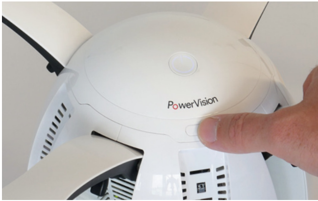
Der Knopf an der Stirnseite der Drohne öffnet die Haube und gewährt Zugang zum Akkuschacht
