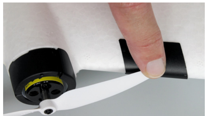
Eine Armierung der Fläche mit einem Plastikschutz verhindert wirkungsvoll Schäden am Schaummaterial
