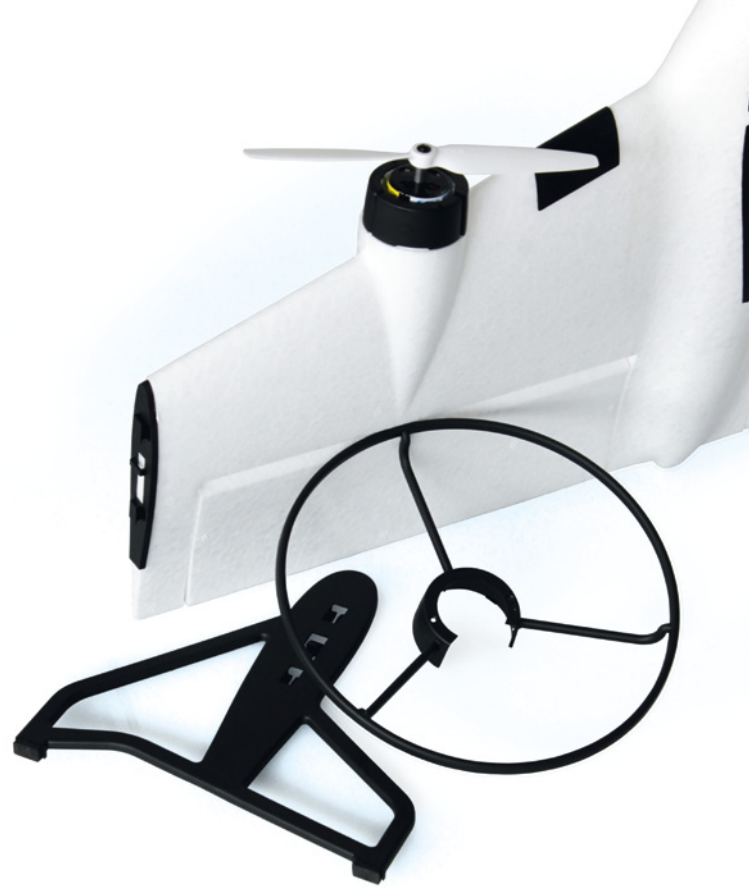
Ohne die seitlich anzubringenden Ständer lassen sich die VTOL-Qualitäten des X-Vert nicht voll nutzen
