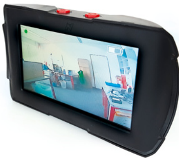
Der LED-Bildschirm überträgt das Live-Bild der Cam. Er kann in Kombination mit der Brille oder allein verwendet werden
