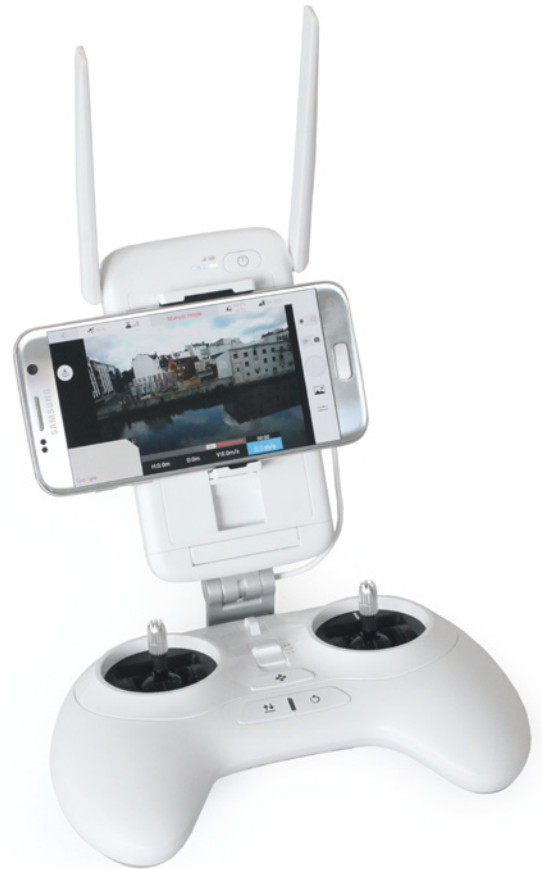
Der Sender und die Base-Station samt verbundenem Smartphone: Beide Geräte werden miteinander gekoppelt. Das ergibt eine leider recht schwere, kopflastige Sendeanlage
