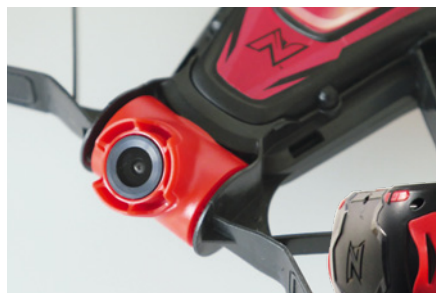
Die FPV-Kamera kann manuell eingestellt werden – für Flüge mit hohem Anstellwinkel
