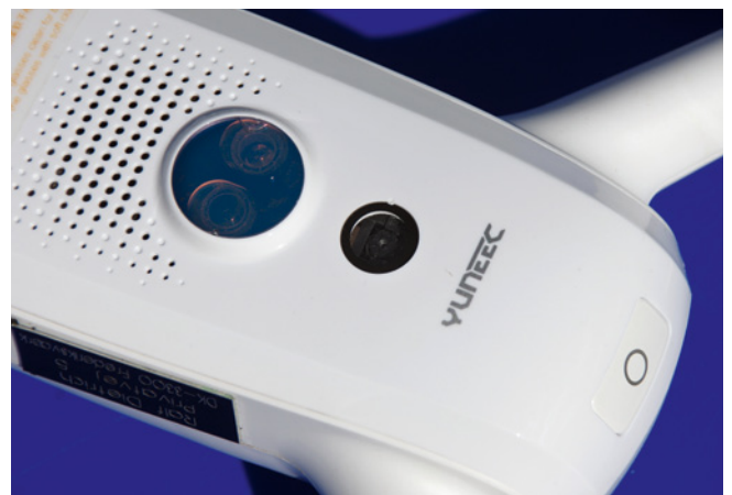
Sowohl Spark (oben) als auch Breeze verfügen über ein nach unten gerichtetes Sichtsystem. Beide funktionieren, DJI hat hier den Vorteil des jüngeren Produktes
