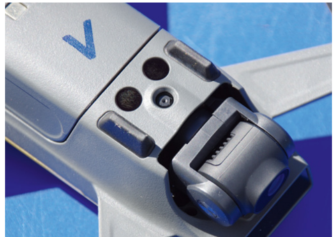
Während die Kamera beim Breeze (links) um eine Achse schwenkbar ist – die Stabilisierung des Kamerabildes erfolgt elektronisch –, verfügt der Spark über ein Dreiachs-Gimbal
