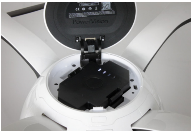
Der Flugakku wird senkrecht in den Schacht gesteckt und verfügt über eine Füllstandsanzeige mittels LED
