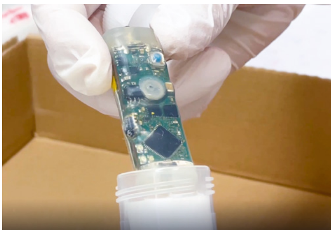
Ein Datenlogger zeichnete auf, welche äußeren Einflüsse während der verschiedenen Transportmethoden auf die Blutproben einwirkten
