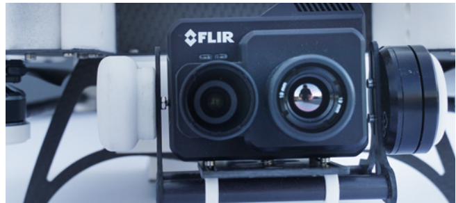
Während in der Standard-Variante der „Buddy“-Drohne Kamertechnik von Flir verbaut ist, soll für RescueFly eine Wiris Pro aus der UAV-Serie von Worswell zum Einsatz kommen
