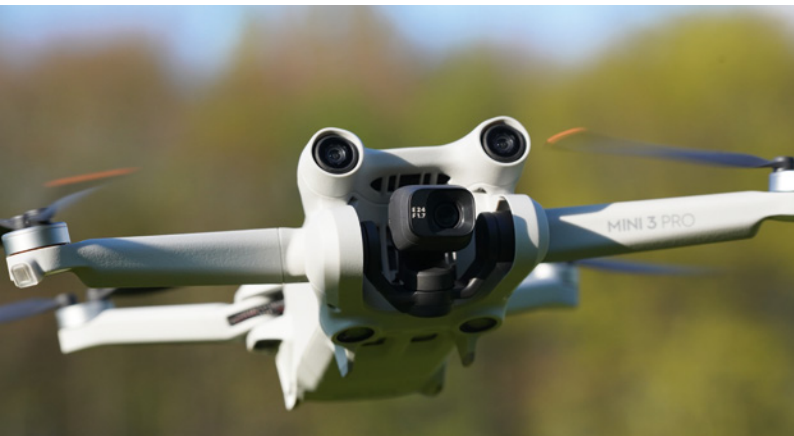
Neues Gehäuse mit Hinderniserkennungssensoren und neue Kamera mit mehr Lichtstärke und höherwertigem Sensor
