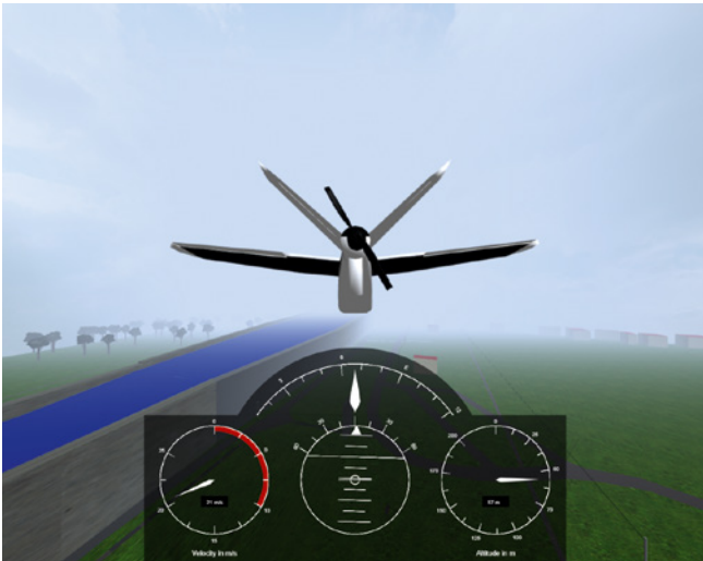
Im Simulator lassen sich mit der Lehr- und Forschungsdrohne Talon verschiedene Reglerstrukturen bis hin zum vollständigen Autopiloten testen
