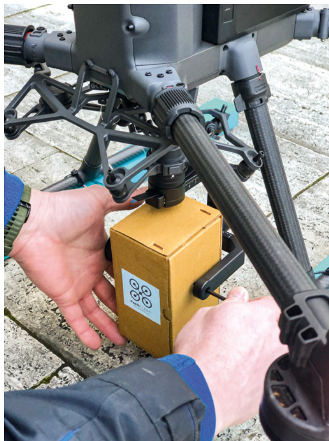
Ein Drittel der Proben wurde unter Einsatz eines vibrationsdämpfenden Gimbals transportiert
