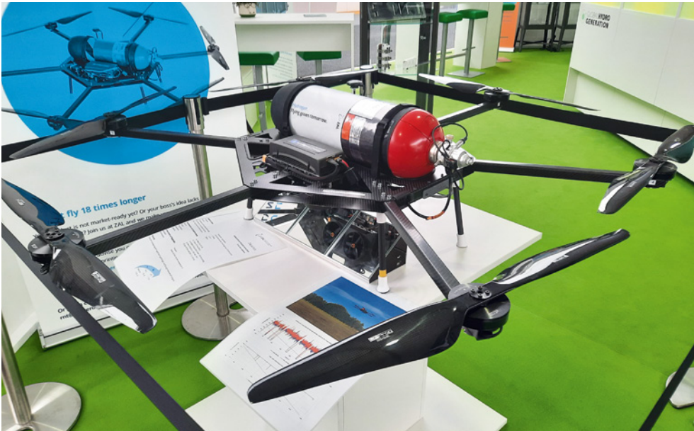
Der Hexakopter ZALbatros ist eine Forschungs- und Entwicklungsplattform aus dem Zentrum für Angewandte Luftfahrtforschung (ZAL). Die sechs Motoren werden von zwei Brennstoffzellensystemen mit jeweils 800 Watt Dauerleistung versorgt, der Wasserstoff wird in einem zentralen Tank mitgeführt
