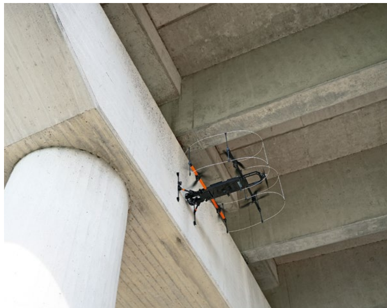
Ist eine vertikale Messung erforderlich, sorgt ein eigens montierter Antrieb im Heck für ausreichend Anpressdruck
