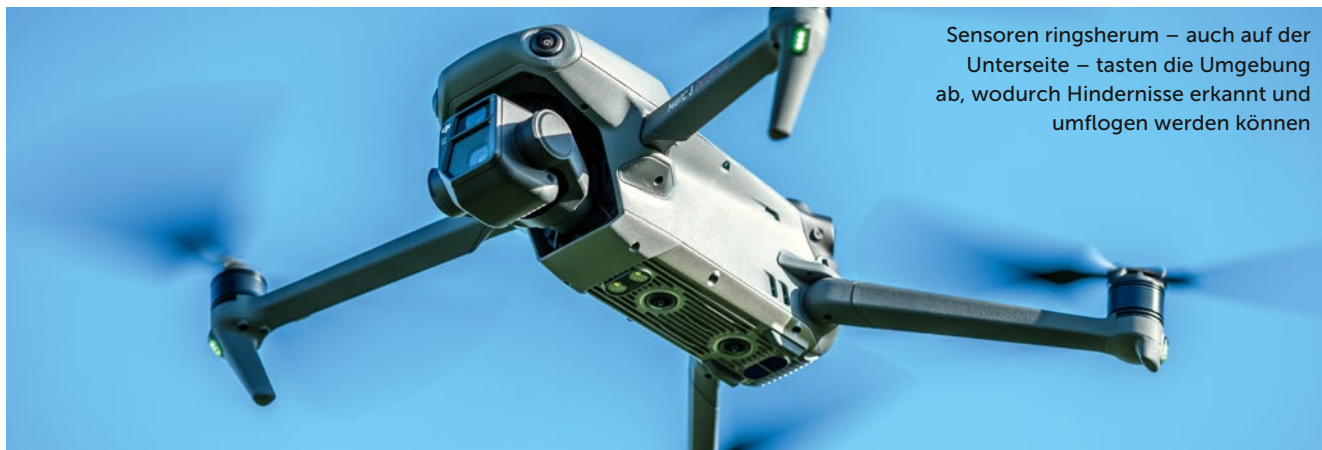
Knapp 1 Kilogramm Abfluggewicht und geringe Abmessungen machen die Mavic 3E zum kompakten Begleiter
