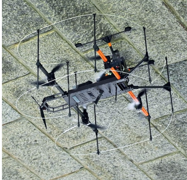
Eine spezielle Konstruktion sorgt dafür, dass die Drohne sich plan an das Bauwerk anschmiegt und den Sensorkopf im richtigen Winkel an der zu untersuchenden Oberfläche ausrichtet
