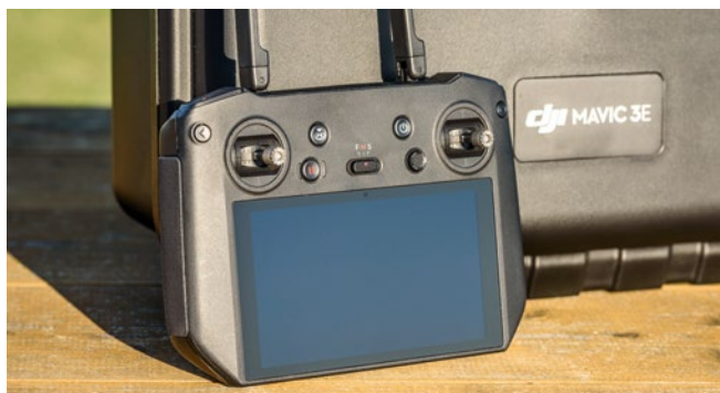
DJI RC Pro Enterprise heißt die mitgelieferte Fernsteuerung. An ihr lässt sich über ein Mini-HDMI-Kabel auch ein externer Monitor anschließen
