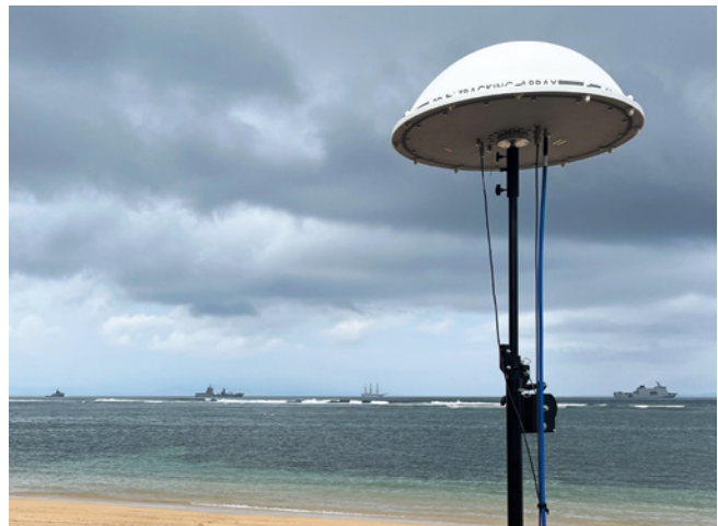
Eine Antenne des Typs IsoLOG 3D kam als Teil des Aartos-Systems an der balinesischen Küste zum Einsatz
