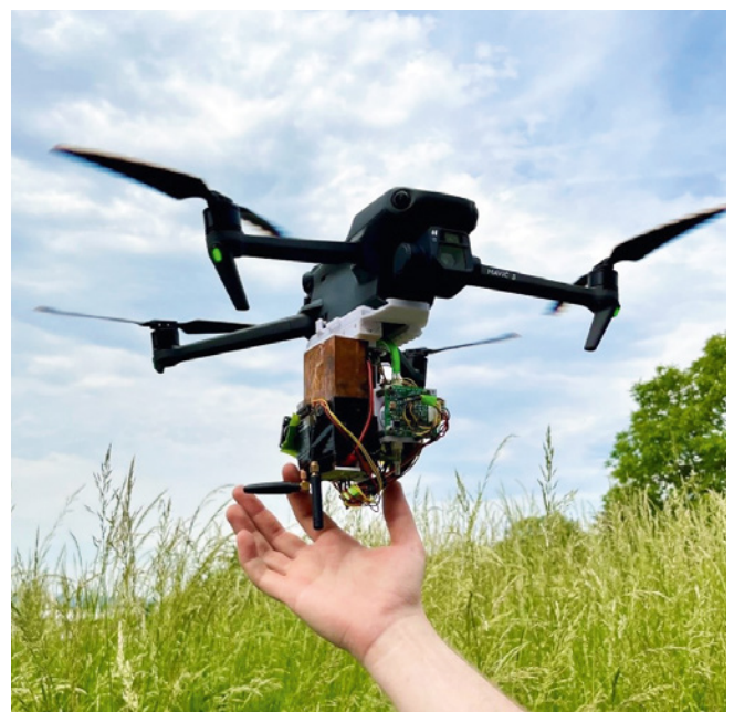
Die mit der erforderlichen Detektionssensorik ausgestattete Forschungsdrohne Little Raven bei einem Flugtest in Mainz
