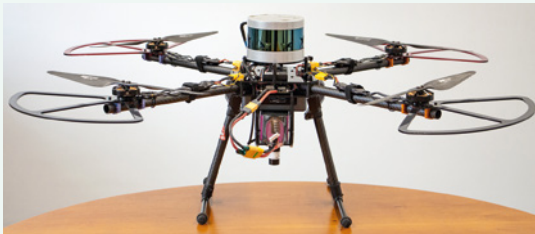
Die am Institut für Integrierte Produktion Hannover entwickelte Indoor-Drohne kann sich selbständig in unbekanntem Innenräumen bewegen
