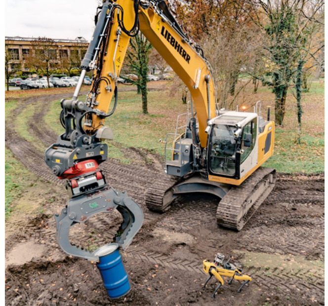
Das Fraunhofer IOSB hat einen 24 t Bagger umgerüstet, der mit Hilfe eines wachsenden Roboter-Vierbeiners Dekontaminationsaufgaben übernehmen soll
