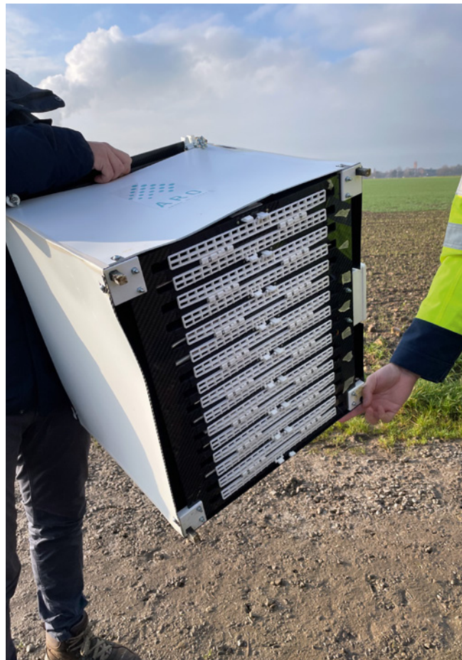
Das Zeitungsmagazin ist eine Spezialanfertigung, die bis zu 16 einzeln verpackte Sendungen abwerfen kann
