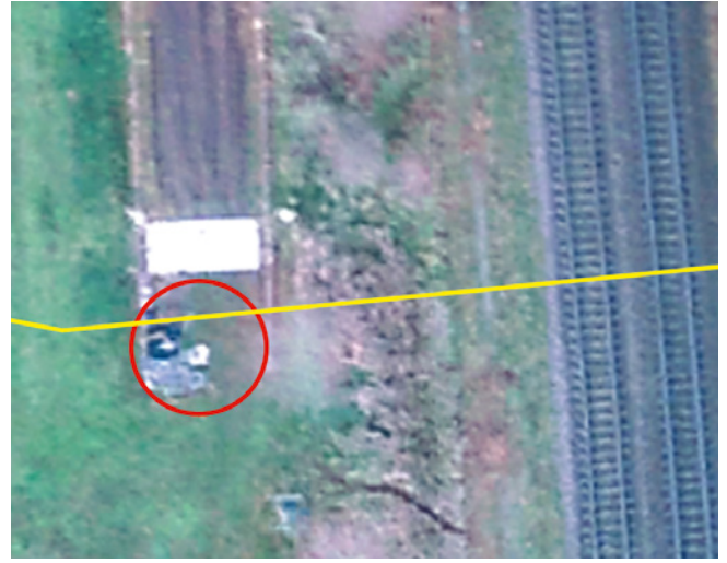
Auf den Bilddaten lassen sich Veränderungen im Verlauf der unterirdischen Pipeline gut erkennen, auswerten und im Zweifel eine direkte Sichtung per Ortstermin organisieren. In diesem Fall stellt oberirdische Lagerung von Material keine Gefahr dar, auch die zwischenzeitliche Bewegung der Elemente ist nicht sicherheitskritisch
