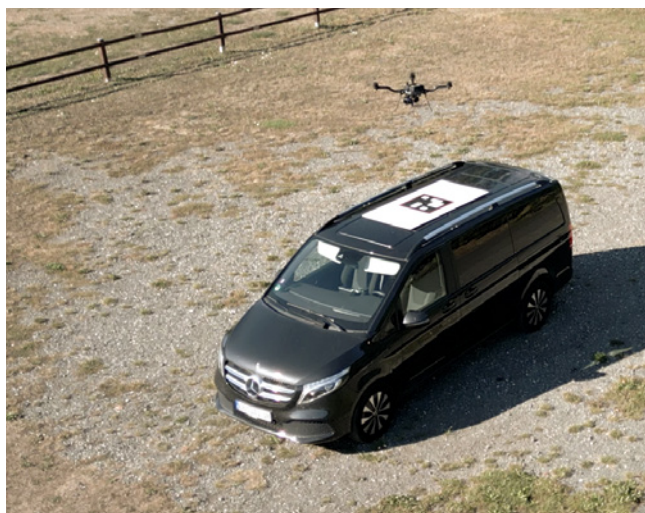
Das Precise Landing basiert auf einem optischen Schlüsselreiz, der von einer nach unten gerichteten Kamera erkannt wird
