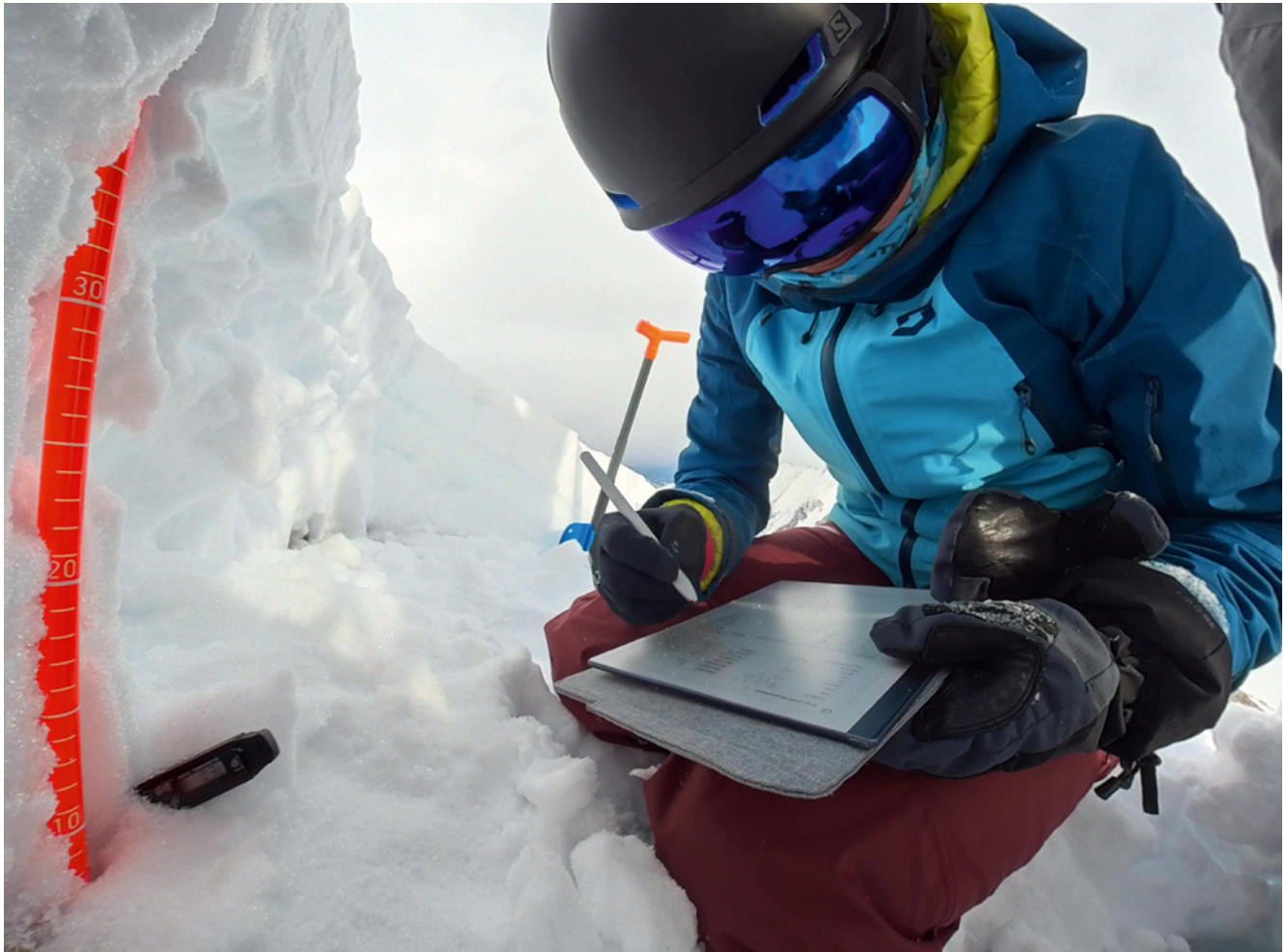
Um die Radarmessungen zu überprüfen, müssen im Projektverlauf noch klassische Schneeprofile erstellt werden
