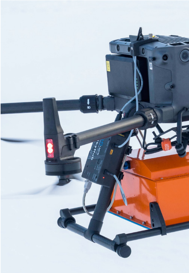
UgCS SkyHub ist ein Bordcomputer, mit dem die Fähigkeiten handelsüblicher Drohnen für professionelle Anwendungen verbessert und eine vielfältige Sensorintegration unterstützt werden sollen
