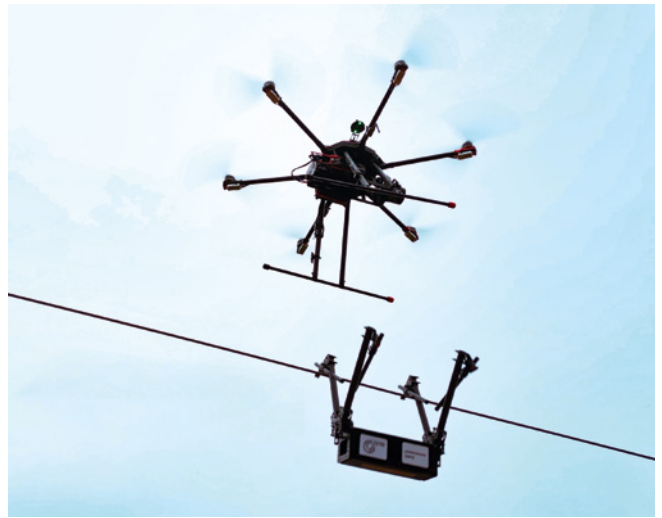
Nach dem Abwurf krallt sich das Sensorgehäuse durch Widerhaken an den Beinen an der Leitung fest und baumelt so lange kopfüber an der Leitung, bis die Messungen beendet sind
