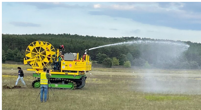
Das ferngesteuerte Raupenfahrzeug CT25 wird mit einer Löschplattform ausgerüstet, um schwer zugängliche Brandherde zu bekämpfen
