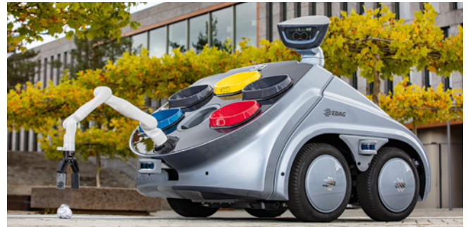
Dank KI sollen die CityBots nicht nur Objekte erkennen und greifen können, auch die Materialerkennung und anschließende Mülltrennung soll realisiert werden
