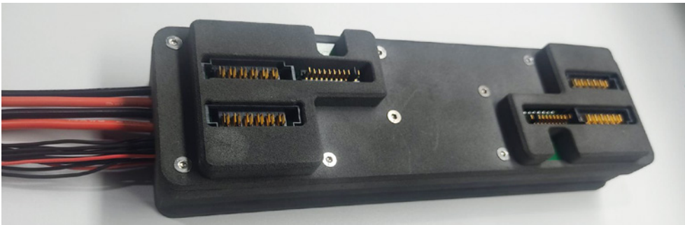
Mithilfe von SLS-3D-Druck kann Nextech Halterungen für Methansensoren herstellen, die dem individuellen Bedarf ihrer Kunden entsprechen
