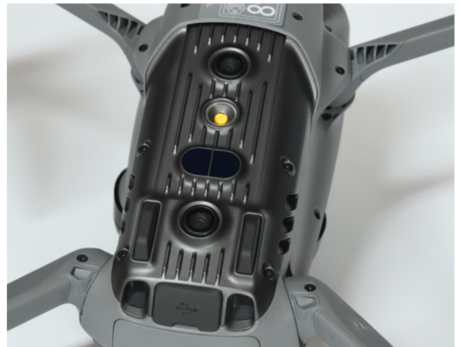
Zahlreiche im Gehäuse platzierte Sensoren tasten die Umgebung ab, sorgen für einen sehr sicheren Flug und verhindern Kollisionen weitgehend
