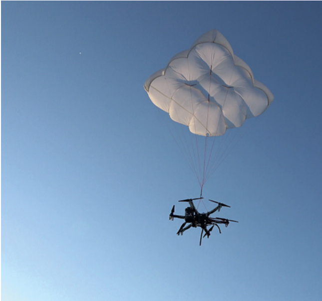
Anbieter wie Drone Rescue Systems aus Österreich entwickeln speziell auf einzelne Drohnen abgestimmte Fallschirme
