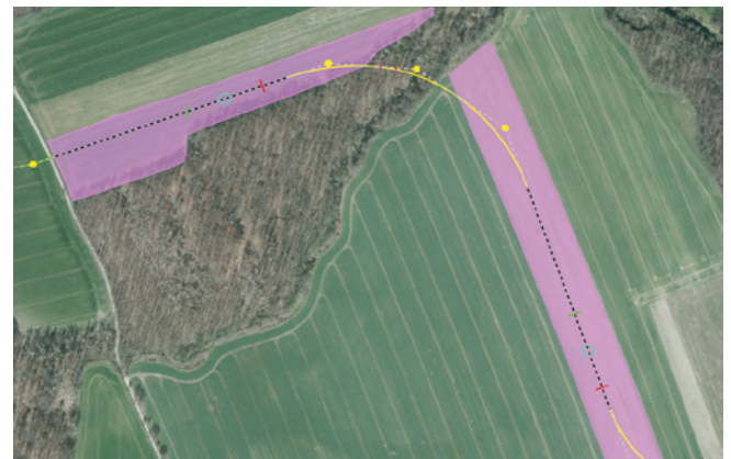
Anhand der vorher festgelegten Flugrouten und definierter Fotopunkte erfolgte der Flugbetrieb der TW-Neo-Drohnen vollständig automatisiert
