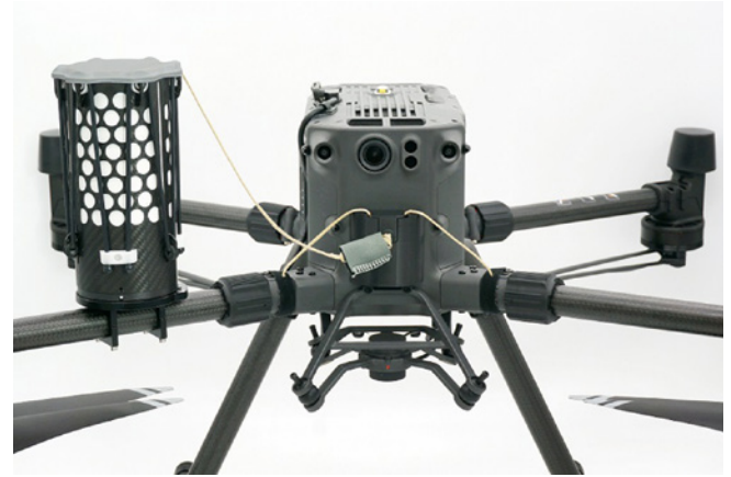
Anbieter wie Drone Rescue Systems aus Österreich entwickeln speziell auf einzelne Drohnen abgestimmte Fallschirme
