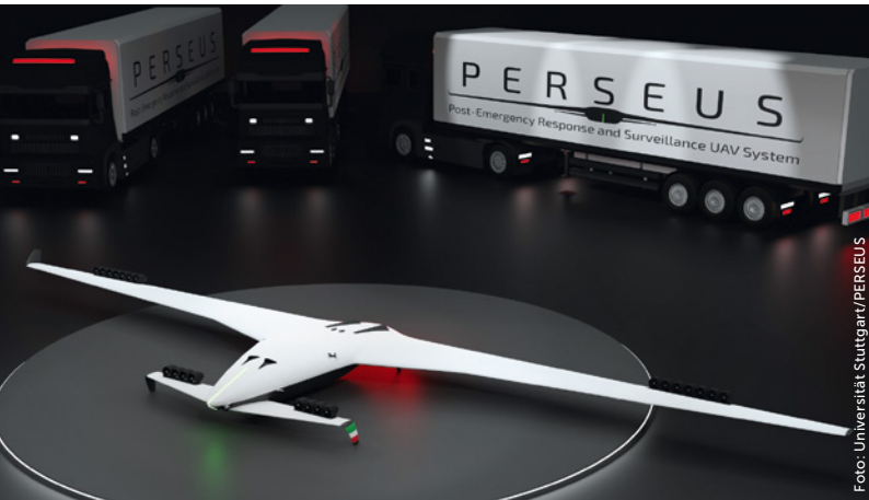
Das eingereichte Konzept der Universität Stuttgart ist ein unbemanntes „Blended Wing Body“-Konzept mit Canard. Die Konfiguration verfügt über ein hybrides Antriebssystem bestehend aus Wasserstoff-Brennstoffzellen, Batterien und Superkondensatoren
