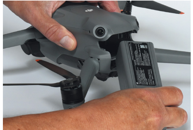
Typisch DJI: Jeder Akku hat seine eigene Bauform und ist nicht kompatibel zu anderen Drohnen. Dafür gestattet die neue 46 Minuten Flugzeit
