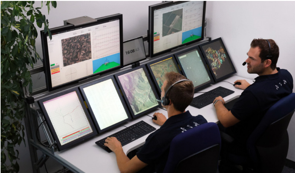
Vom Leitstand im hunderte Kilometer entfernten Aachen aus überwachte und koordinierte ein Operator den Betrieb von bis zu vier Drohnen gleichzeitig
