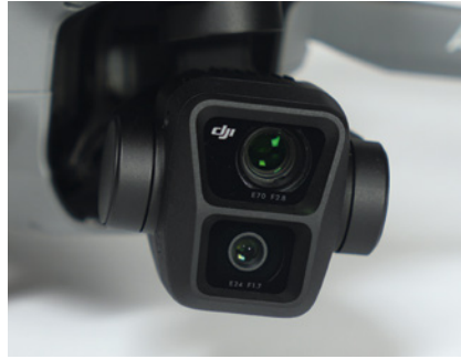
Das neue Doppelkamarasystem mit Weitwinkel- und Tele-Linse im sehr gut arbeitenden Gimbal
