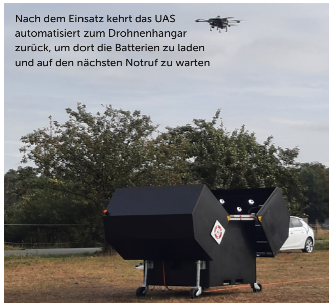
Eine Besonderheit des Drohnenhangars sind die Beleuchtung und eingebaute Kameras, sodass die Drohne aus der Ferne auf mögliche Schäden begutachtet werden kann
