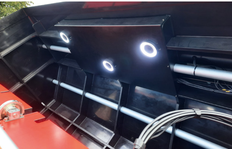
Eine Besonderheit des Drohnenhangars sind die Beleuchtung und eingebaute Kameras, sodass die Drohne aus der Ferne auf mögliche Schäden begutachtet werden kann
