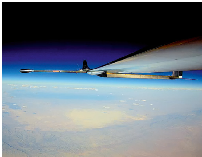
Selfie in der Stratosphäre: Die PHASA-35 ist für den Dauerbetrieb als „High Altitude Pseudo Satellite“ konzipiert
