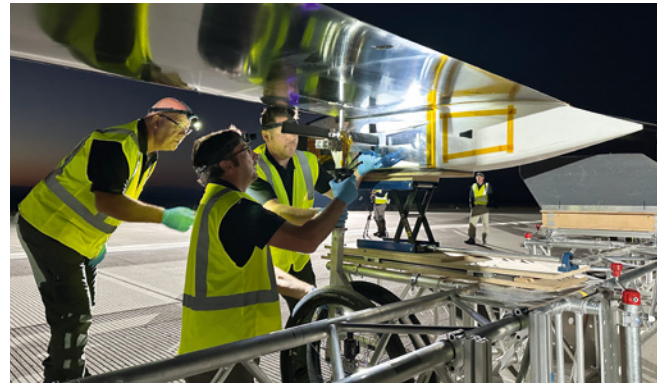
Um Gewicht zu sparen, ist die Carbonhülle so dünn wie eine Bleistiftmine
