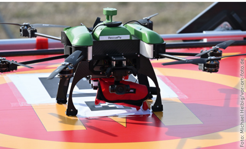
Die Drohne ist in der Lage, autonom die verunfallte Person zu detektieren und zielgenau Rettungsbojen abzuwerfen
