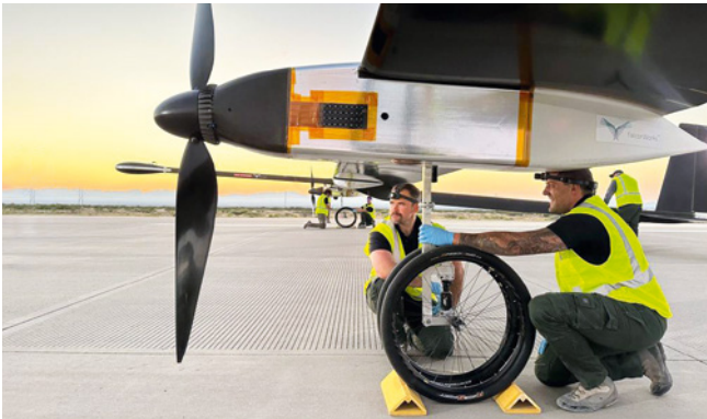
Da ein Fahrwerk auf Langzeitmissionen nur unnötiger Ballast wäre, erfolgt der Start von einem „fahrbaren Untersatz“ aus
