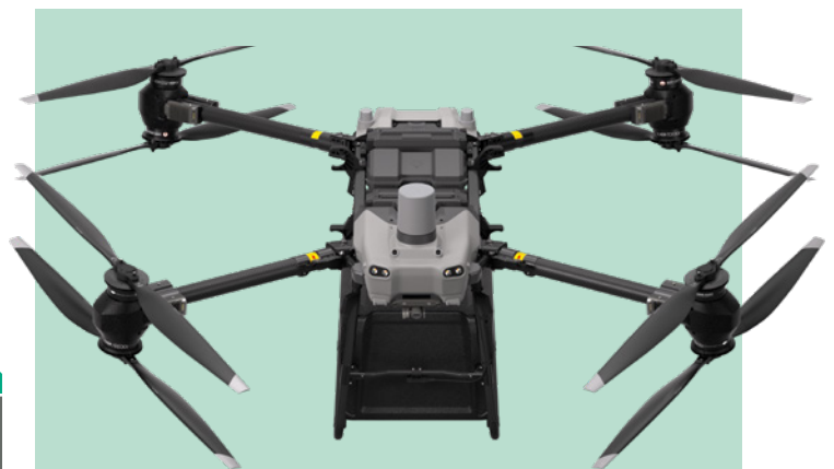
Die Cargodrohne FlyCart 30 soll bis zu 40 Kilogramm Zuladung mehr als 25 Kilometer weit transportieren können
