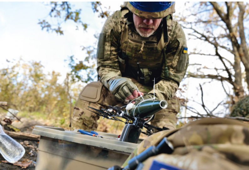
Mit einfachen Kabelbindern aus dem Baumarkt wird die Granate an der Racedrohne befestigt
