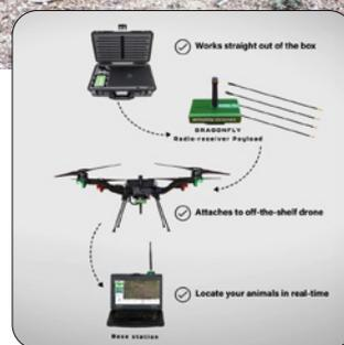
Das Dragonfly-Modul ist kompatibel mit handelsüblichen Drohnen und ermöglicht das Echtzeit-Tracking von bis zu 40 markierten Tieren
