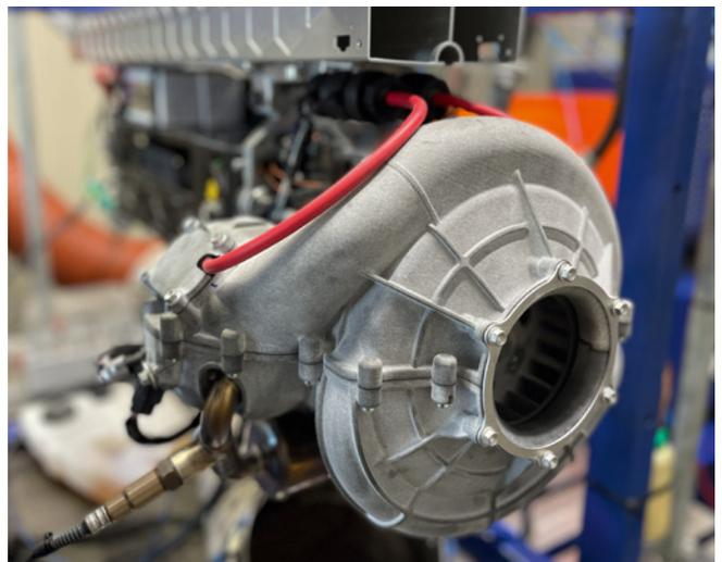
Im neuen EFT-Hybrid-1x werden die Vorteile von Verbrennungsmotoren und elektrischen Antriebssträngen kombiniert. Dadurch soll es ermöglicht werden, die Flugzeit von großen und schweren UAVs erheblich zu verlängern
