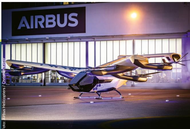
Der voll-elektrisch betriebene CityAirbus hat eine Spannweite von 12 Metern und wiegt etwa 2 Tonnen
