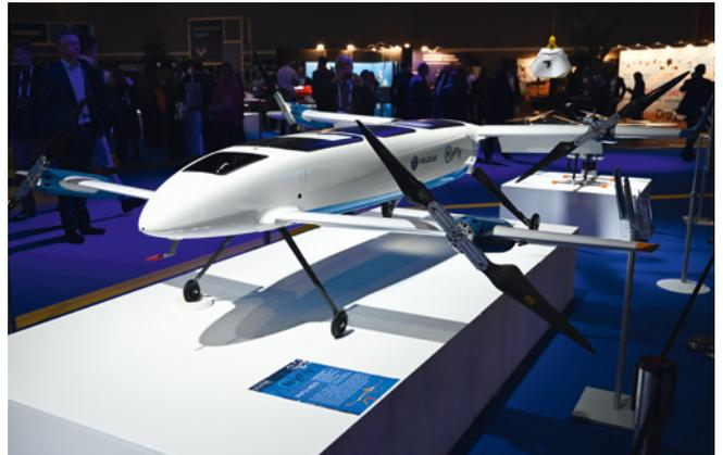
70 Kilogramm bringt die mit Wasserstoff betriebene Transportdrohne H510 des niederländischen Unternehmens HyFly auf die Waage. Das UAS mit 3.000 Millimeter Spannweite soll eilige Güter auch unter widrigen Umgebungsbedingungen ans Ziel bringen
