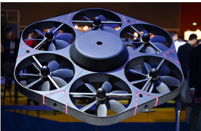
Bis zu 32 dieser per Brennstoffzelle betriebenen Scura-Drohnen sollen in einem 20-Fuß-Container Platz finden. Dieser dient als großer Hangar, von dem aus die Fluggeräte als On-Demand-Systeme für Industrieunternehmen und den Perimeterschutz zur Verfügung stehen können
