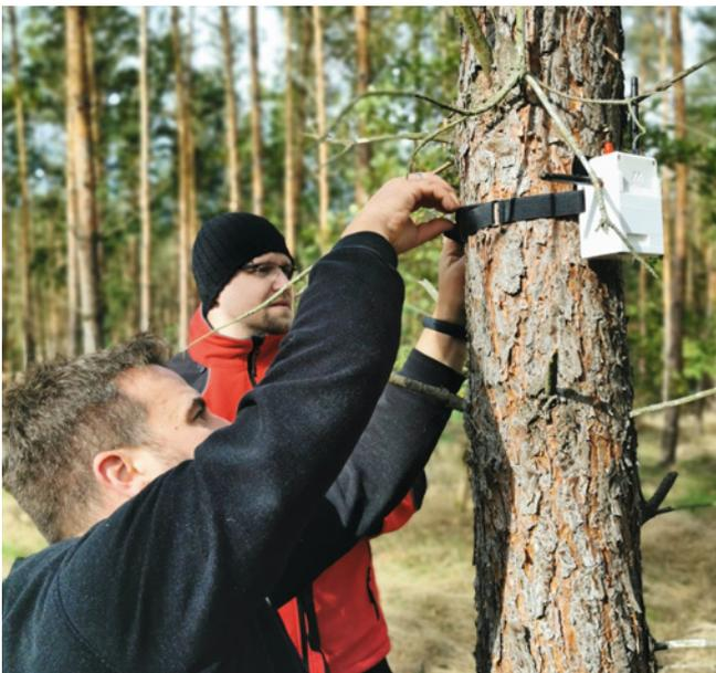
Für den sicheren Drohnenflug im Wald werden schwache oder fehlende GNSS-Signale zur Positionsbestimmung mit Signalen mobiler drahtloser Sensornetzwerke kompensiert
