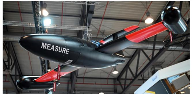
Die Measure-Drohne wurde dafür entwickelt, Informationen zu Radioaktivität und Vulkanasche in der Luft zu sammeln, um die Sicherheit in der Luftfahrt zu erhöhen
