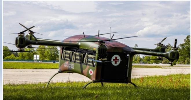
Die Konstruktion ist auf Effizienz und schnelle Abläufe getrimmt. So sind die jeweils drei Akkupacks pro Seite direkt zugänglich und können innerhalb kürzester Zeit getauscht werden
