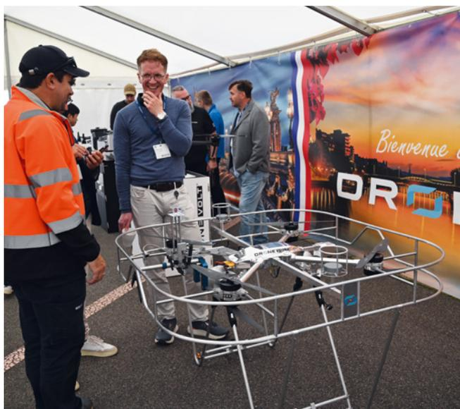
Die Linedrone von DroneVolt ist für die Inspektion von Stromtrassen konzipiert. Sie funktioniert nach dem Prinzip eines Faradayschen Käfigs und kann direkt auf aktiven Hochspannungsleitungen landen
