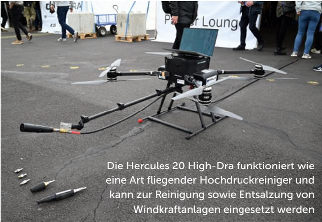
Die Hercules 20 High-Dra funktioniert wie eine Art fliegender Hochdruckreiniger und kann zur Reinigung sowie Entsalzung von Windkraftanlagen eingesetzt werden
