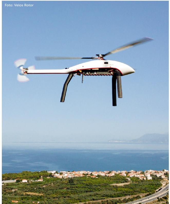
Die Analyse des Anwendungsfall ergab, dass die Drohne des Typs V3 von Velos Rotors am besten für die Stromleitungsinspektion in alpinem Gelände geeignet ist
