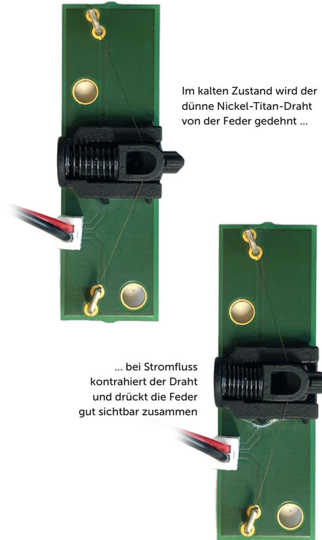
erzeugt der Draht bei einer Dehnung von nur 3 Prozent einen Hub von 2 Millimeter. Da die Stellzeit für das Einfahren der Aktorik direkt von der Heizleistung abhängt, können problemlos Reaktionszeiten von 100 Millisekunden erreicht werden.
