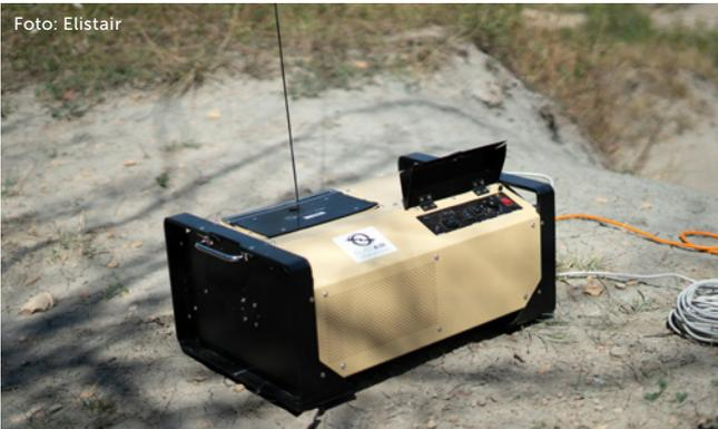
Mit der mobilen Basisstationen „Safe-T Tethered Drone Station“ von Elistair lassen sich UAS unterschiedlicher Hersteller bis in 100 Meter Höhe in die Luft bringen
