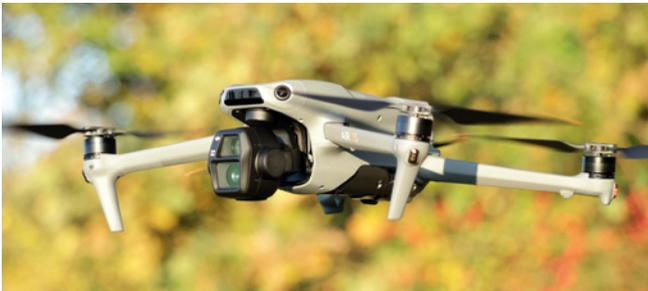
Die neue DJI-Drohne ist mit einer Weitwinkel- und einer Telekamera ausgestattet und überzeugt nicht zuletzt durch die im Vergleich zu anderen DJI-Drohnen noch einmal verbesserte Hinderniserkennung
