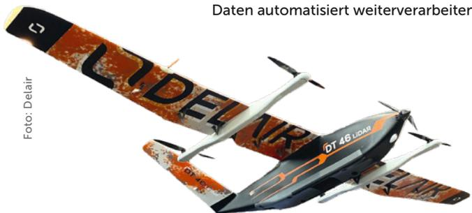
Im September stellte Delair die neue Langstreckendrohne DT46 LiDAR vor. Darin ist ein LiDAR-Sensor des Typs Voyager von Yellowscan verbaut, um eine All-in-one-Lösung für hochpräzises Mapping über weite Distanzen anzubieten
