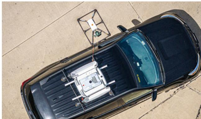
Fest auf Fahrzeugen installierte Tethering-Systeme, die per Knopfdruck aus dem Innenraum heraus in Betrieb gesetzt werden können, eröffnen völlig neue Anwendungsszenarien
