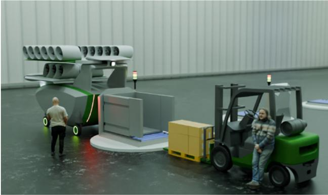
Die Akkus für den Flugebetrieb sollen in die Transportboxen integriert werden, sodass die Standzeiten der Drohne am Boden auf ein Minimum begrenzt werden können
