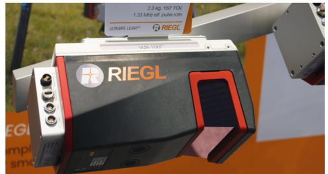
Der speziell für den UAS-Einsatz konzipierte LiDAR-Sensor VUX 10025 ist dank eines Sichtfelds von 160 Grad besonders gut für die Kartierung größerer Areale geeignet
