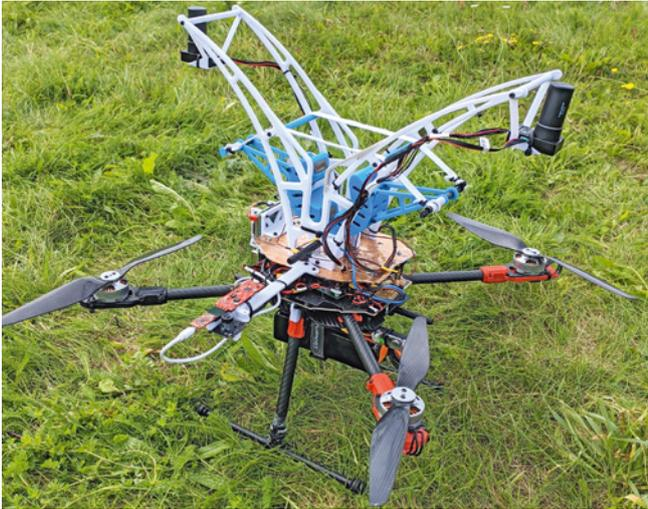
Der Testaufbau ist noch etwas sperrig, aber das Prinzip der kontaktlosen Batterieladung funktioniert bereits
