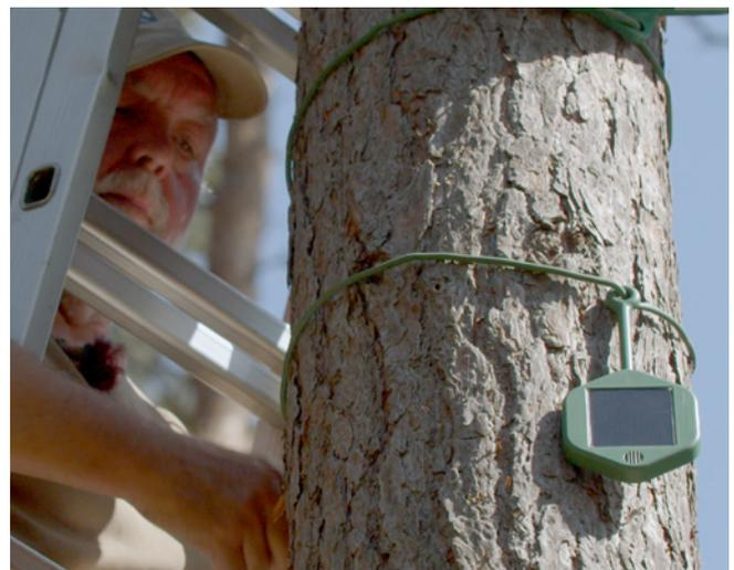
Die speziellen Sensoren sind für die Früherkennung von Waldbränden konzipiert und reagieren auf die Veränderungen von Gaskonzentrationen in der Luft. So lassen sich bereits Schwelbrände erkennen, ehe offenes Feuer ausbricht
