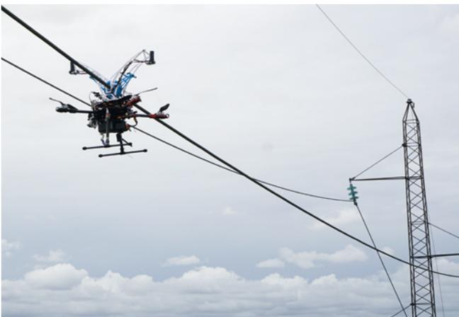
Detektion und Annäherung an das Leitungskabel funktionieren mithilfe von KI-Algorithmen und LiDAR-Sensoren
