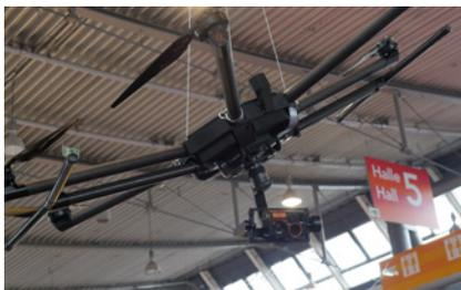
Ausgehend von der hausinternen Akkuproduktion wurde die Highdra-Drohne von Starcopter aus Braunschweig in modularer Leichtbauweise konstruiert
