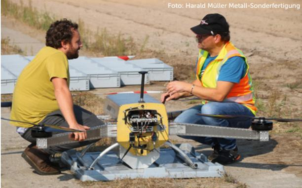
Bei Tests in der Bundesanstalt für Materialforschung und -prüfung (BAM) in Horstwalde erprobte das PEELIKAN-Team automatische Streckenflüge der Pilotdrohne in unterschiedlichen Höhen mit variablen Geschwindigkeiten, um die Steuerung des Löschmittels beim Wasserabwurf unter Realbedingungen zu erproben
