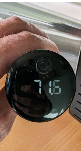
Außen wird das Gerät ordentlich warm. Nach 30 Minuten bereits über 70 °C. Nach einer Stunde waren es auf der Rückseite fast 100 °C
