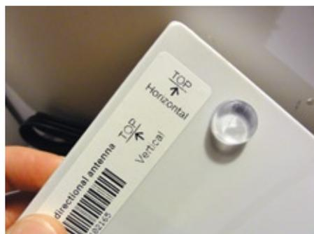
Aufgedruckte Polarisation einer Empfangsantenne
