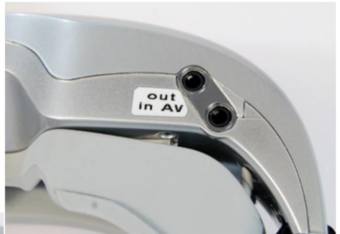
Der eingebaute Empfänger ist aufgrund der einfachen Antenne schnell an seiner Reichweitengrenze angelangt. Ein externer Empfänger mit Patchantennen ist daher zu empfehlen
