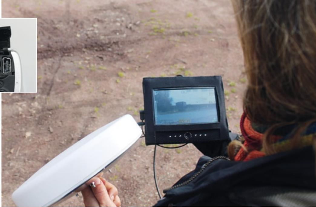
Links die Backfire-Antenne. Der Empfänger befindet sich an der Rückseite des Monitors und wird dort vom Akku des portablen DVD-Players betrieben
