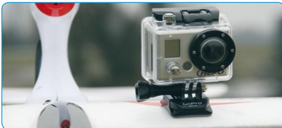
Optimaler Kompromiss: Weiter links auf dem Flügel montiert, ist zwar das Blickfeld frei, die Seitenneigung des Flugmodells dann jedoch zu hoch. Das Acrylglasgehäuse bietet optimalen Schutz gegen Staub, Wasser und Stöße
