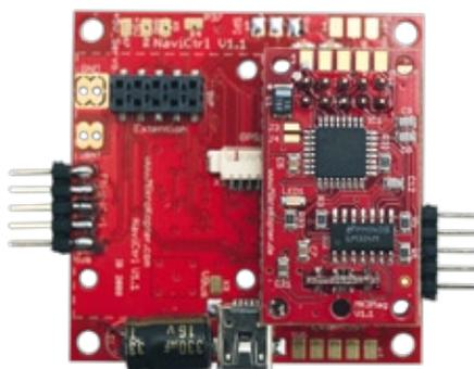
Die beiden Wi232-Funkmodule haben eine Reichweite von etwa 1.300 Meter am Boden. Eines befindet sich an der seriellen Schnittstelle des Navi-Bords am Kopter. Das andere Funkmodul wird am Notebook, an einem freien USB-Port, über das MikroKopter-USB angeschlossen.
