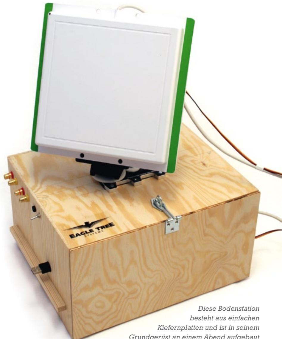
Diese Bodenstation besteht aus einfachen Kiefernplatten und ist in seinem Grundgerüst an einem Abend aufgebaut
