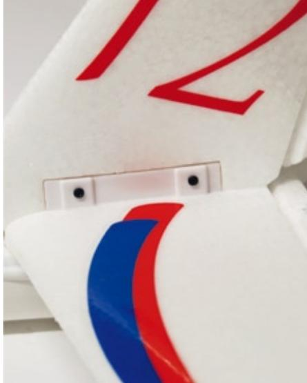
Das Kreuzleitwerk sitzt in Kunststoffformteilen und ist lediglich verschraubt. So lässt es sich ganz einfach demontieren
