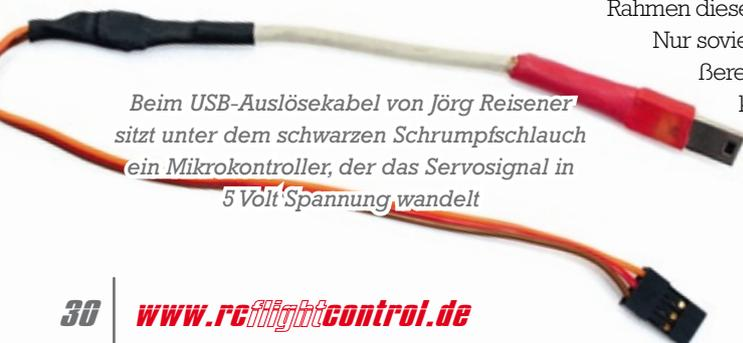
Beim USB-Auslösekabel von Jörg Reisener sitzt unter dem schwarzen Schrumpfschlauch ein Mikrocontroller, der das Servosignal in 5 Volt-Spannung wandelt
