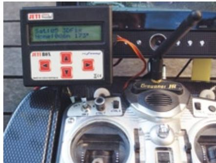
Die telemetrischen Daten können zusätzlich über das Telemetriesystem von Jeti-Duplex ausgegeben werden
