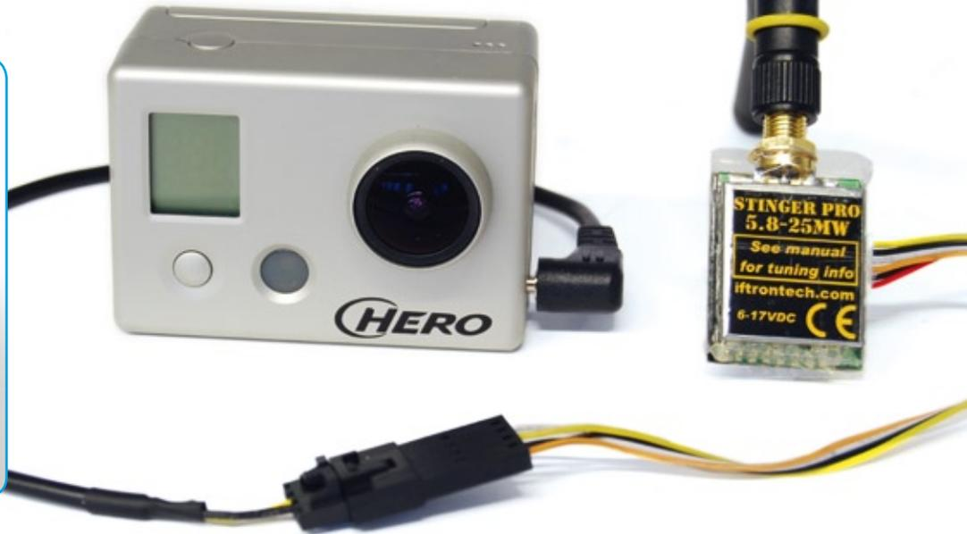
Mit dem Live-Out-FPV-Kabel kann man die GoPro auch als FPV-Kamera nutzen. Die Ausgabe erfolgt in Pal und ohne Ton
