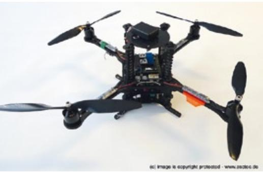
Der Quadrocopter Pelican wurde auf Solarzellen-Betrieb umgerüstet
