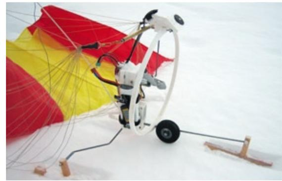
Schnee bietet dem Fotografen ein ganz neues Betätigungsfeld. Die Räder des Gleitschirms lassen sich problemlos durch selbst konstruierte Kufen austauschen
