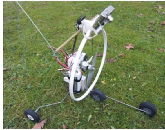
*Die flugbereite Motorgondel mit montierter Kompaktkamera. Auf der Rückseite der Kamerahalterung stehen über einen Hohlstecker die 11,1 Volt des Flugakkus zu Verfügung, um auch Kameras oder Sender ohne eigene Spannungsquelle verwenden zu können*
