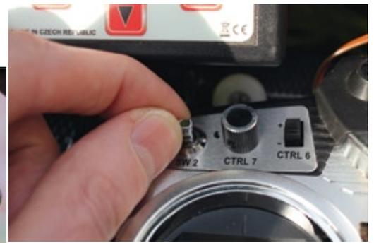
Die Auslösung erfolgt in der mechanischen wie auch der elektronischen Variante per Schalter am Sender
