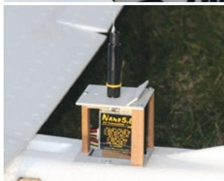
Verschiedene Versuche, das Sendemodul möglichst hoch und mit freier Sicht im Modell einzubauen.
