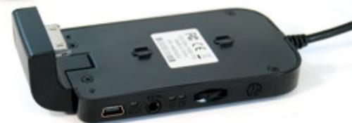
*Die Dockingstation ist eigentlich zur Aufnahme eines iPod gedacht, beherbergt aber den Akku wie auch die Elektronik*
