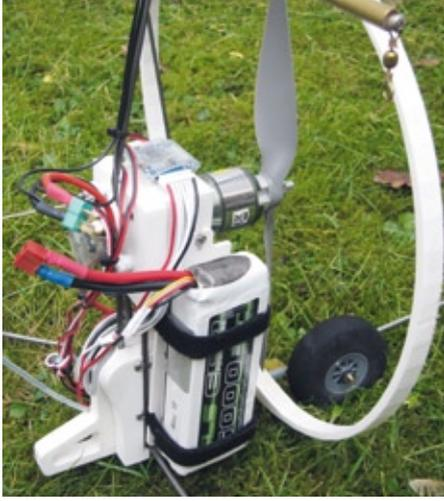
Mit 5.000 Milliamperestunden Kapazität kann der Gleitschirm je nach Windverhältnissen auch mal deutlich länger als 20 Minuten in der Luft bleiben
