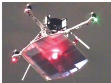
*Hier der Pelican in der Laserversion. Der mit Solarzellen ausgerüstete Quadrocopter ist weiß eingefärbt. Andernfalls besteht die Gefahr, dass aufgrund der Temperaturentwicklung durch den Infrarot-Laser das Fluggerät beschädigt wird*
