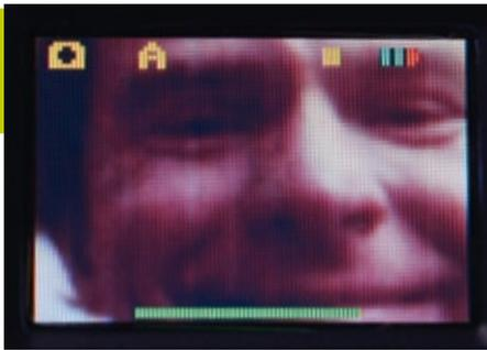
Das Display an der Kamera löst nicht besonders hoch auf, genügt jedoch zum Ausrichten des Bildausschnitts
