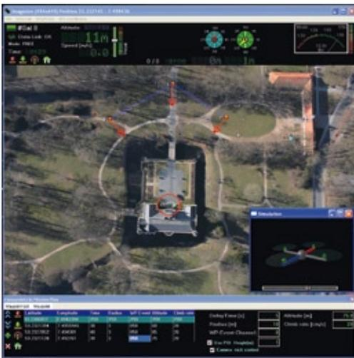
Mit Hilfe der POI-Funktion richtet sich das eingesetzte Fluggerät immer automatisch auf das gewünschte Zielobjekt aus
