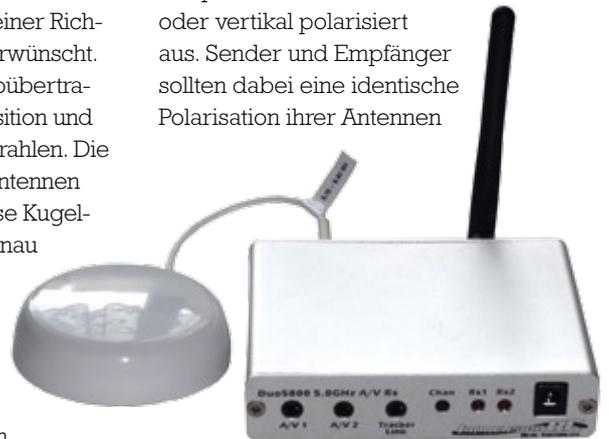
Ein weiteres Diversity-System. Im Inneren arbeiten zwei unabhängige Empfänger. Die Stärke und Qualität des Empfangs werden beurteilt und über eine automatische Umschaltung wird nur das jeweils bessere Signal ausgegeben
