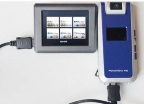
Das optionale Display kann man direkt über ein Kabel mit der Kamera verbinden, ...
