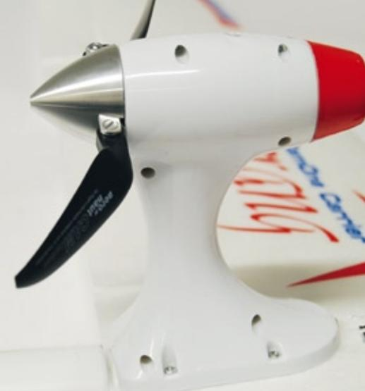
Der Pylon des Aufsatzmotors wirkt mit einem Spinner als Abschluss erst recht stromlinienförmig
