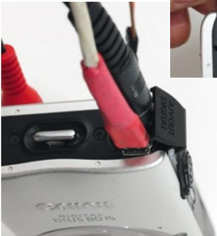
Hier links der Videoausgang für den kleinen Klinkestecker. Rechts der Eingang für das USB-Auslösekabel. Am A/V-Ausgang lässt sich auch ein Live-Bild abnehmen
