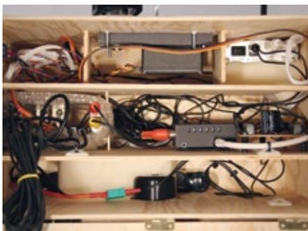
Ein Blick in die Bodenstation enthüllt den Hauptakku (unterstes Fach), das Eagle-Eyes-Modul und Empfänger 1 (mittleres Fach) sowie Schalter, Kabeldurchführungen, Mechanik-Modul und Empfänger 2 (oberstes Fach)
