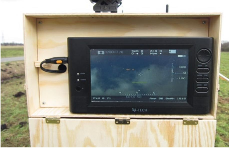
Der Monitor der Bodenstation ist vollständig verkabelt hinter der Schutzklappe der Selbstbaubox befestigt. So müssen auf dem Flugplatz zum Starten nur die Hauptenergieversorgung und der Monitor angeschaltet werden
