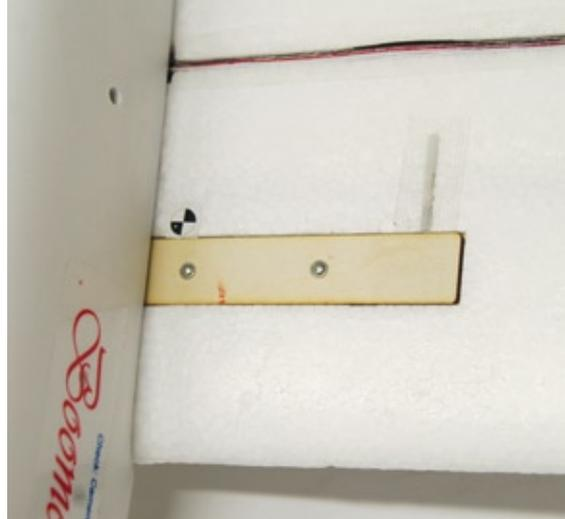
Die Sperrholzunge zur Versteifung der Fläche ist mit vier Schrauben montiert. Verklebt man sie, lässt sich die Tragfläche nicht mehr teilen
