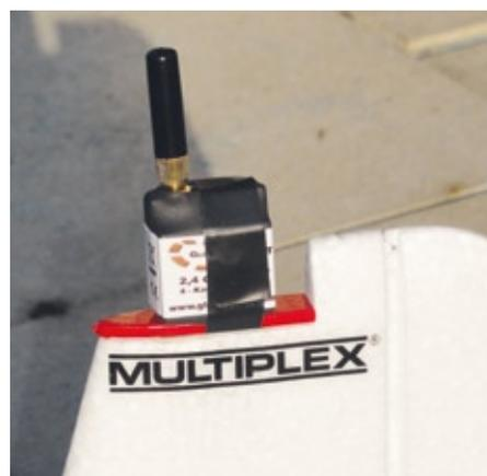
Beispiel für die erhöhte Montage des Senders am Heckleitwerk eines TwinStars
