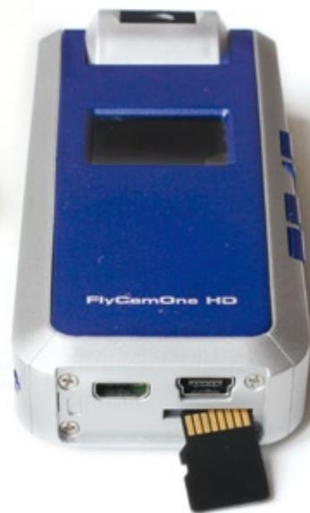
*An der Unterseite sitzt ein Mini-USB-, ein Mini-HDMI-Anschluss sowie der Micro-SD-Kartenslot*
