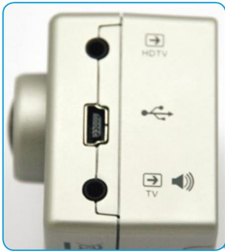
Mit dem oberen 2,5-Millimeter-Klinkenstecker kann man ein Fernsehgerät direkt Full HD anschließen
