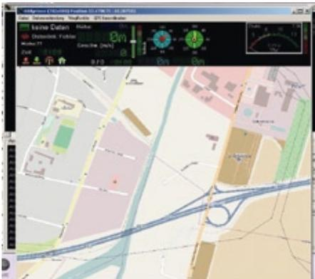
Nachdem das MikroKopter-Tool auf dem Notebook gestartet ist, kann das Wi232-Funkmodul eine Verbindung zum Kopter aufnehmen. Das OSD wird über einen Boten aus dem MikroKopter-Tool heraus gestartet. Neben den grafisch dargestellten Telemetrie-Daten des Kopters, ist die vorher eingeladene Karte (siehe Kartenmaterial) zu sehen
