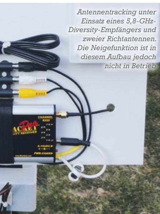
Antennentracking unter Einsatz eines 5,8-GHz-Diversity-Empfängers und zweier Richtantennen. Die Neigefunktion ist in diesem Aufbau jedoch nicht in Betrieb
