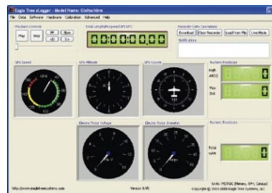
Abbildung 4: Mit der Windows-Software „Data Recorder“ können alle Telemetriedaten live an der Bodenstation mitverfolgt werden. Zudem gibt es auch umfangreiche Konfigurationsmöglichkeiten für das OSD Pro und den Datenlogger
