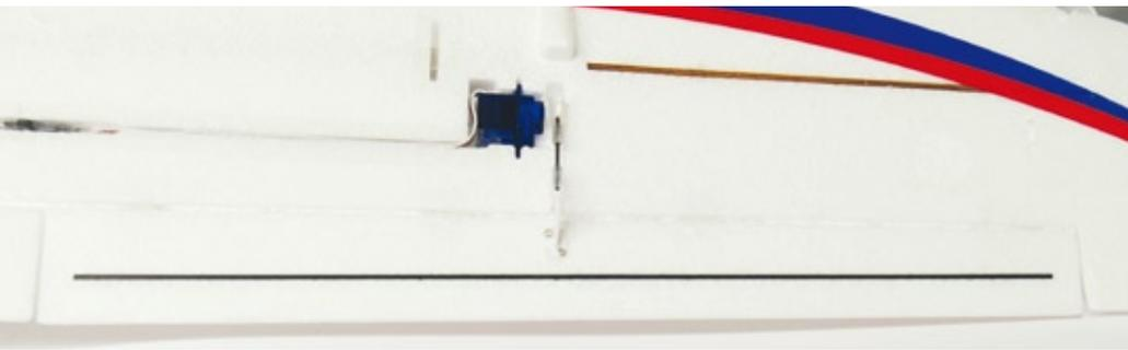
Die Querruder sind mit einem CFK-Stab zusätzlich gegen Verwinden versteift
