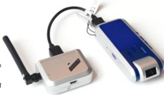
*Den Sender des Video-Downlinks verbindet man über ein Kabel mit der FlyCamOne 720p*
