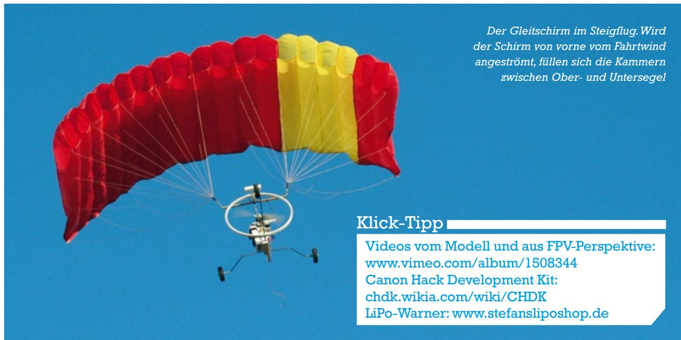
*Der Gleitschirm im Steigflug. Wird der Schirm von vorne vom Fahrtwind angeströmt, füllen sich die Kammern zwischen Ober- und Untersegel*
