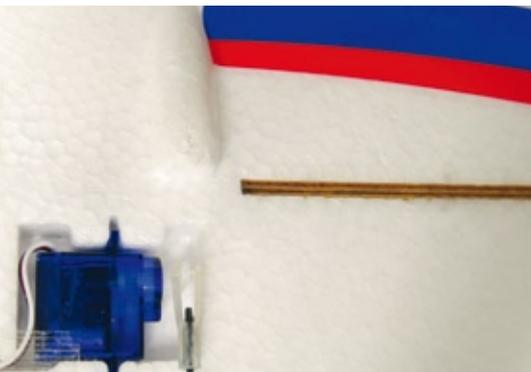
*Leider ist der Hauptholm nicht mit der Versteifung des Außenflügels verbunden, doch die Statik ist auch so mehr als ausreichend dimensioniert*
