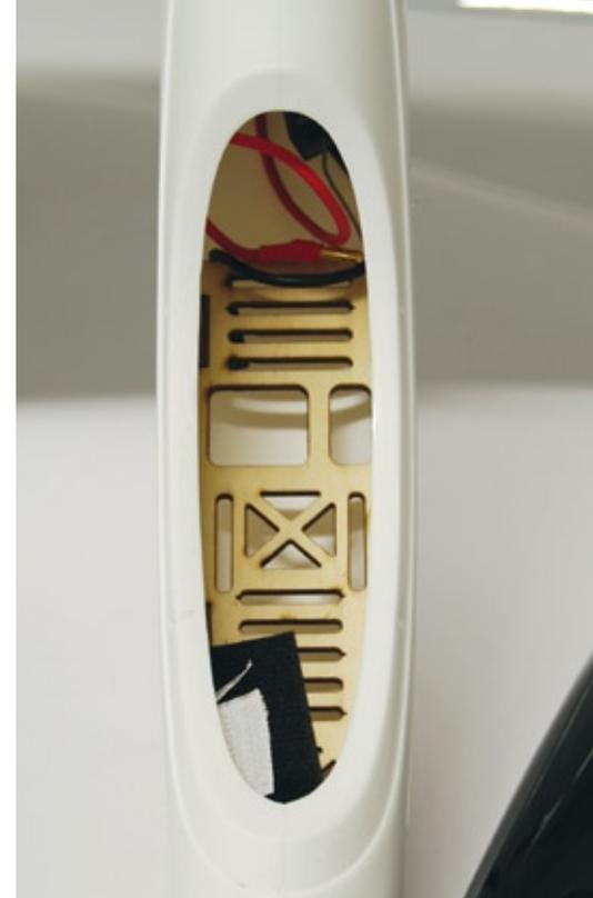
Hier ist genügend Platz vorhanden, um auch das sperrigste FPV-Equipment unterzubringen, denn der Rest der RC-Ausrüstung wie Empfänger, Servos und Regler sind unter der Tragfläche untergebracht
