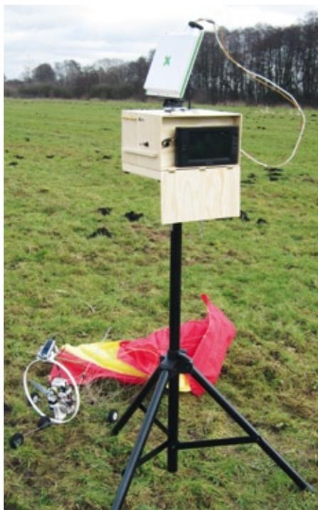
*Die Bodenstation startbereit auf dem Boxenständer montiert. Dieser bietet deutlich mehr Stabilität als ein einfaches Fotostativ*
