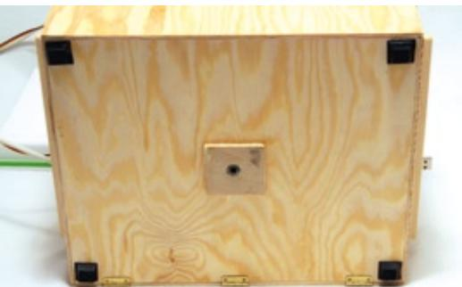
*Der erste Versuch, die Basisstation auf einem Stativ zu befestigen, bestand aus einer eingeklebten Mutter mit Fotogewinde. Diese Variante ist vergleichsweise wackelig. Viel besser ist die Variante mit einem hochwertigen Stativ*
