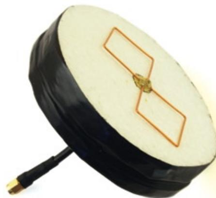
Abbildung 5: Eine mit einfachsten Mitteln selbst gebaute Biquadantenne. Im Internet ist eine Reihe von praktischen Anleitungen verfügbar
