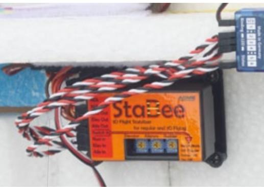
Ein besonderes Augenmerk bei der Montage gilt dem exakten geraden und ebenen Einbau des StaBee auf dem Modell – hier im Super Zoom von Hacker. Die Kabel am StaBee müssen bei der Montage in Richtung Heck des Flugzeugs zeigen. Das vierte Kabel dient zur Umschalten zwischen den Modi beim Fliegen über einem Drei-Stufen-Schalter am Sender
