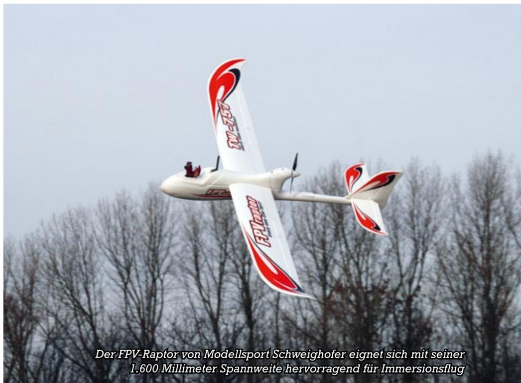
Der FPV-Raptor von Modellsport Schweighofer eignet sich mit seiner 1.600 Millimeter Spannweite hervorragend für Immersionsflug
