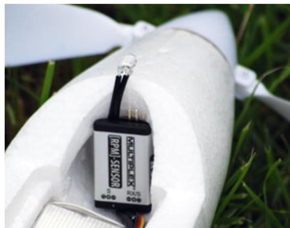
Der optische Drehzahlsensor sollte möglichst nahe der Luftschraube positioniert werden. Bei Klappplatten muss man hier jedoch einen Kompromiss eingehen
