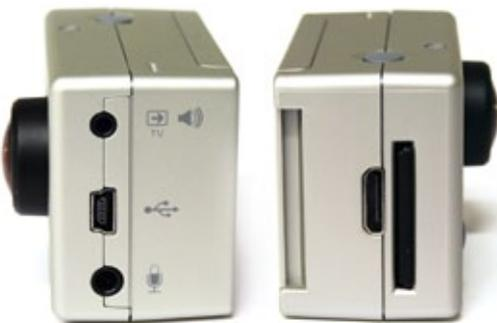
An der linken Gehäuseseite findet man von oben nach unten: Live-Out-Buchse, Mini-USB, Mikrofonanschluss. Auf der anderen Seite befindet sich links neben dem SD-Kartenslot ein Mini-HDMI-Anschluss
