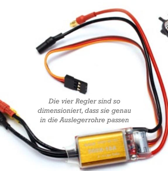
Die vier Regler sind so dimensioniert, dass sie genau in die Auslegerrohre passen
