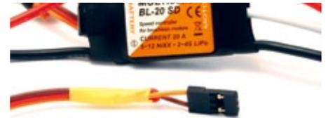
Bei einem der Regler wird das BEC-System deaktiviert
