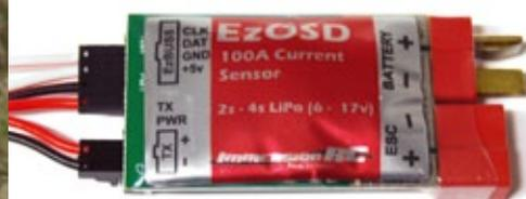
*Der Stromsensor wird einfach zwischen Akku und Regler eingeschleift. Er übernimmt auch die Stromversorgung des OSDs*
