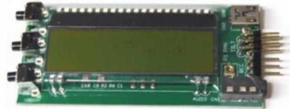
*Der Antennentracker-Controller ist eine Platine mit einem großen Display. Einstellungen nimmt man mittels der drei Drucktaster an der linken Seite vor. An der rechten Seite steckt man die beiden Servos der Pan/Tilt-Mechanik an*
