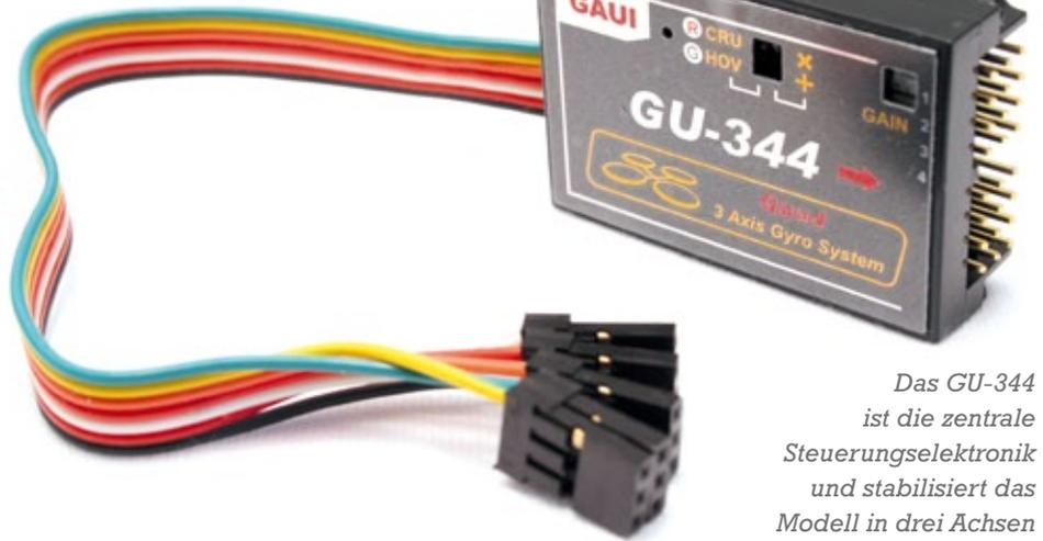
*Das GU-344 ist die zentrale Steuerungselektronik und stabilisiert das Modell in drei Achsen*
