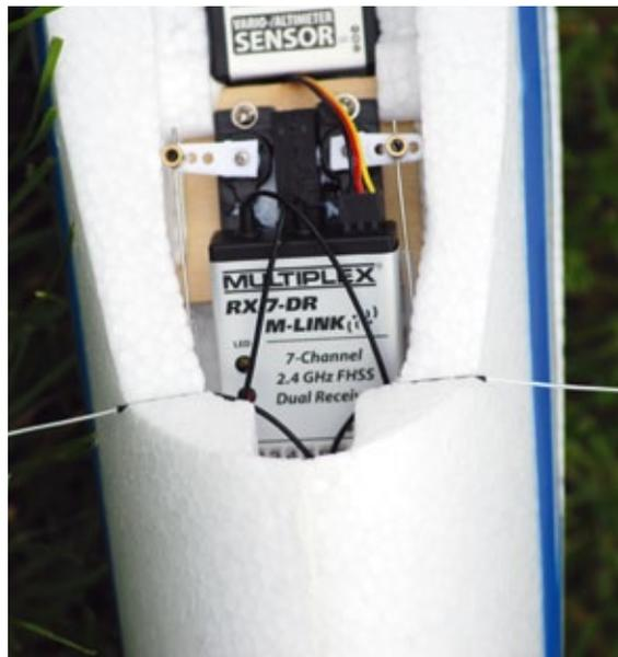
Beste Reichweite ist bei 90 Grad zueinander angeordneten Antennen garantiert
