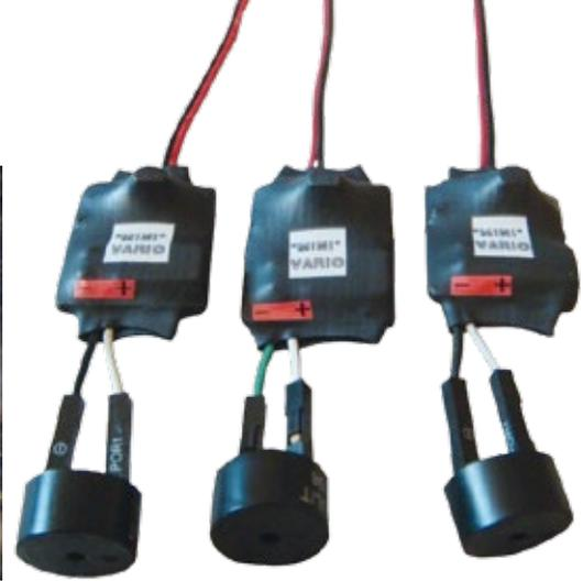
Die selbstgebauten Mini-Varios verhelfen zu stundenlangen Flügen in der Thermik
