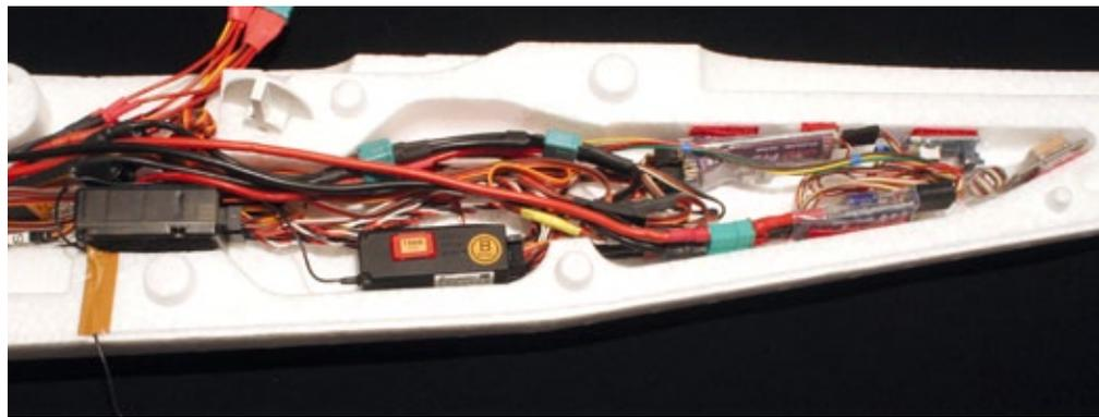
Im Heckbereich werden die Komponenten des OSD-Systems von Eagle Tree Systems untergebracht. Im mittleren Rumpfbereich findet man die Regler und der Autopilot (links) und der Empfänger (rechts)
