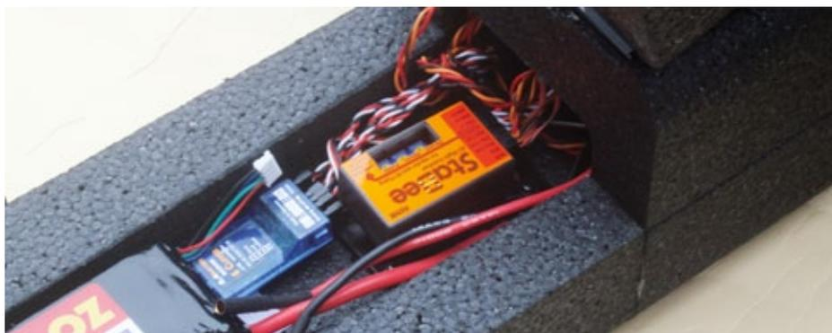
Etwas einfacher gestaltete sich der Einbau im Vamp. Hier ist ein ebener Rumpfboden vorhanden, der parallel zur Profilschne der Tragfläche liegt. Die Verbindungskabel gehen direkt zum Empfänger, der gleich vor dem StaBee angeordnet ist
