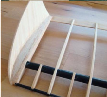
Rumpf schon auf dem Baubrett zusammengeklebt werden. Dabei ist lediglich darauf zu achten, dass das Seitenleitwerk rechtwinklig zum Höhenleitwerk verklebt wird. Das Seiten- und Höhenruder wird später beim Bespannen einfach mit Folie am Leitwerk angeschlagen.
