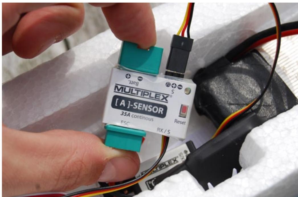
Der Stromsensor wird einfach zwischen Akku und Regler eingeschleift
