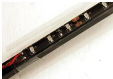
LED-Beleuchtung mit Schrumpfschlauch
