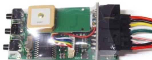
Einstellungen nimmt man mithilfe der drei Tasten an der linken Seite vor. Das quadratische Bauteil ist das GPS-Modul
