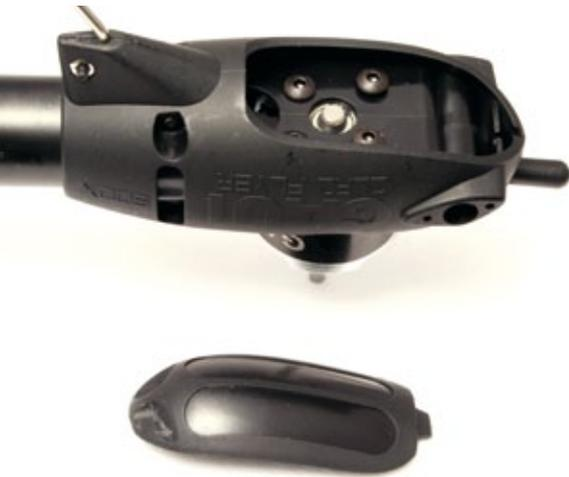
*Die Abdeckungen der Motorgondeln können zu Beleuchtungszwecken durch eine transparente Variante ersetzt werden*
