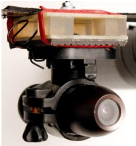
Universalhalter mit nachgerüsteter Schwingungsdämpfung
