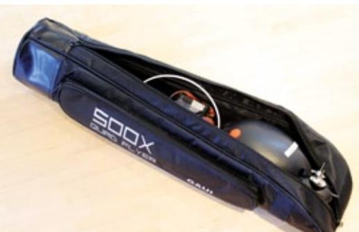
*Nach Demontage des Rahmens und der Propeller lässt sich der Quad zusammengeklappt in der Tasche verstauen*
