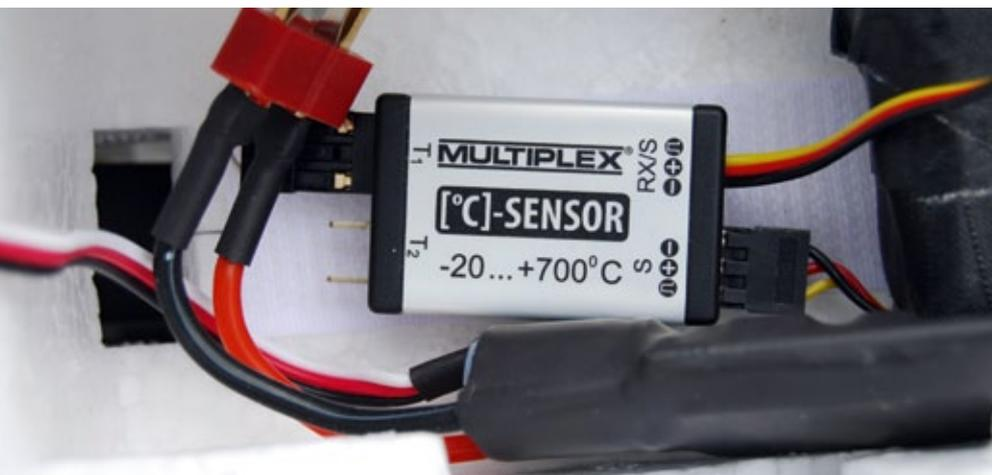
Das Temperaturmessgerät kann mit zwei Sensoren bestückt werden
