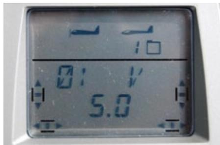
Auch ohne angeschlossene Sensoren empfängt der Sender stets die aktuelle Empfängerspannung
