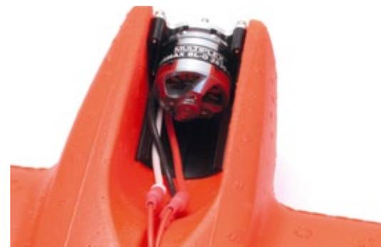
Die neuen bürstenlosen Motoren werden mit einer modifizierten Montageplatte an den bestehenden Aufhängungen befestigt
