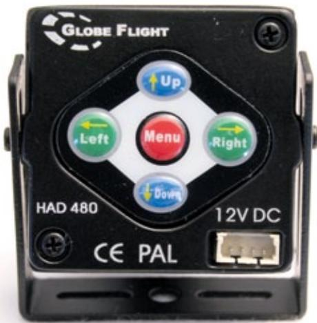
Auf der Rückseite der Kamera befindet sich das 5-Tasten-Feld für die Bedienung des OSD-Menüs. Bei Bedarf kann das Objektiv der Kamera gewechselt werden
