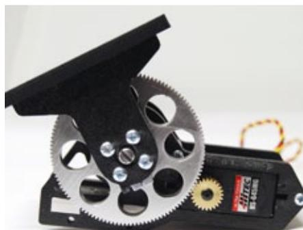
Die Tilt-Mechanik wird von einem umgebauten Hitec HS-645MG angetrieben
