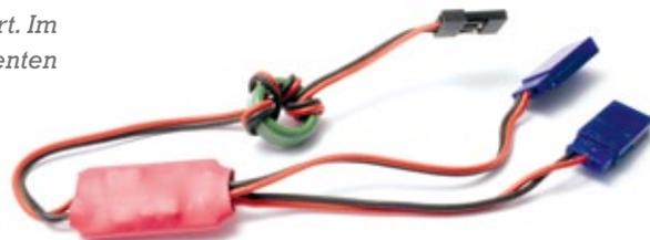
*Der Step-Up-Wandler mit angelöteten Anschlusssteckern. In dieser Variante können zwei Verbraucher mit 12 Volt versorgt werden*
