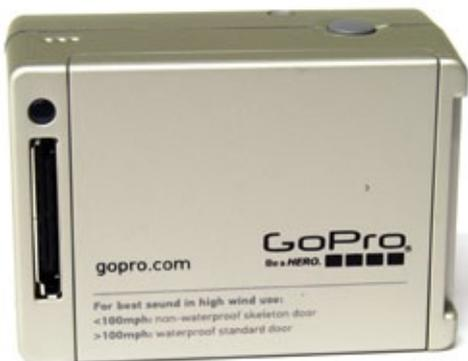
An der Rückseite lassen sich entweder ein Bildschirm oder ein zusätzlicher Akku anschließen – beides natürlich optional erhältlich
