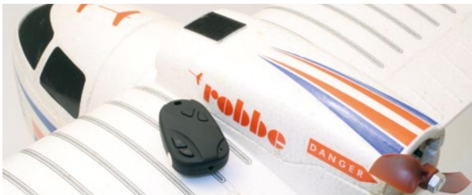
Die Befestigung am Modell per Klett erlaubt einen einfachen Wechsel der Kameraposition. Nahe am Schwerpunkt befestigt, kann fast jedes Flugmodell als Träger verwendet werden. Hier: robbe Seabee
