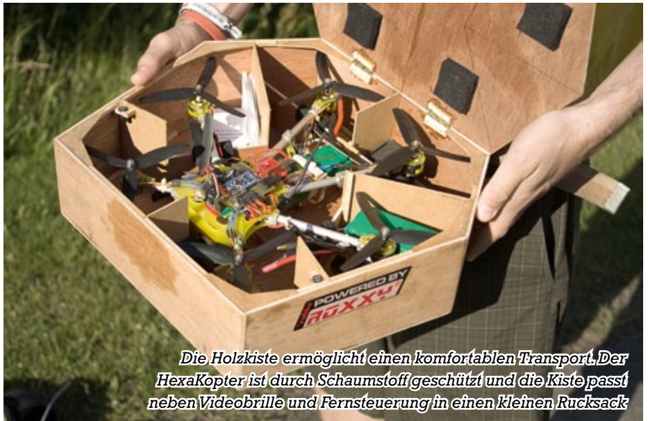
Links im Bild der abgespeckte Empfänger, in der Mitte die Platine zur Regelung der Fluglage. Der rote Würfel rechts im Bild besteht aus drei Gyroskopen und einem Zweiachs-Beschleunigungssensor. Das teure Bauteil kann einfach demontiert und für verschiedene Projekte verwendet werden
