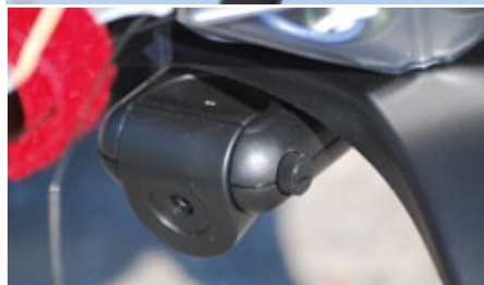
Die kleine HD-Kamera von Conrad wurde einfach mit Doppelklebeband unter der Mittelkonsole mit Blickrichtung nach vorn befestigt. Sie ist mit einem Servo-Anschlusskabel mit der Bordelektronik verbunden und lässt sich via Fernsteuerung auslösen
