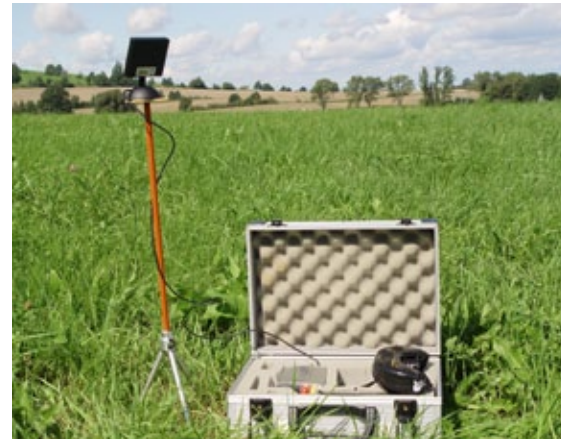
Für mehr Reichweite ist eine Richtantenne nötig. Diese sollte mindestens einen halben, besser noch 1,5 Meter hoch über der Erde aufgestellt sein
