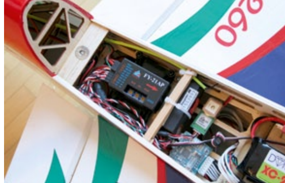
Die Lageregelung wird zwischen den Empfänger und die Servos ein geschleift
