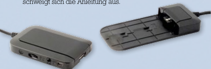
Links, das ist die Akkubox, die die Brille mit dem Empfänger verbindet und mit dem Strom versorgt. Rechts ist der VAG-Adapter und der muss beim FPV-Betrieb ab
