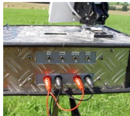
Alle innenliegenden Komponenten lassen sich einzeln abschalten
