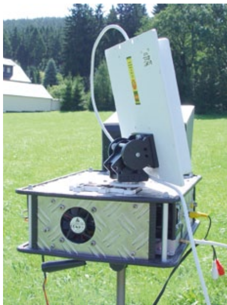
Die Pan/Tilt-Mechanik schwenkt automatisch die Patchantenne in die Richtung des Modells
