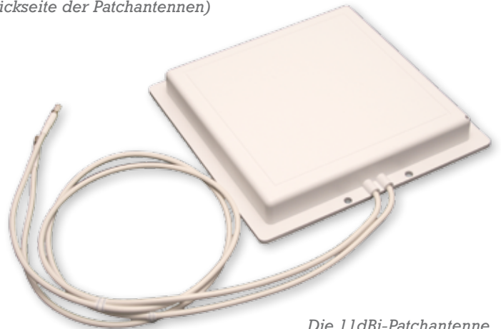
Die 11 dBi-Patchantenne mit Raumdiversität besteht aus zwei nebeneinander stehenden Antennen, um negative Folgen der Mehrwegeausbreitung zu kompensieren
