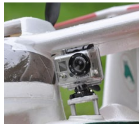
Die Kamera, etwas erhöht auf Stelzen, ist – zumindest bei ruhigerem Wasser – frei von Spritzern und hat dennoch in eine schöne wellennahe Perspektive
