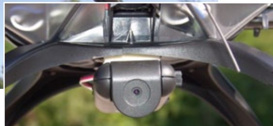
Die kleine HD-Kamera von Conrad wurde einfach mit Doppelklebeband unter der Mittelkonsole mit Blickrichtung nach vorn befestigt. Sie ist mit einem Servo-Anschlusskabel mit der Bordelektronik verbunden und lässt sich via Fernsteuerung auslösen
