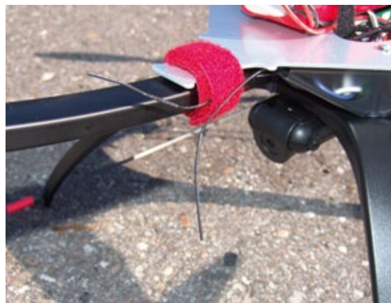
Die beiden Antennen des GR-16-Empfängers können bequem nach außen geführt werden
