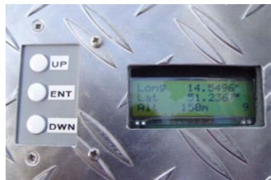
Die Daten des GPS-Moduls lassen sich über ein eingelassenes LC-Display ablesen
