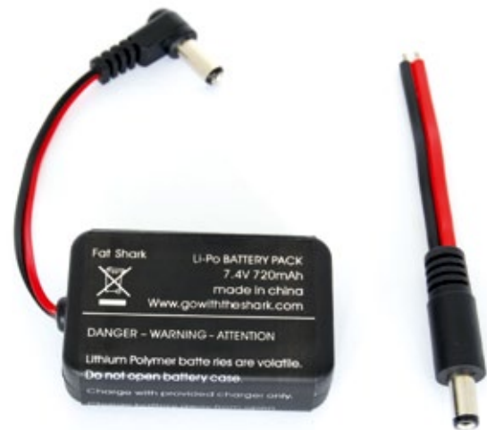
Der Akku ist optional, allerdings liegt ein Stecker zum Anlöten eines 2s-LiPos bei
