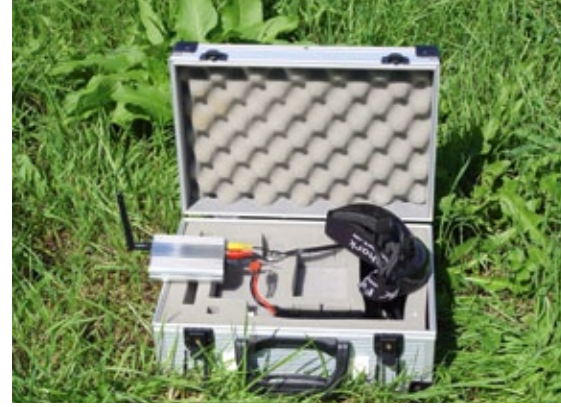
Vom Koffer in die Luft. Möchte man mit den geringsten Mitteln in nächster Nähe fliegen, genügt auch eine Rundstrahlantenne
