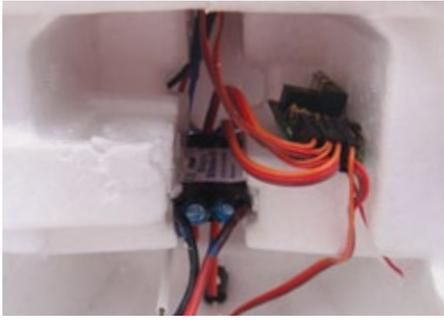
*Der Regler und der Empfänger sind an einer erhöhten Position angebracht. So sind die beiden Elektronikbausteine zunächst gegen eindringendes Wasser geschützt*
