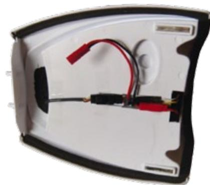
*Die Verkabelung der Videoanlage ist auf der Unterseite der Kabinenhaube angebracht*
