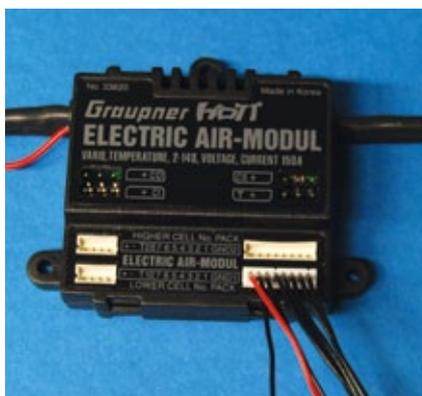
An der rechten Steckerseite schiebt man den Balancerstecker des Akkus über einen Adapter an
