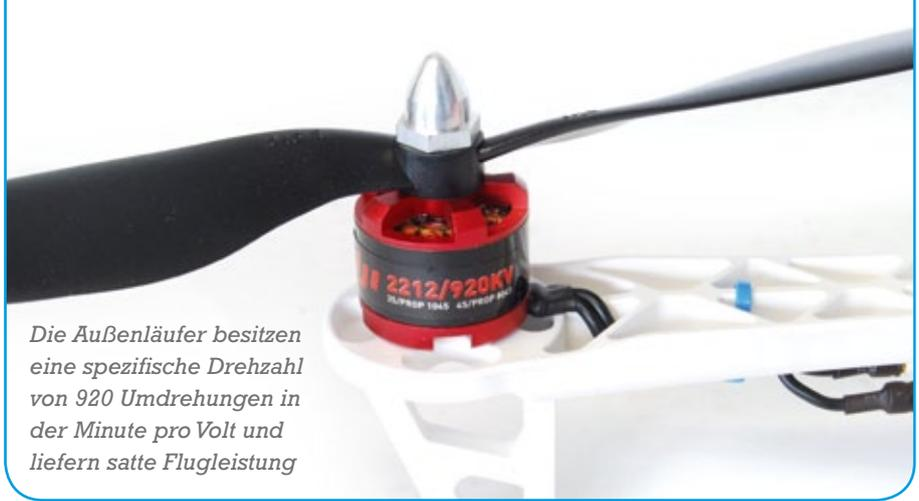
Die Außenläufer besitzen eine spezifische Drehzahl von 920 Umdrehungen in der Minute pro Volt und liefern satte Flugleistung
