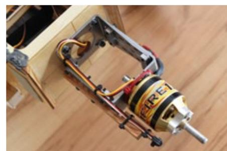
Am Motor sind die Sensoren für Temperatur und Drehzahl verbaut
