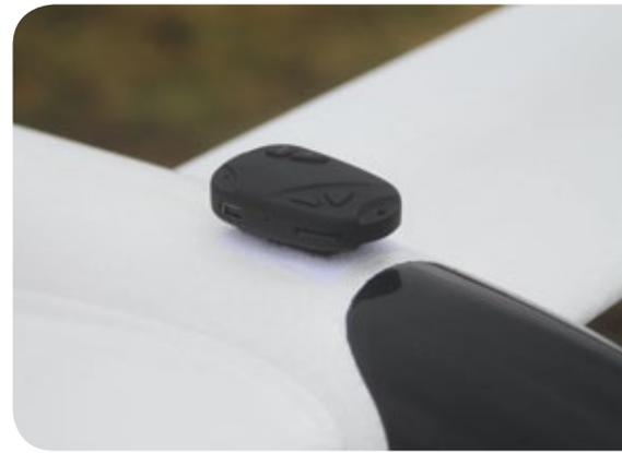
*Bei der Perspektive nach hinten zum Leitwerk richtet man am besten die Kamera leicht schräg nach unten, damit in der waagerechten Fluglage nicht nur das Leitwerk zu bewundern ist*
