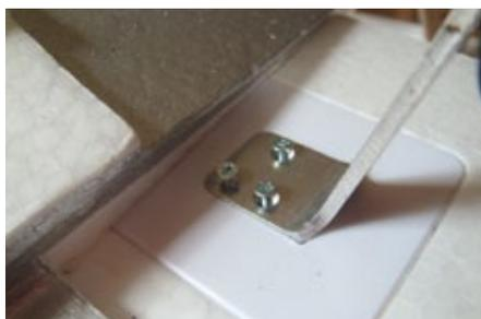
*Für Wasserflüge wird die Fahrwerksaufnahme mit einer Abdeckung verschlossen*
