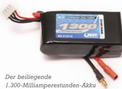
Der beiliegende 1.300-Milliamperestunden-Akku ermöglicht ausreichend lange Flugzeiten
