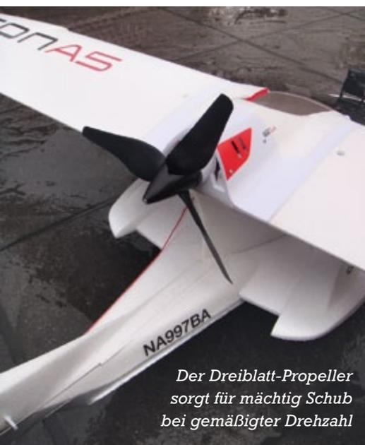
*Der Dreiblatt-Propeller sorgt für mächtig Schub bei gemäßigter Drehzahl*
