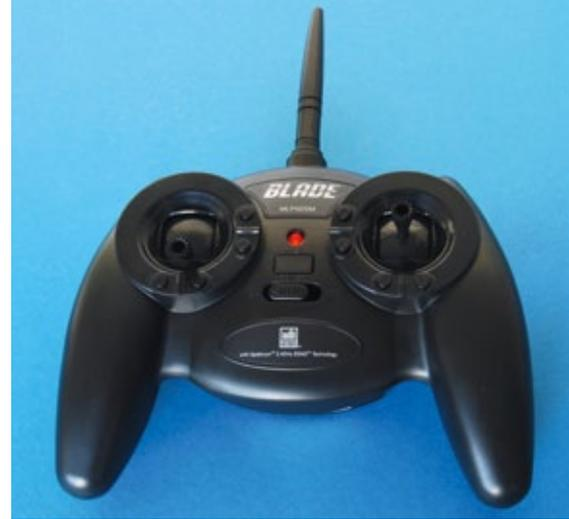
*Zur RTF-Version des Blade mQX gehört ein MLP4DSM-Vierkanalsender. Dessen Kreuzknüppel sind mit digitalen Trimmungen versehen*
