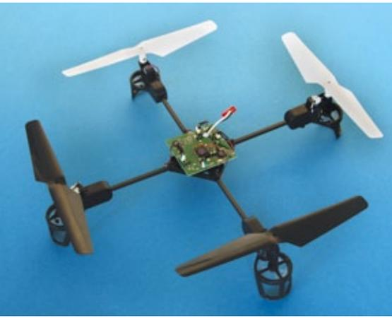
Der mQX ist denkbar einfach aufgebaut. Die Hauptplatine ist auf dem Rahmen-Mitteilteil verschraubt. Dieses nimmt die vier Ausleger auf
