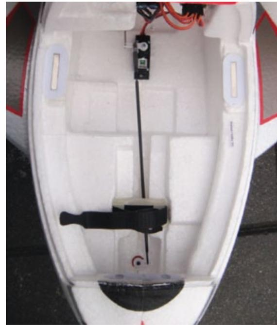
*Ein Servo im Rumpf steuert das Seitenruder und – wenn eingesetzt – das Bugfahrwerk an*
