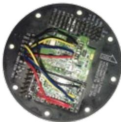
... dann die Gyros und die Beschleunigungssensoren, die aufgesteckt und mit einzeln zu auflöten Kabeln verbunden werden müssen, ...
