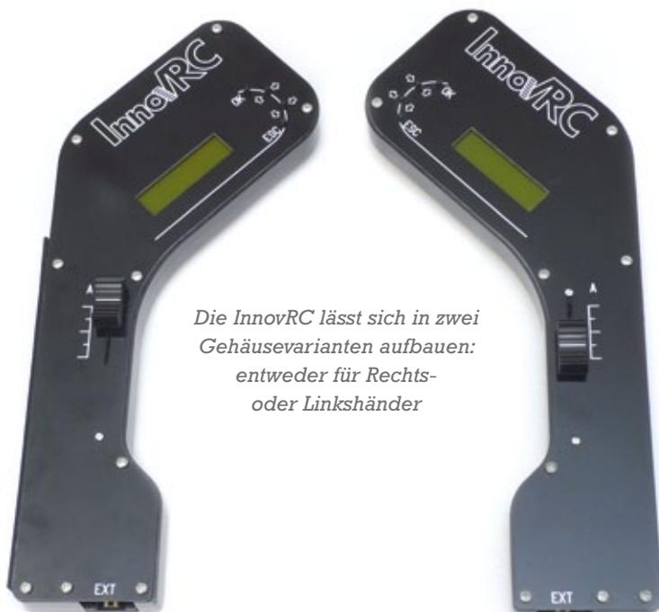
Die InnovRC lässt sich in zwei Gehäusevarianten aufbauen: entweder für Rechts- oder Linkshänder
