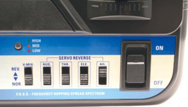
Mit den Servo-Reverse-Schaltern an der Fernbedienung kann die Drehrichtung der Servos invertiert werden
