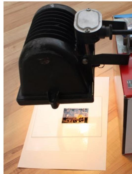
Die Platinen werden mit der Baustrahler-Methode belichtet
