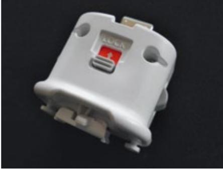
*Der Wii-Motion-Plus-Adapter verhilft dem Wii-JoyPad durch zusätzliche Beschleunigungssensoren für eine exaktere Steuerung im Spiel. Diese Sensoren nutzen wir auch für unseren Kopter*
