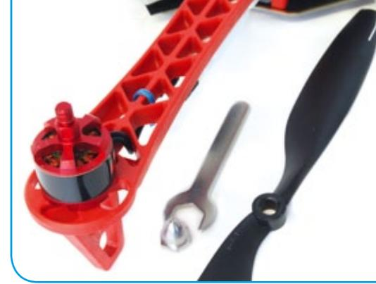
*Die Luftschraubenaufnahme besitzt zur Verdrehsicherung eine Anfasung auf der Welle*
