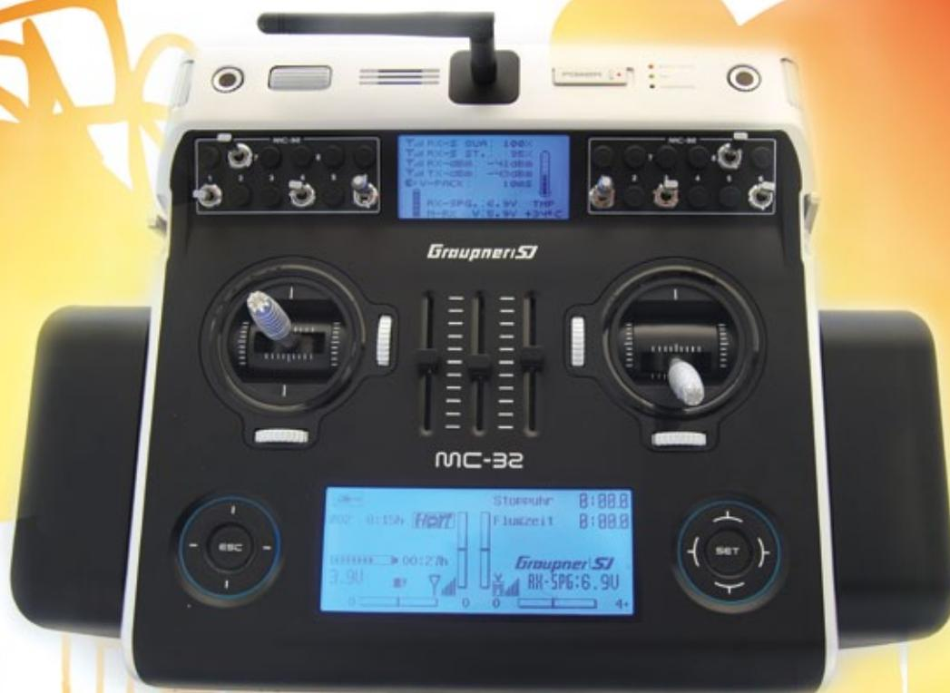
Graupner bietet seit längerem das hauseigene HoTT-System an. Das Besondere bei dieser 2,4-Gigahertz-Technik ist die von vornherein integrierte Telemetrie. Hier sind unter anderem neben einem üblichen barometrischen Vario auch zwei so genannte Airmodule für Elektro- sowie Verbrennungsmotoren und ein GPS-Modul erhältlich. Wir sehen uns hier in Verbindung mit der neuen mc-32 das Electric Air-Modul sowie das GPS-Modul einmal genauer an.
