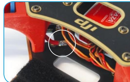
*Lediglich ein paar Lötunkte für die Regler sind beim Zusammenbau zu setzen*
