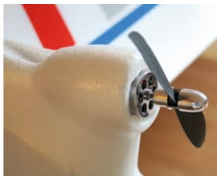
Um die Vibrationen zu reduzieren, sollte man den Propeller für Videoaufnahmen wuchten oder ersetzen
