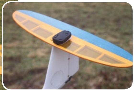
*Einen schönen Blick über sein Modell bekommt man, wenn die Kamera oben auf einem T-Leitwerk befestigt ist. Dabei sollte man bedenken, dass der Schwerpunkt neu ausgewogen werden muss. Je nach verwendeter Kamera ist es möglich, auch mit verschiedenen Objektiven zu spielen. Mit einem Weitwinkel sieht man besonders viel vom Modell*
