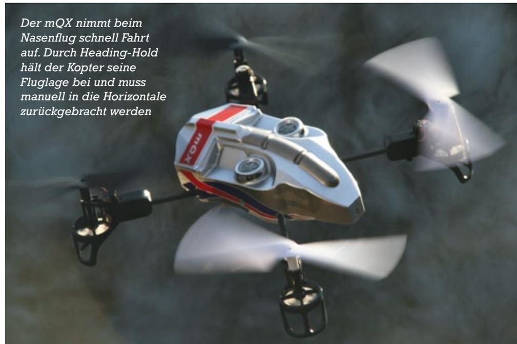
Der mQX nimmt beim Nasenflug schnell Fahrt auf. Durch Heading-Hold hält der Kopter seine Fluglage bei und muss manuell in die Horizontale zurückgebracht werden
