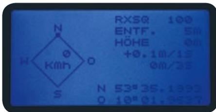
Das GPS-Modul macht aus der mc-32 ein regelrechtes Cockpit. Lädt man ein Bild der Umgebung von Google Earth in den HoTT-Manager, kann man die Bewegungen seines Flugs nachvollziehen
