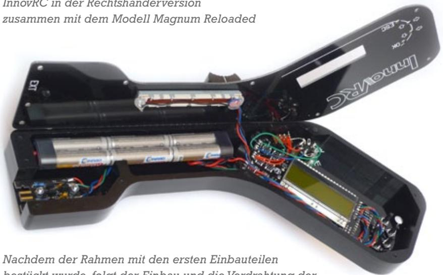
Nachdem der Rahmen mit den ersten Einbauteilen bestückt wurde, folgt der Einbau und die Verdrahtung der Elektronik. Gut zu erkennen: Beide Front-/Rückplatten sind doppelseitig bedruckt
