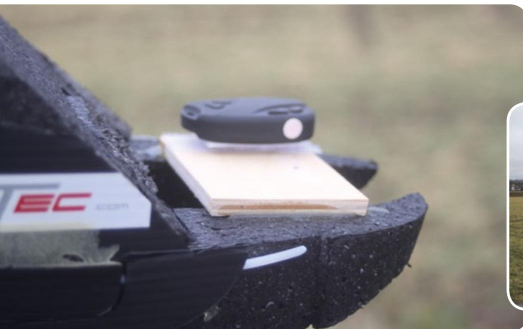
*Bei einem langsamen Elektro- oder Segelflugzeug reicht für die Befestigung Klettband aus. Hier ist die GunCam in der Rumpfnase des Vamp von Bormatec befestigt*
