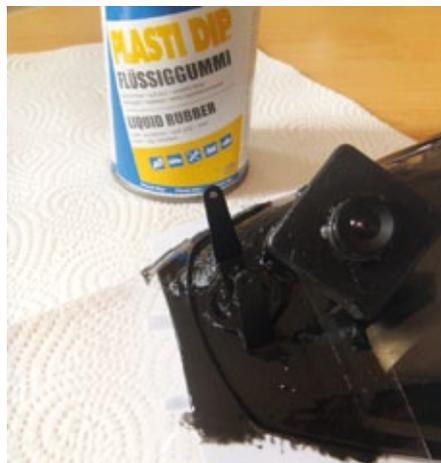
Die Befestigung des Kamerahalters und die Kabeldurchführungen dichten PlastiDip ab. Um hier eine saubere Kante zu erhalten, wurde schlicht mit Tesa abgeklebt
