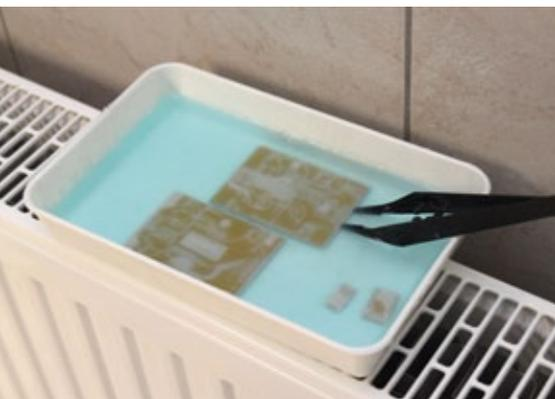
Im Ätzbad verschwindet das ungeschützte Kupfer. Die Heizung beschleunigt den Vorgang
