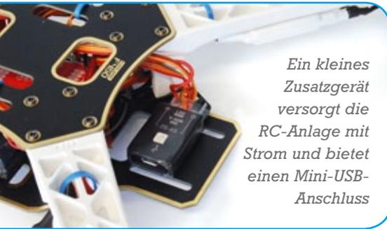
*Ein kleines Zusatzgerät versorgt die RC-Anlage mit Strom und bietet einen Mini-USB-Anschluss*
