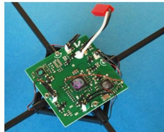
Die Hauptplatine beinhaltet die 4-in-1-Einheit. Sie fungiert als Empfänger, Controller, Mischer und Gyro
