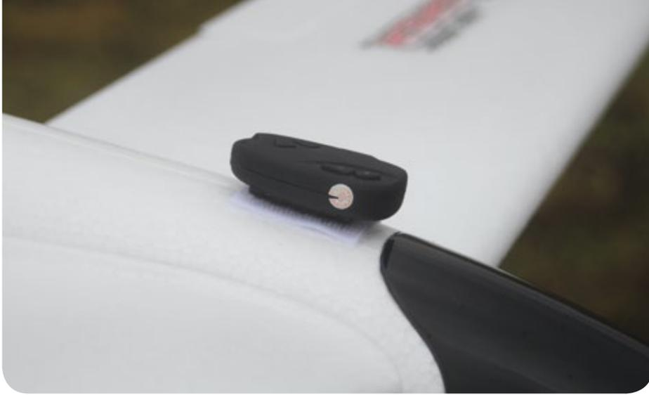
*Handelt es sich um einen Elektrosegler, so sollte die Kamera leicht schräg nach vorne zeigen, damit im günstigsten Fall der Propeller nicht im Sichtbereich der Kamera ist. Sichelförmige Streifen sind sonst die Folge und trüben das Filmergebnis*
