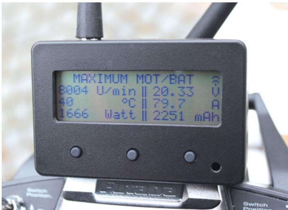
Das absolut erreichte Maximum kann jederzeit auf Knopfdruck abgefragt werden. Die Spannung stellt das gemessene Minimum des Akkus dar
