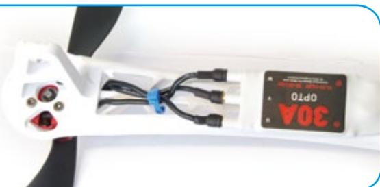
Die Motorkabel lassen sich durch die Ausleger ziehen. So wirkt der Aufbau viel aufgeräumter
