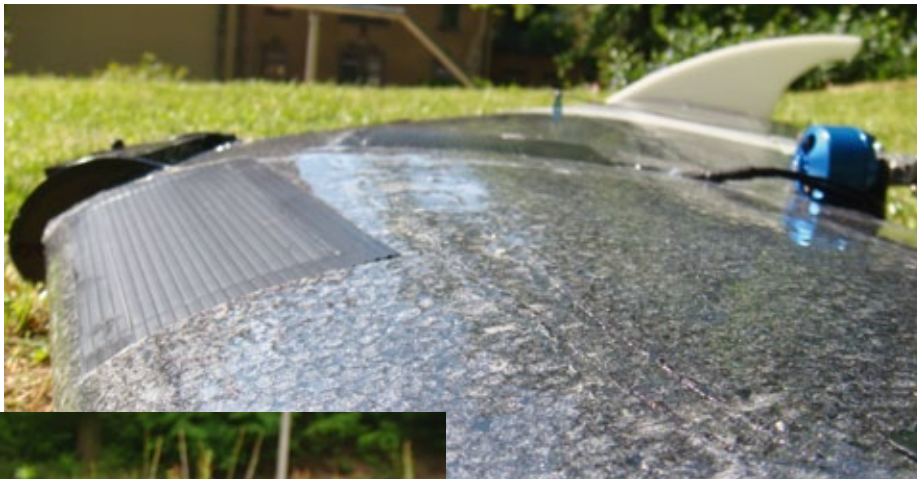
Die Oberfläche wird zuletzt mit Laminarfolie bebügelt. Das ergibt ein hartes und dauerhaftes Finish
