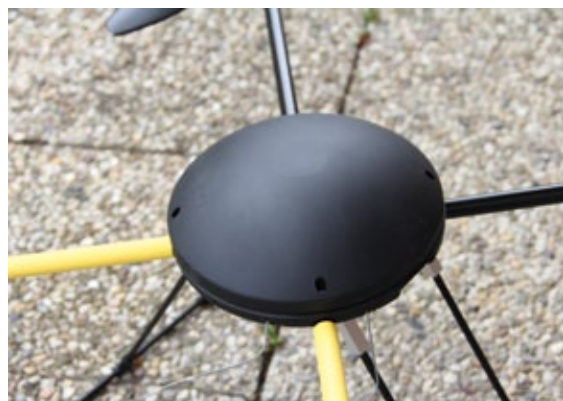
Die Haube schützt die Elektronik vor leichtem Regen
