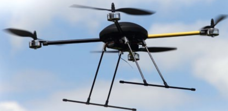
An der Aluminium-Schiene auf der Unterseite wird der Flugakku befestigt
