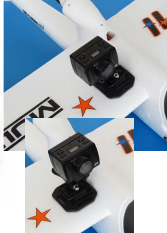
Idealerweise ist die Kamera mittig über dem Rumpf platziert. Eine leicht außermittige Position macht sich aber nicht negativ bemerkbar
