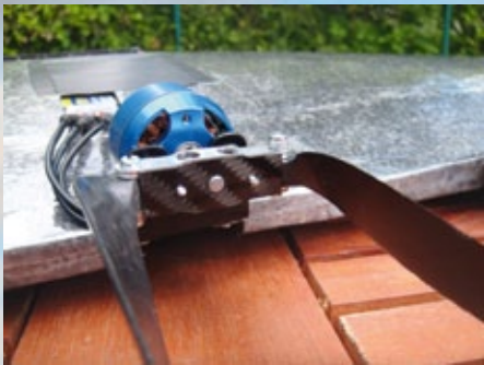
Um das Einklappen beider Propellerblätter zu einer Seite zu verhindern ist ein Abstandshalter erforderlich. Hier wurde einfach etwas CFK-Plattenmaterial auf das Mittelteil des Klapppropellers geschraubt
