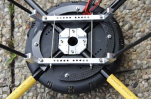
An der Aluminium-Schiene auf der Unterseite wird der Flugakku befestigt
