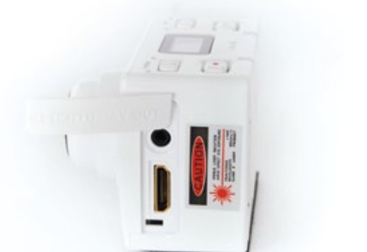
An der linken Gehäusesseite befinden sich ein Mini-HDMI-Port und ein AV-Out-Ausgang
