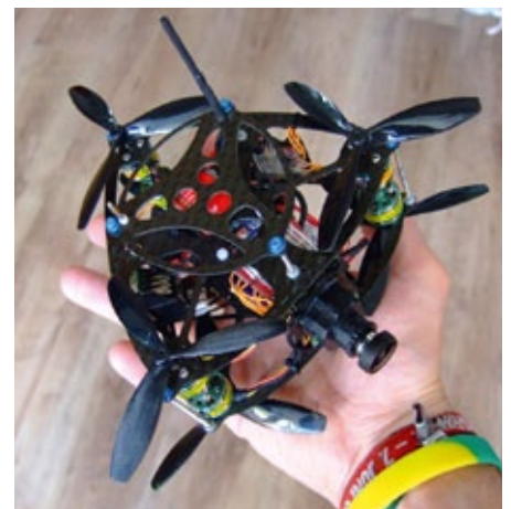
Die erste Version des Kopters ist noch ein paar Zentimeter größer. Man beachte den großen Abstand zwischen den Propellerspitzen
