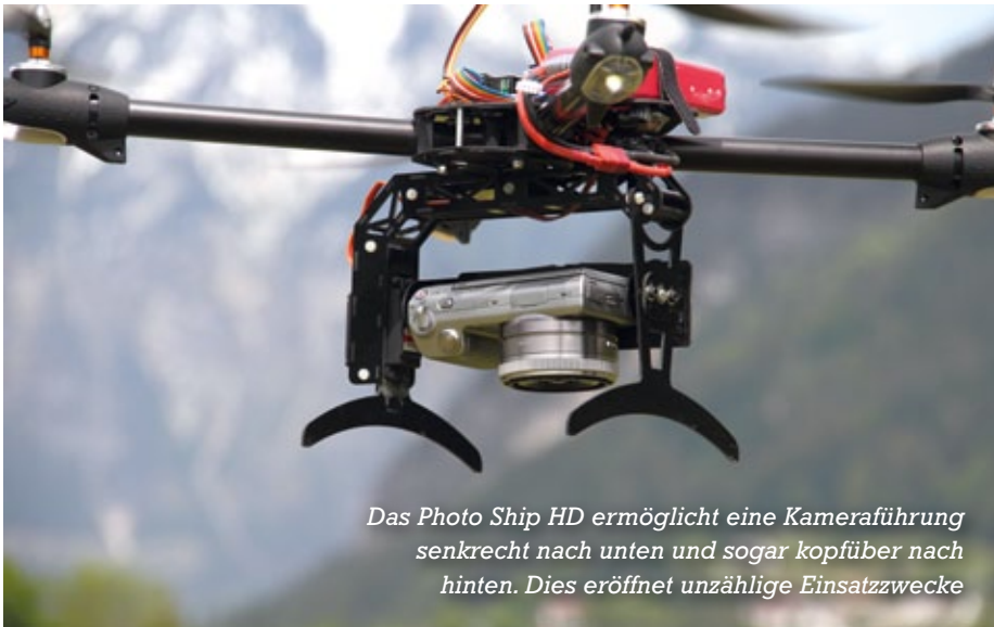
Bei einer Kameraausrichtung nach vorne sind die Ausleger nur bei Verwendung eines Weitwinkel-Objektivs zu sehen
