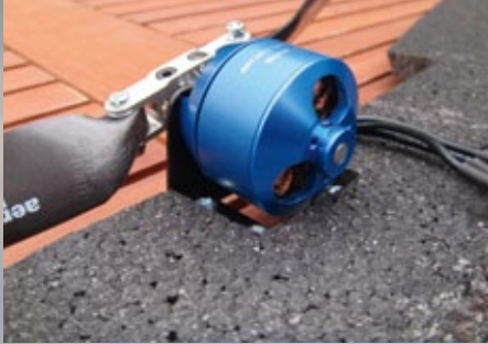
Auf diese montiert man danach einen L-Winkel aus Aluminium, an dem letztendlich der Motor verschraubt wird
