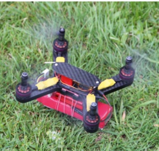
Wanze mit 2.600-Milliamperestunden-LiPo – das ging nur im Bodeneffekt
