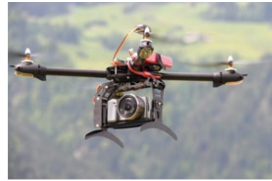
Bei einer Kameraausrichtung nach vorne sind die Ausleger nur bei Verwendung eines Weitwinkel-Objektivs zu sehen
