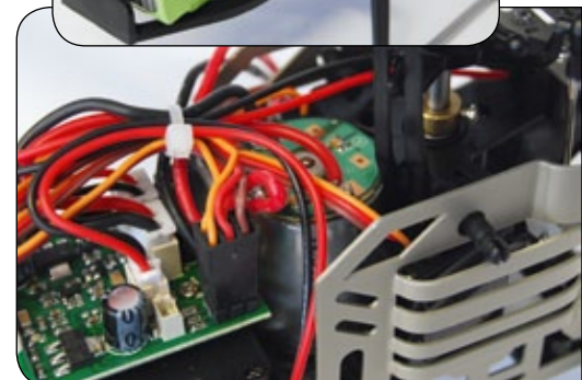
Für den Antrieb des Hauptrotors ist ein Motor in 370er-Baugröße verantwortlich
