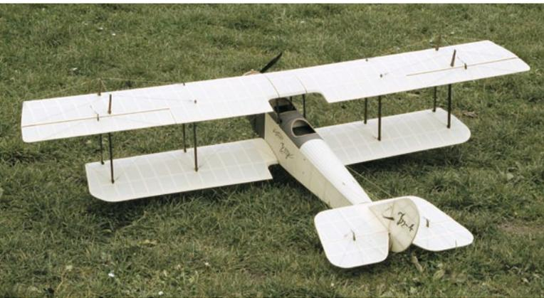
Abbildung 5: Die Curtiss-Jenny mit einer Spannweite von 1.800 mm hat ein im Vergleich zur maßstäblichen Verkleinerung doppelt so großes Höhenleitwerk – man merkt es kaum
