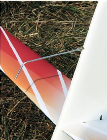
Die TEK-Düse wird im Seitenleitwerk eingebaut. Über eine in den Rumpf eingeklebte Messingbuchse ist diese zum Transport abnehmbar
