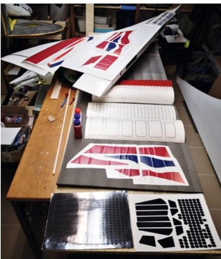
Aus dem Hause Tailormadedecals stammen die Klebefolien, die nach Schablonen aus Transparentpapier genau an das Modell angepasst wurden
