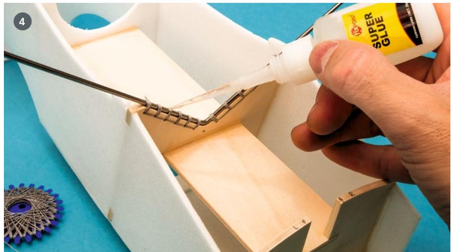
4) 2,5-mm-Federstahldraht besitzt genau die richtigen Eigenschaften für sichere Starts und Landungen. Den per Schraubstock und Kombizange gebogenen Draht nähern wir ganz klassisch am Fahrwerksspannt fest und tränken die Fäden mit dünnflüssigem Sekundenkleber.
