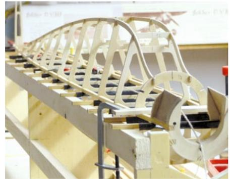
**Spätestens bei diesem Bild zum Rumpfbau wird klar, warum eine Helling nötig ist**
