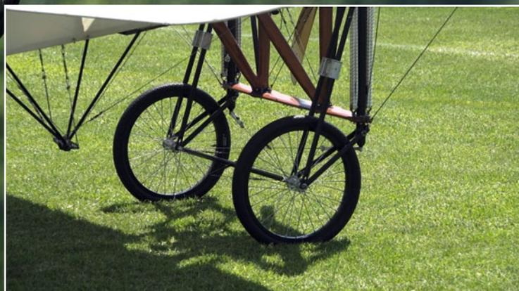
Bei solchen Modellgrößen können bereits handelsübliche Fahrradräder eingesetzt werden
