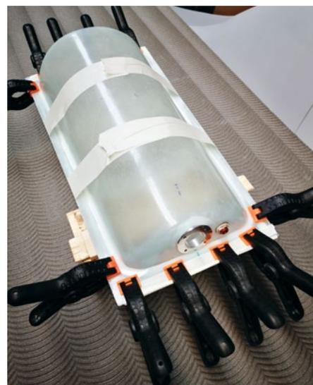
Der GFK-Tank wird in zwei Halbschalen geliefert. Nach dem Einbau der Beschlüge werden sie mit angedicktem Harz verklebt
