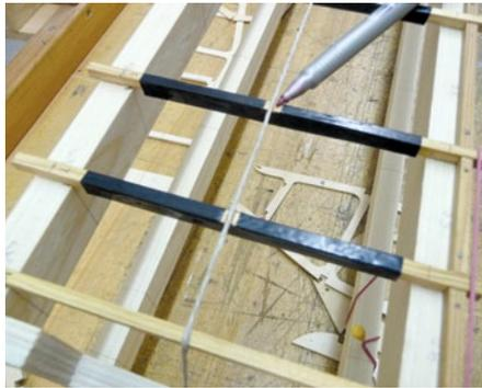
**Zur Orientierung und exakten Ausrichtung von Spanten und Stringern werden Linien markiert und abgespannt**
