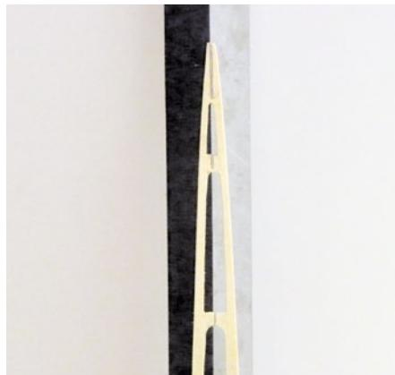
Kleine optische Hilfe beim Ausrichten der vertikalen Seitenleitwerksrippe: Um einen besseren Kontrast zu erreichen, wurde ein Winkel zur Hälfte mit schwarzem Klebeband abgedeckt
