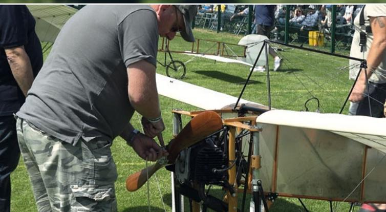
Verbaut sind jeweils modifizierte Rasenmähermotoren. Im „kleineren“ 1:2-Modell wird dieser noch mit Seilzug gestartet
