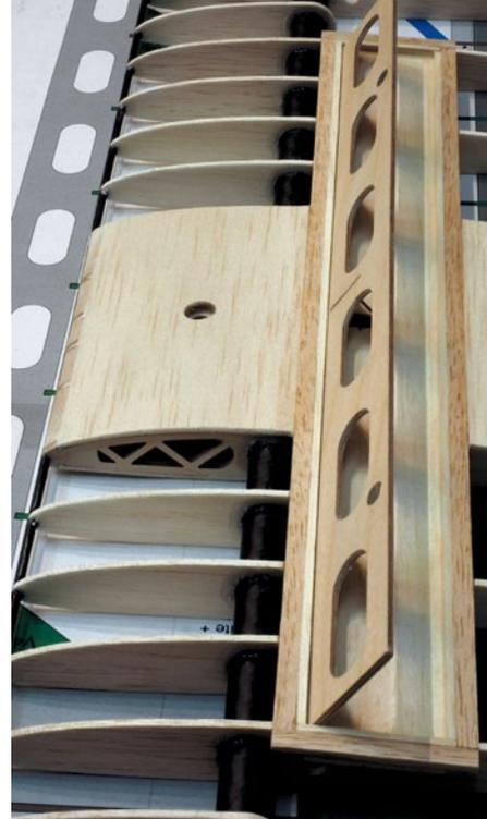
**Der Spoiler im Rohbau:** Die Klappe wird mit kleinen Neodym-Magneten in der Ruhestellung gehalten, so bleibt sie sauber geschlossen und das Servo zieht nur noch Ruhestrom. Im Schnellflug würde die ganze Klappe etwas nach oben gesaugt werden, das Servo müsste dagegen halten
