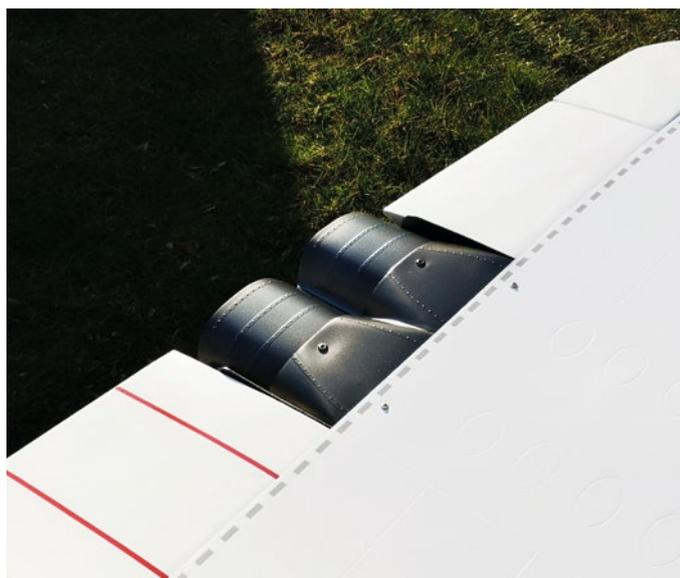
**Mit Streifen aus Klebefolie und ein paar Nieten lassen sich die Triebwerksauslässe aufwerten**
