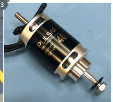
1) Unter der Motorhaube ist mehr als genug Platz für den Motor. Da das Brandschott keinen Motorsturz hat, sorgen zwei Unterscheiben dafür. 2) Bei leichten Antrieben finden die beiden Leitwerksservos ihren Platz unter dem Flügel. 3) Der Motor passt perfekt unter die geräumige Motorhaube aus GFK. Die sitzt auf vier Abstandshaltern. So kann die Kühlluft problemlos entweichen
