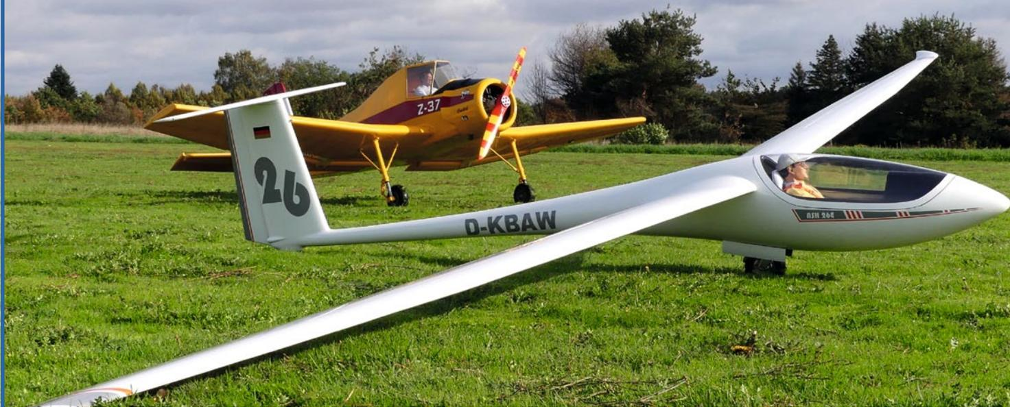
Die Original ASH-26 wurde von Schleicher für die 18-m-Klasse entwickelt und serienmäßig mit Wölbklappen und Einziehfahrwerk ausgestattet. Fast alle gebauten Muster lieferte man in der E-Version aus, wobei „E“ hier für Engine, genauer gesagt das mit einem Wankelmotor bestückte Klapptriebwerk steht. Das Modell der Firma Airworld im Maßstab 1:3 ist in Voll-GFK/CFK-Bauweise hergestellt. Der nahtlose Rumpf ist ebenso wie das komplette Modell in RAL 9016 weiß eingefärbt. Mit dem verfügbaren
