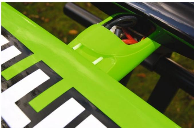
Die Tragfläche wird vorn durch zwei Bolzen sowie die ausgeprägte Rumpfausformung sicher gehalten
