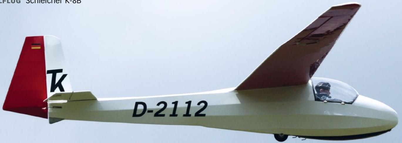
Der Rumpf dieser K 8B entspricht in Formgebung und Aufbau fast der alten Hegi K-8B, die Spannweite wurde auf originalgetreue 2.200 mm vergrößert
