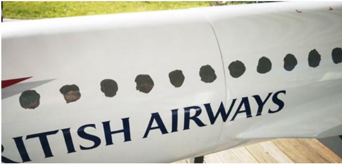
Nach dem Antrocknen wurde fast alles mit einem terpentin getränkten Lappen abgewischt, sodass nur die Kanten sichtbar blieben – eine Arbeit, die man am besten im Freien erledigt
