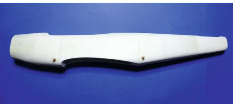
Komplett montierter und verschliffener Rumpf
