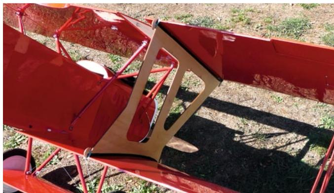
Im Bausatz finden sich zwei gepolsterte Transportgestelle, die vor der Demontage der Flügel nahe des Baldachins eingesetzt und mit jeweils einem Gummiring oben und unten an den Flügeln gesichert werden. Nach Lösen von zwei Schrauben kann das Flächenpaar in einem von den Steckungsrohren gezogen werden. In umgekehrter Reihenfolge wird montiert. So kann der Doppeldecker fast so schnell wie ein Eindecker auf- und abgerüstet werden
