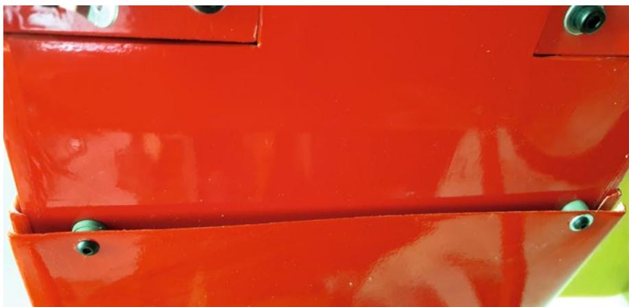
Die kleinen Abkantungen unten an der Motorhaube (rechts und links) verhindern, dass diese zum Verschrauben flach auf dem Rumpfbau aufliegt. Um das auszugleichen wurden Distanzscheiben untergelegt
