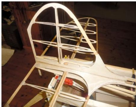
**Beim Zusammenbau mit Ausrichten von Höhen- und Seitenleitwerk sowie der beiden Flächenhälften muss zwingend exakt gearbeitet werden. Dafür wurde die Rumpfhelling mit zwei Abstützungen für die Tragflächen erweitert**
