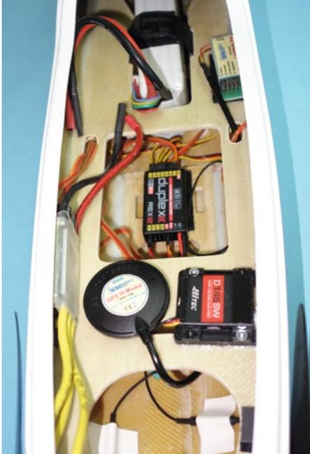
Die GPS-Antenne braucht eine „CFK-freie“ Sicht nach oben. Je mehr Satelliten gefunden werden, desto besser
