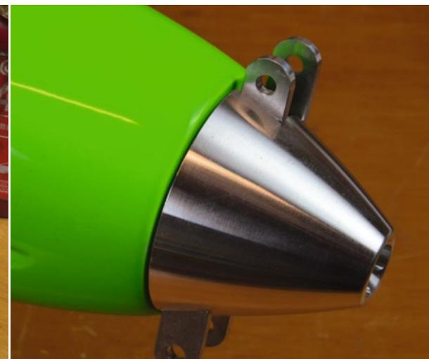
**Der Motorspant aus CFK passt exakt und sorgt damit für einen sauberen Rumpf-Spinner-Übergang**
