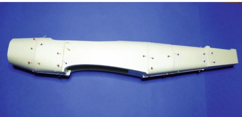
Die Bauteile für den Rumpf werden beim Verkleben mit Stecknadeln fixiert
