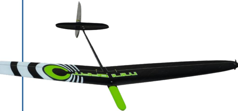
Der Mini Dart ist ebenfalls neu bei Hepf Modellbau. Das Plug-and-Play-Modell wurde für die 1.000-mm-F3K-Wettbewerbsklasse konzipiert und ist als CFK-Variante mit 115 g Gewicht und als 120 g wiegende GFK-Version ab 369,- Euro in unterschiedlichen Farben erhältlich. Laut Hersteller ist der 720 mm lange Mini Dart für Einsteiger und als Spaßmodell geeignet, um auch an kleineren Hügeln oder Geländekanten im Aufwind oder in der Thermik zu fliegen. [www.hepf.at](http://www.hepf.at)
