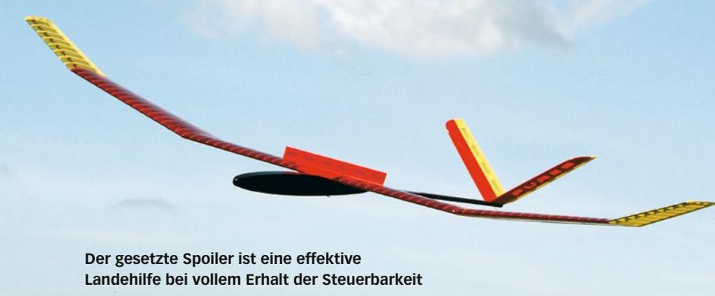
**Der gesetzte Spoiler ist eine effektive Landehilfe bei vollem Erhalt der Steuerbarkeit**
