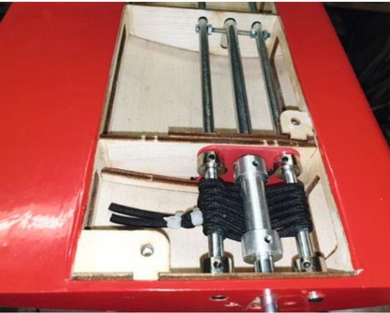
Über einen großen, abnehmbaren Deckel gelangt man an die ziemlich originalgetreue Gummiband-Federung. Selbst eine verbogene Achse ließe sich sehr schnell und einfach ersetzen
