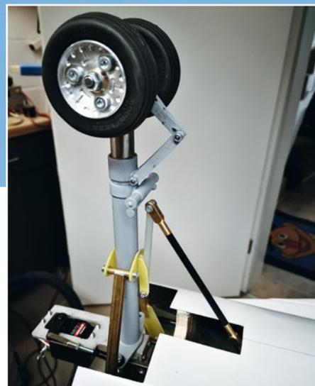
Im ausgefahrenen Zustand des Bugfahrwerks ist die Alu-Aufnahme für das Lenkservo gut zu erkennen
