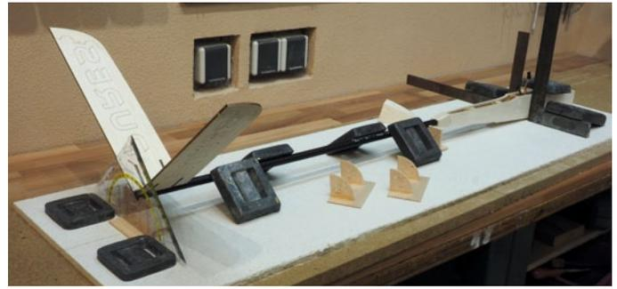
Die Hochzeit des Kohlefaserrohrs mit dem Rumpf. Die präzise Bauanleitung nebst Bauhilfen wie die Leitwerksträger-Auflagen sorgen dafür, dass hier nichts schief geht
