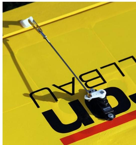
Typisch „Zweitausender“. Gradlinige Querruderanlenkung durch zwei Flächenservos statt Torsionsanlenkung beider Querruder mit nur einem Servo
