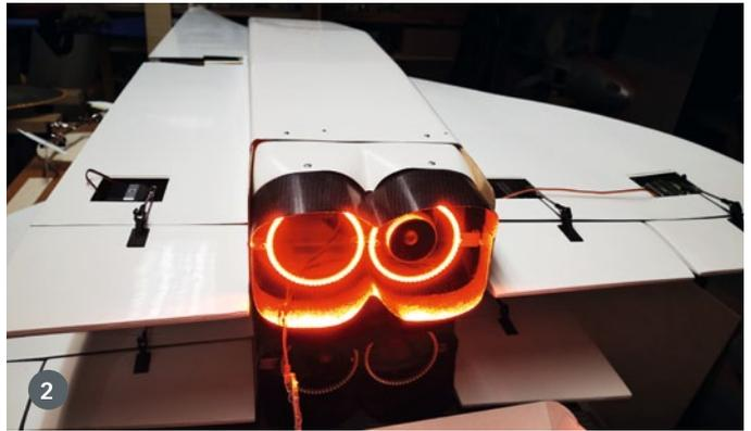
1) Lichttest im Keller bestanden. 2) Die Nachbrennerringe sind ein ganz besonderer Effekt an der Concorde. Gut zu sehen, wie die mit selbstklebender Alufolie ausgekleideten Innenseiten der Triebwerksauslässe den Lichtschein reflektieren. 3) Auch die Detaillierung der Unterseite von Modellen ist wichtig, besonders wenn gut fotografiert wird. Gut zu erkennen sind die Beschriftungen und die Beleuchtung
