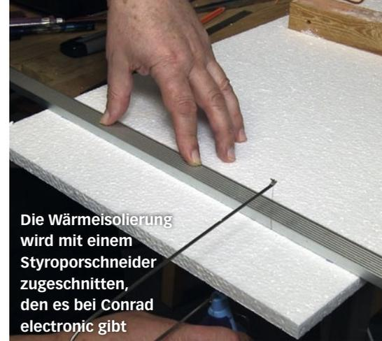
Die Wärmeisolierung wird mit einem Styroporschneider zugeschnitten, den es bei Conrad electronic gibt
