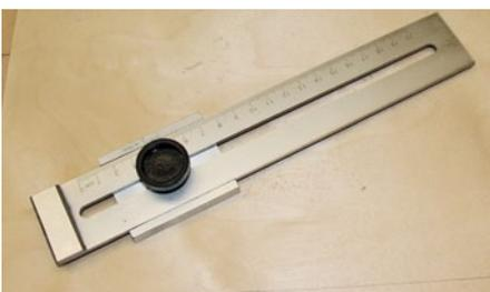
Gerät des Autors: Reiter mit Feststellschraube und Anschlag, das verschiebbare Lineal mit Millimeter-Skala
