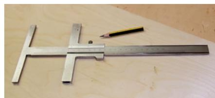
Die komfortablere Version des Modellbaukollegen: Der links abgebildete Querbalken kann als Lineal benutzt werden, es gilt der Außenrand als Bezugslinie
