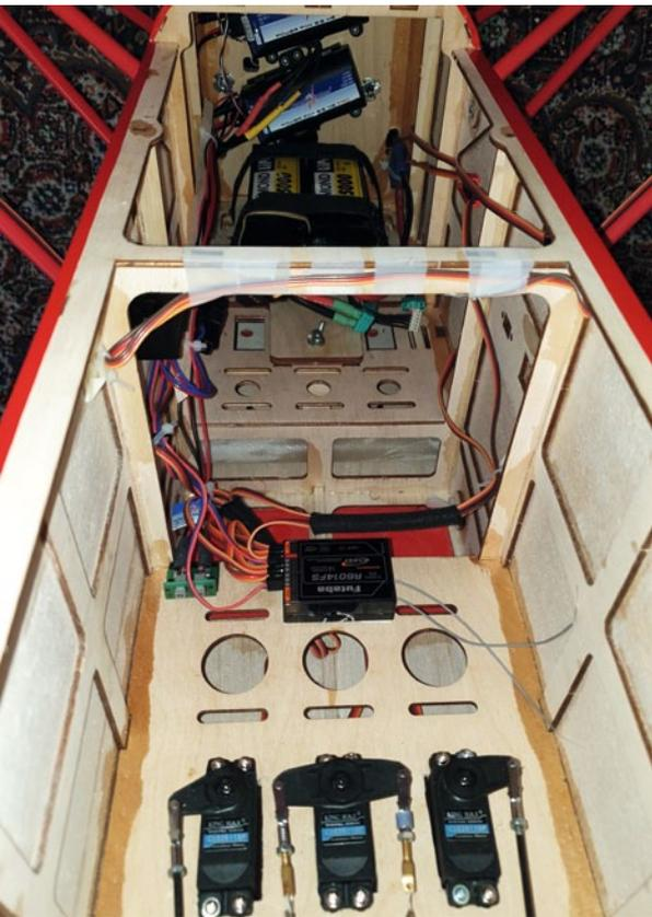
**Blick in den offenen Rumpf. Ganz vorne die zwei PowerPak-Akkus, als Weiche wird ein PowerBox Sensor verwendet, der gleichzeitig auch als Schalter fungiert. Die beiden Antriebsakkus sind auf einem herausnehmbaren Schlitten befestigt, der im Bausatz enthalten ist. Mittig und hinten Empfänger und Servos**
