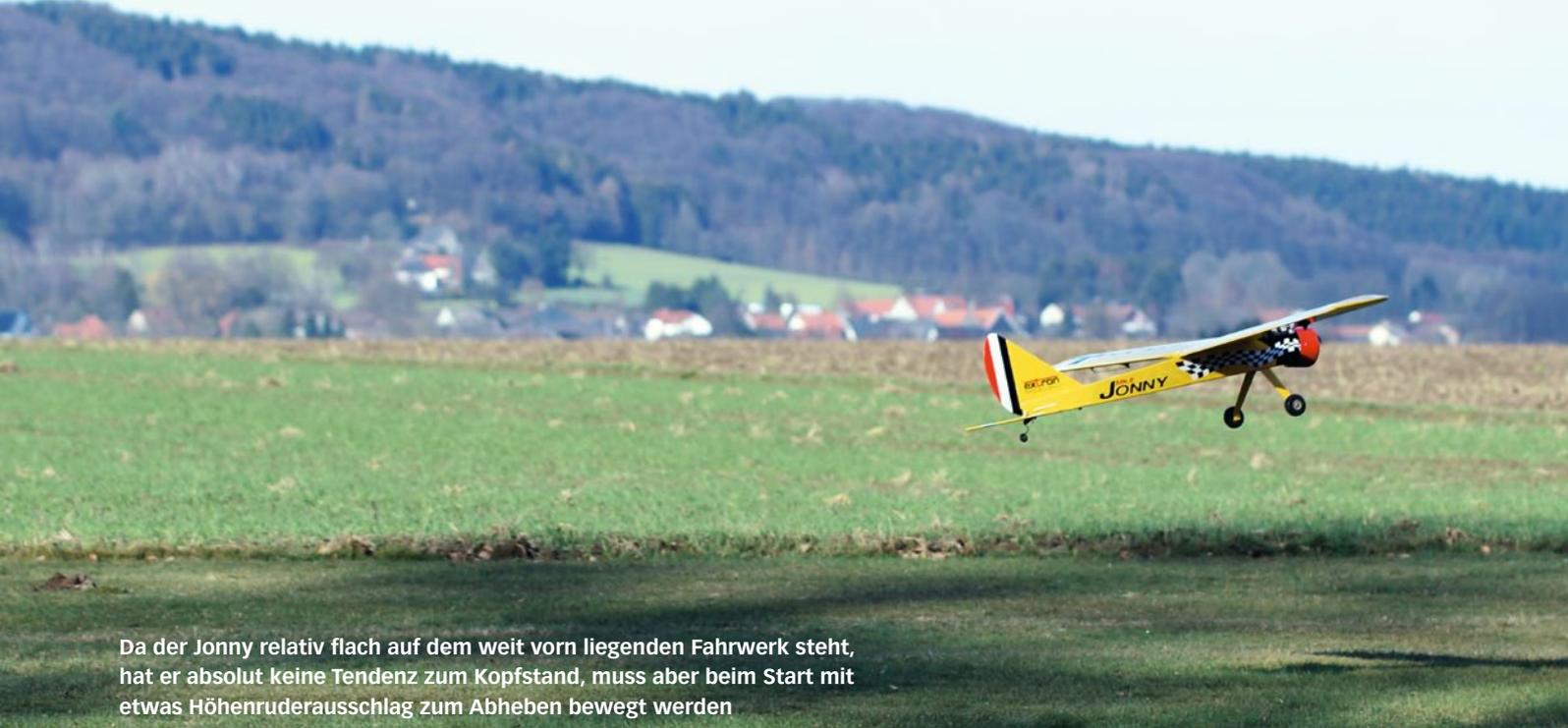
Da der Jonny relativ flach auf dem weit vorn liegenden Fahrwerk steht, hat er absolut keine Tendenz zum Kopfstand, muss aber beim Start mit etwas Höhenruderausschlag zum Abheben bewegt werden
